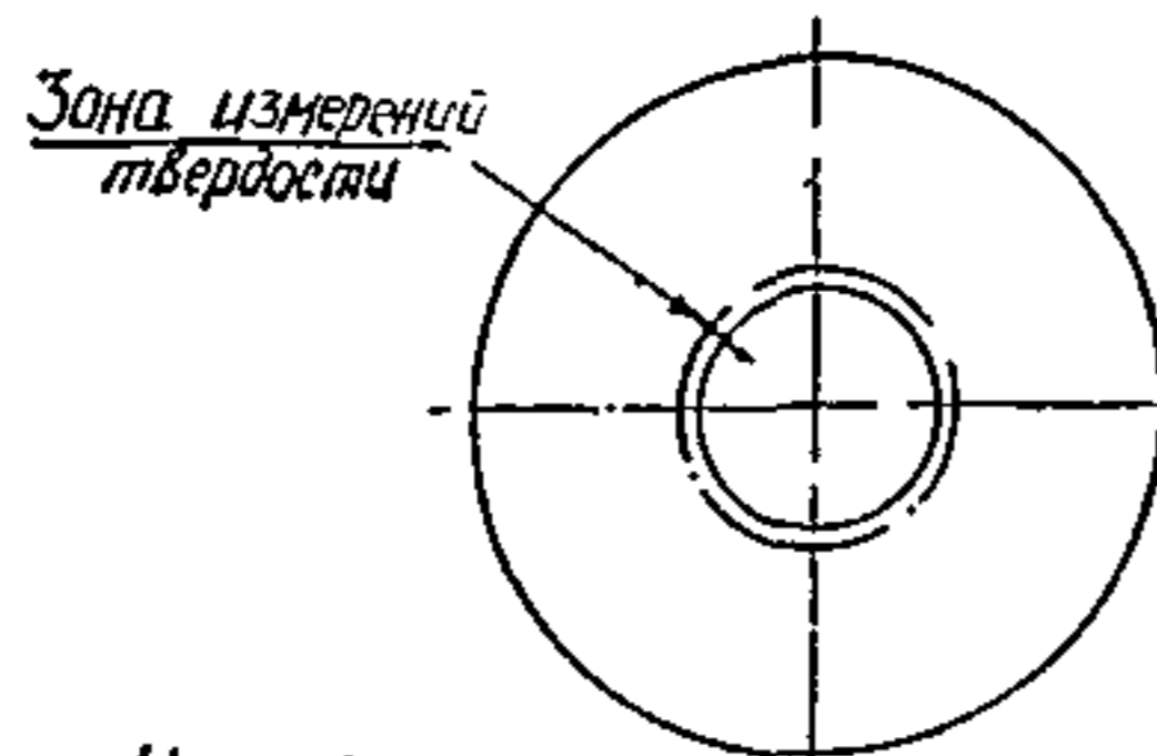
Черт. 1. Образец-свидетель для проверки твердости ГОСТ 17801-77, ГОСТ 17802-77, ГОСТ 17803-77, D ≤ 50
