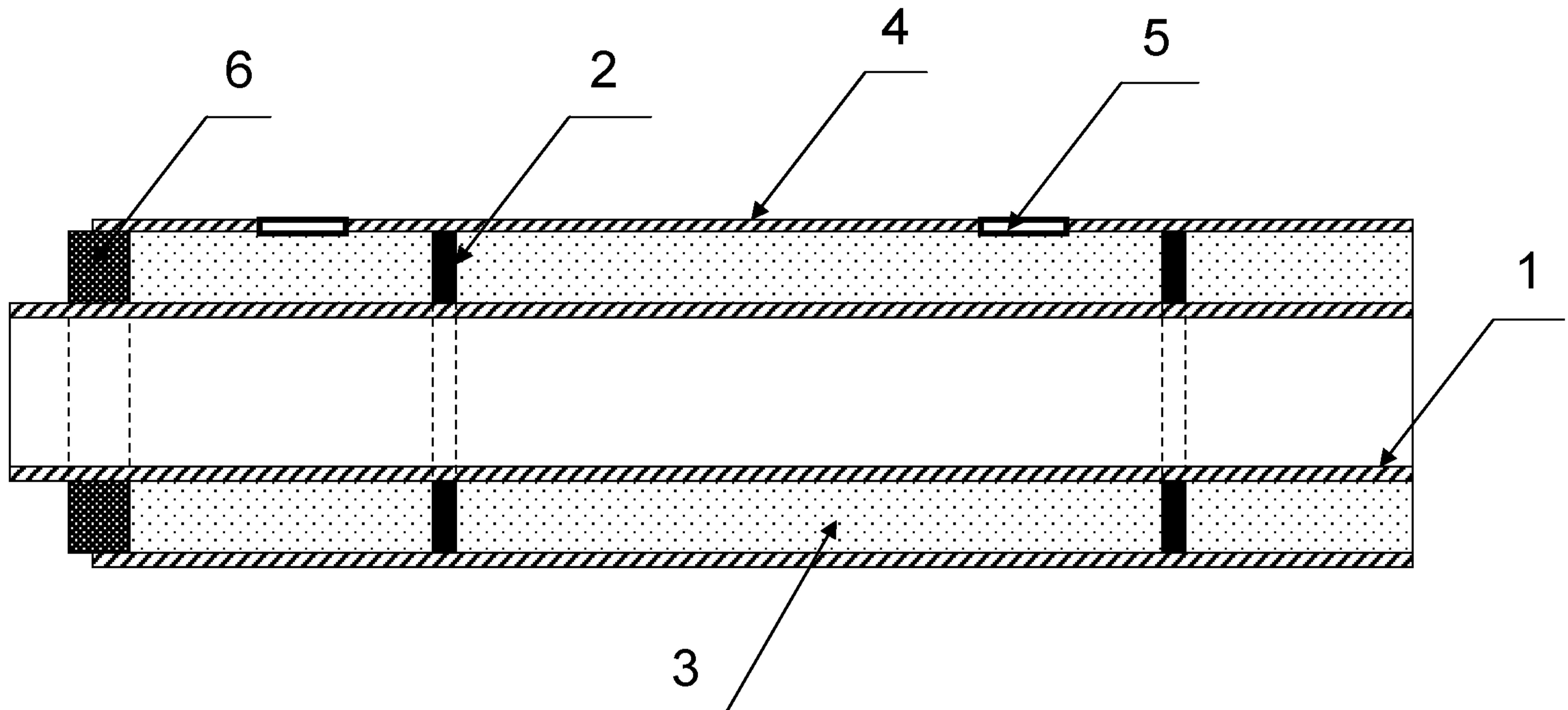
1 – изолируемая труба; 2 – центрирующая опора; 3 – изоляция из пенобетона; 4 – гидроизоляционная оболочка; 5 – заливочное отверстие; 6 – торцевой уплотнитель.
