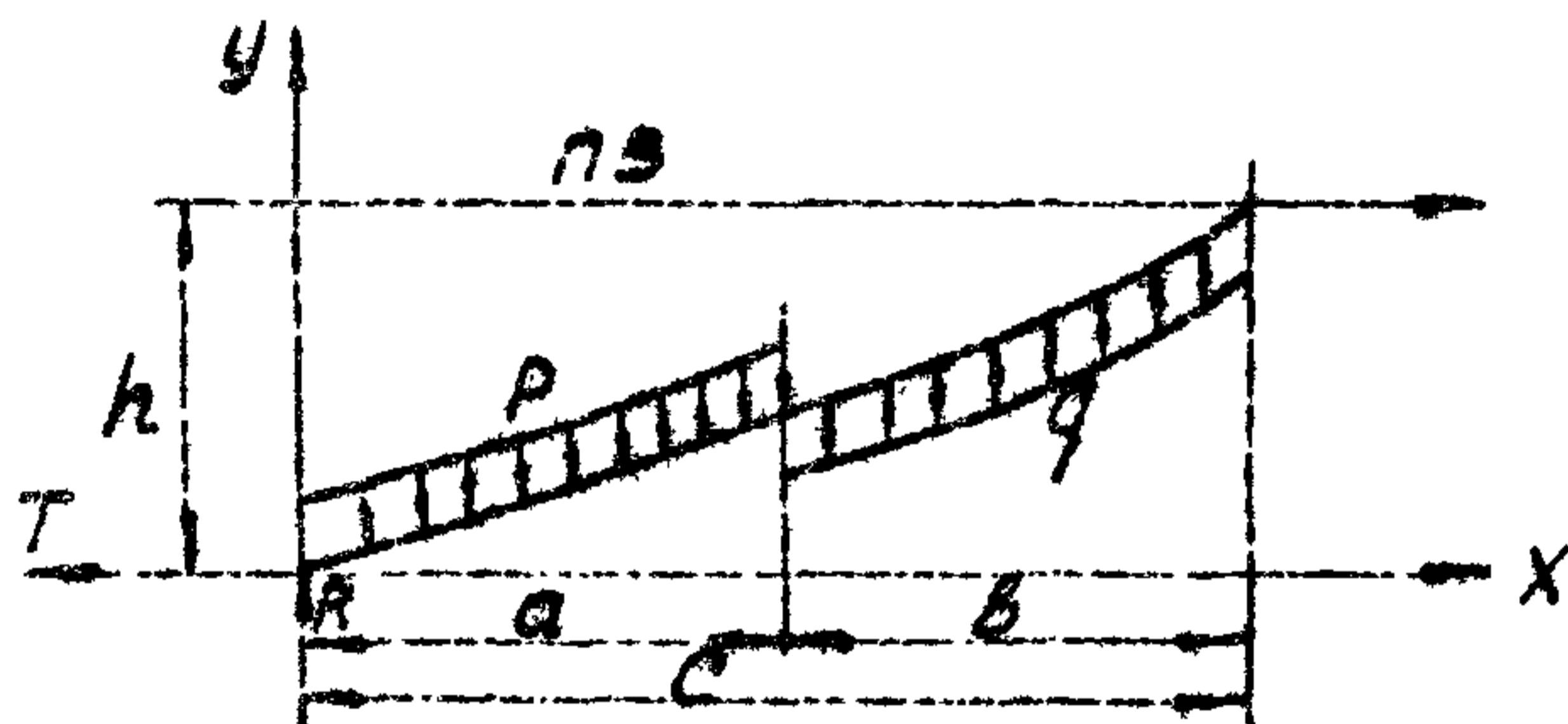
Усилия в трубопроводе при консольном изгибе (схема а) определяют следующим образом. Максимальный изгибающий момент в трубопроводе находят по формуле
