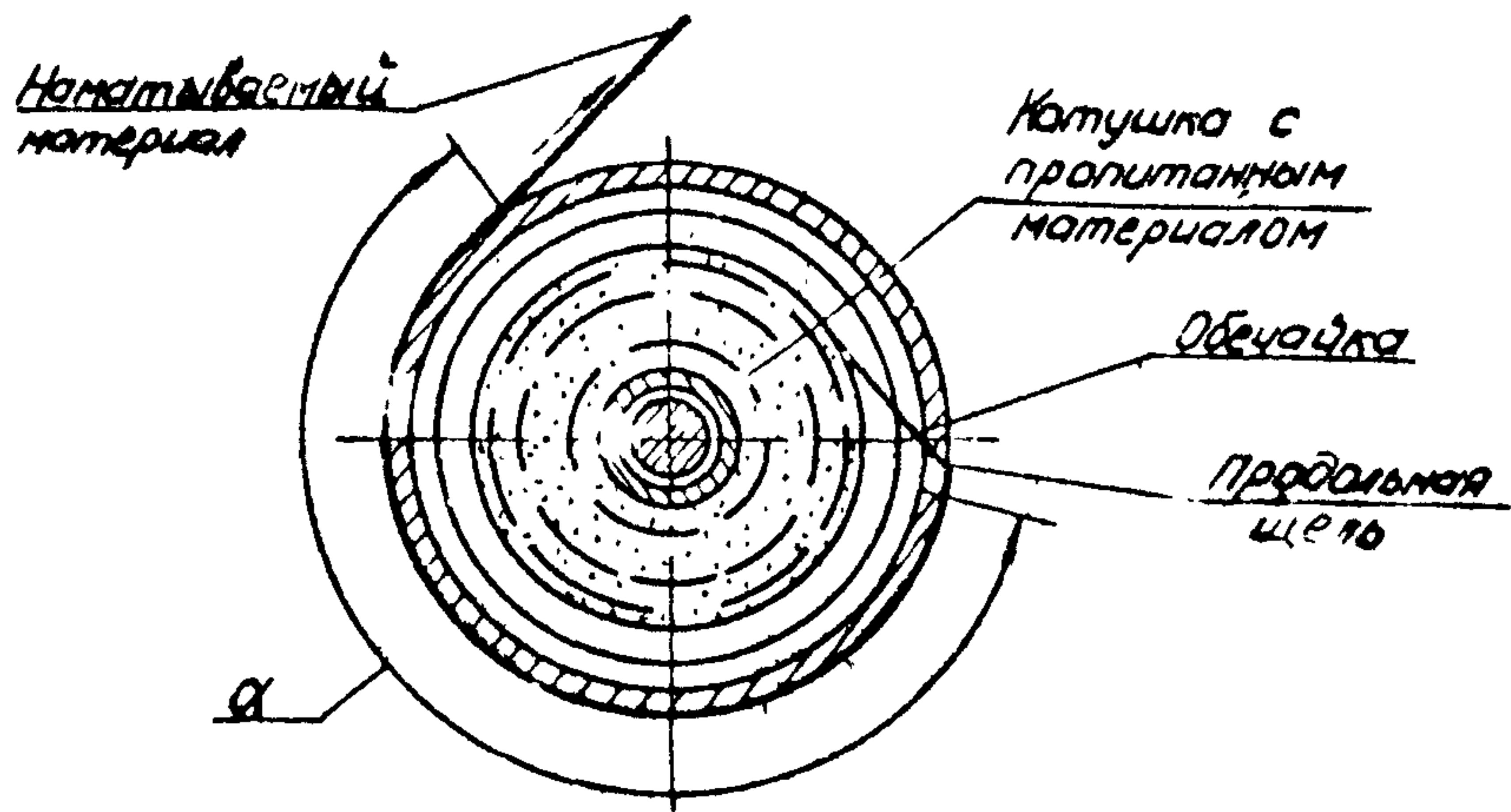
Рис. 6. Поперечный разрез тормозной обечайки с установленным в ней наматываемым материалом
