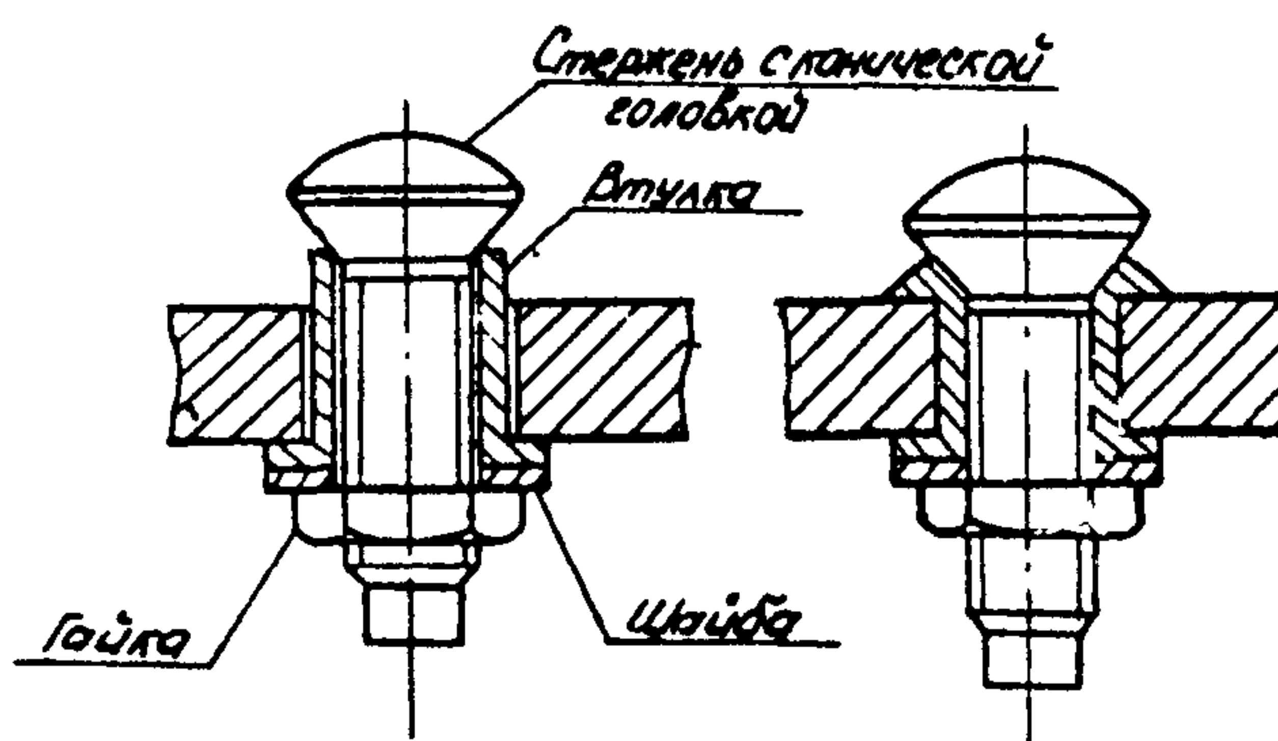
Рис. 2. Пробка разъемная
