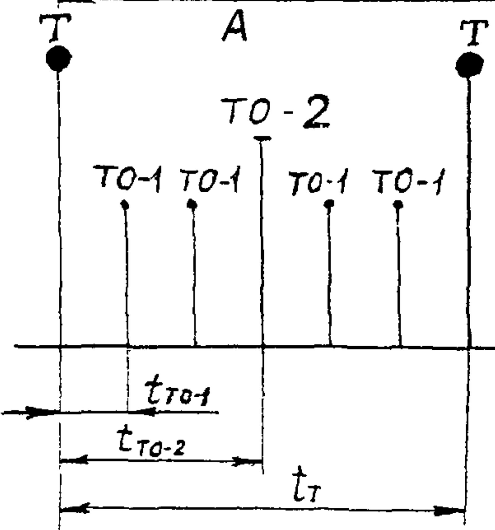
Рис. Б1 Типовой график проведения технических обслуживаний и ремонтов ТОиР (на весь жизненный цикл) эксплуатации башенного крана:
