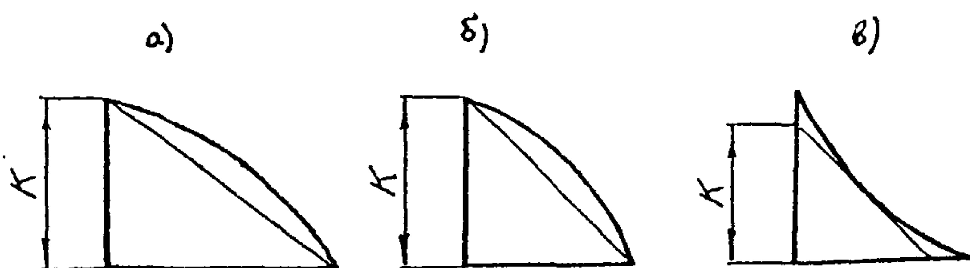
Рис. Ж1. Определения катета К для выпуклых (а, б) и вогнутых (в) швов
