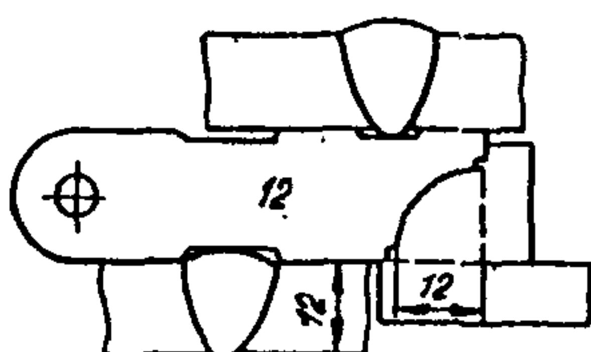
Рис. Ж5. Специальный шаблон для контроля сварных швов
