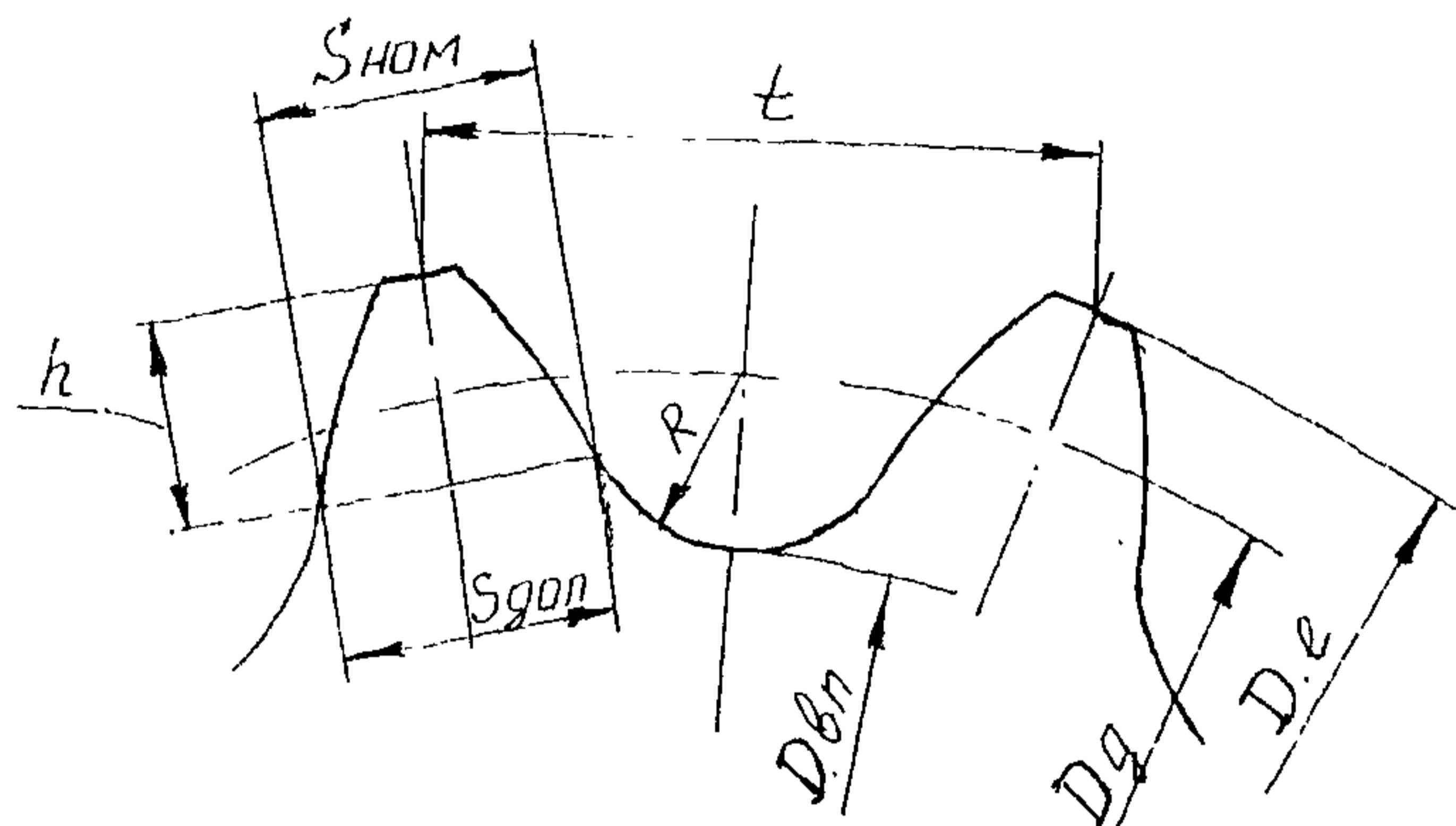
Рис 3 Геометрические параметры профиля зубьев звездочки.
