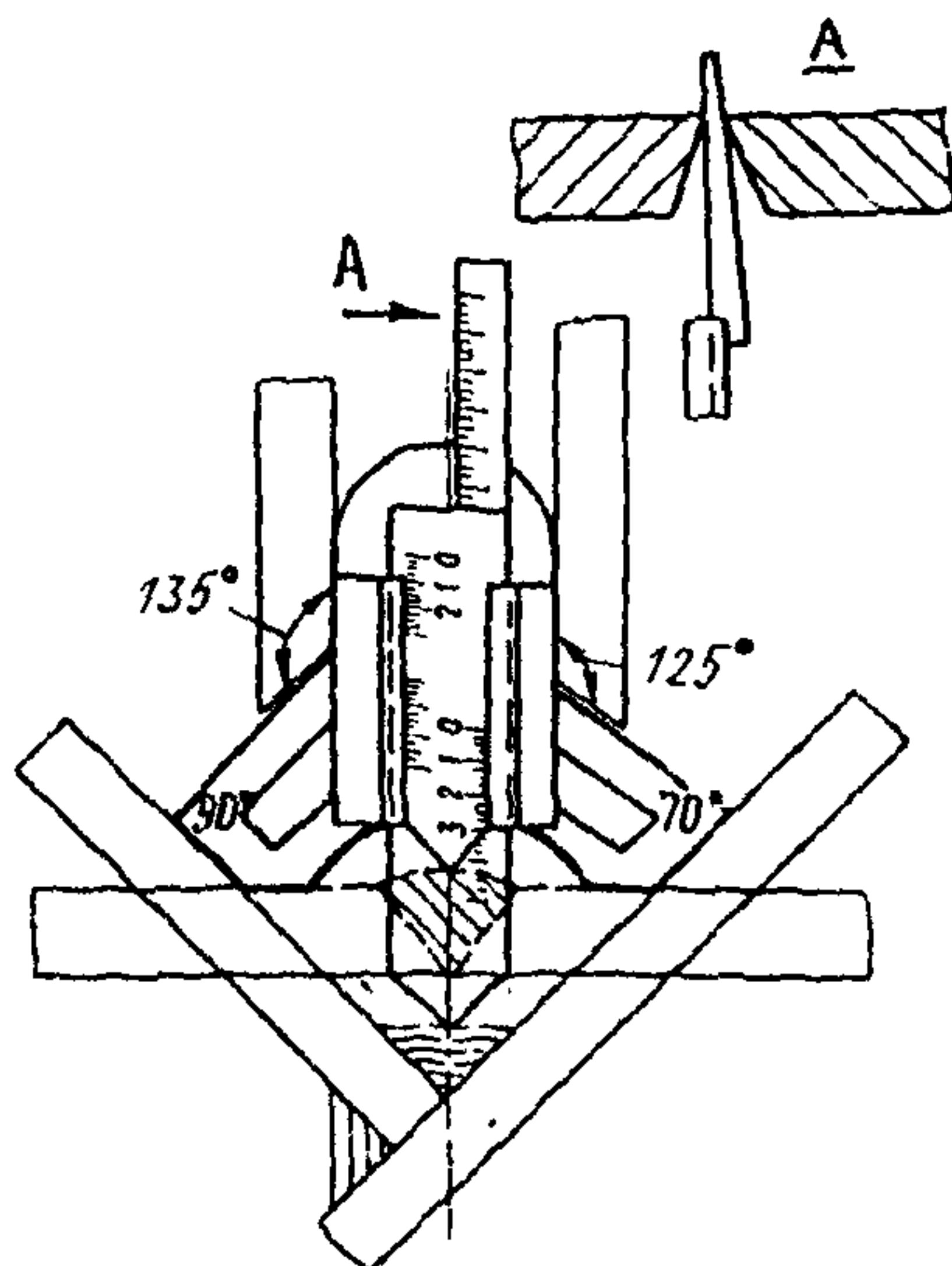
Рис. Ж2. Контроль универсальным шаблоном конструкции В. Э. Ушерова-Маршака
