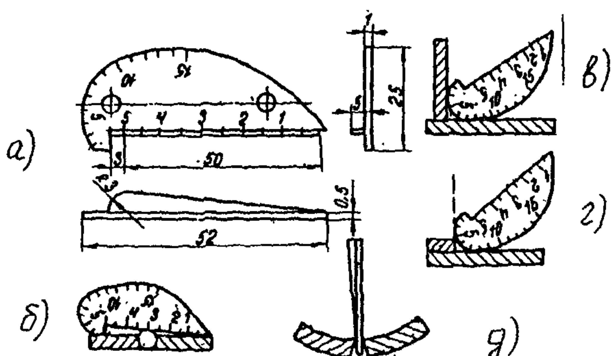
Рис. Ж3. Контроль универсальным шаблоном конструкции А. И. Красовского
