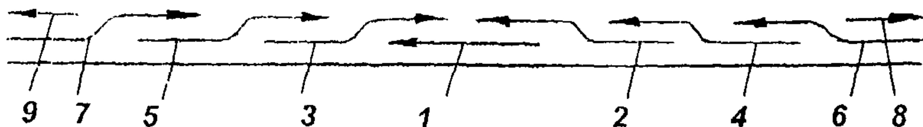
9.2.5.3. Наложение многослойных швов следует выполнять обратно-ступенчатым способом согласно рисунку. Каждый последующий слой выполнять после остывания предыдущего и очистки от шлака. При этом длина каждого шва не должна превышать 200 мм
