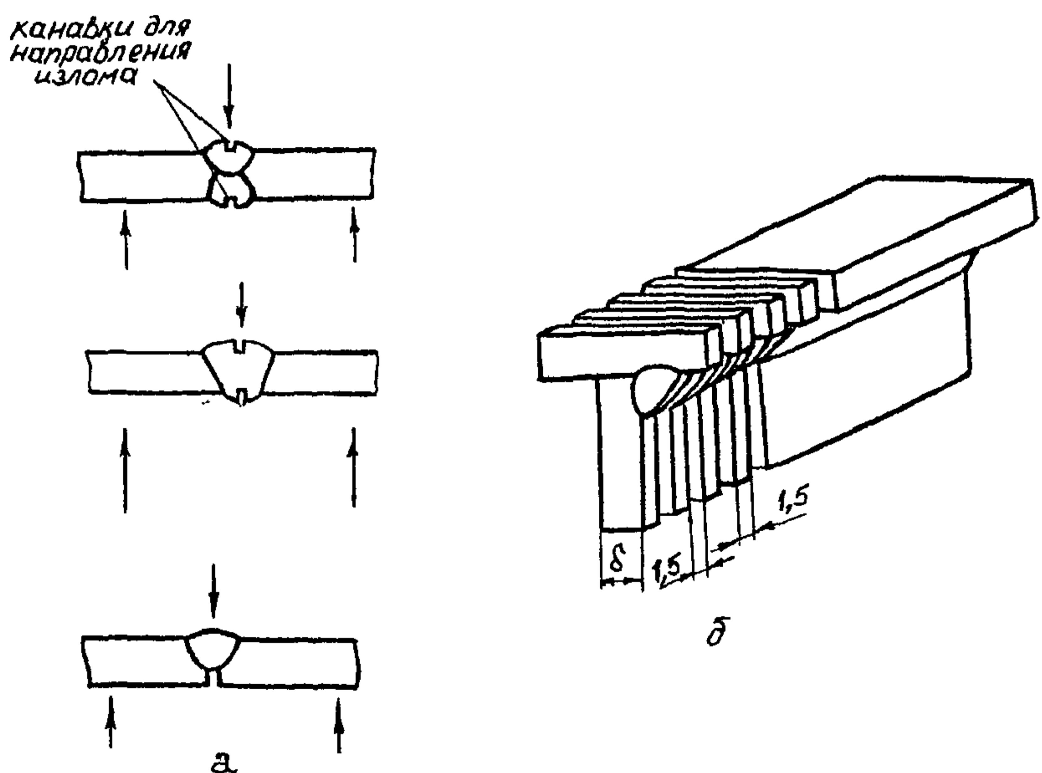
Рис. Ж6 Вскрытие сварных швов изломом (а)
