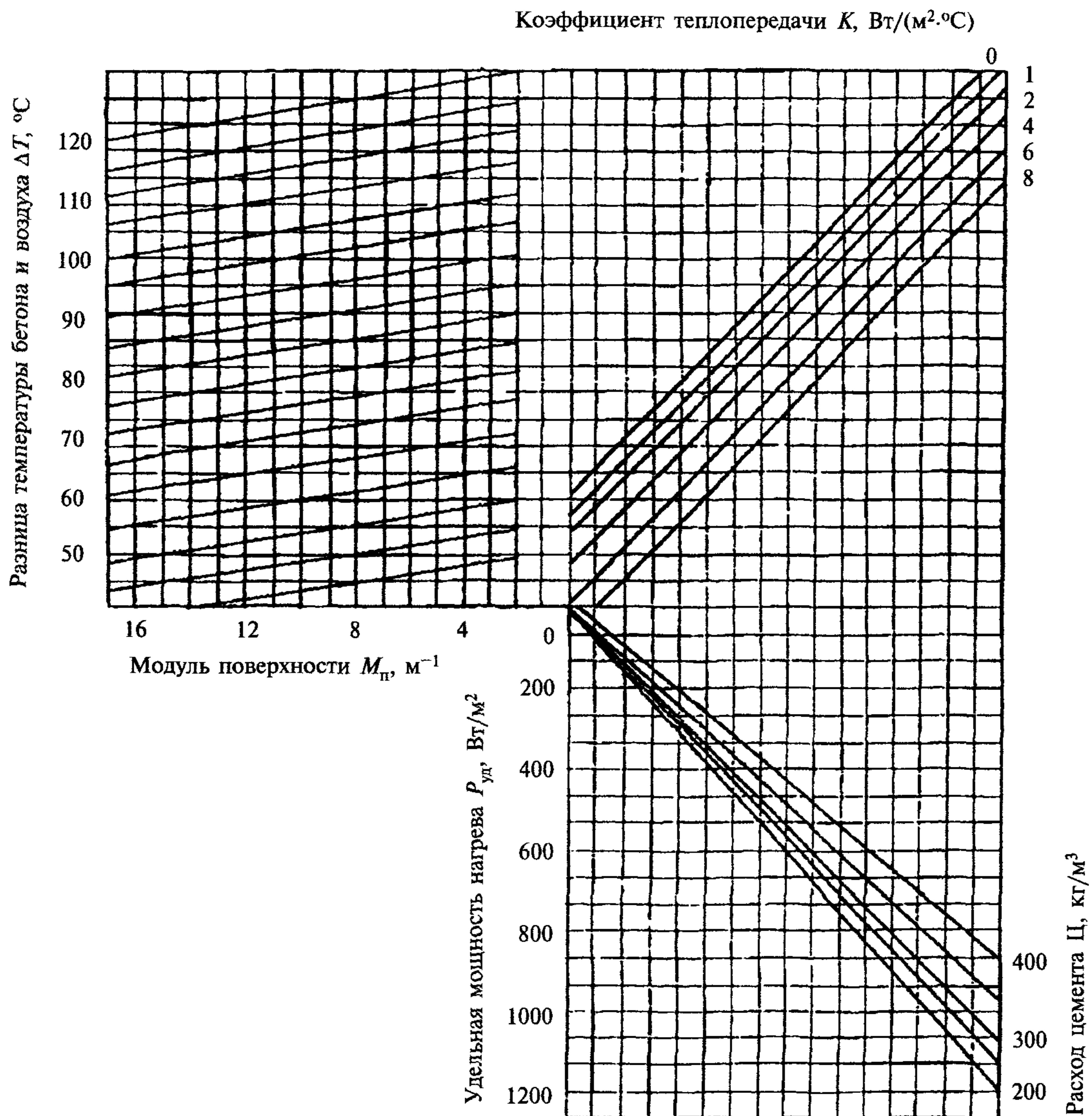
**Рисунок 1 — Номограмма для определения удельной мощности нагрева бетона**
