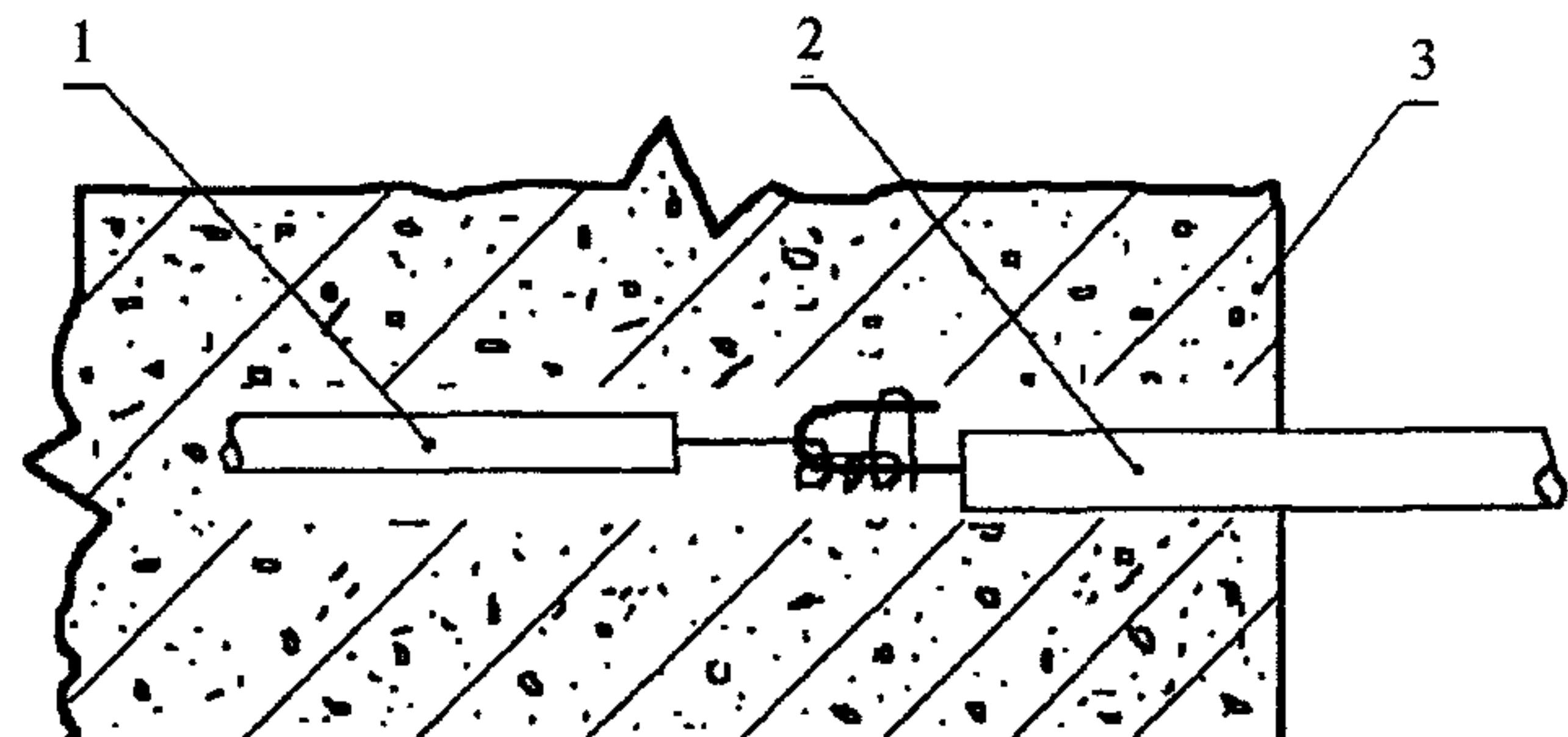
**Рисунок 4 — Вывод проводов из бетона**
