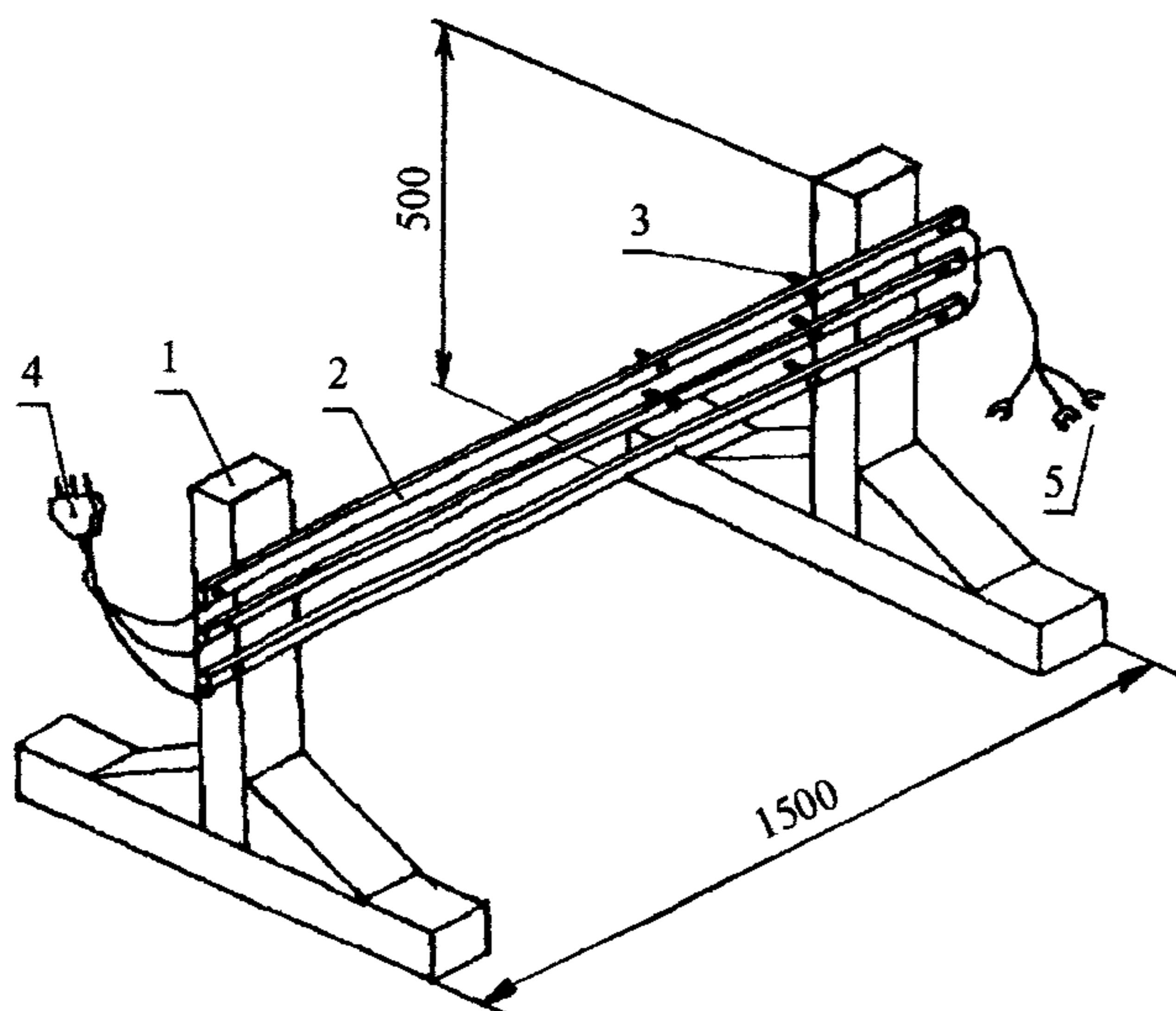
**Рисунок 5 – Инвентарная секция электроразводки для коммутации нагревательных проводов**
