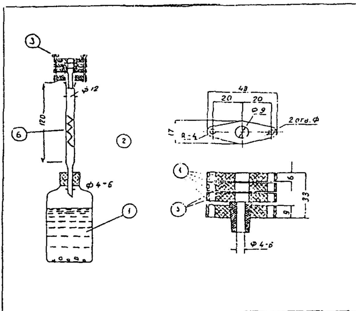
Рис. 1. Прибор для улавливания мышьяковистого водорода.
