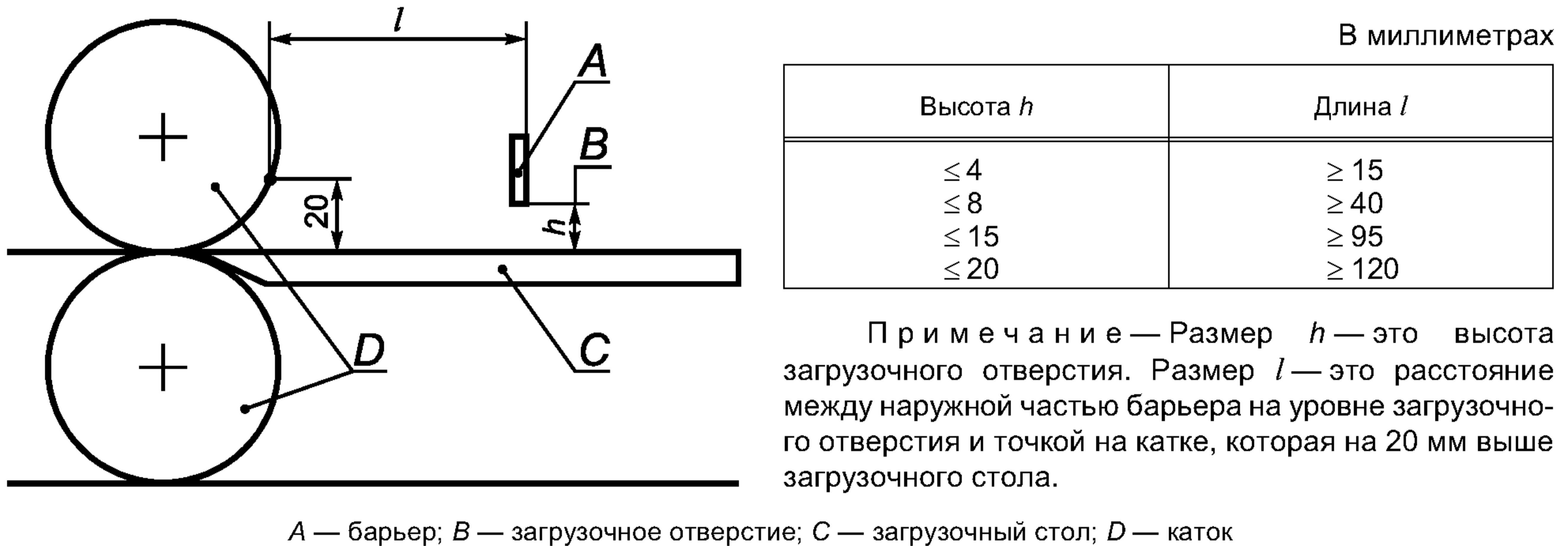
Рисунок 101 — Размеры загрузочного отверстия катковых гладильных машин
