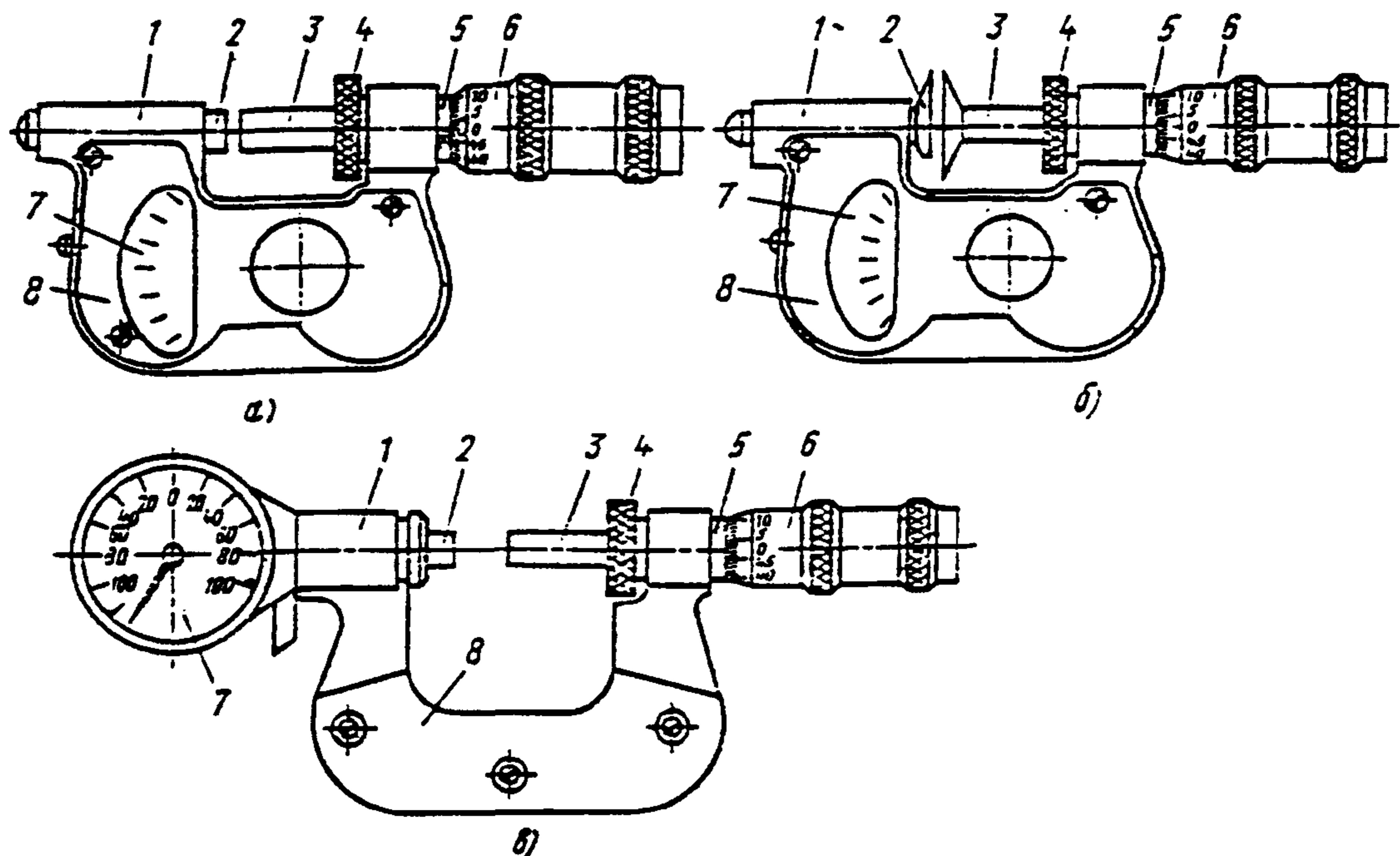
Рис. 5. Микрометры рычажные:
