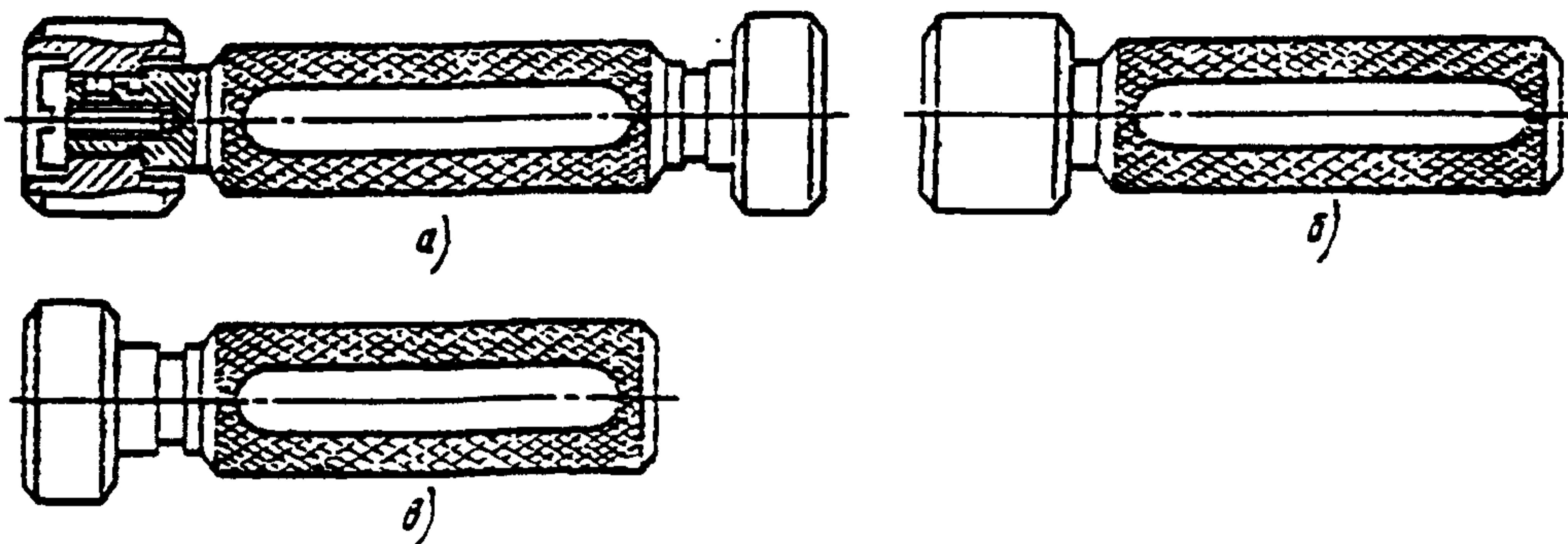
Рис. 16. Пробки с насадками:
