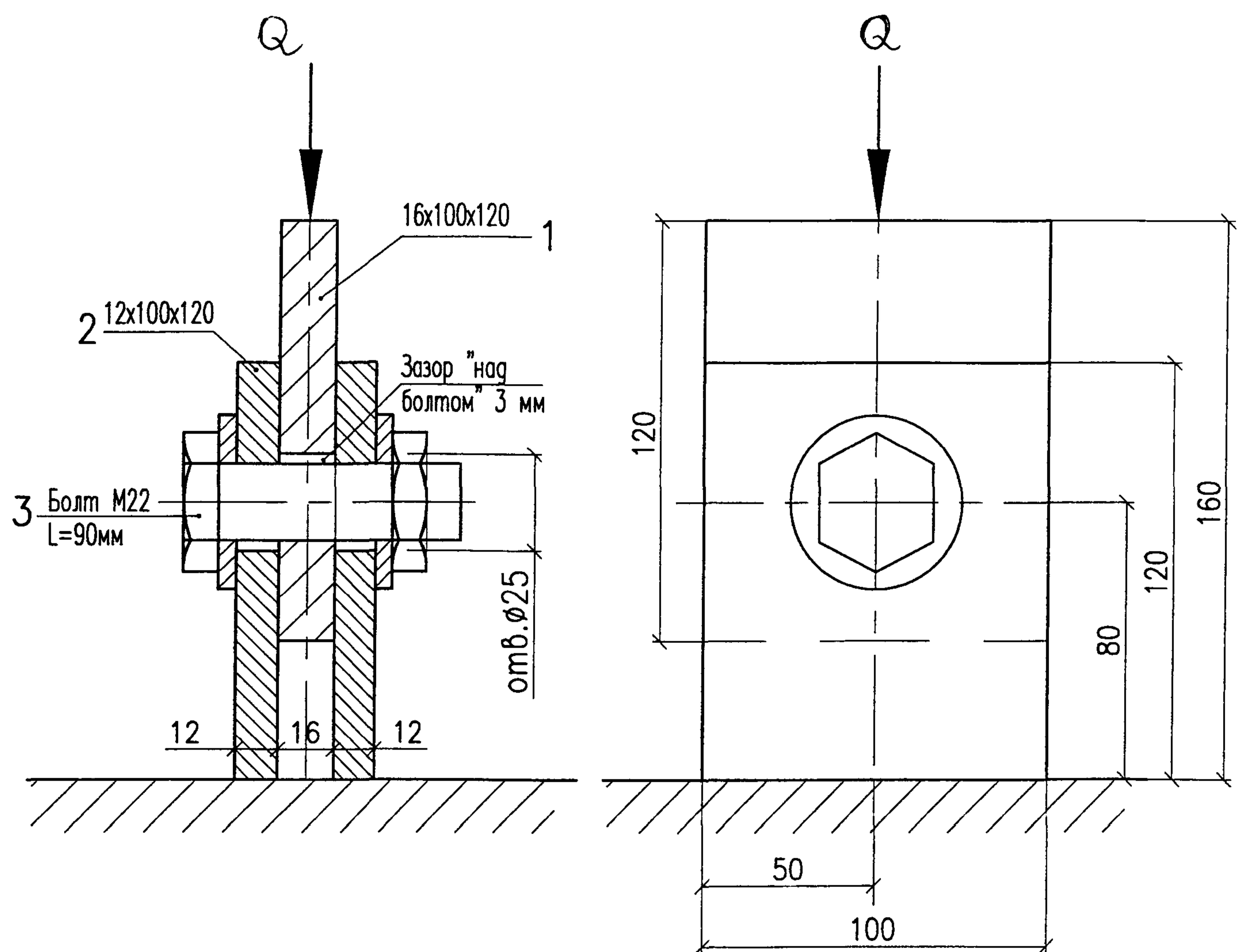
1 – основной элемент; 2 – накладка; 3 – высокопрочный болт с шайбами и гайкой
