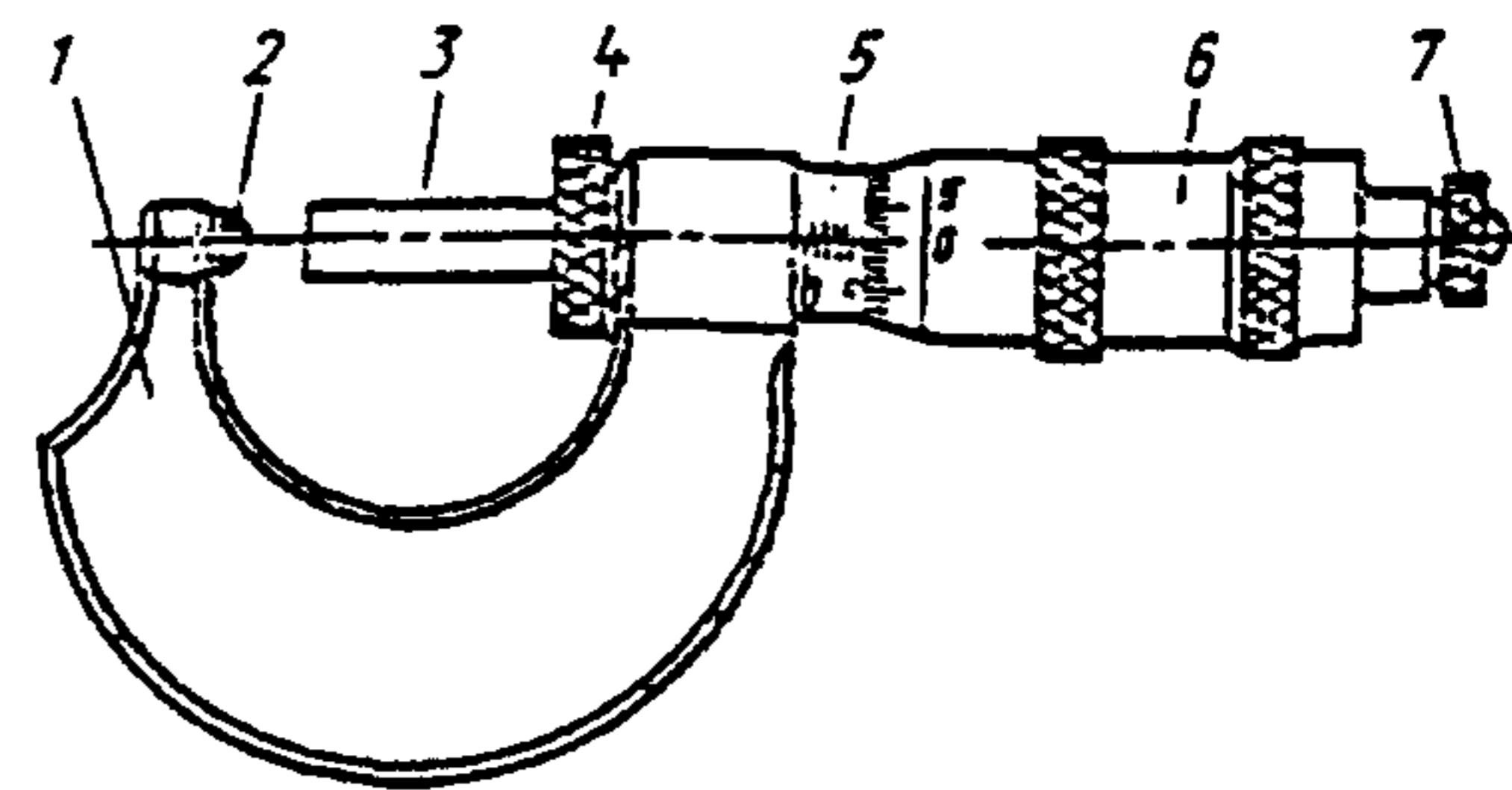
Рис. Н.8. Микрометр типа МТ:
