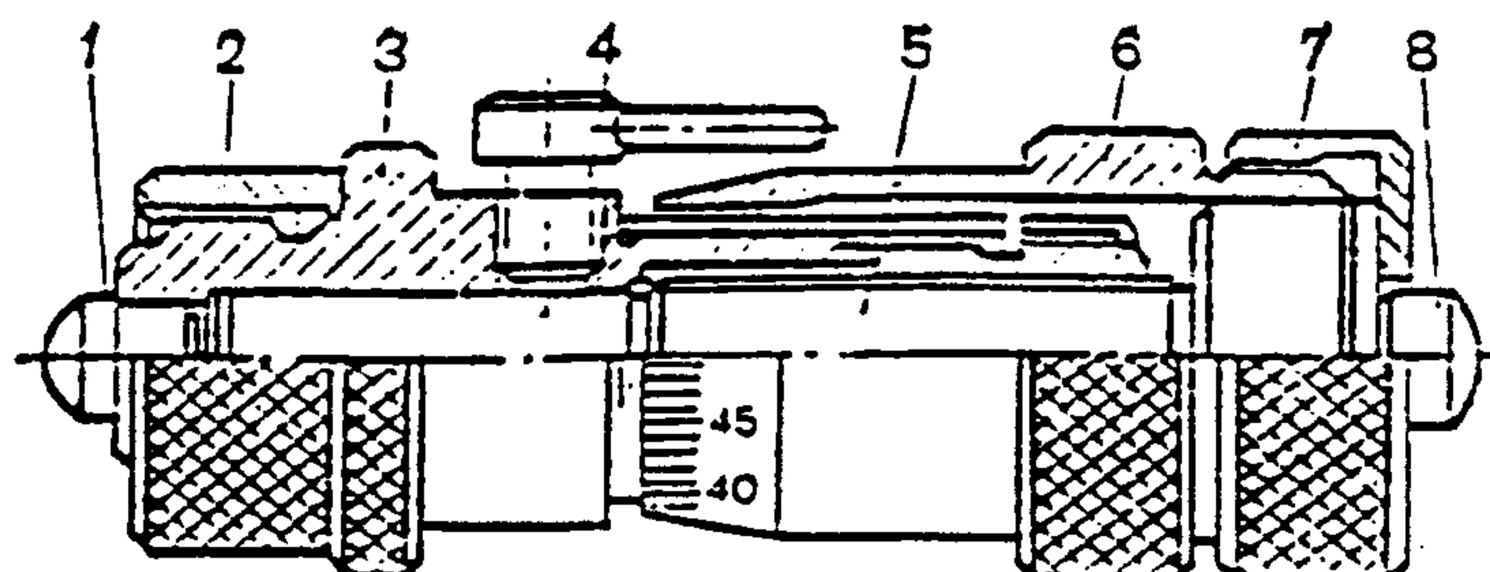
Рис. 10. Микрометрический нутромер:
