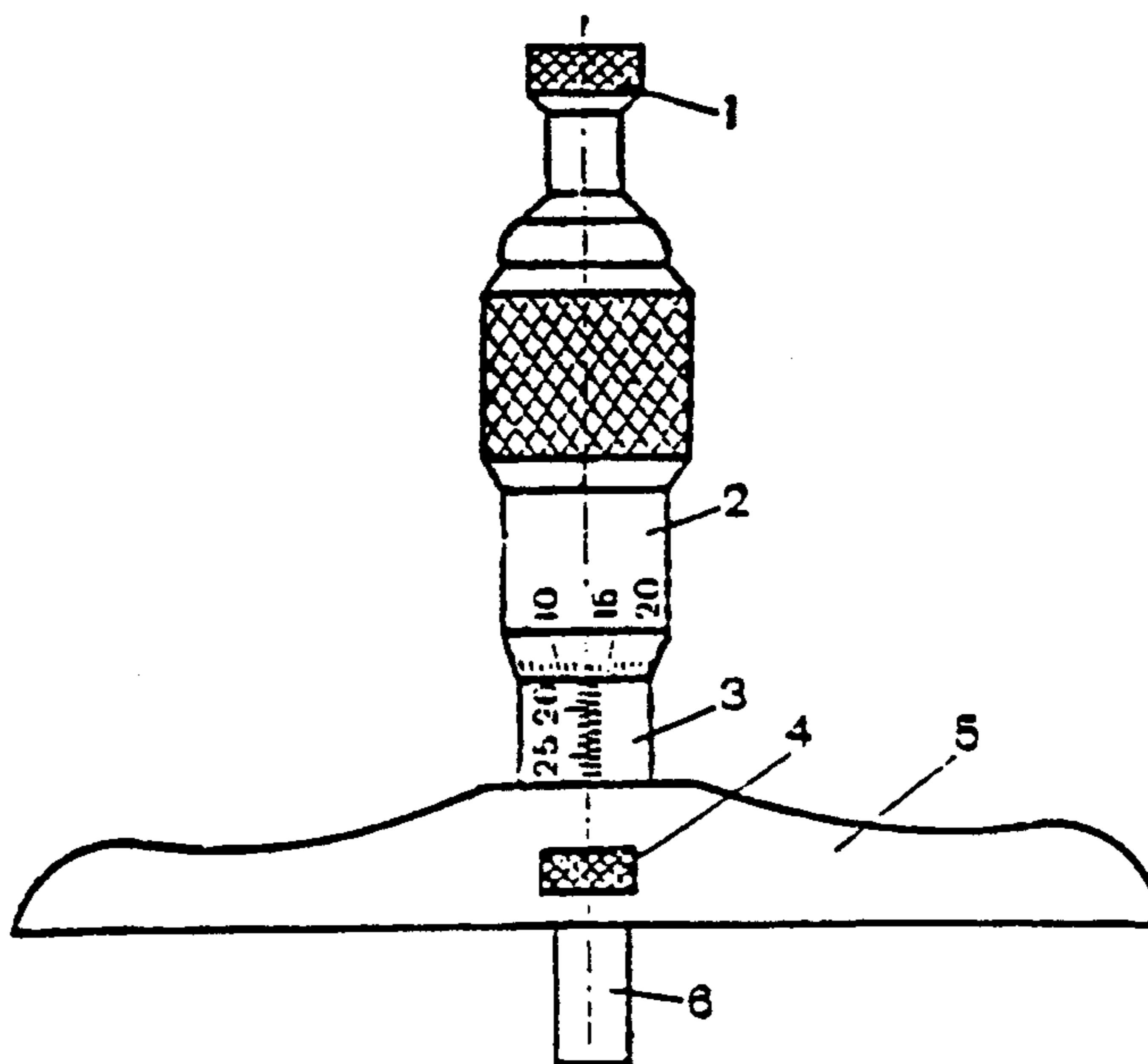
Рис. 11. Микрометрический глубиномер:
