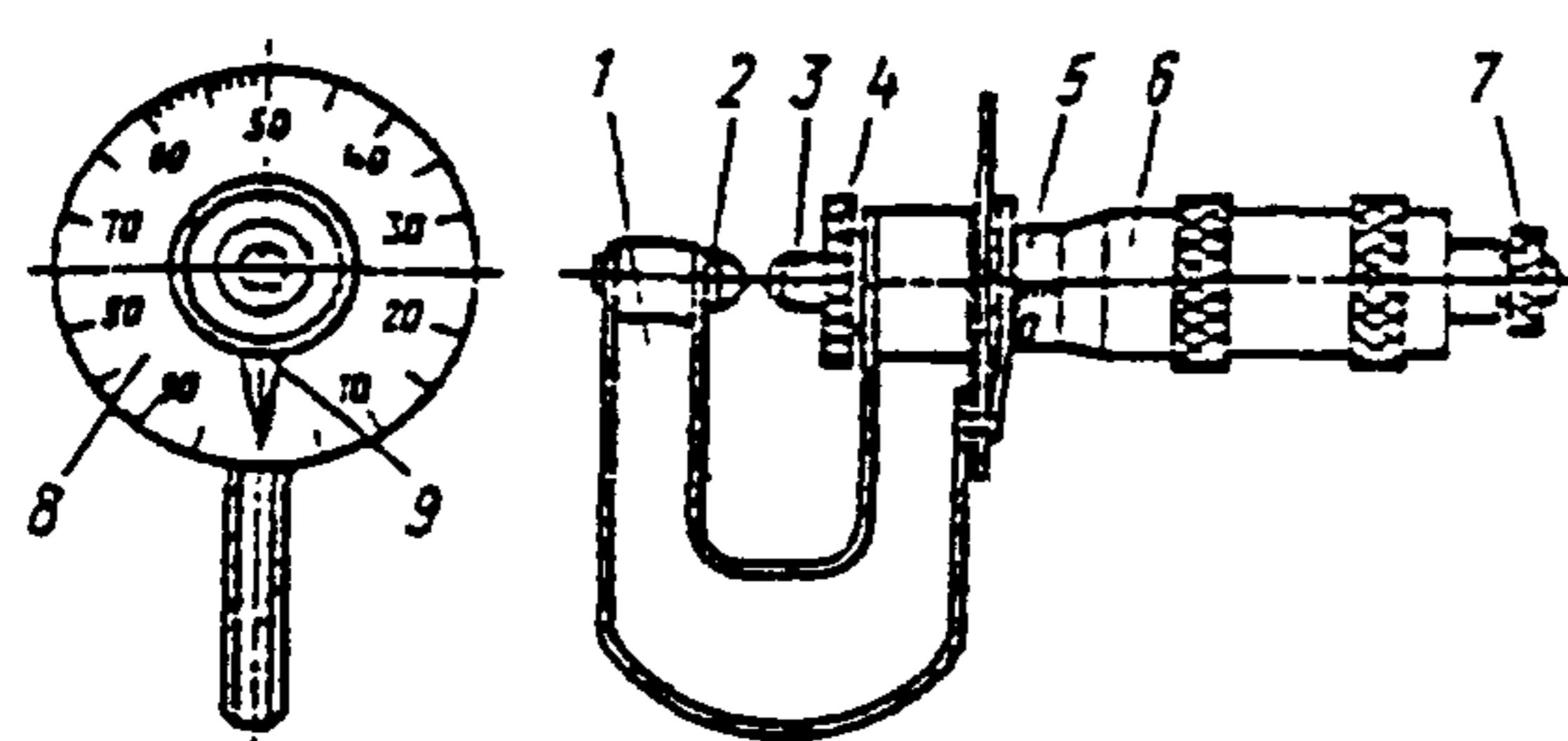
Рис. Н.7. Микрометр типа МЛ:
