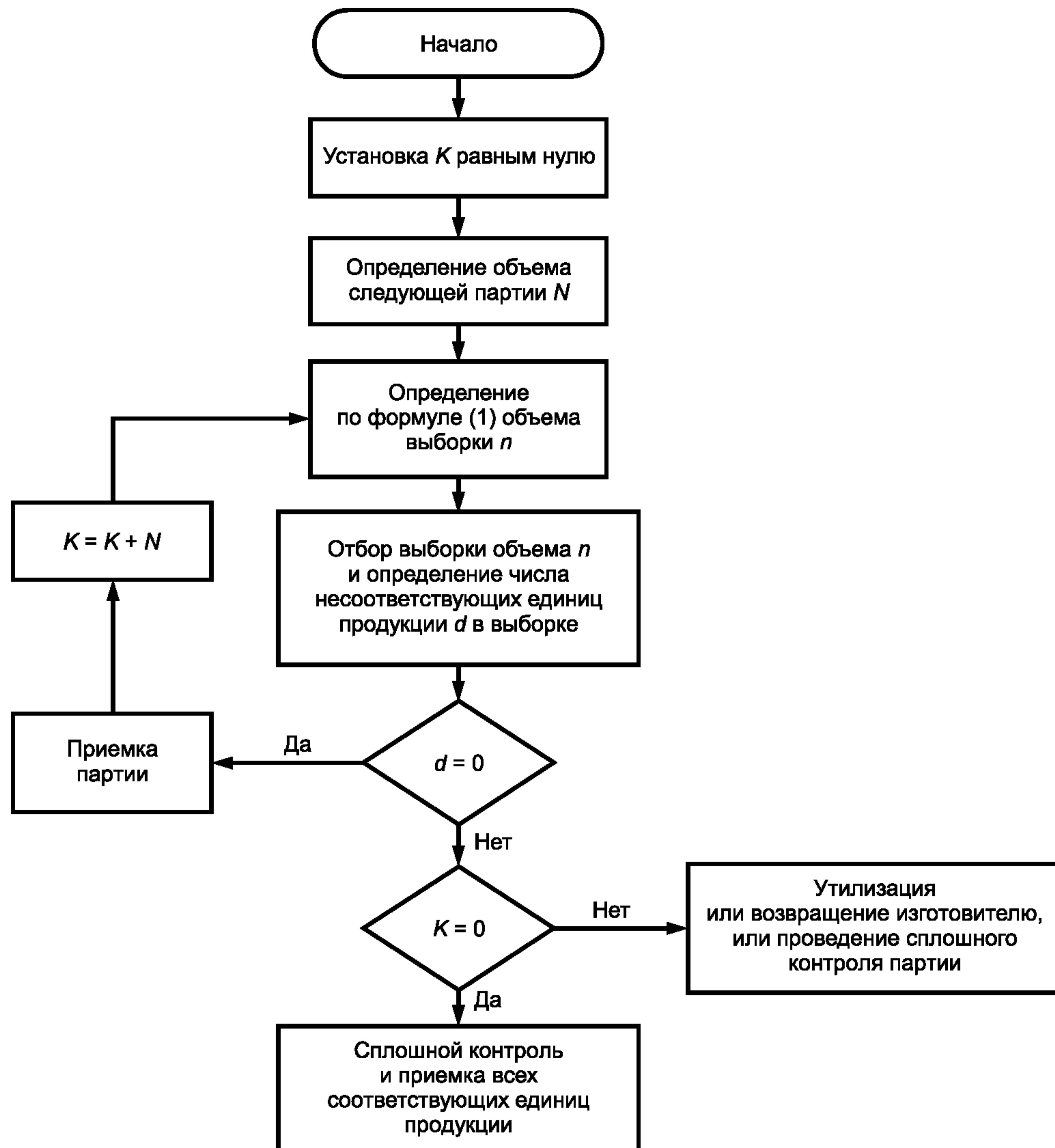
Рисунок 1 — Блок-схема стандартной процедуры приемки
