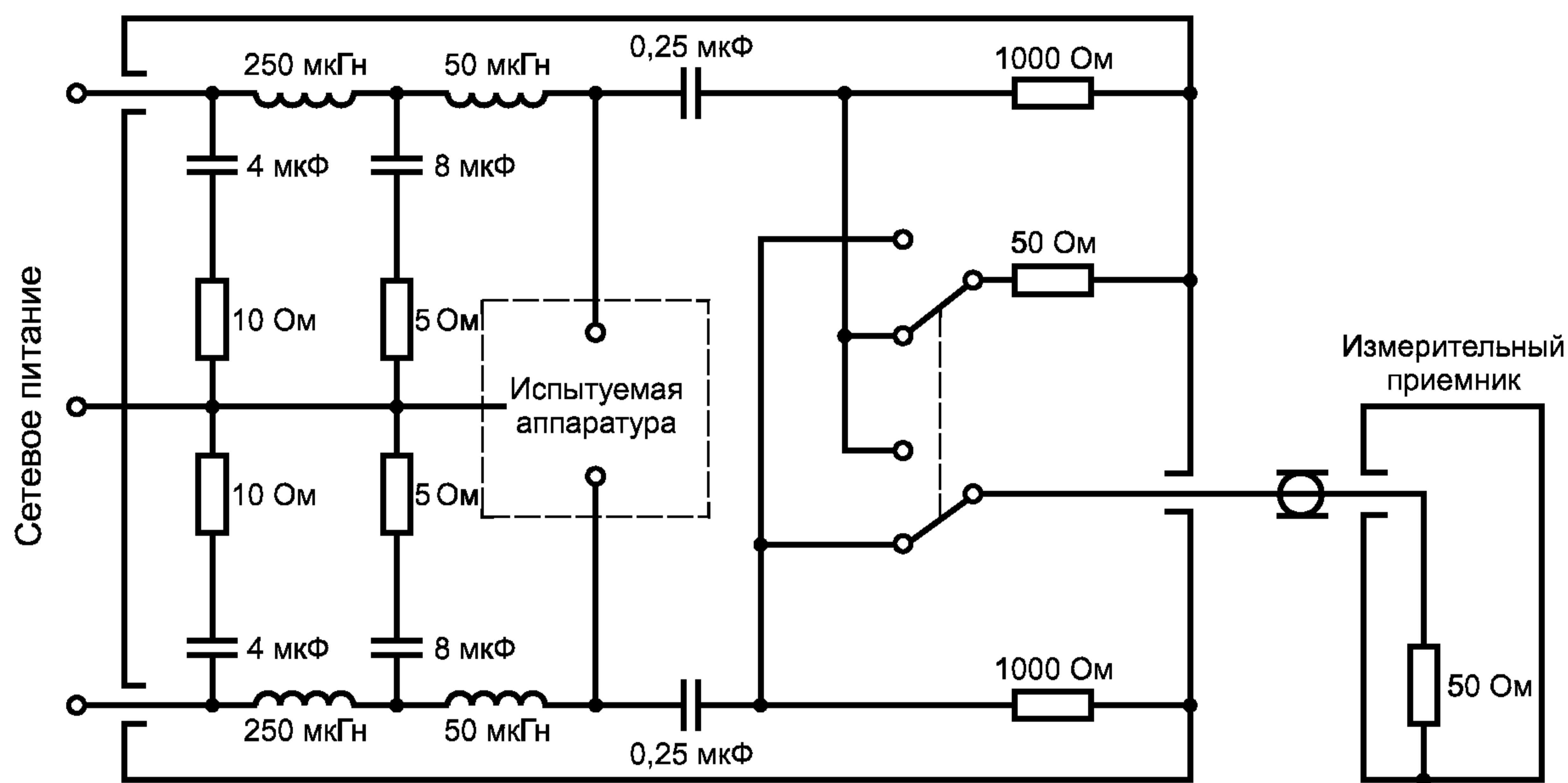
а) Пример V-образной схемы сети питания  $50 \text{ Ом}/\text{мкГн} + 5 \text{ Ом}$  при использовании диапазона частот от 10 до 150 кГц
