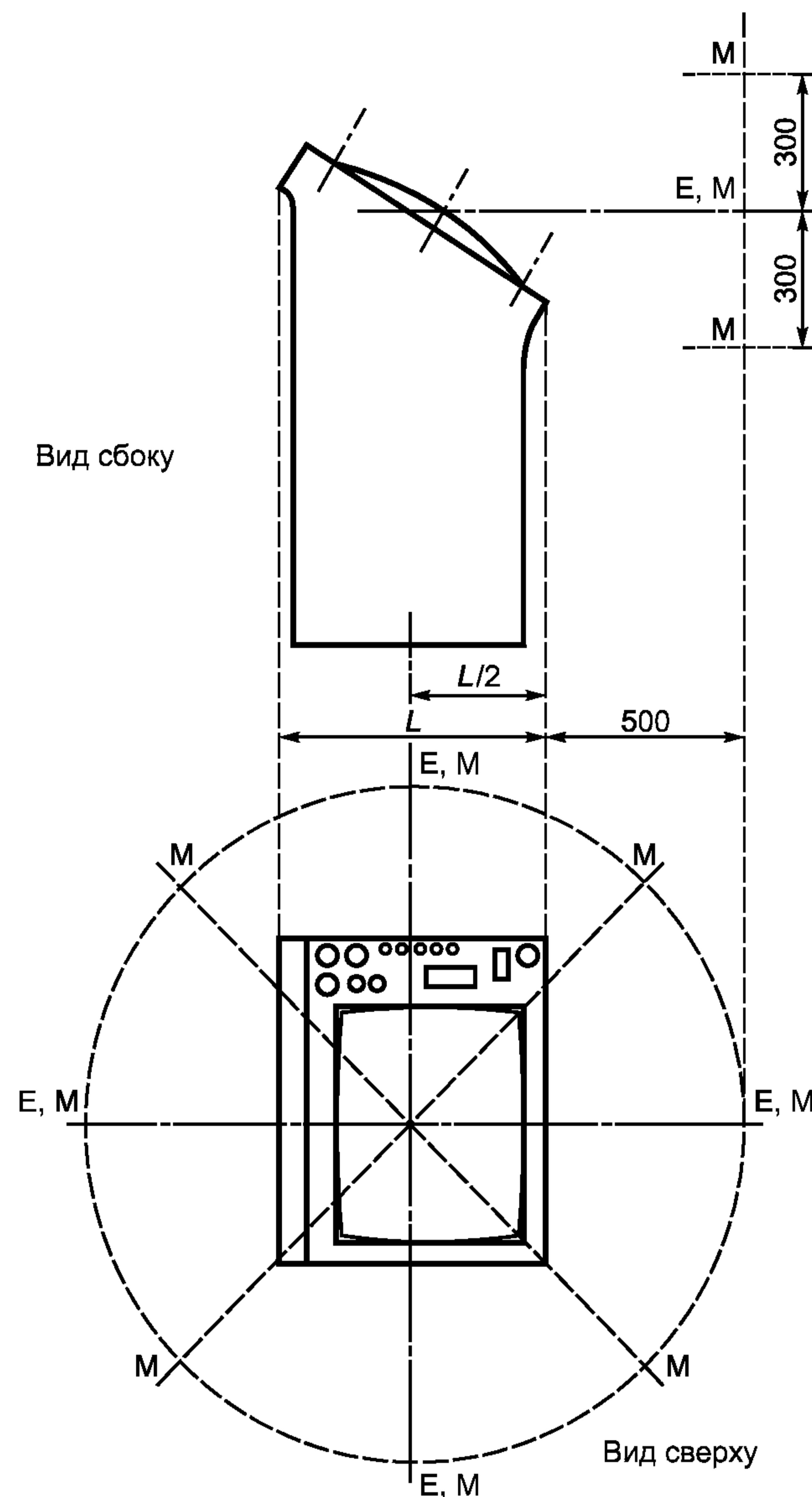
$M$  — положение для измерения магнитного поля;  $E$  — положение для измерения электрического поля
