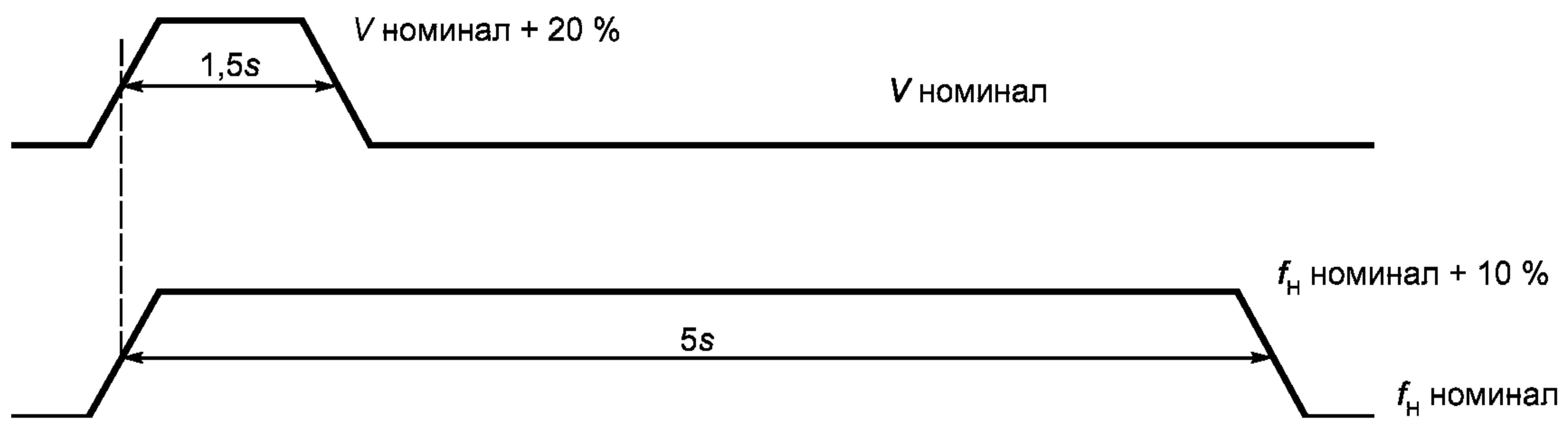
a) Тест 1: напряжение  $V + 20\%$  и частота  $f + 10\%$
