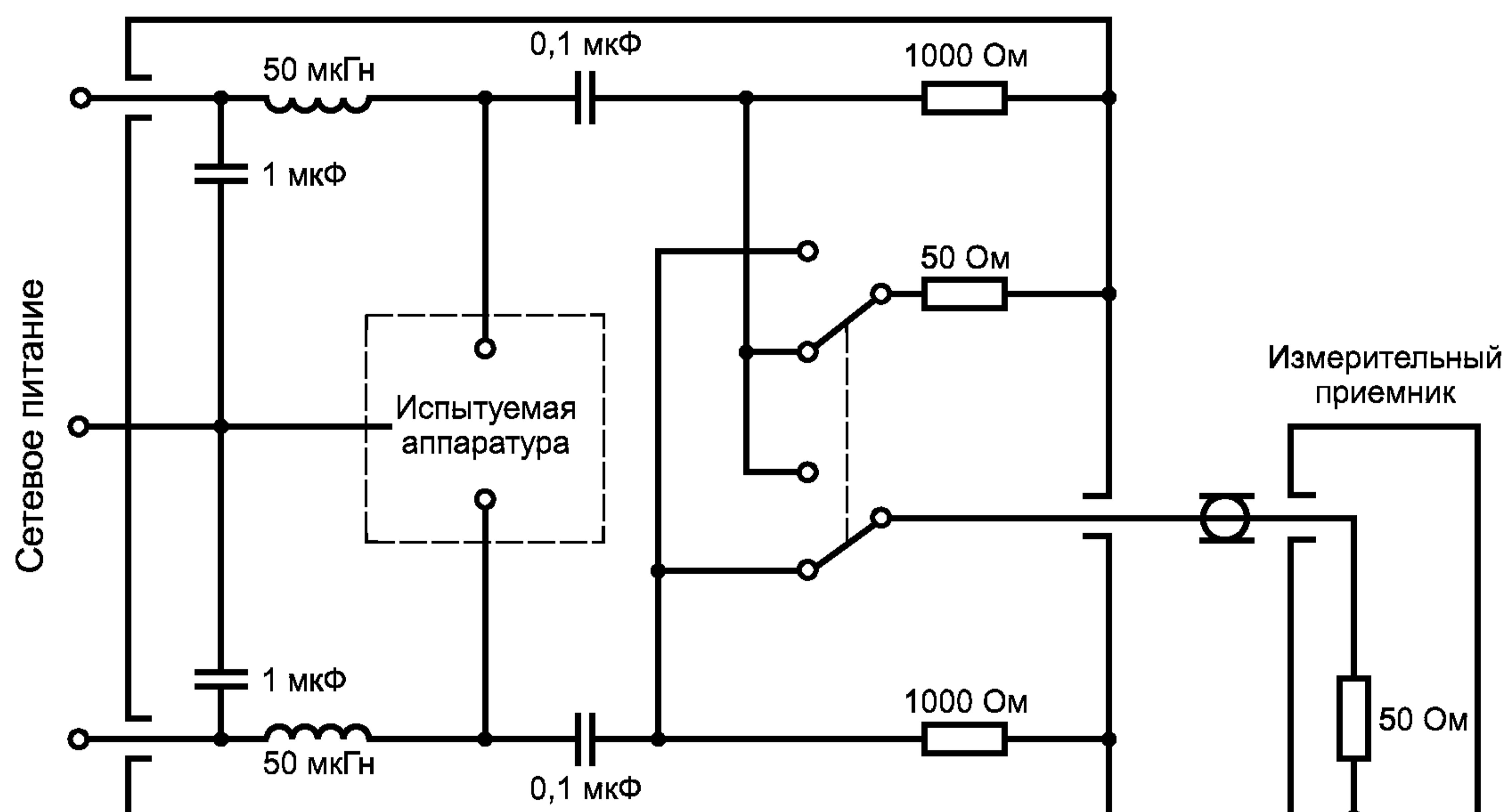
б) Пример V-образной схемы сети питания  $50 \text{ Ом}/\text{мкГн}$  при использовании диапазона частот от 150 кГц до 30 МГц
