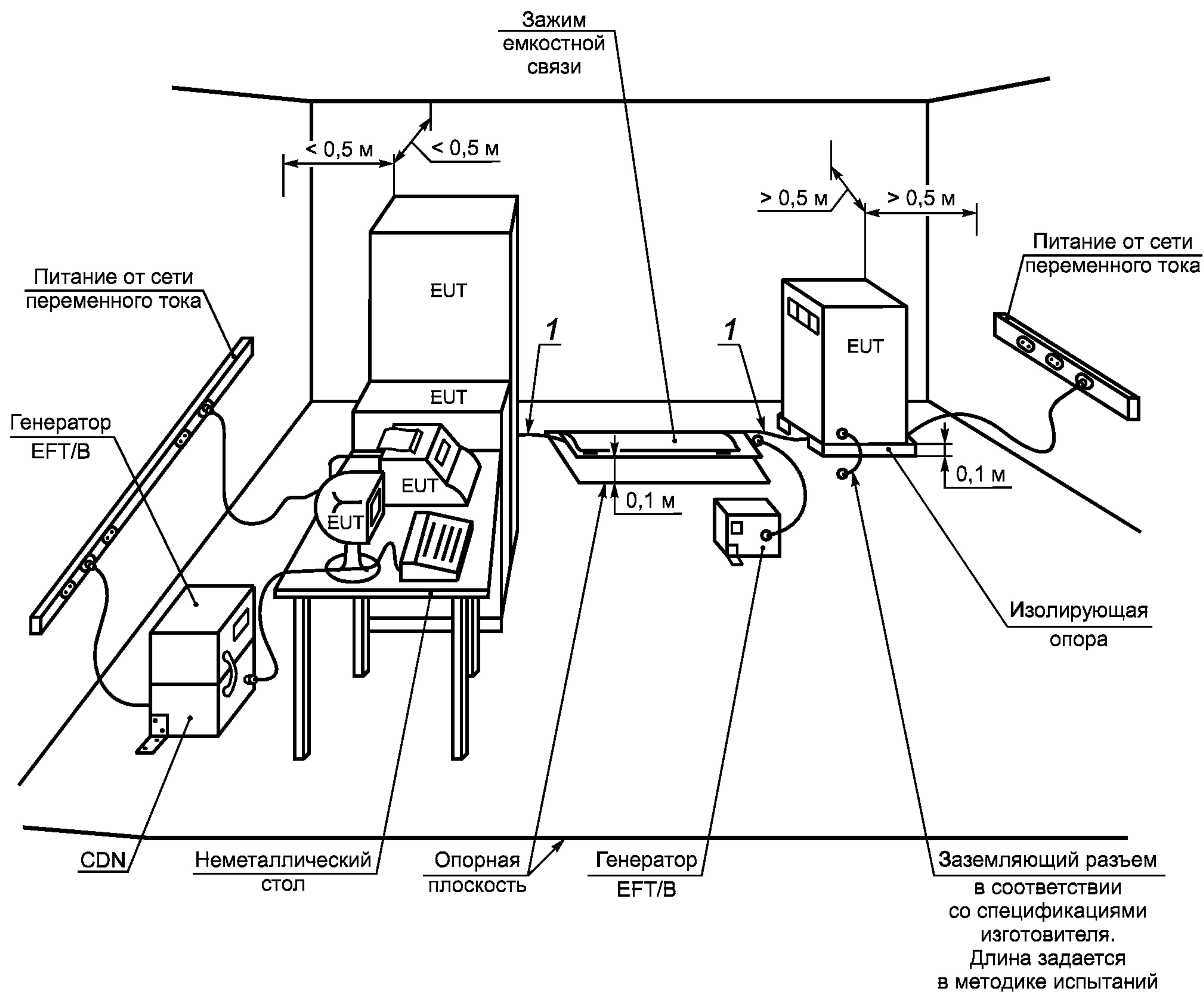
*l* — длина между зажимом и испытуемым EUT (не более 1 м)
