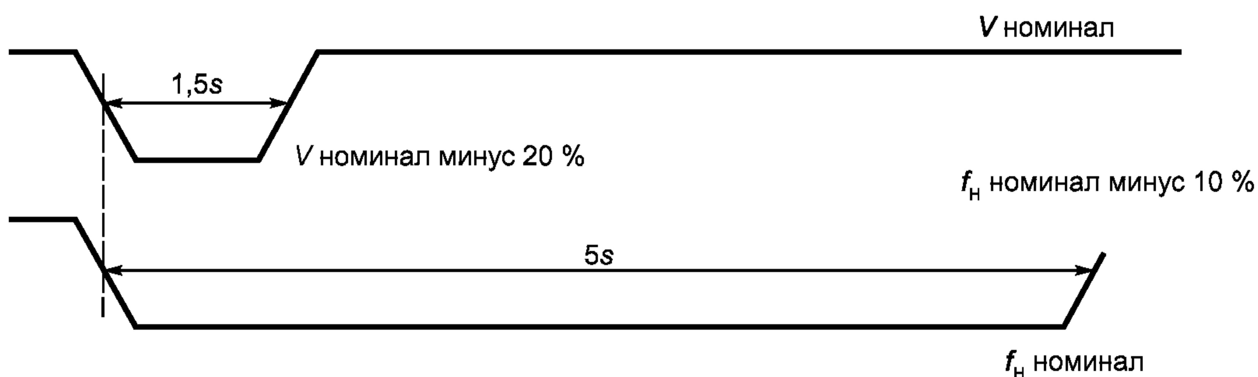
b) Тест 2: напряжение  $V$  минус  $20\%$  и частота  $f$  минус  $10\%$
