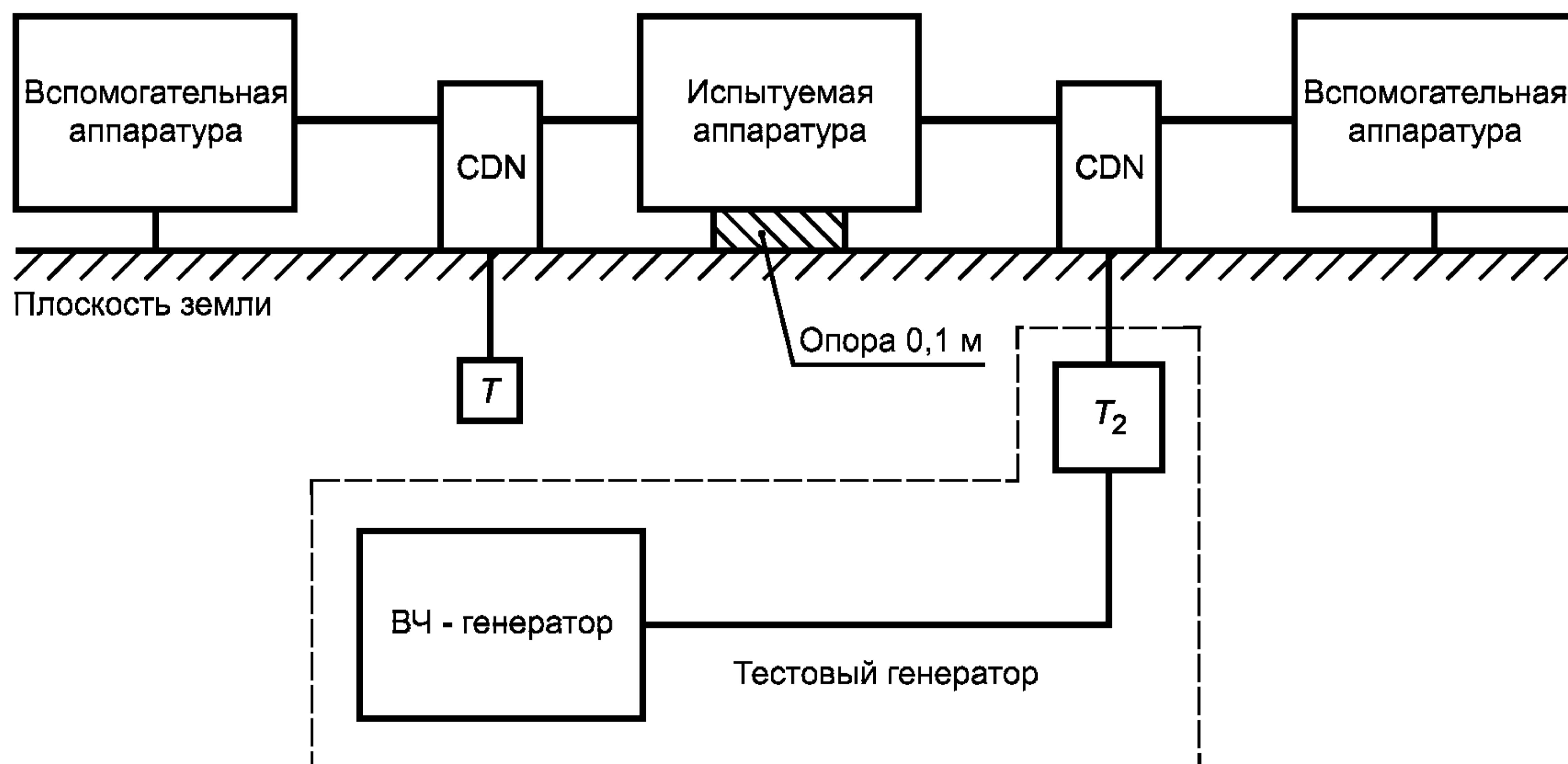
$T$  — нагрузка 50 Ом;  $T_2$  — аттенюатор мощности (6 дБ); CDN — цепь «связь — развязки»
