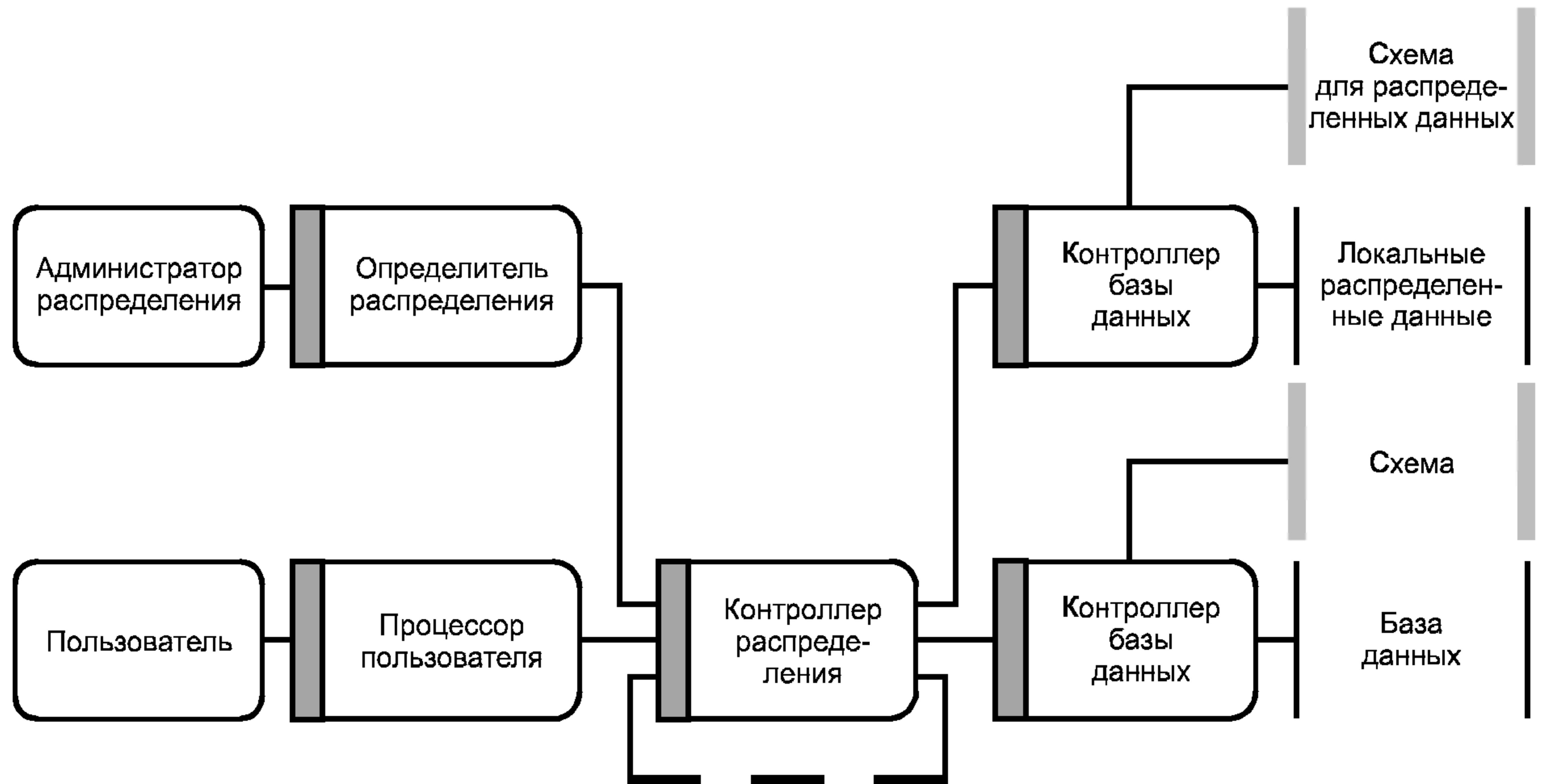
Рисунок 11 — Управление распределенными данными
