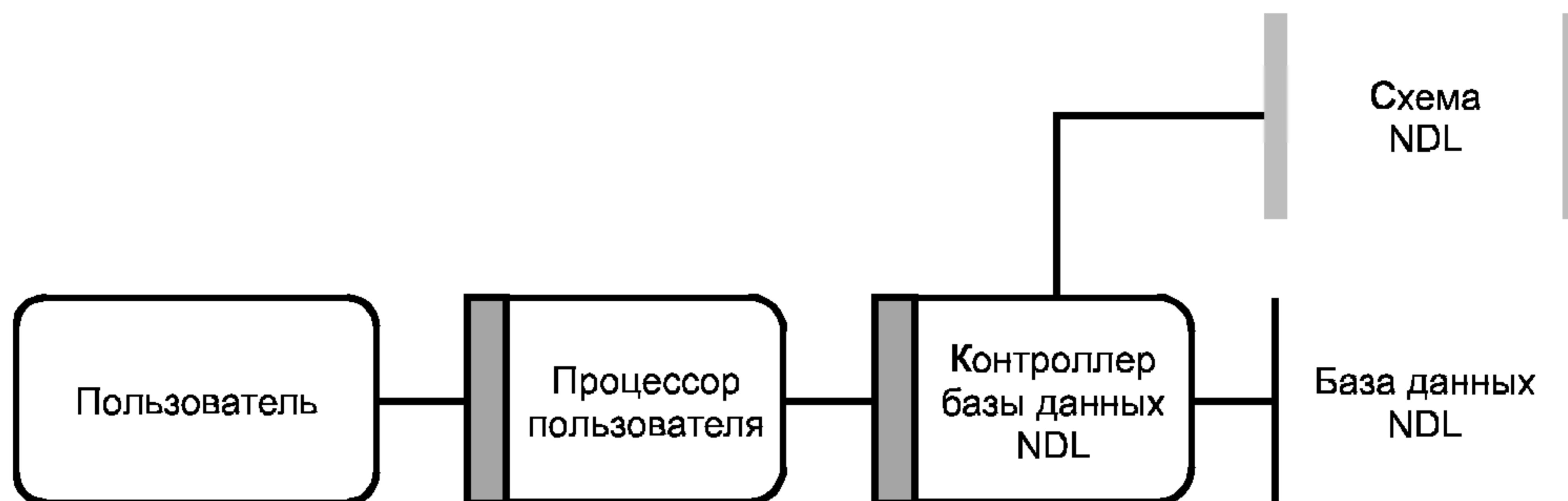
Рисунок В.3 — Размещение контроллера базы данных NDL
