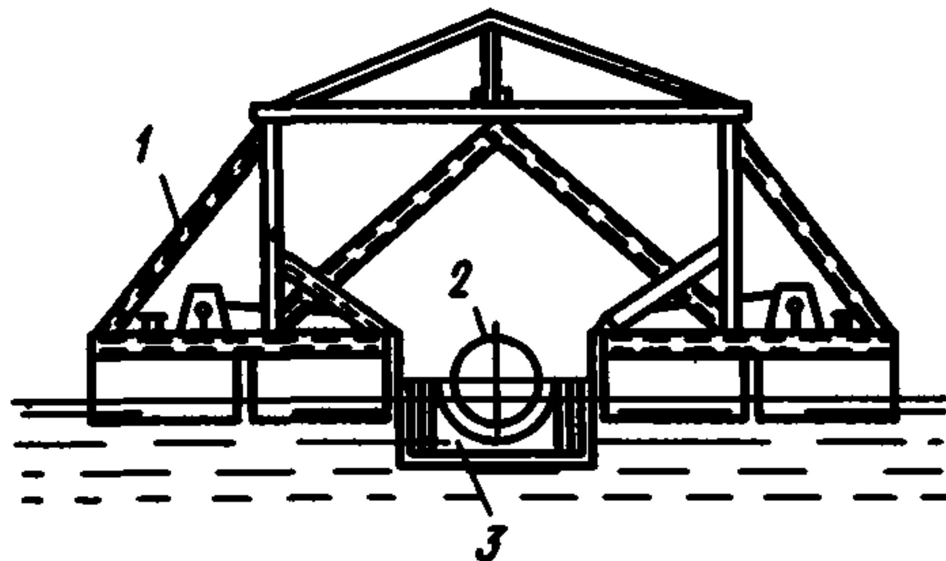
Рис. 1. Схема установки плавучей камеры для сварки межсекционного стыка: 1 — плавучая портальная опора; 2 — трубопровод; 3 — плавучая камера
