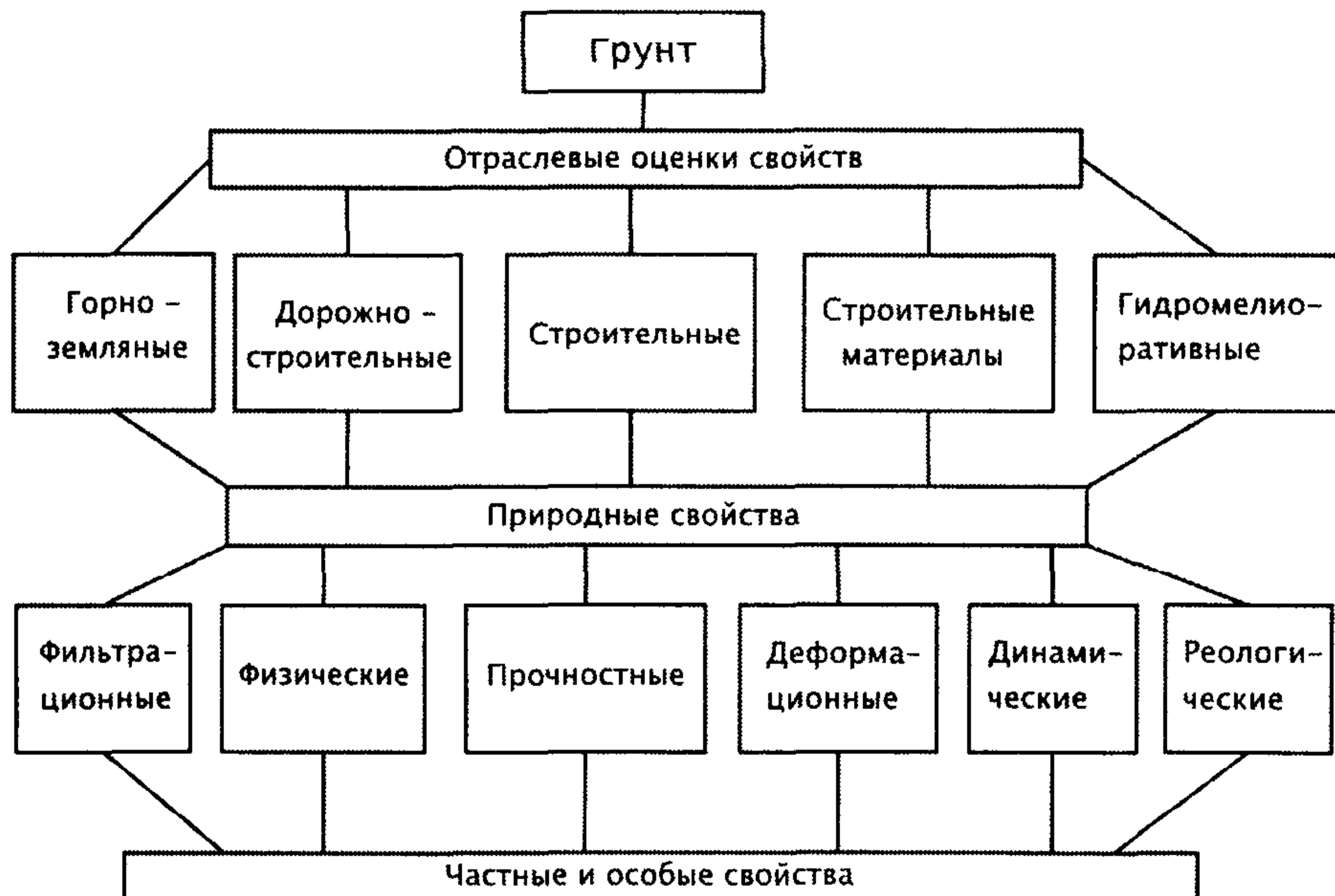
Рис. 6 Схема свойств грунтов
