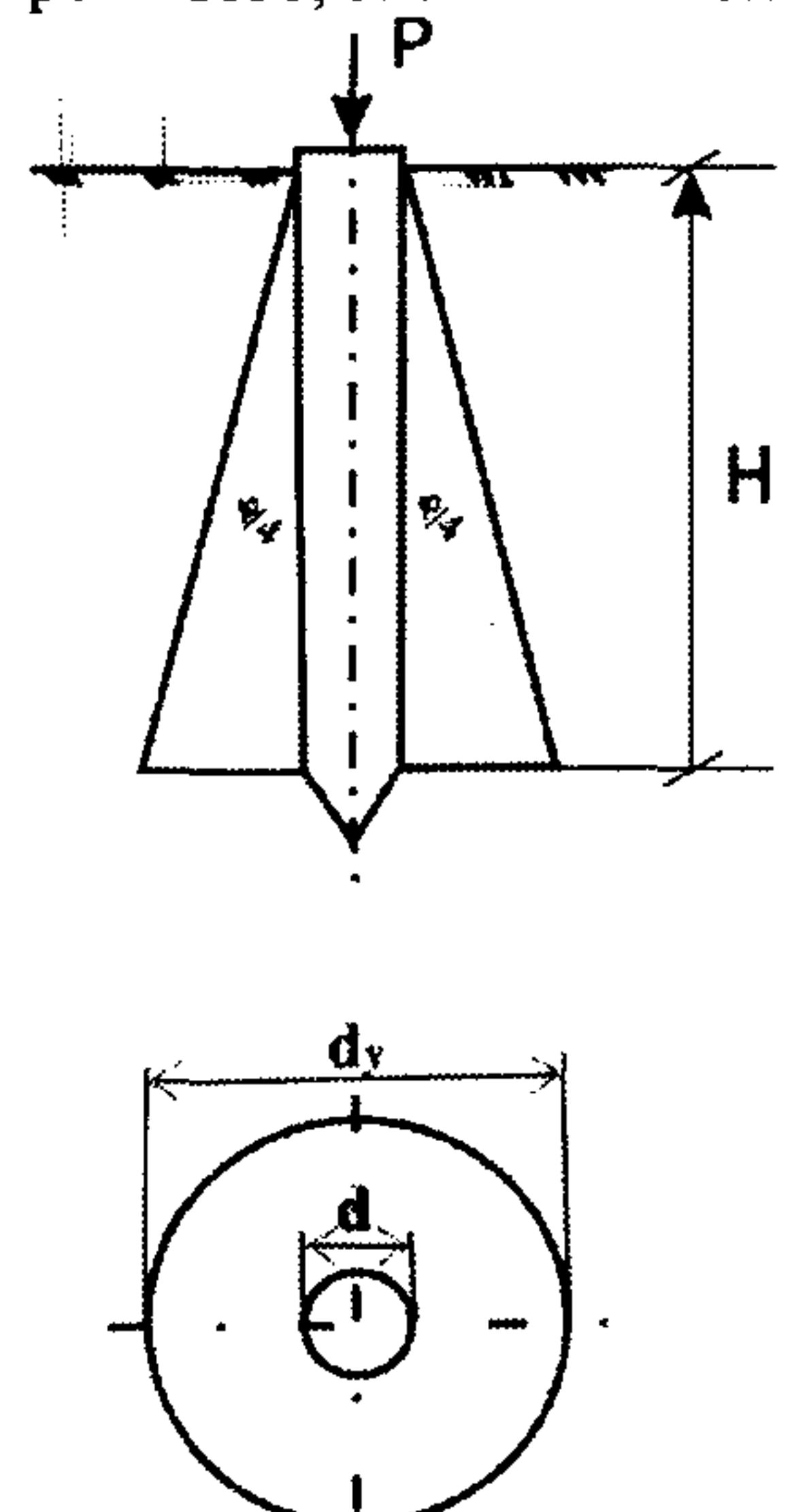
Рис. 19. Схема определения площади условного фундамента под сваей.
