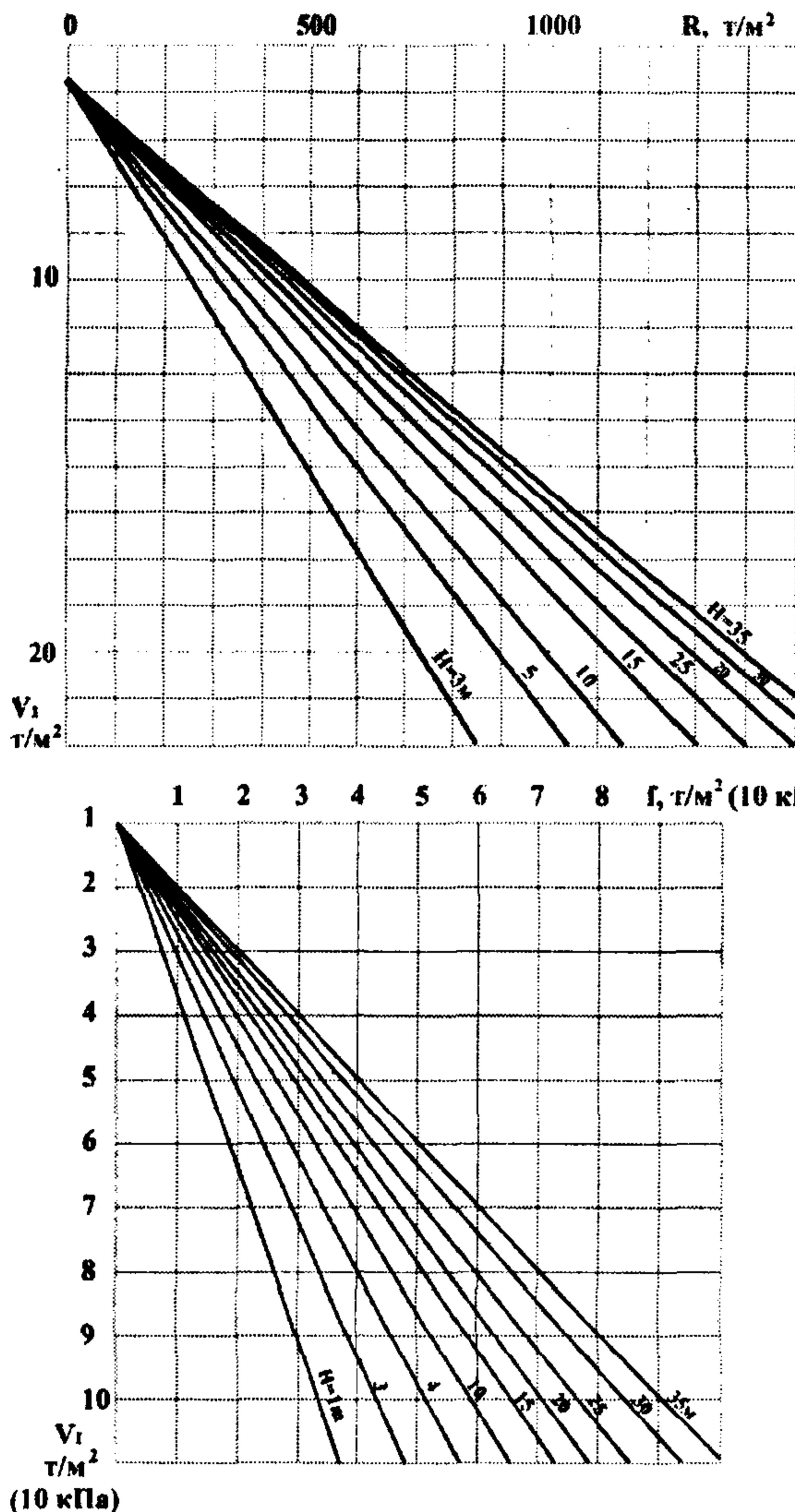
Рис. 16. График аппроксимаций для определения сопротивления острия сваи  $R$  по раздвигу  $V_i$  для глинистых грунтов ( $H$  - глубина сваи, м).
