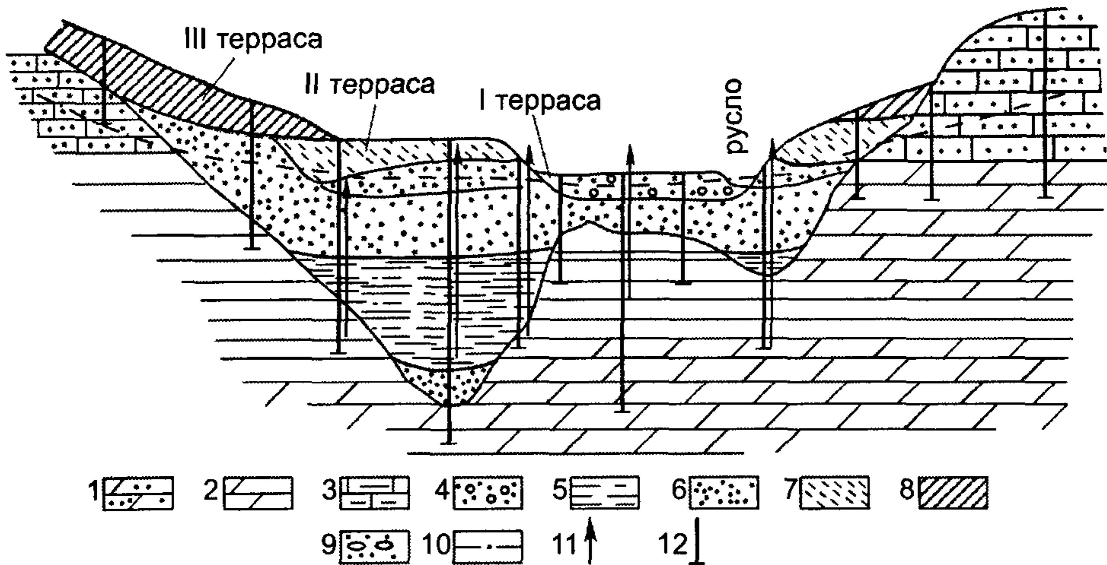
*Палеозойские породы (верхняя пермь)* 1 – песчаники, 2 – мергели, 3 – известняки, третичные отложения 4 – галечники, 5 – глины, четвертичные осадки 6 – пески, 7 – супеси, 8 – суглинки, 9 – галечники, 10 – уровень грунтовых вод, 11 – напорные подземные воды, 12 – буровые скважины
