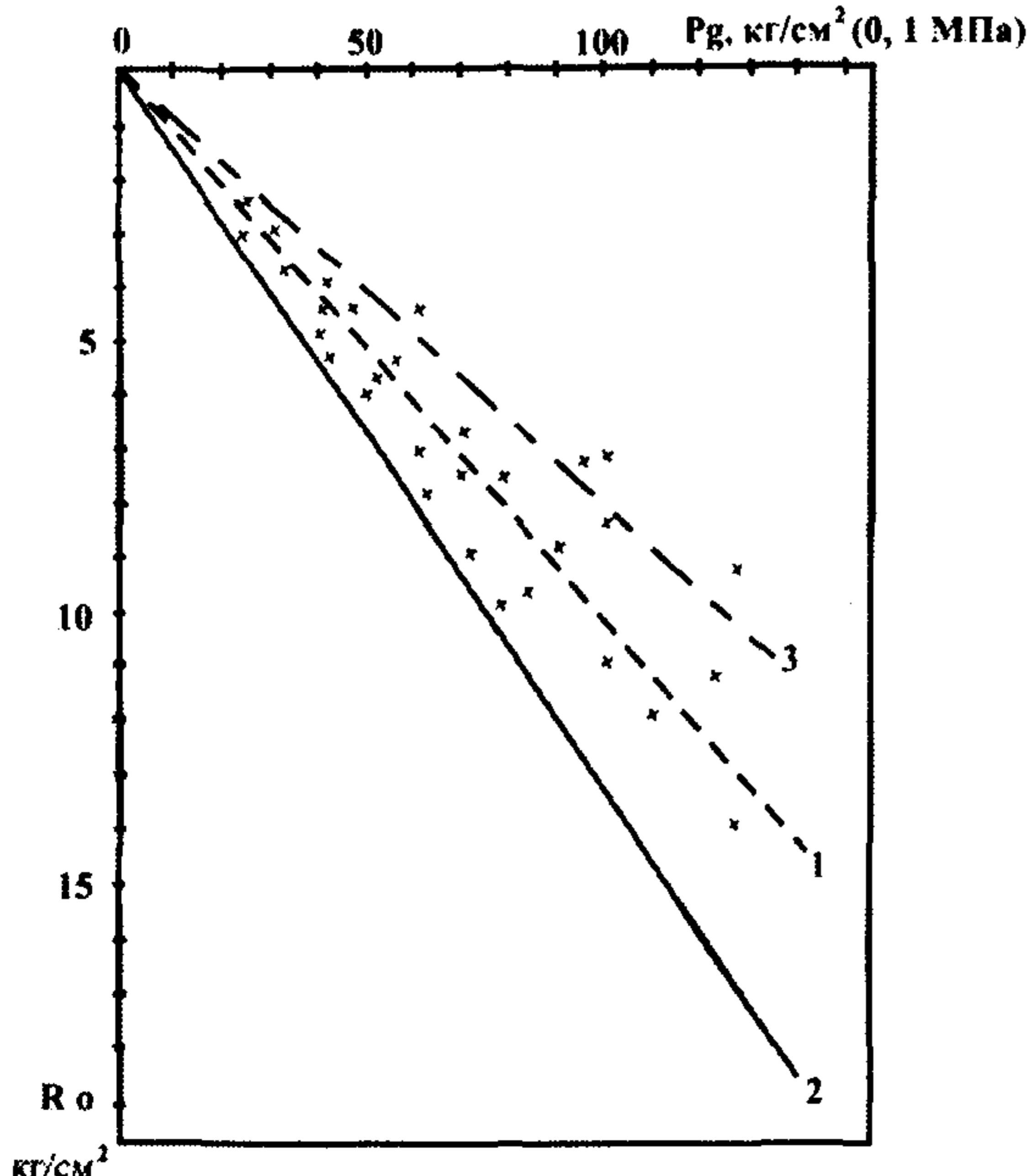
*Рис. 22. Графики зависимости распора  $P_q$  от оценочного сопротивления  $R_o$  на условный фундамент:*
