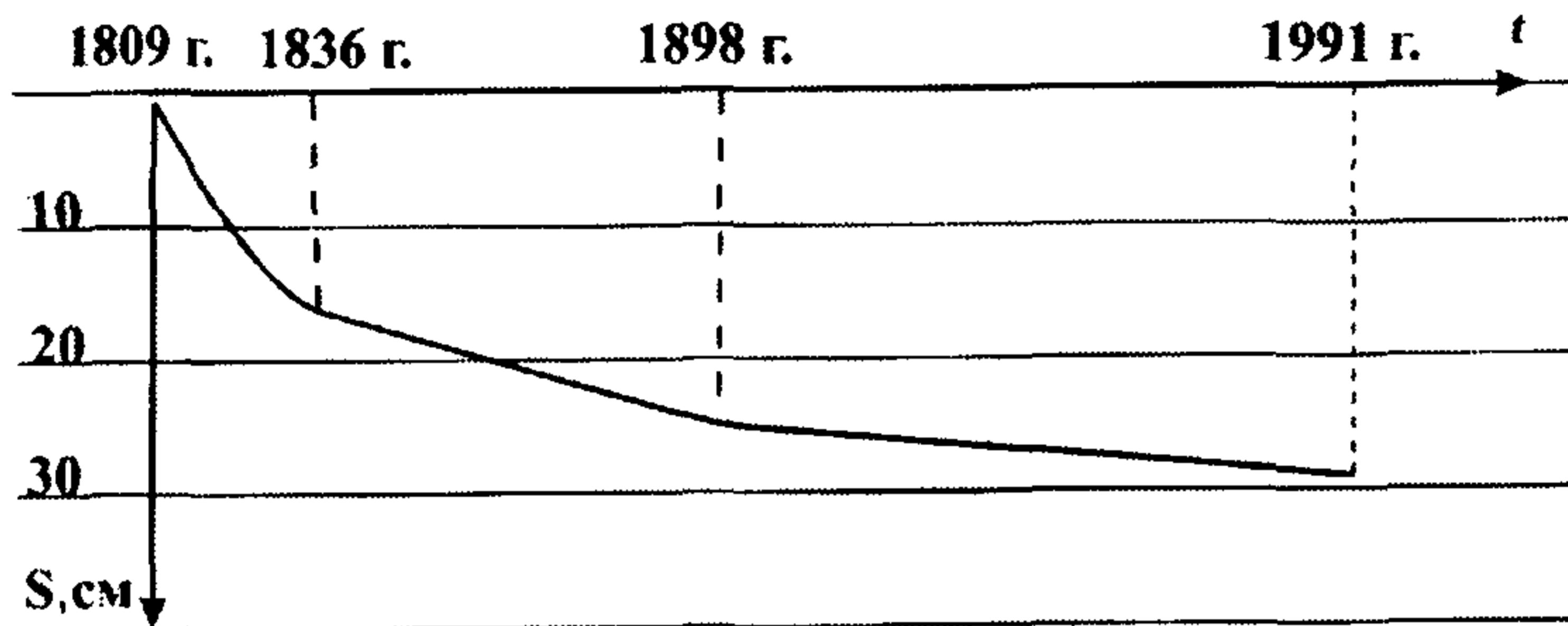
Рис. 33. График осадки фундамента под башней главного корпуса Ижевского завода.
