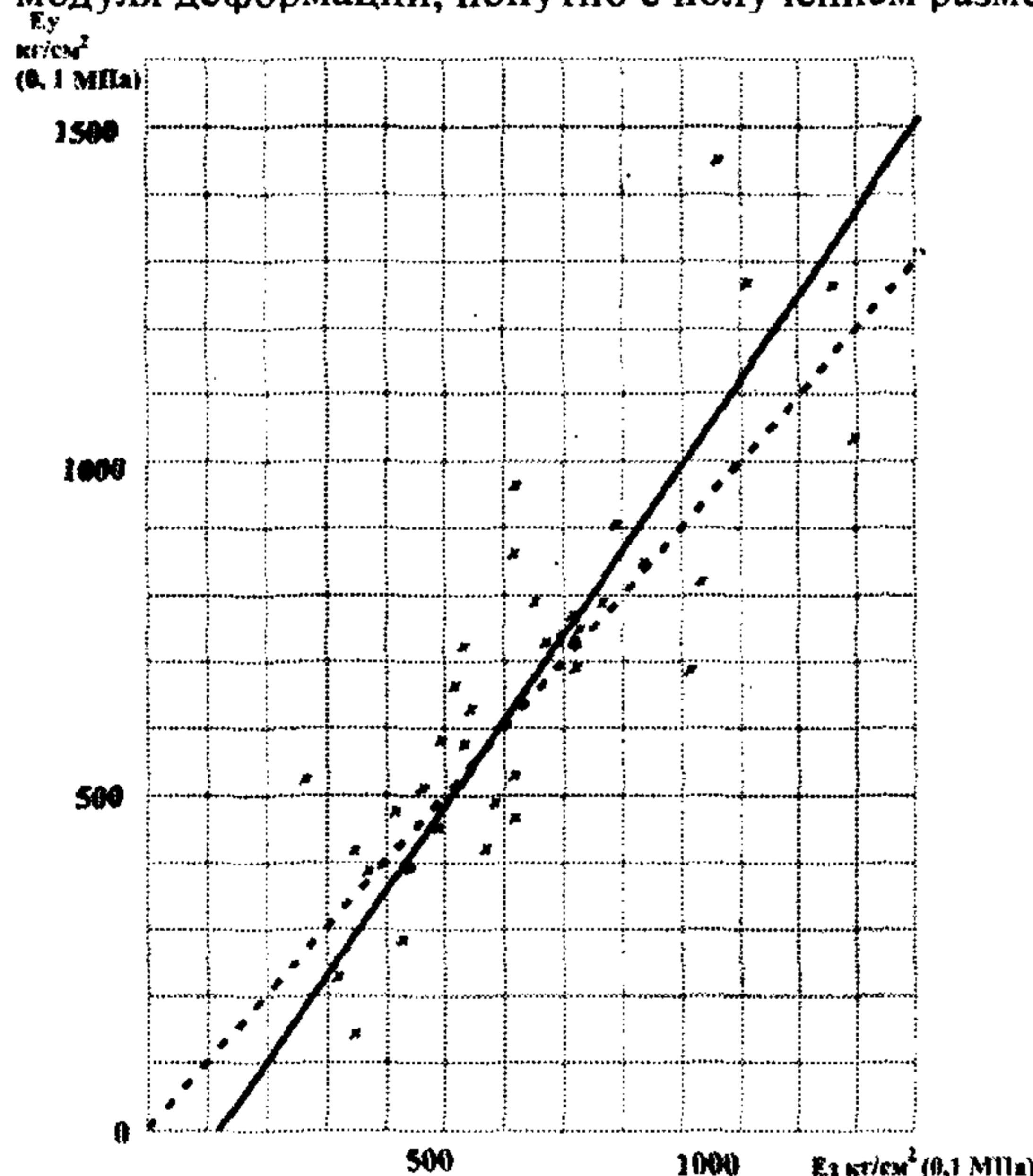
Рис. 20. Графическое сопоставление модулей деформации верхнепермских глин, определенных по результатам статических испытаний свай  $E_y$  по (43) и сопротивлению погружению конуса  $E_3$  по (19): сплошная линия – аппроксимирующее значение; пунктир – среднее значение.
