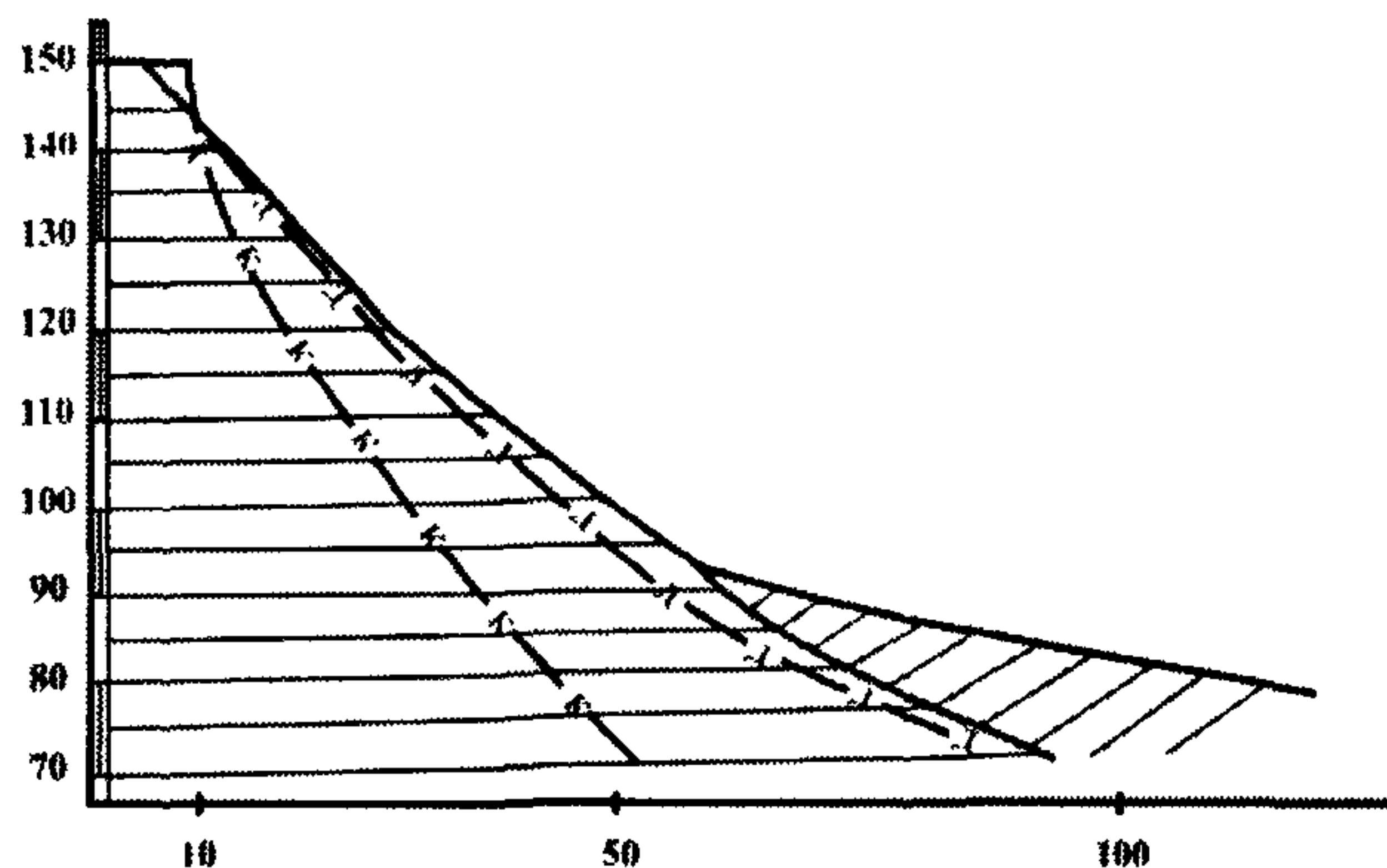
Рис. 41. Разрез по оползневому склону р. Кама.
