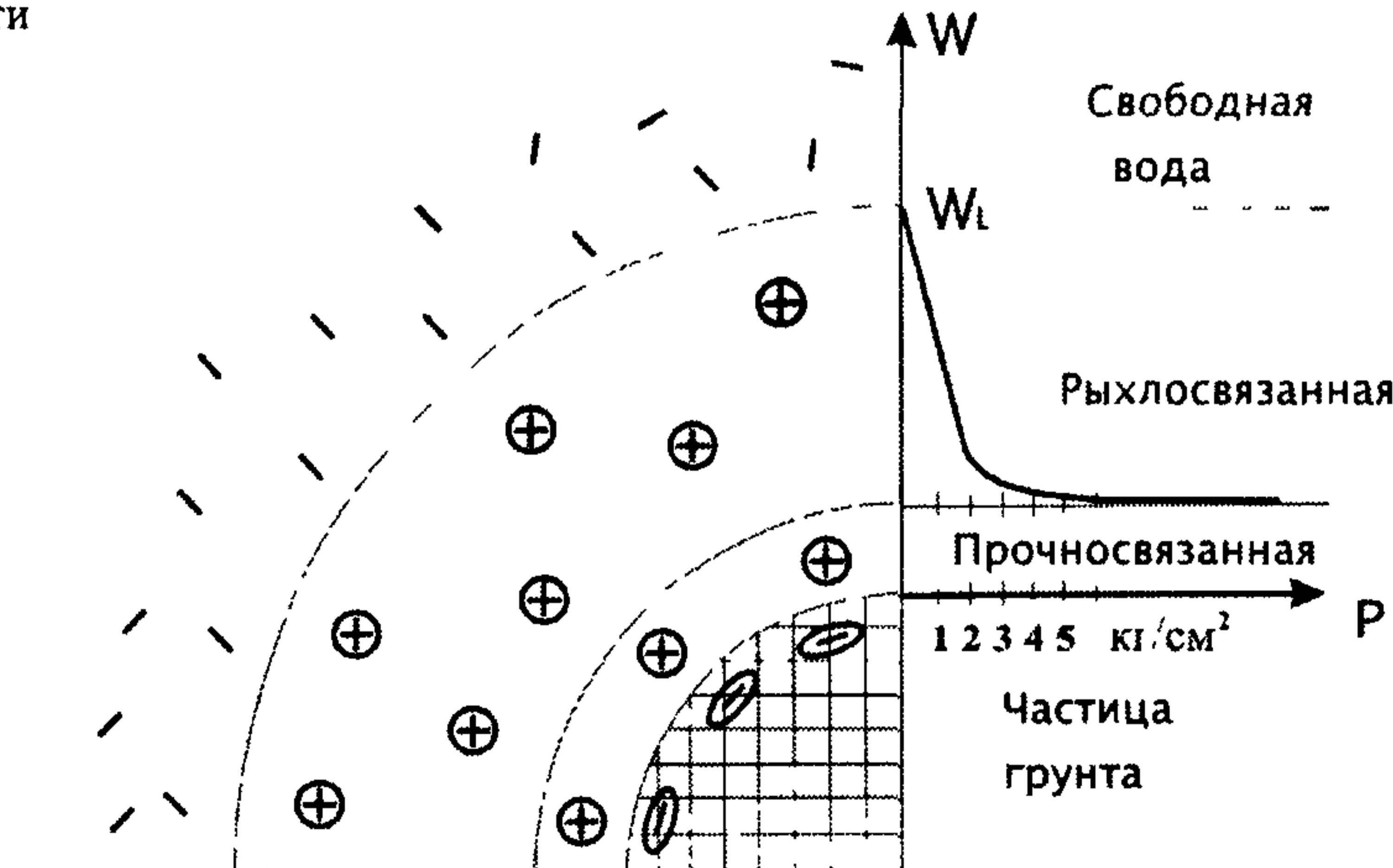
Рис. 7 Схема молекулярного взаимодействия в системе "минеральная частица–вода"
