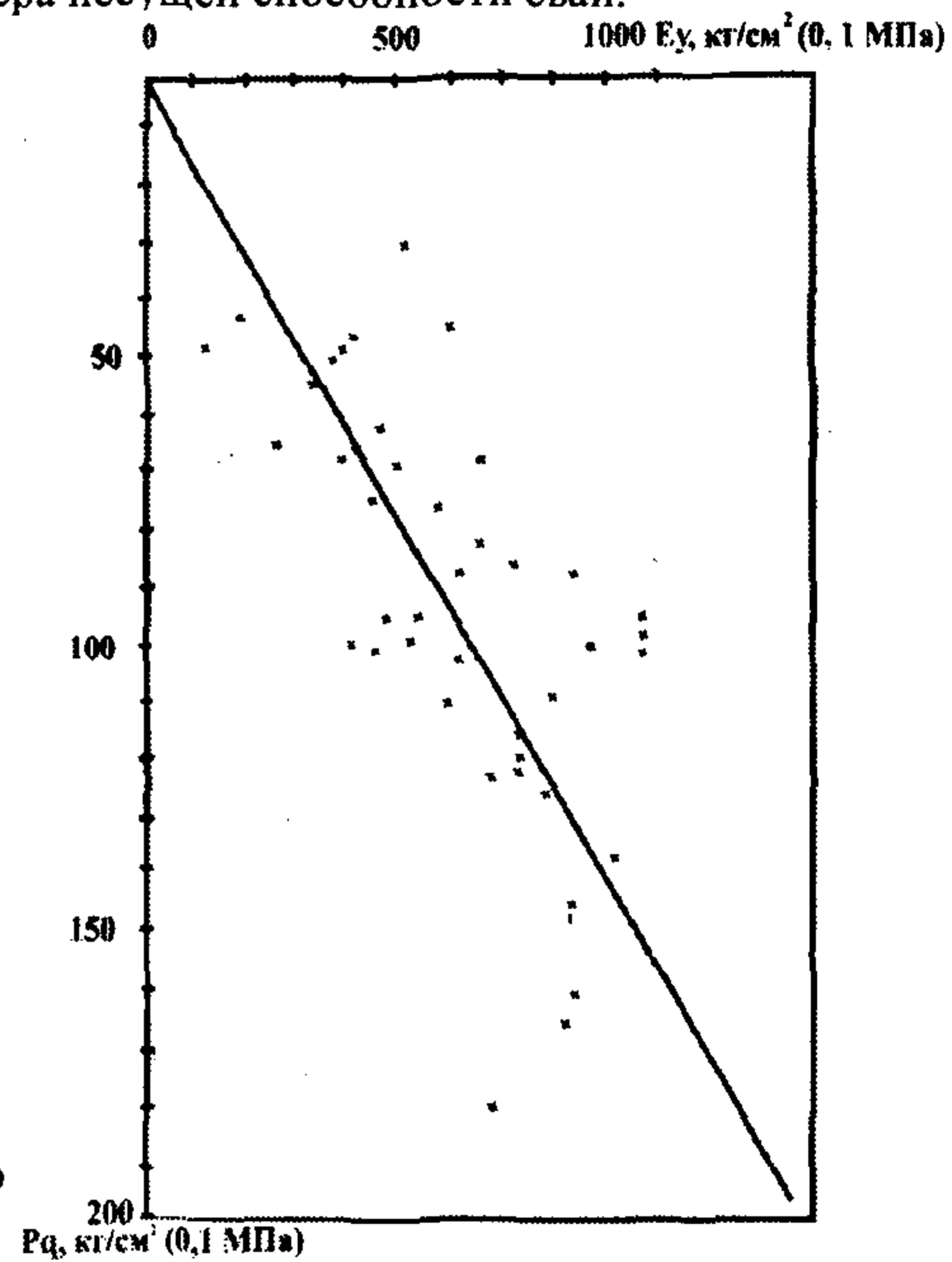
Рис. 21. Графическое сопоставление модулей деформации по статическим испытаниям свай  $E_y$  с сопротивлением погружению  $Rq$ . Сплошная линия – аппроксимирующее значение.
