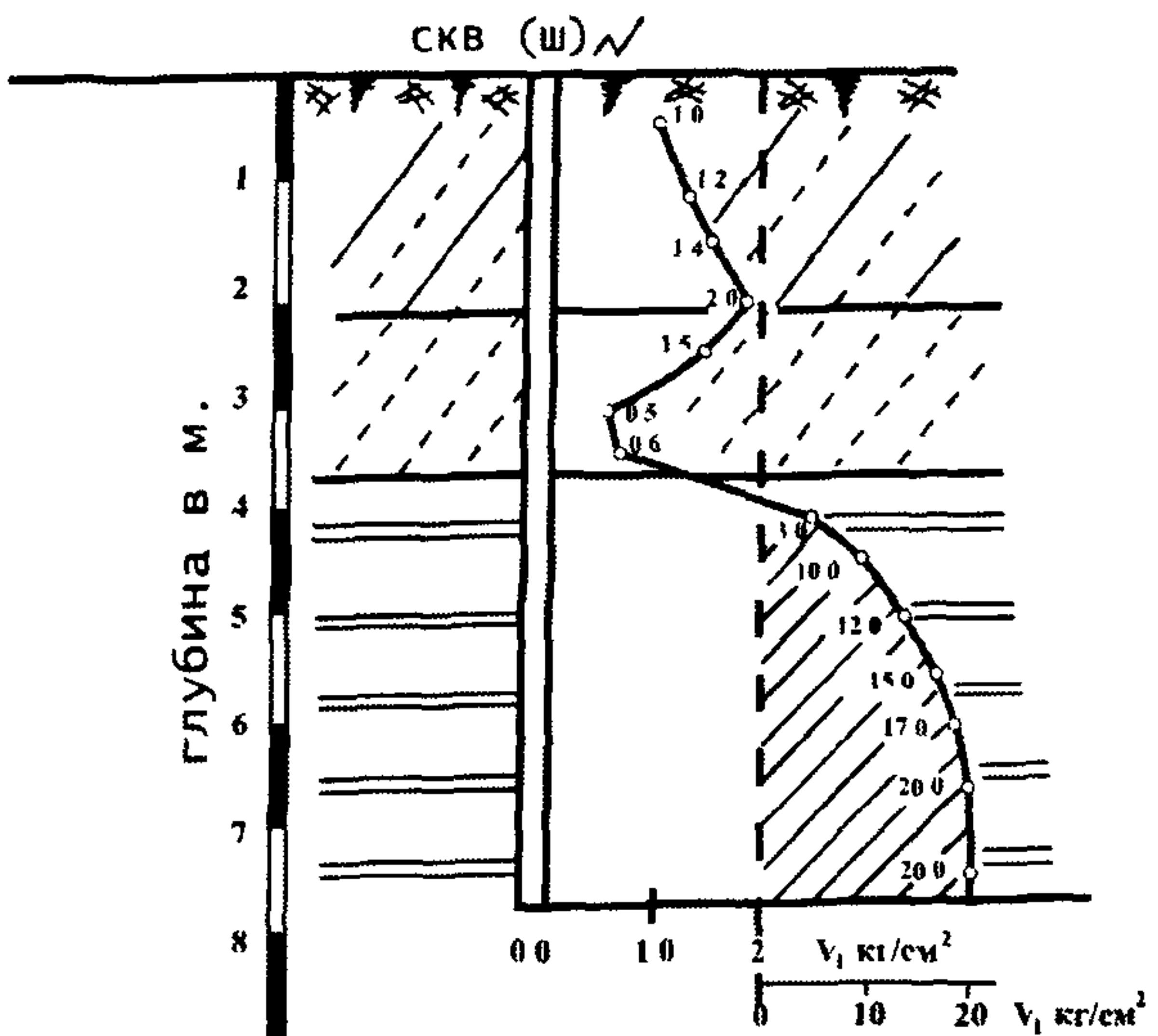
Рис 14 Инженерно-геологический разрез с данными проникания (распора) конуса 30° в керн или стенки шурфа
