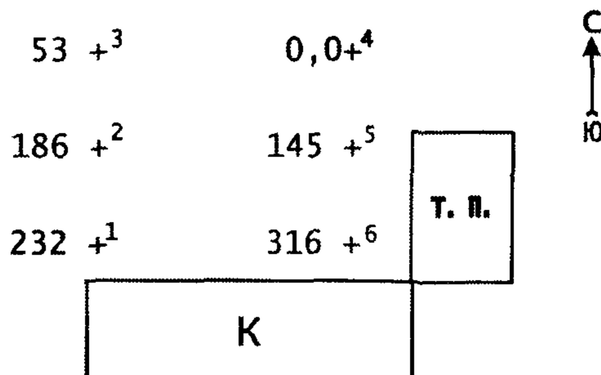
*Рис. 29. Схема расположения фундаментов с относительными отметками опорных плит:
