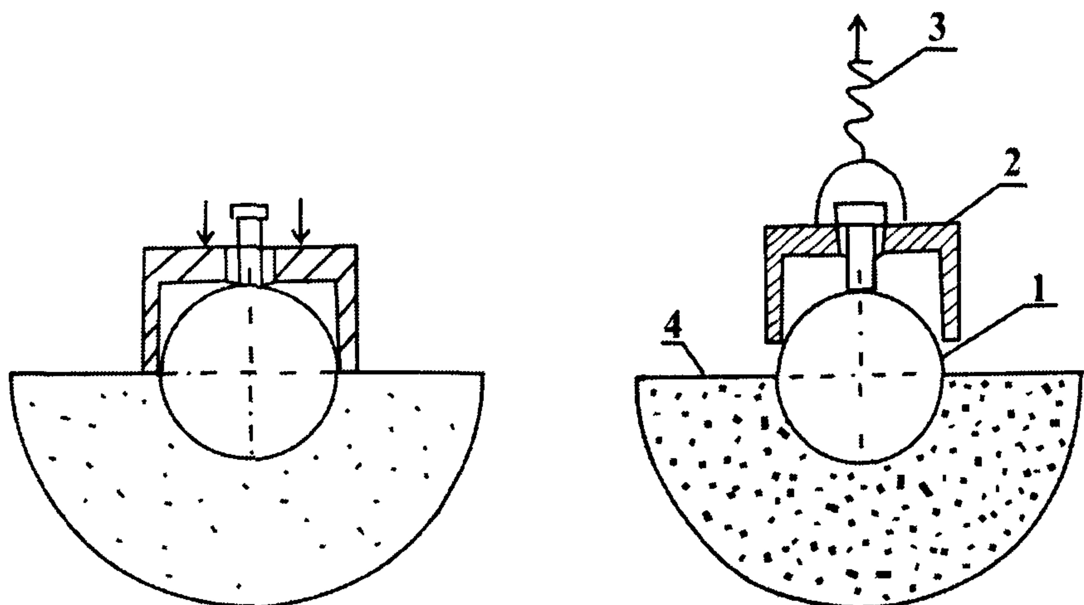
Рис 12 Схема испытания глиномером
