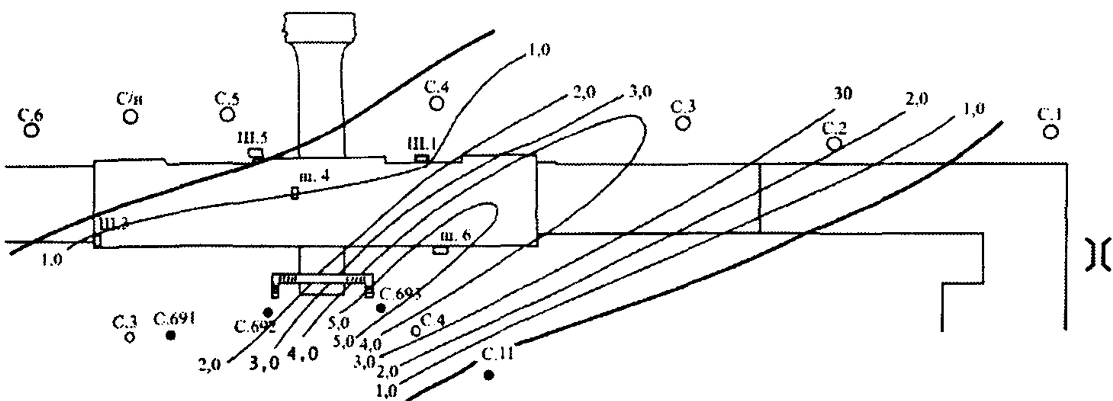
Рис. 34. План-схема залегания погребных стариичных иловато-суглинистосупечаных отложений под корп. I п. о. «Ижмаш»:
