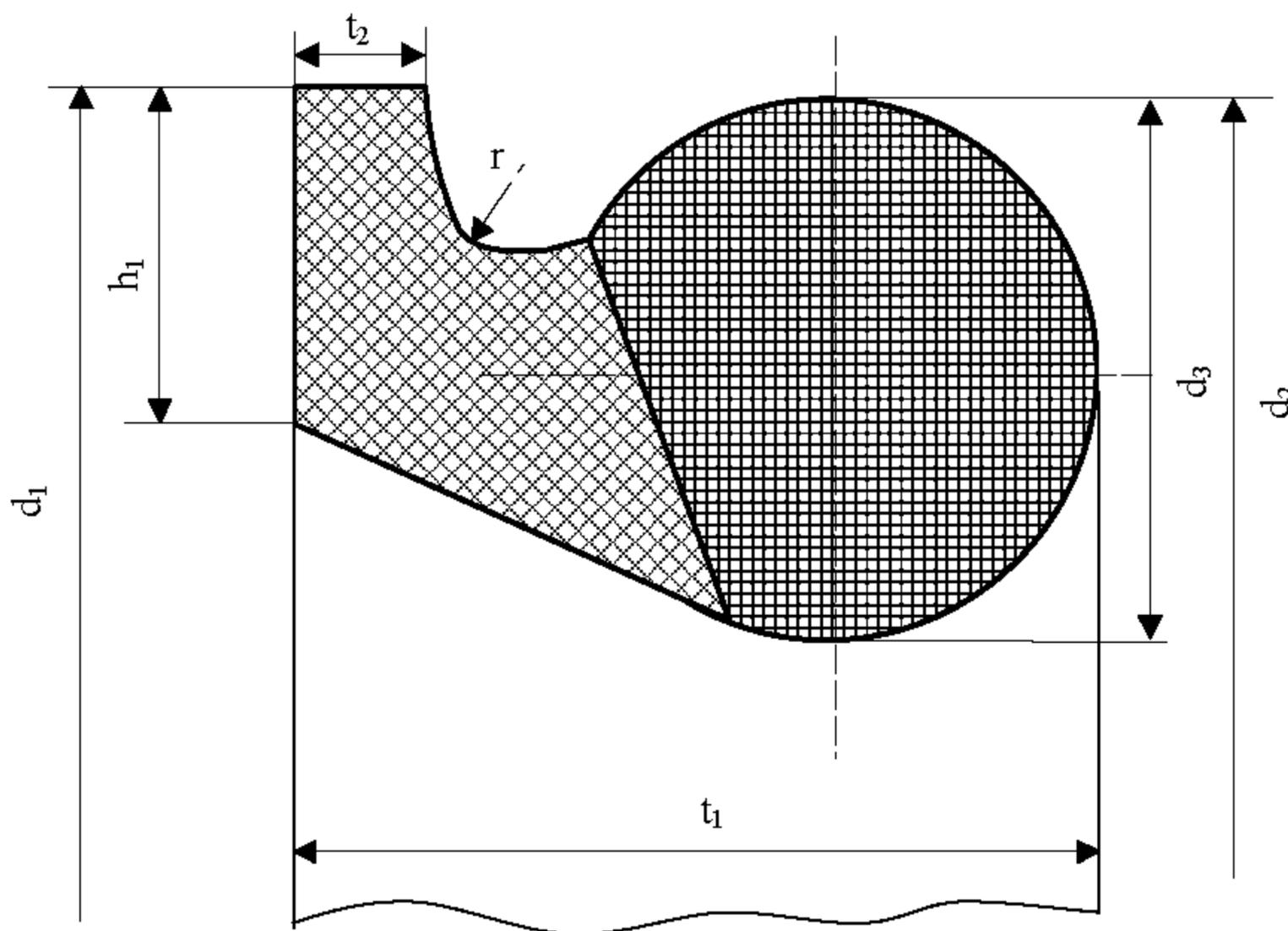
Рисунок А.6 – Уплотнительное резиновое кольцо (под соединение «Тайтон»)
