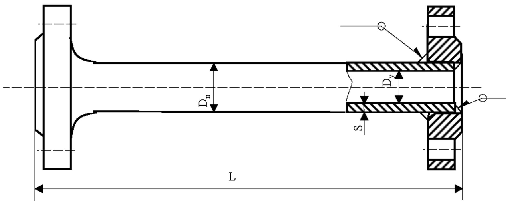
Рисунок А.10 – Труба с литым и приваренным фланцами (тип А)
