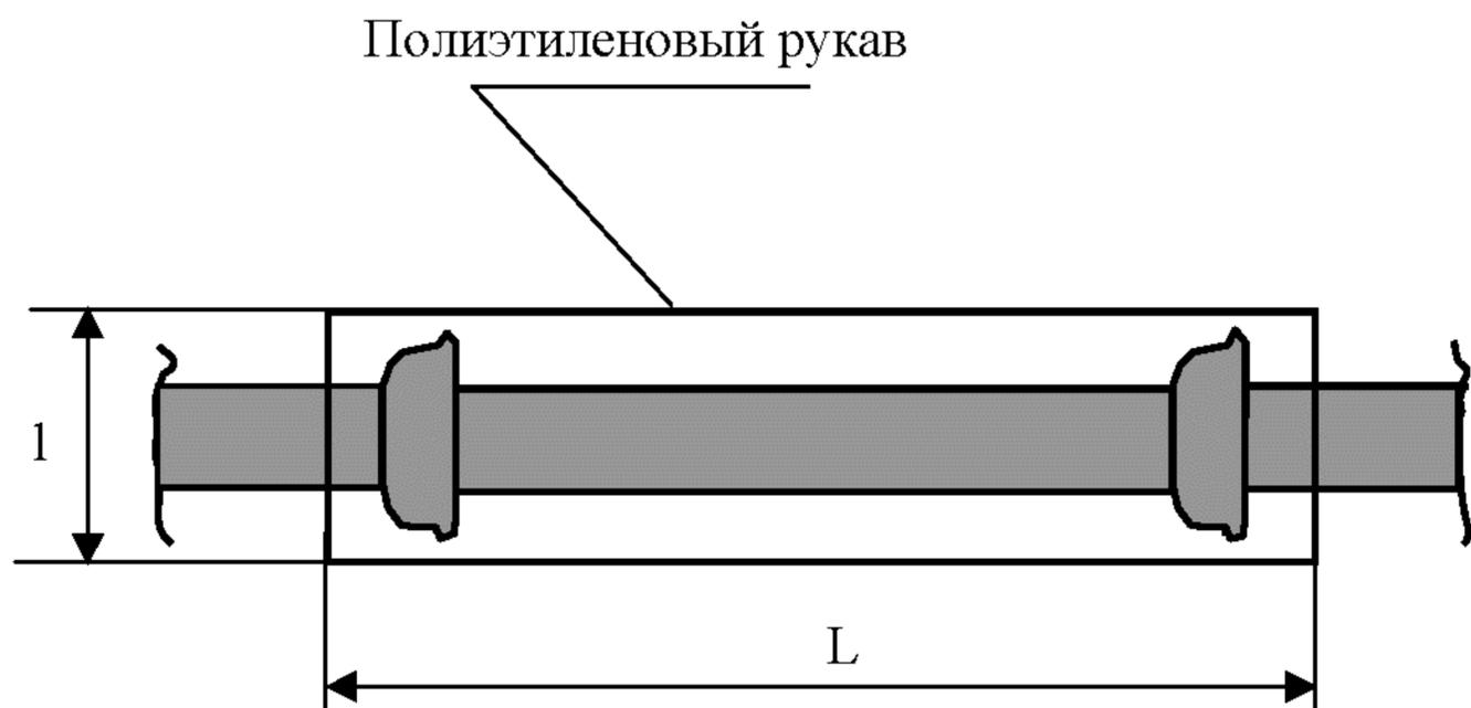
Рисунок А.16 – Полиэтиленовый рукав
