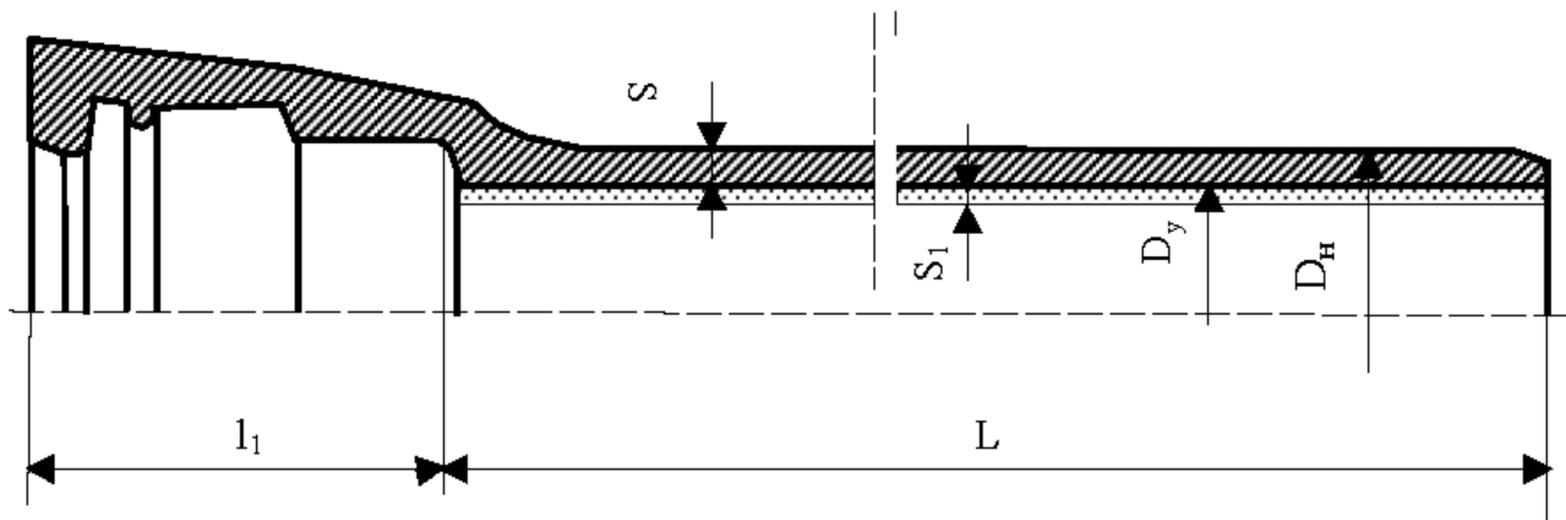
Рисунок А.2 – Труба раструбная под соединение «Тайтон»
