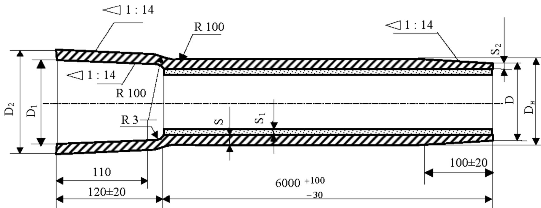
Рисунок А.4 – Труба под нахлестное сварное соединение
