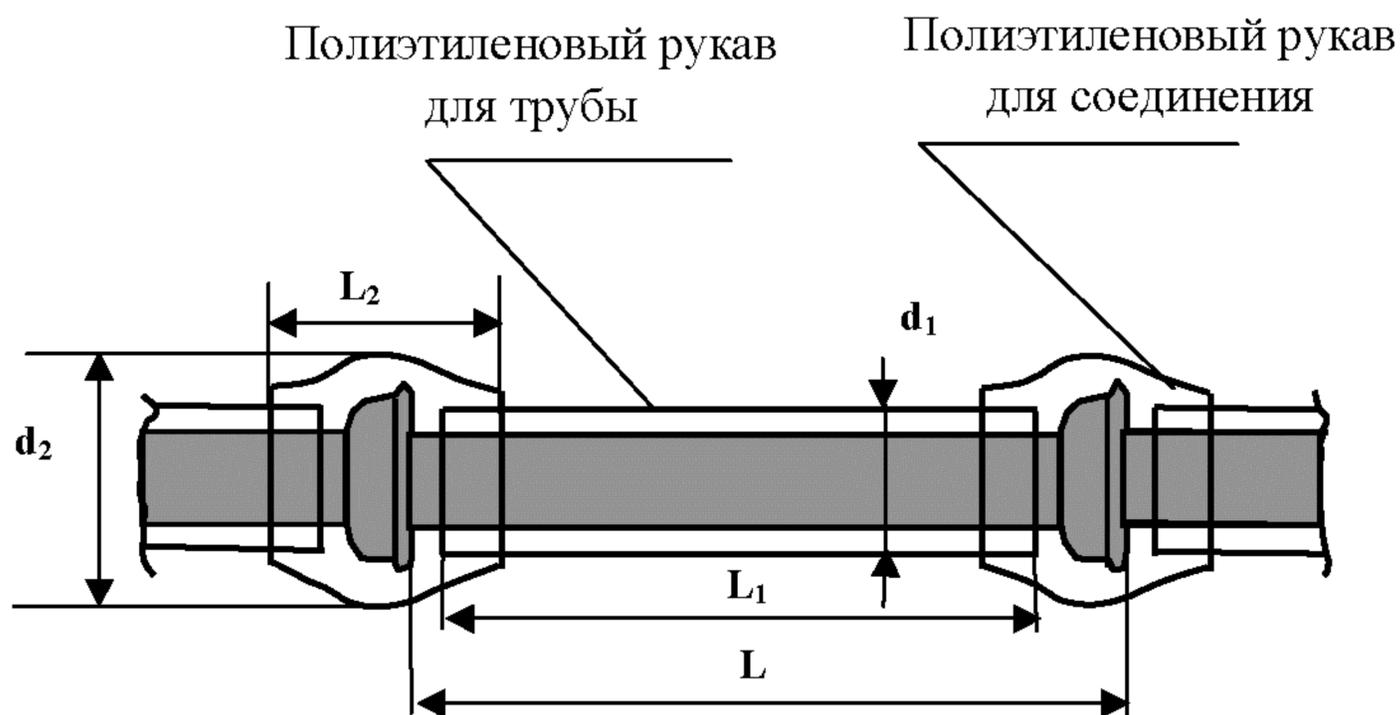
Рисунок А.16 – Полиэтиленовый рукав
