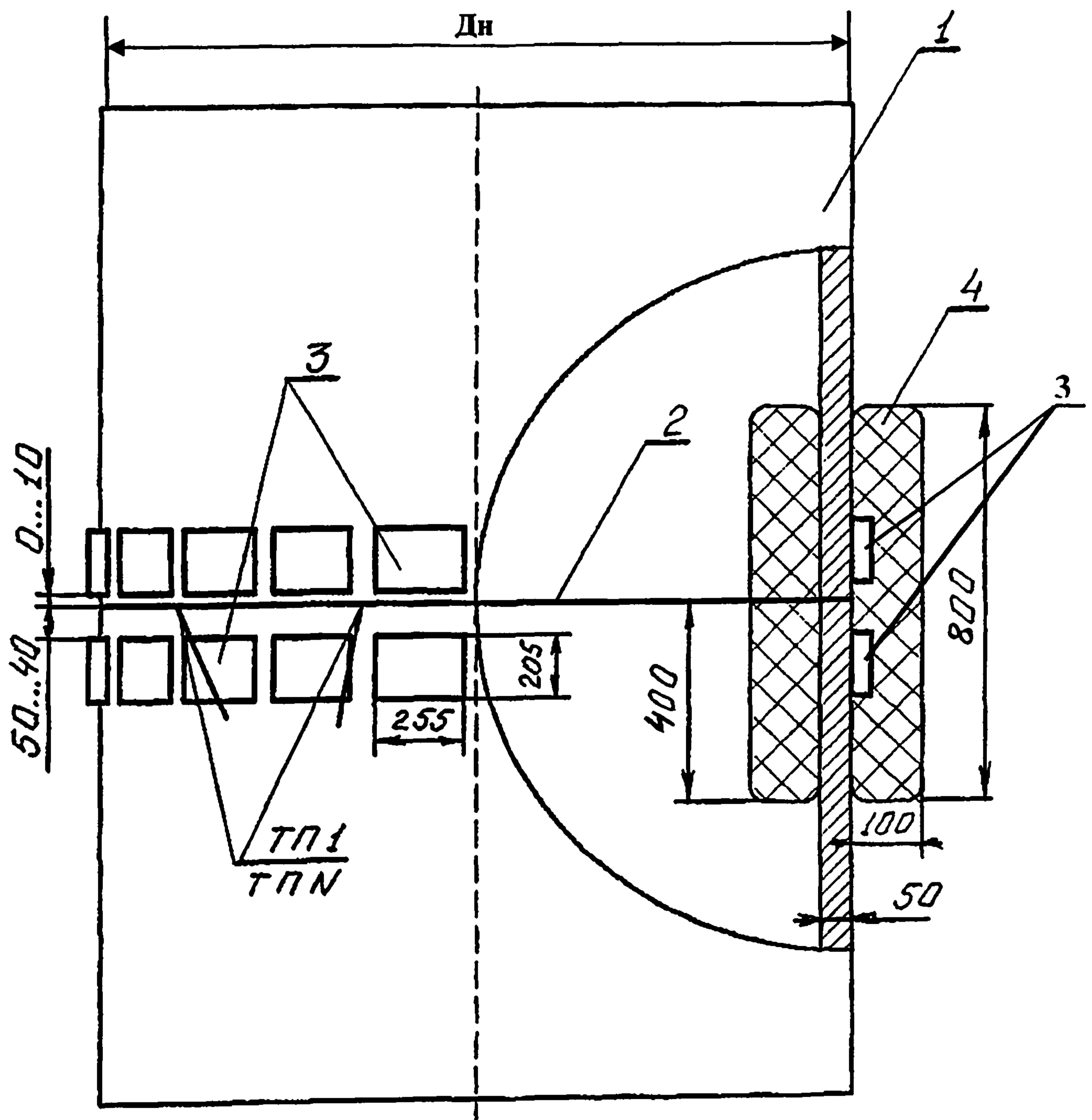
1. - Корпус аппарата; 2. - Сварной шов; 3. - Гибкие нагревательные коврики 255x205мм;
