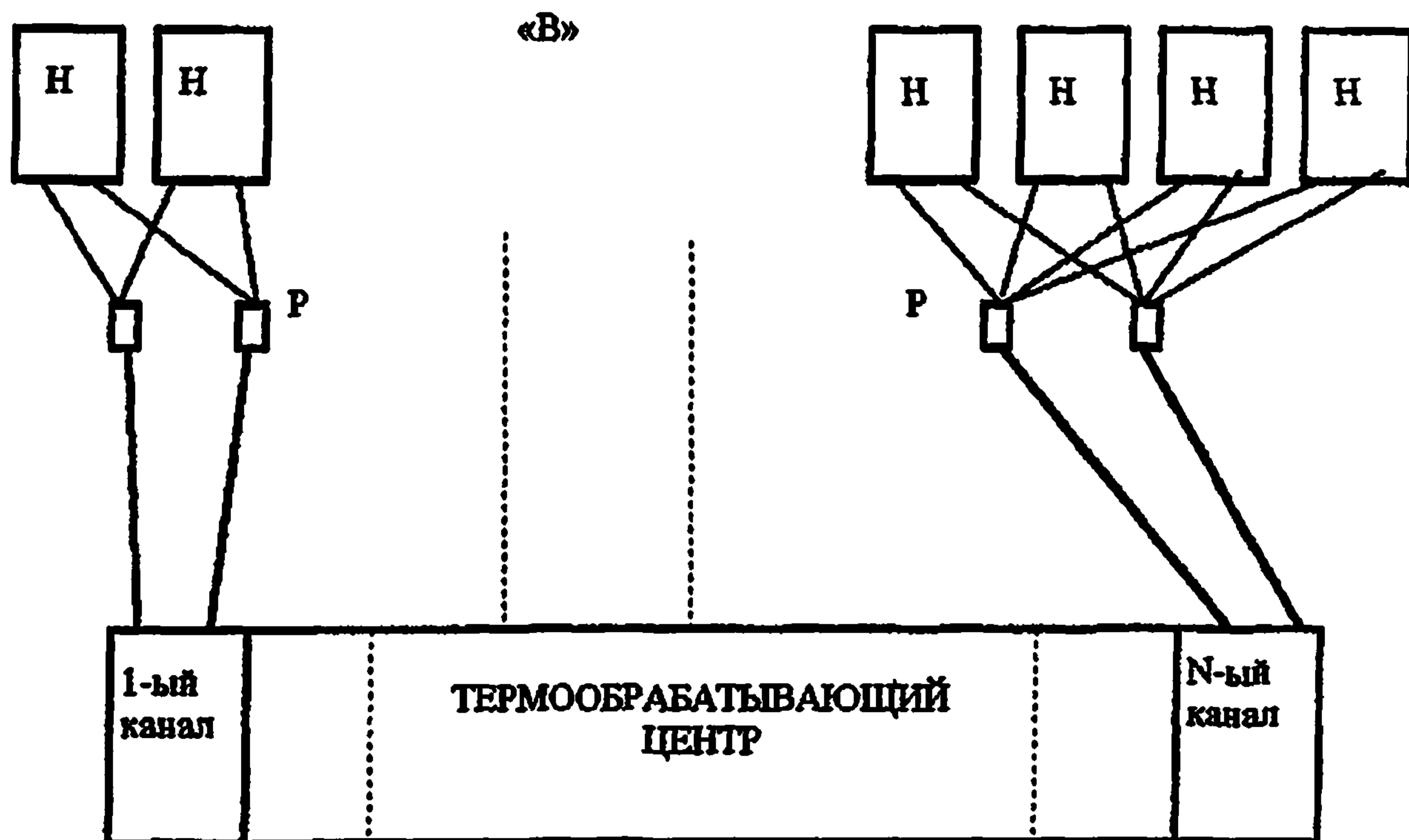
«А» - Схема подключения нагревателей к управляемому источнику питания «напрямую; «Б» - Схема подключения нагревателей к неуправляемому источнику питания через балластные реостаты, «В» - Схема подключения нагревателей к источнику питания термообрабатывающего центра; Н - Нагреватели; РБ - Балластные реостаты; Р - Разветвители.
