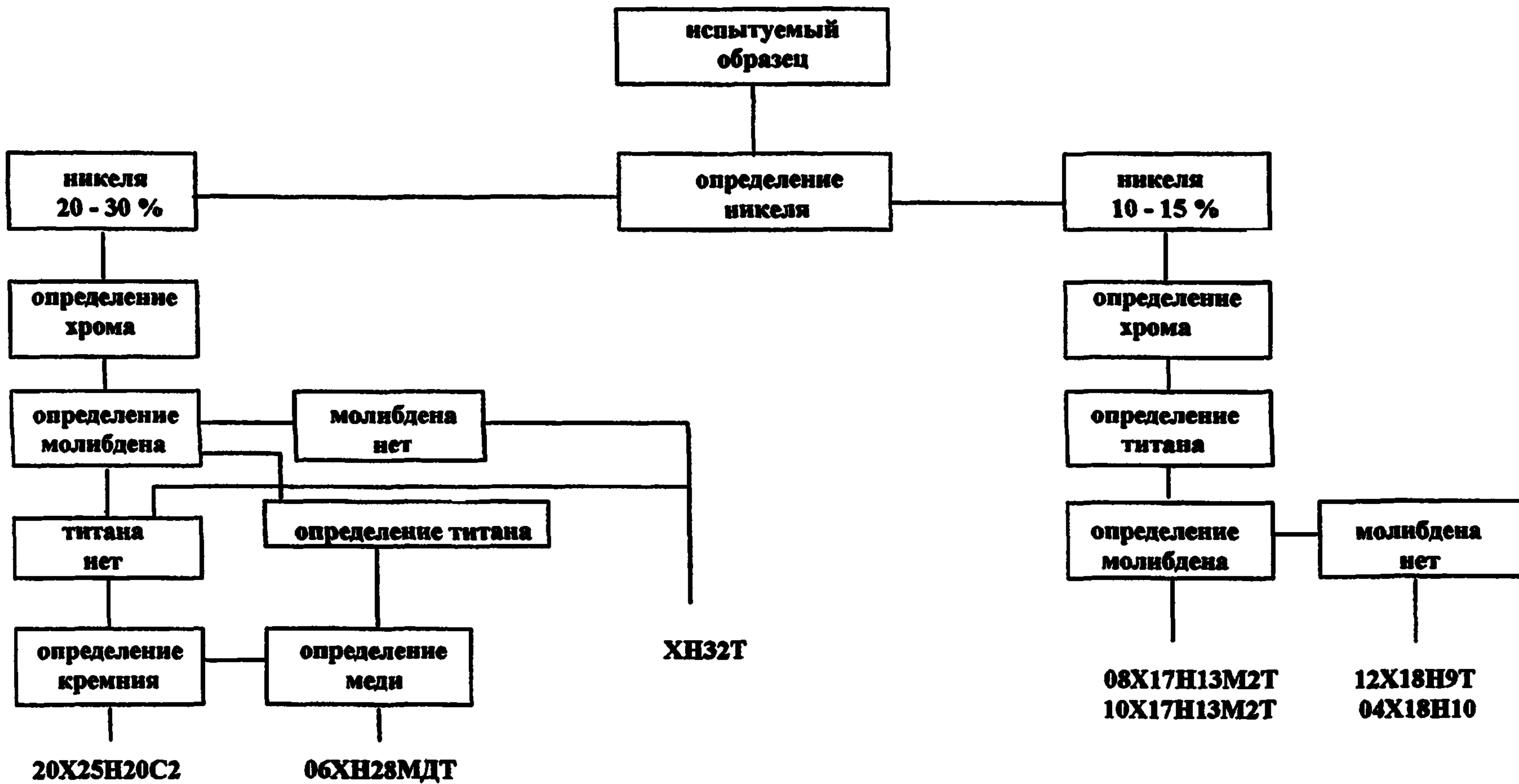
Рисунок 1 – Схема очередности определения для разбраковки высоколегированных сталей
