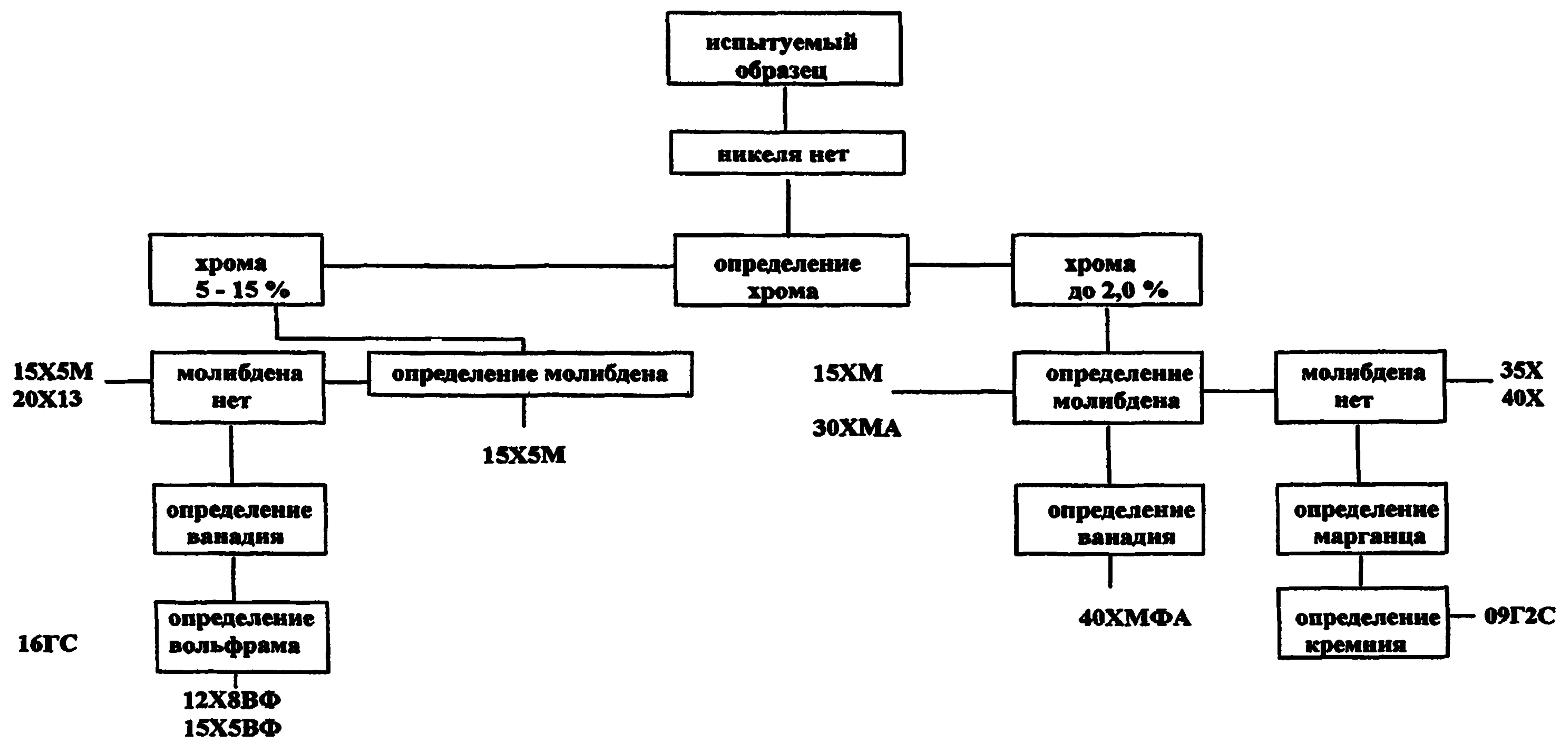
Рисунок 2 – Схема очередности определения для разбраковки низколегированных и легированных сталей
