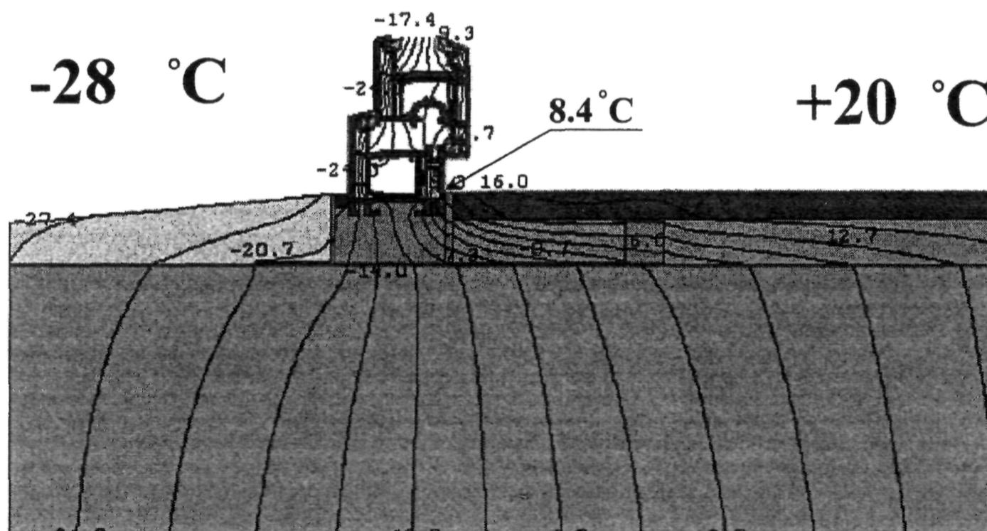
Рисунок А.4 – Температурное поле узла примыкания О.Б.из ПВХ профиля шириной 70 мм к проему без четверти однослойной стены (рисунок А.3).
