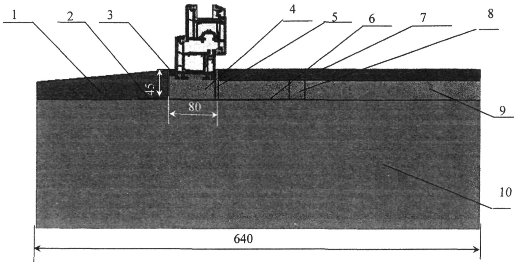
Рисунок А.3 – Узел примыкания О.Б. из ПВХ профиля к проему без четверти однослойной стены (кирпичная кладка).
