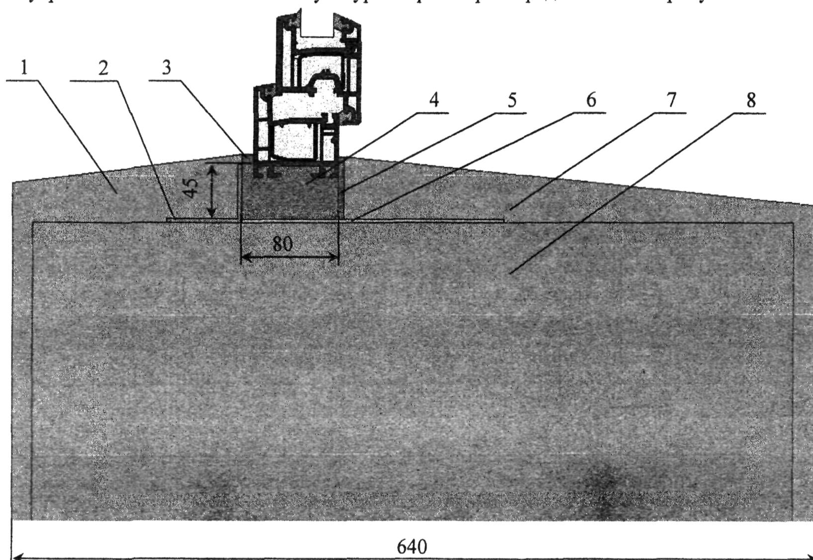
Рисунок А.7 – Узел примыкания О.Б. из ПВХ профиля к проему без четверти однослойной стены из пено-газобетонных блоков с отделкой наружных и внутренних откосов «теплым» штукатурным раствором.
