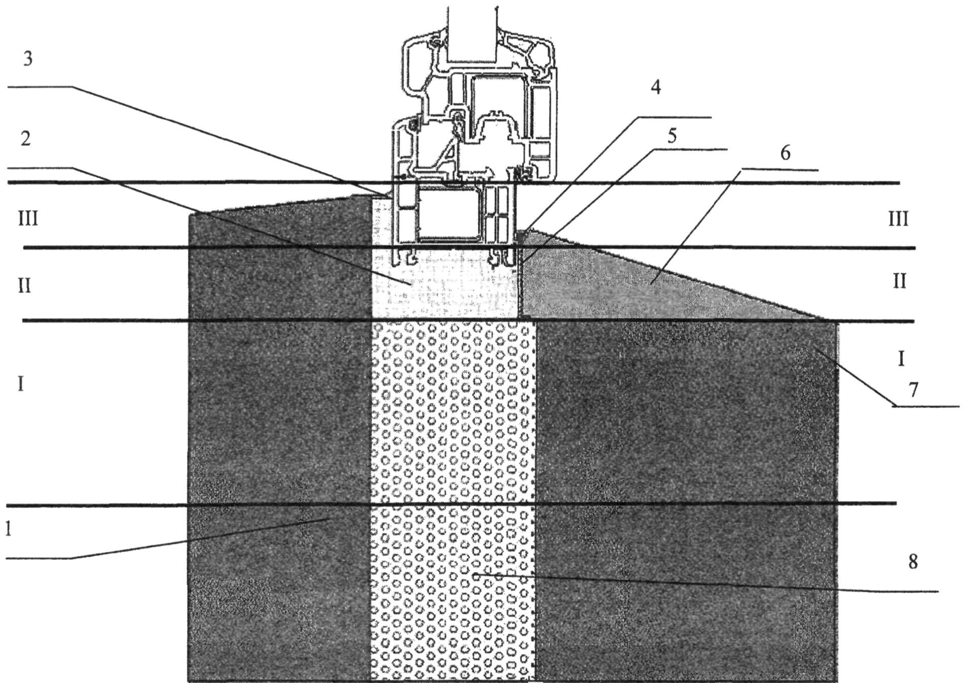
Рис.1 Схема узла примыкания О.Б. к проему многослойной стены.
