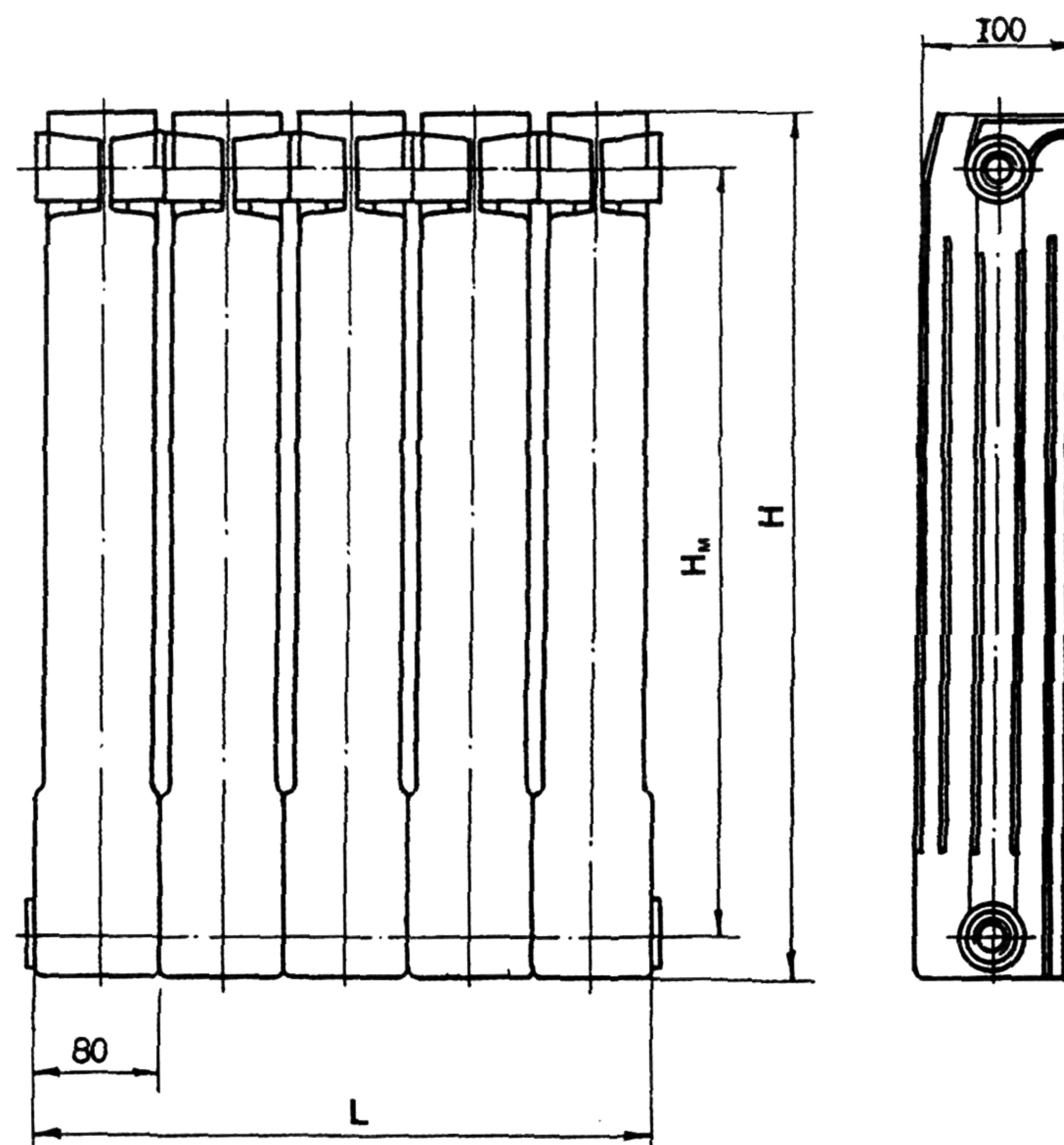
Рис. 1.1. Общий вид (а) и габаритные размеры (б)
