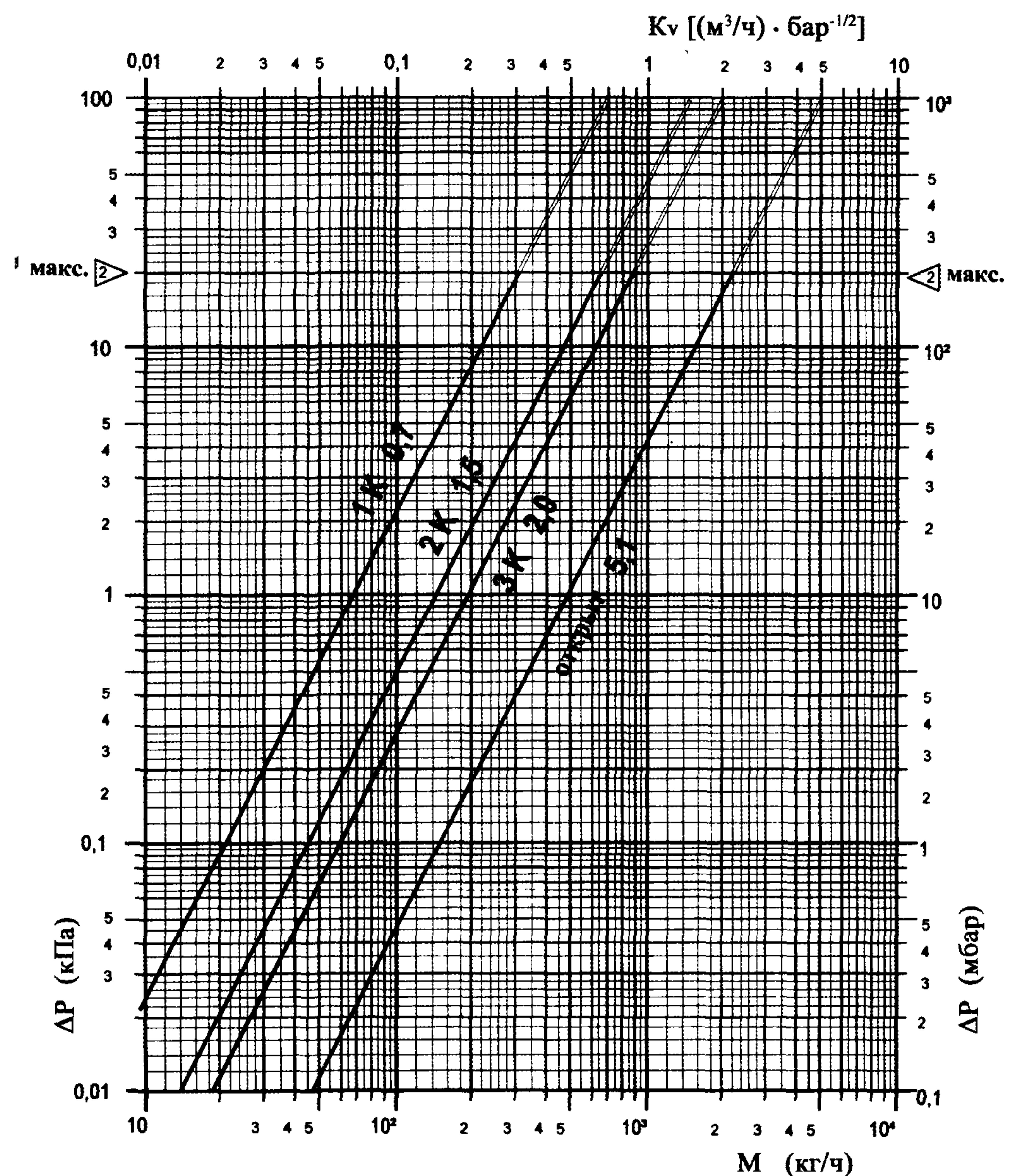
Рис. 3.3. Гидравлические характеристики термостатов
