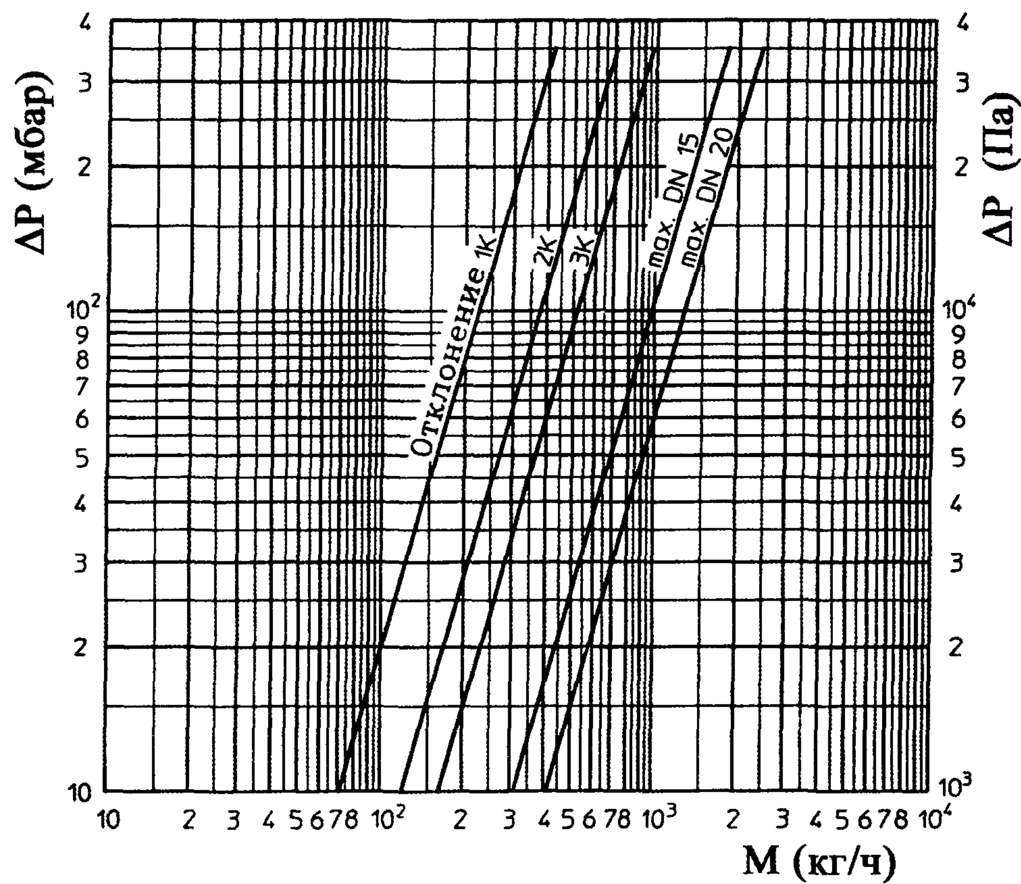
Рис. 3.4. Гидравлические характеристики термостатов серии «М»
