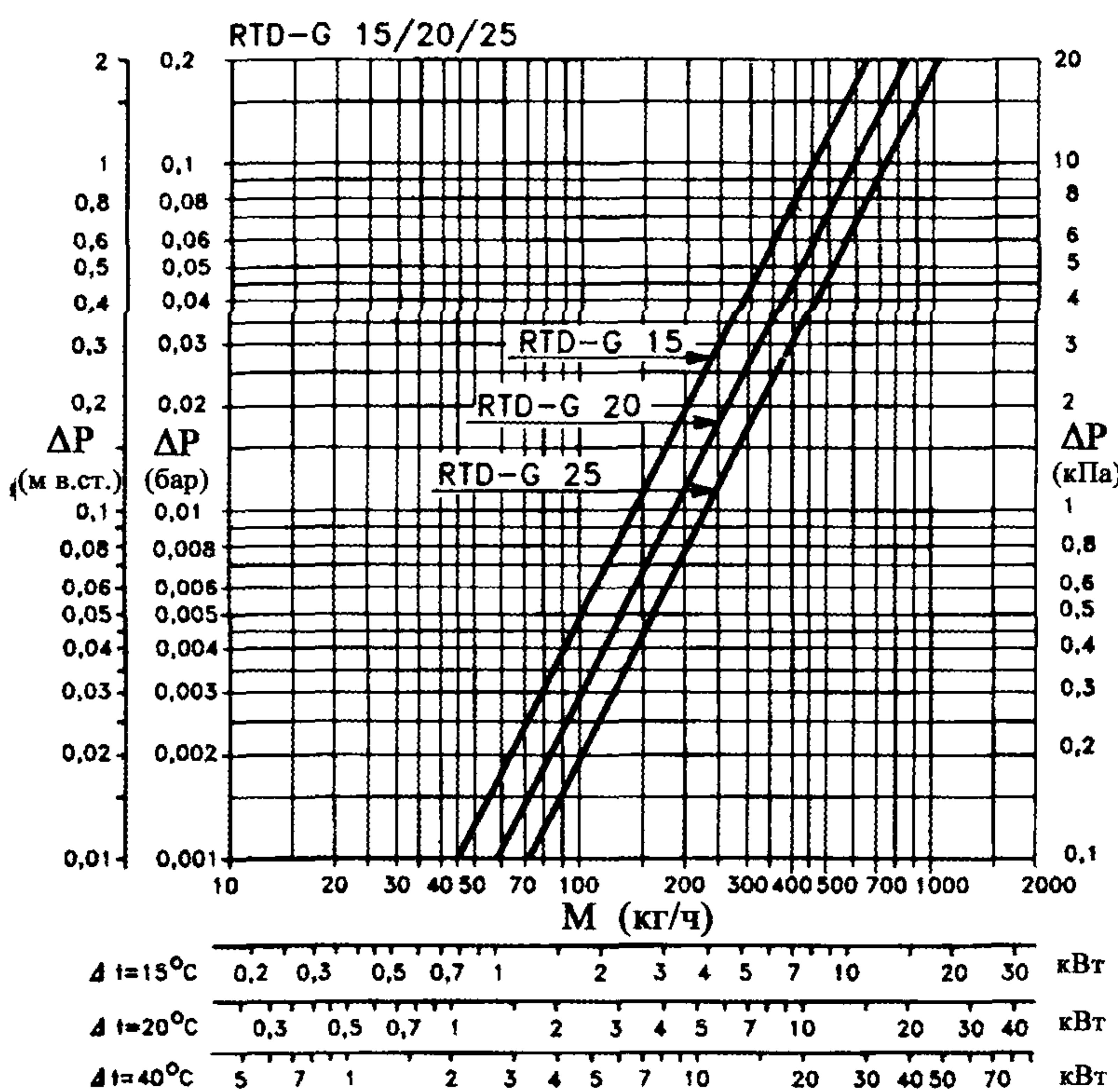
Рис. 3.2. Гидравлические характеристики термостатов «Данфосс»:
