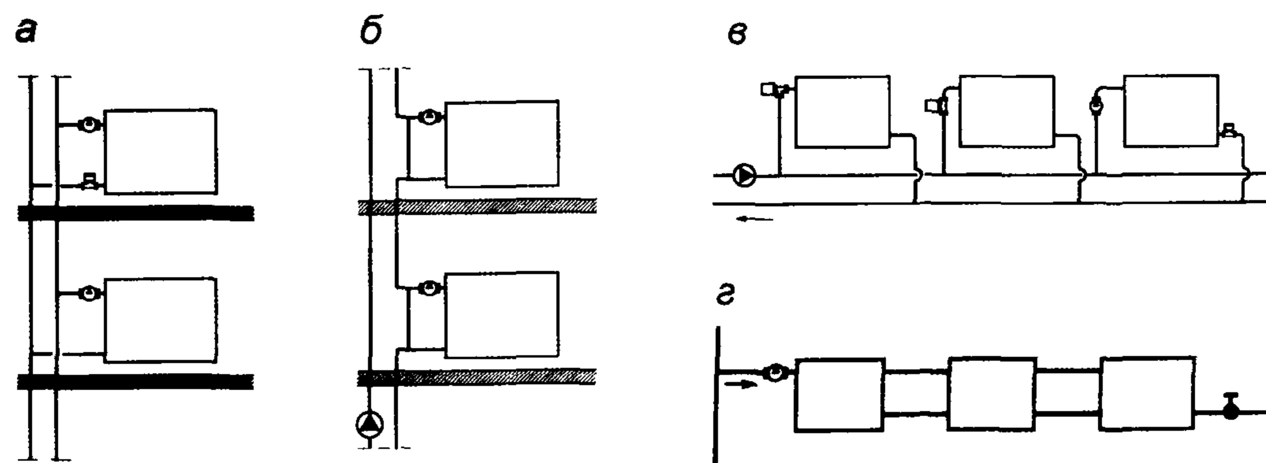
Рис. 2.2. Схемы систем водяного отопления с секционными радиаторами:
