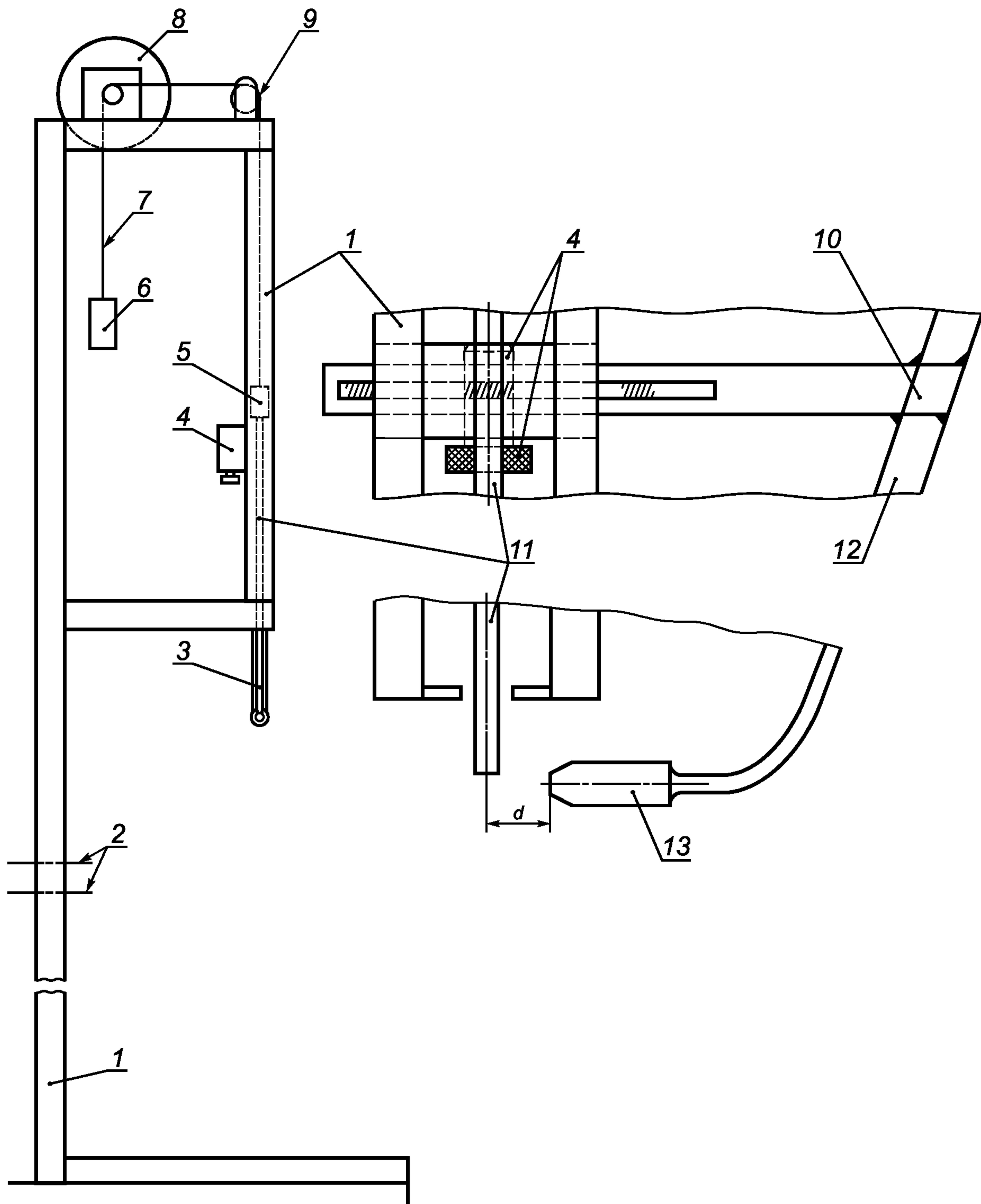
1 — рама; 2 — линии отверстий для крепления направляющего приспособления; 3 — сварочная горелка; 4 — система для регулирования расстояния  $d$ ; 5 — кольцо-держатель; 6 — противовес; 7 — трос; 8 — мотор; 9 — шкив; 10 — зажим; 11 — стальной стержень; 12 — корпус горелки; 13 — сопло горелки
