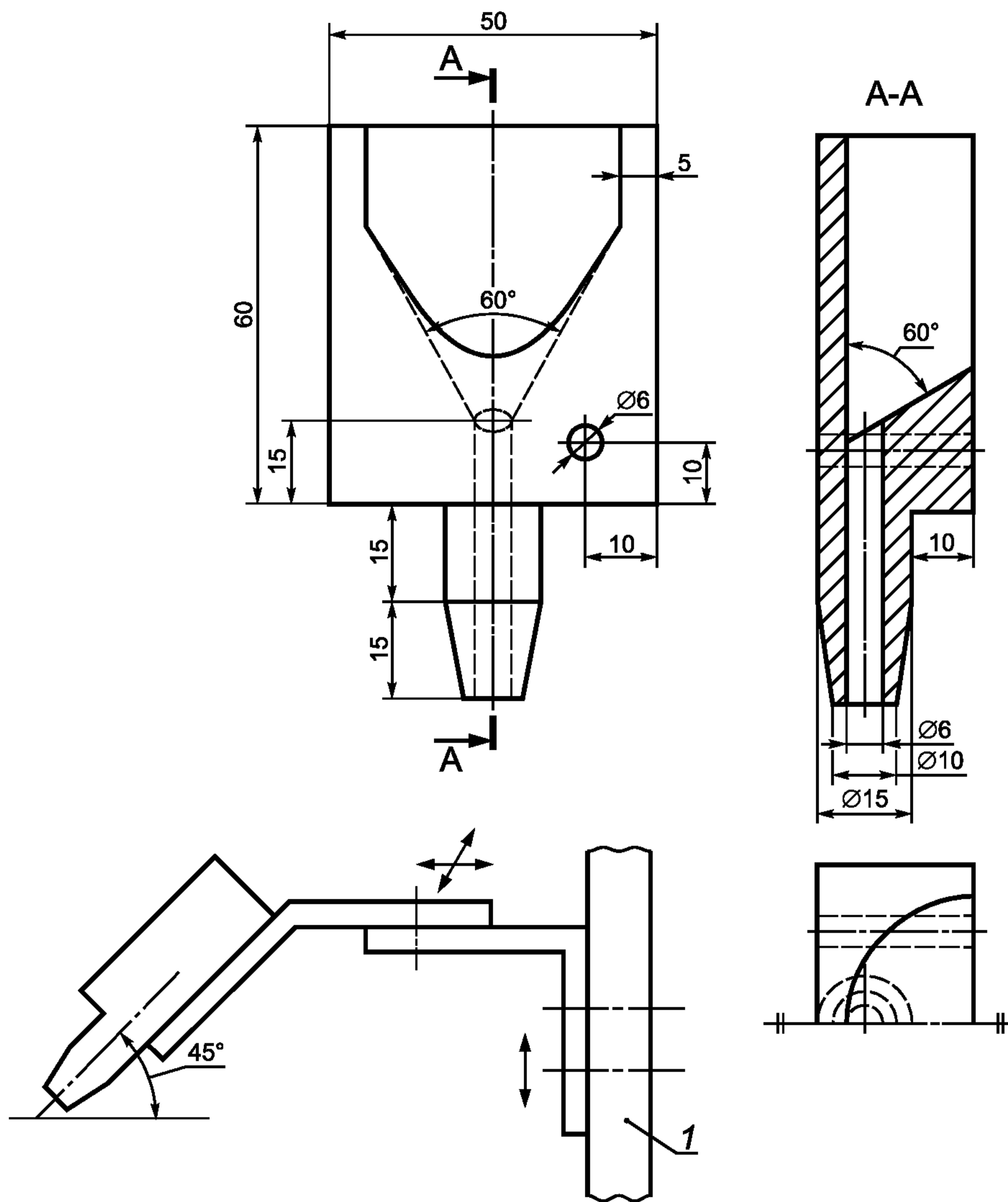
**П р и м е ч а н и е** — Рекомендуется отдельно изготавливать воронку и детали трубы направляющего приспособления, а затем скреплять их под прессом.
