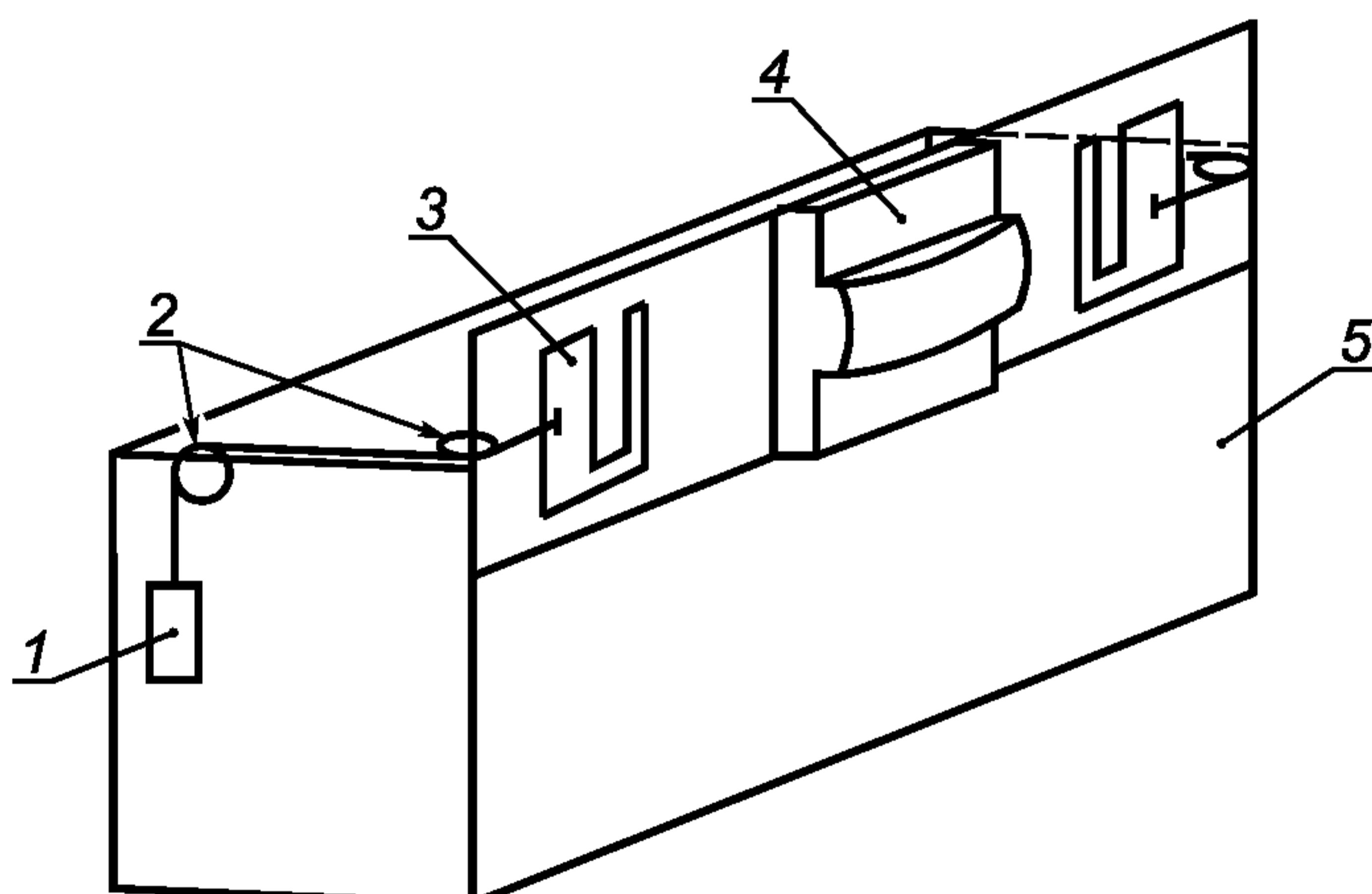
1 — противовес; 2 — шкивы; 3 — захват; 4 — блок опоры датчика; 5 — рама
