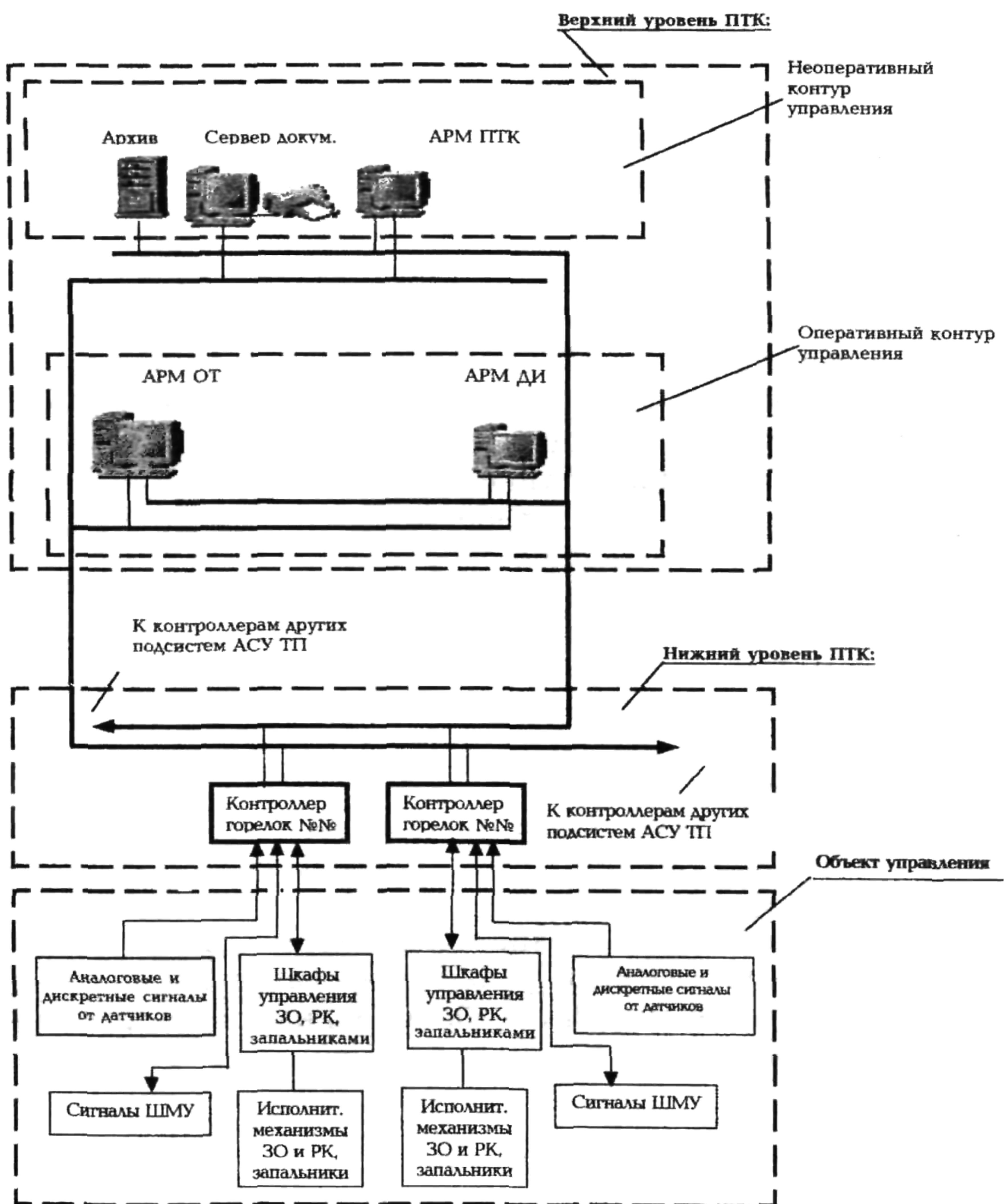
Рисунок 2 – Структурная схема ПТК системы
