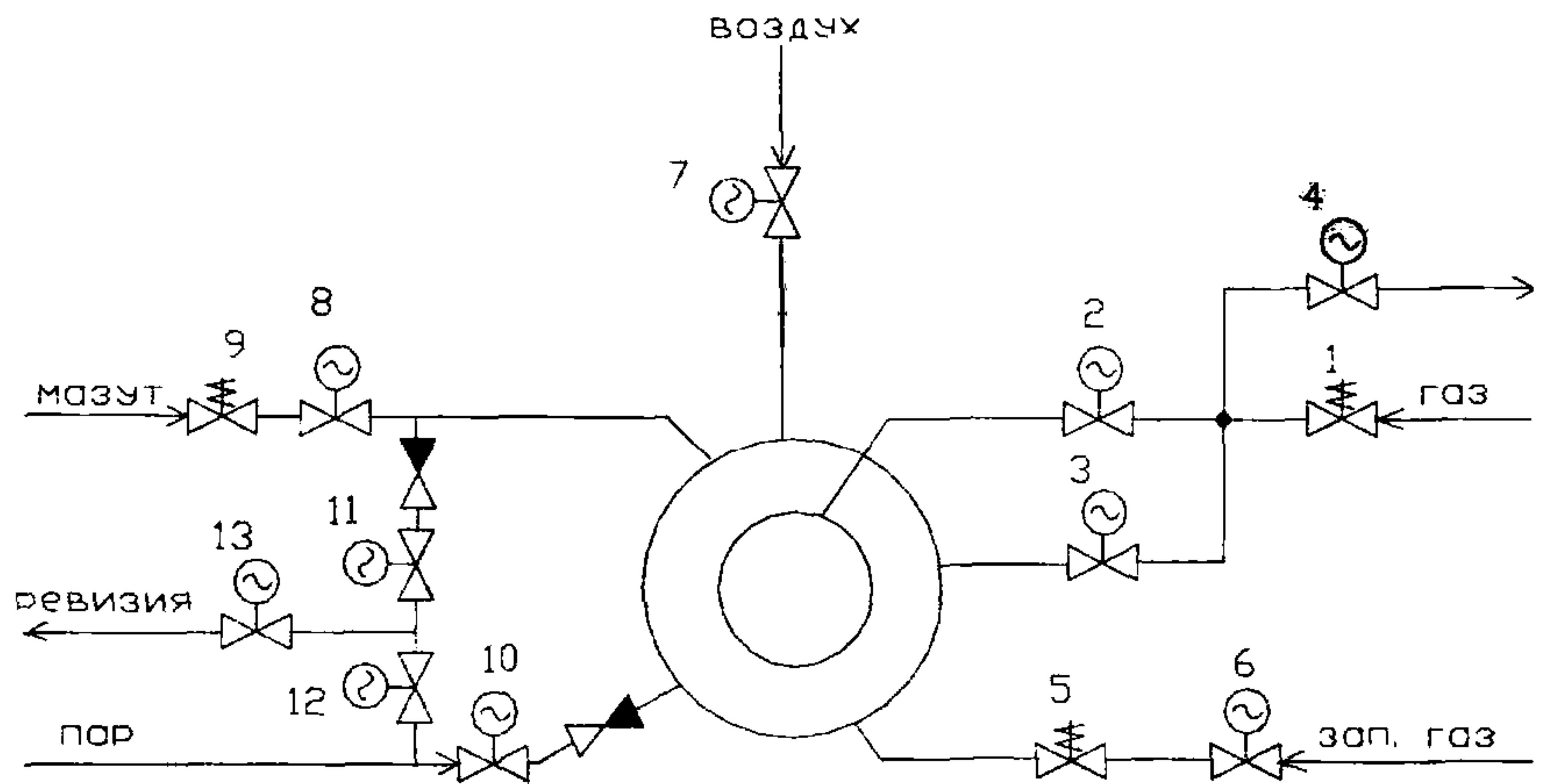
**Рисунок 1 – Схема газомазутной горелки**
