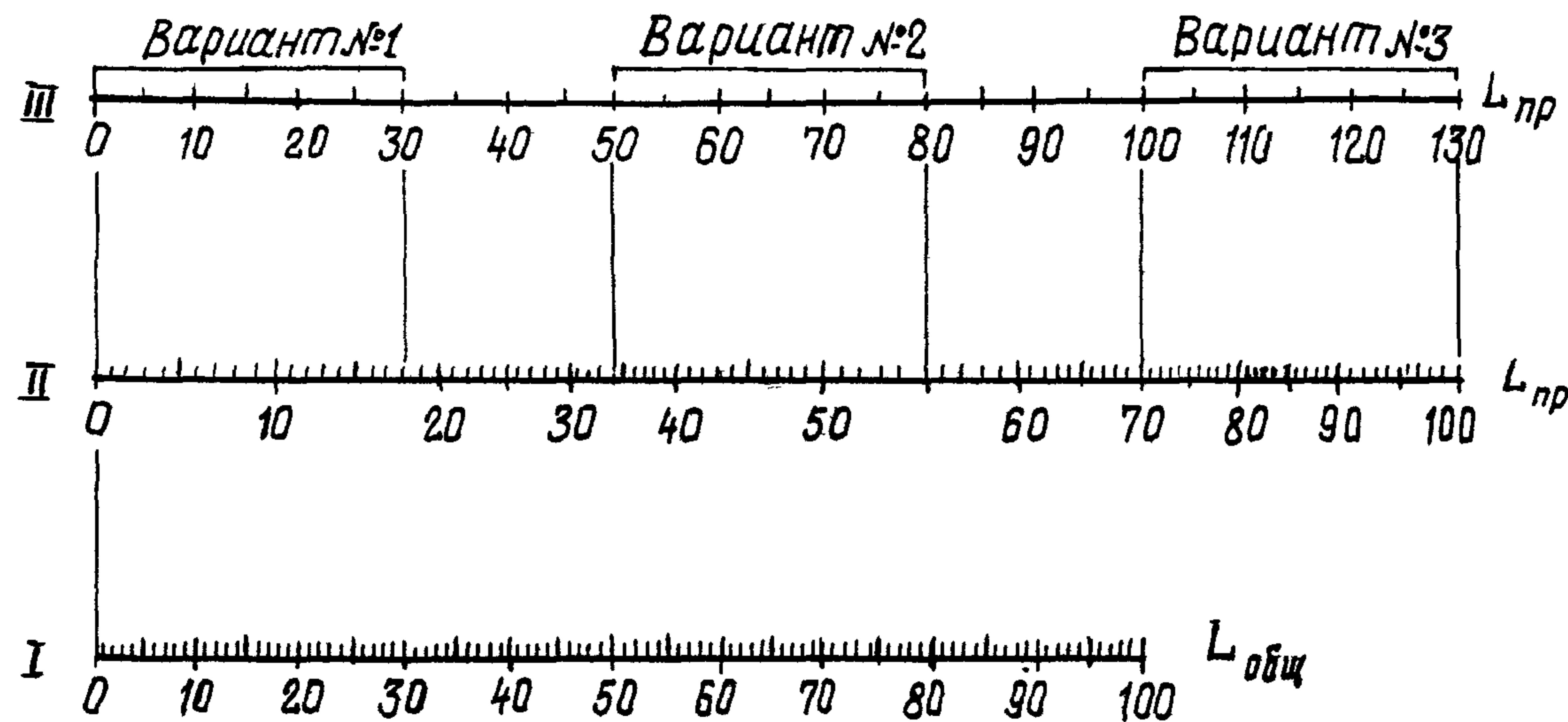
Рис.3. График для определения по трассе магистрального трубопровода границ участков работы отдельных производственных комплексов
