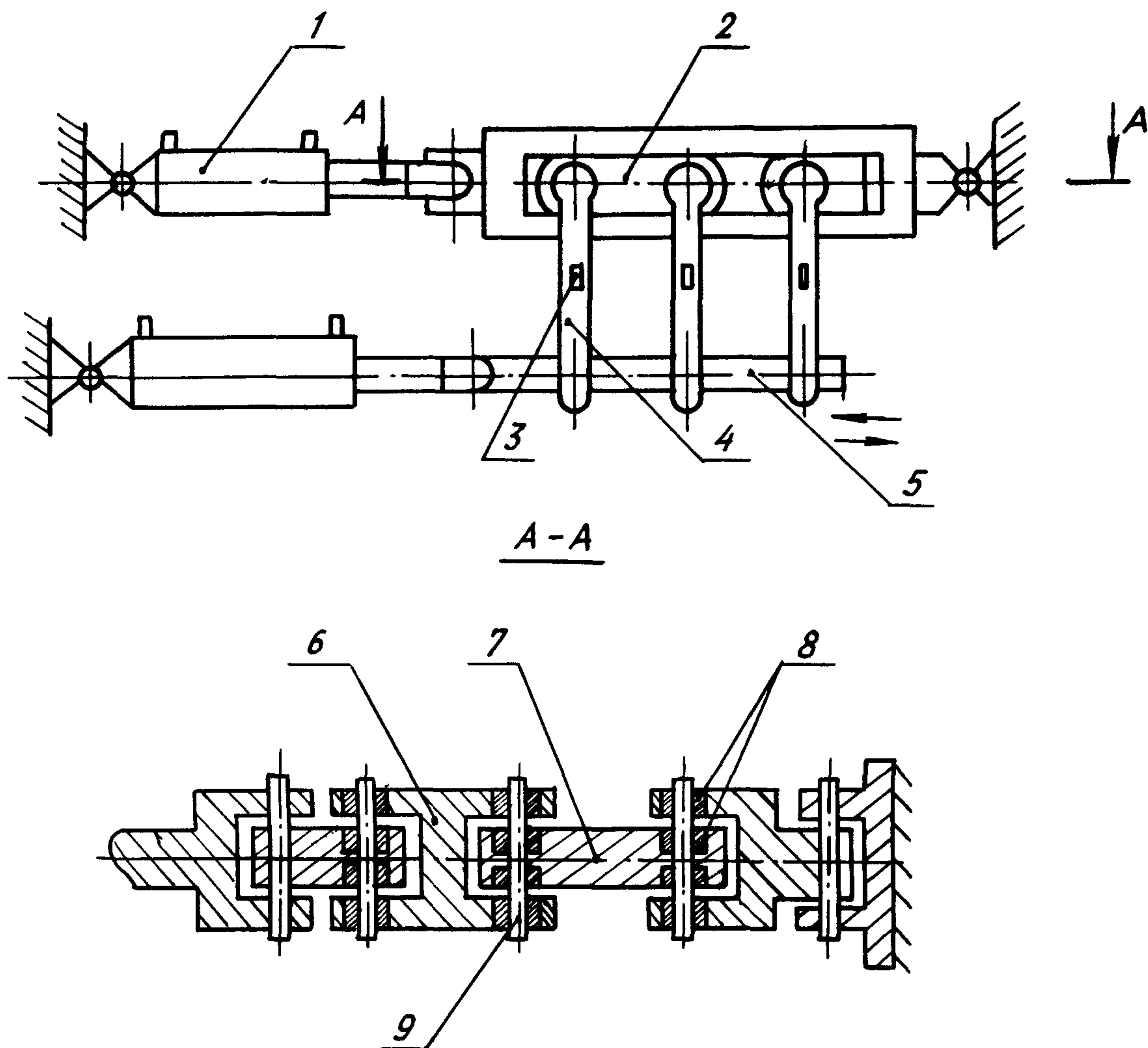
1 - нагружающий цилиндр; 2 - блок шарниров в направляющих; 3 - тензометрический датчик; 4 - рычаг; 5 - механизм привода; 6 - внешнее звено; 7 - внутреннее звено; 8 - втулки; 9 - ось
