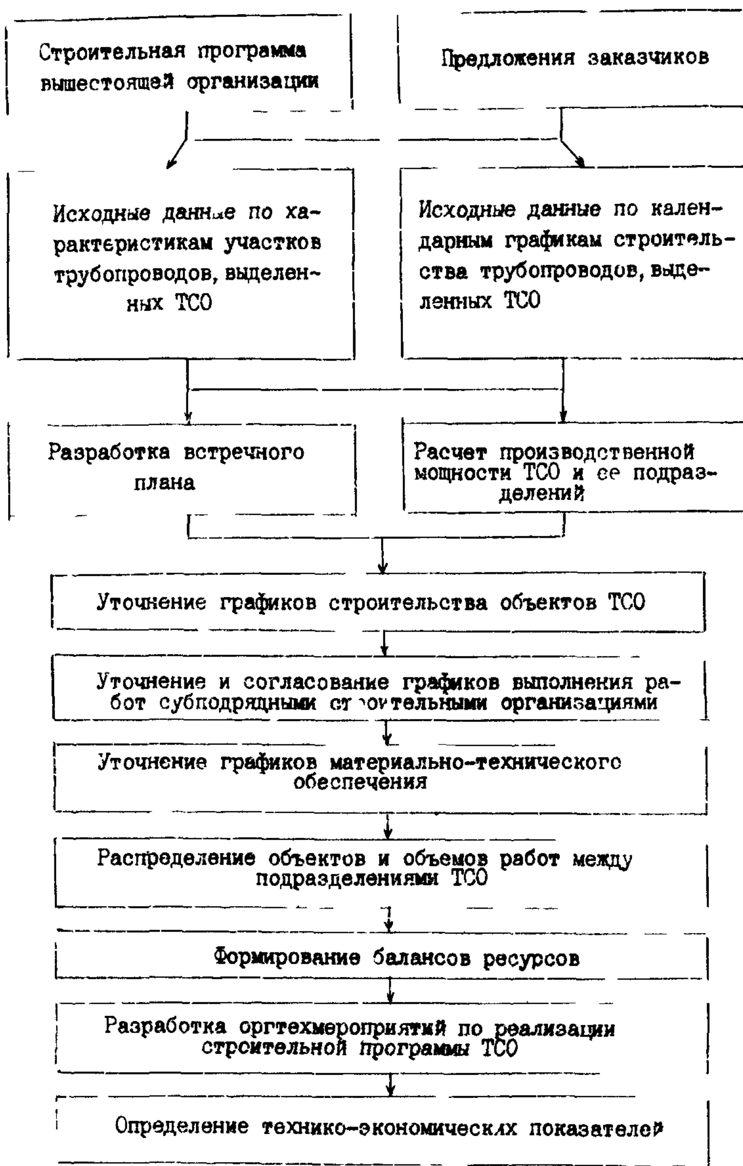
Рис.2. Последовательность разработки строительной программы трубопроводостроительной организации
