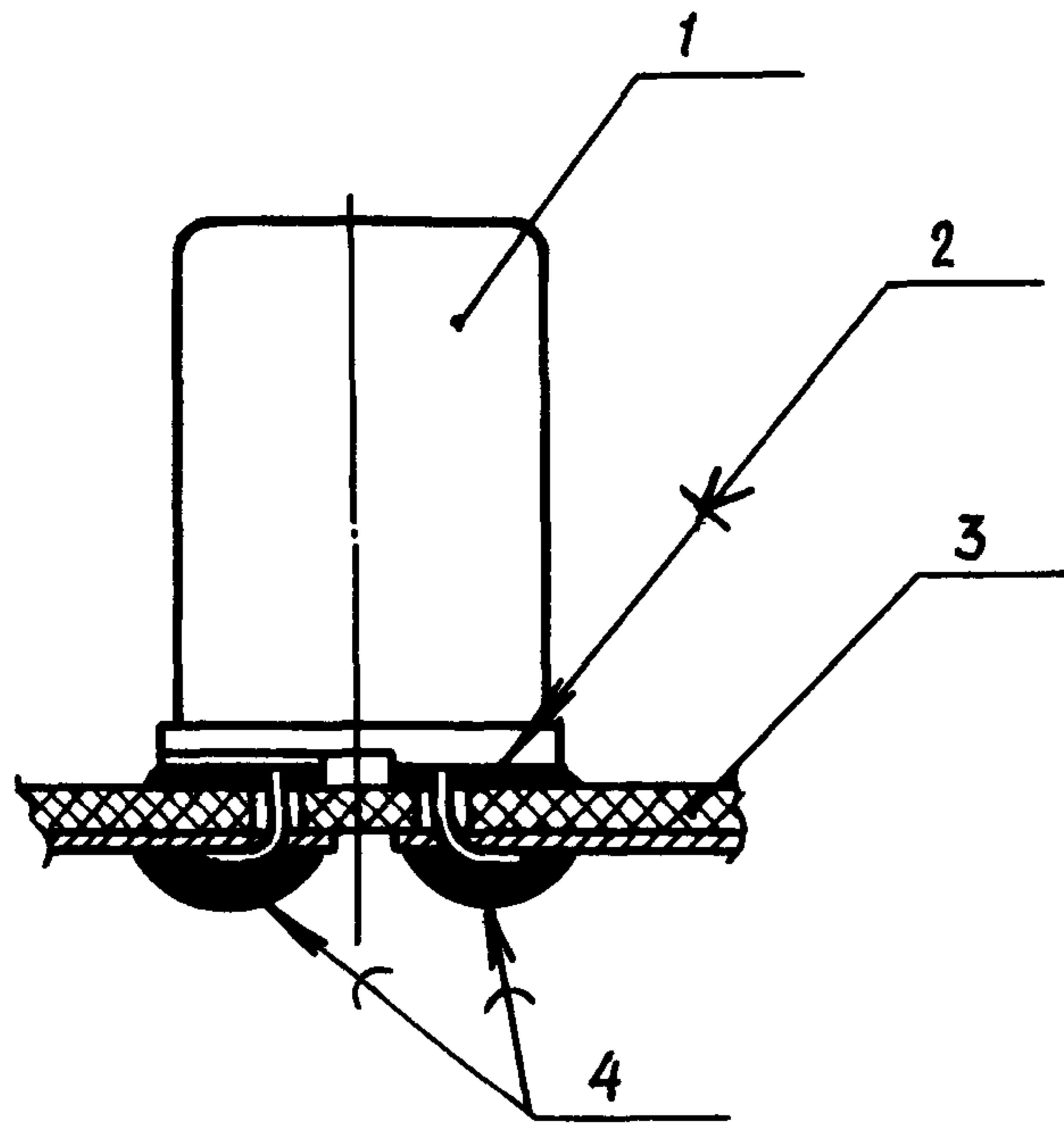
1 - реле; 2 - клей или эпоксидная замазка;
