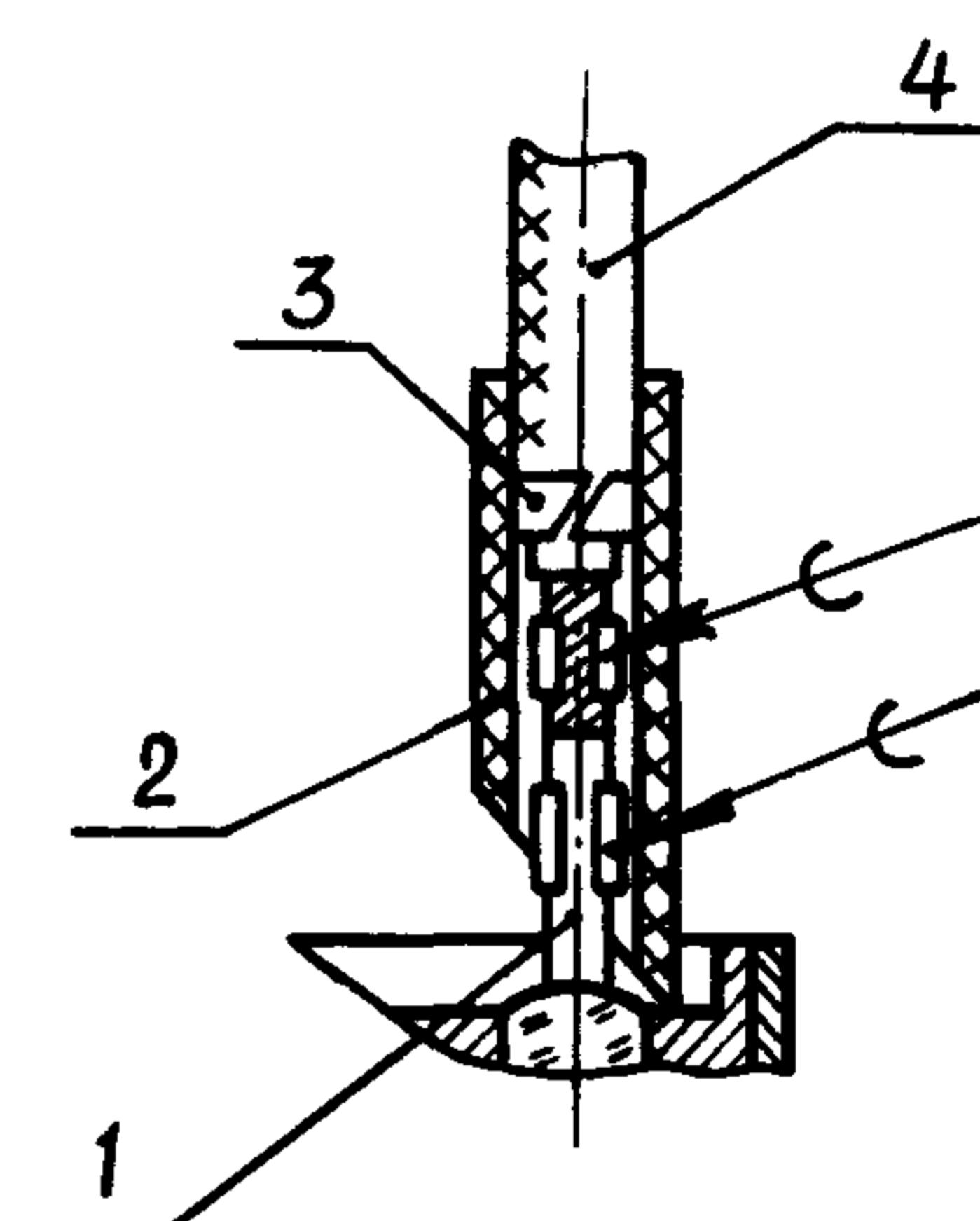
1 - вывод; 2 - трубка изоляционная;
