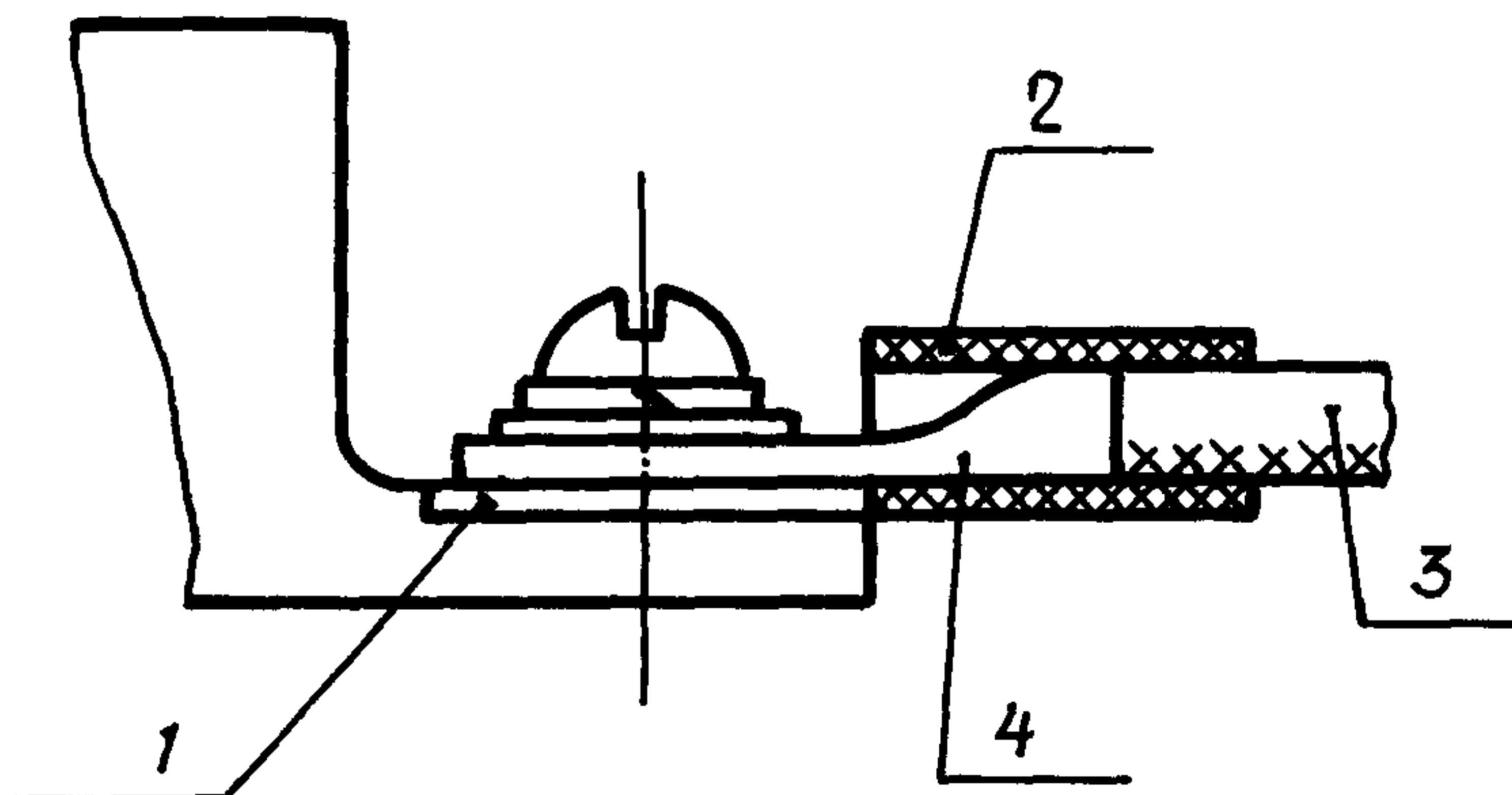
1 - шина; 2 - трубка изоляционная; 3 - провод;
