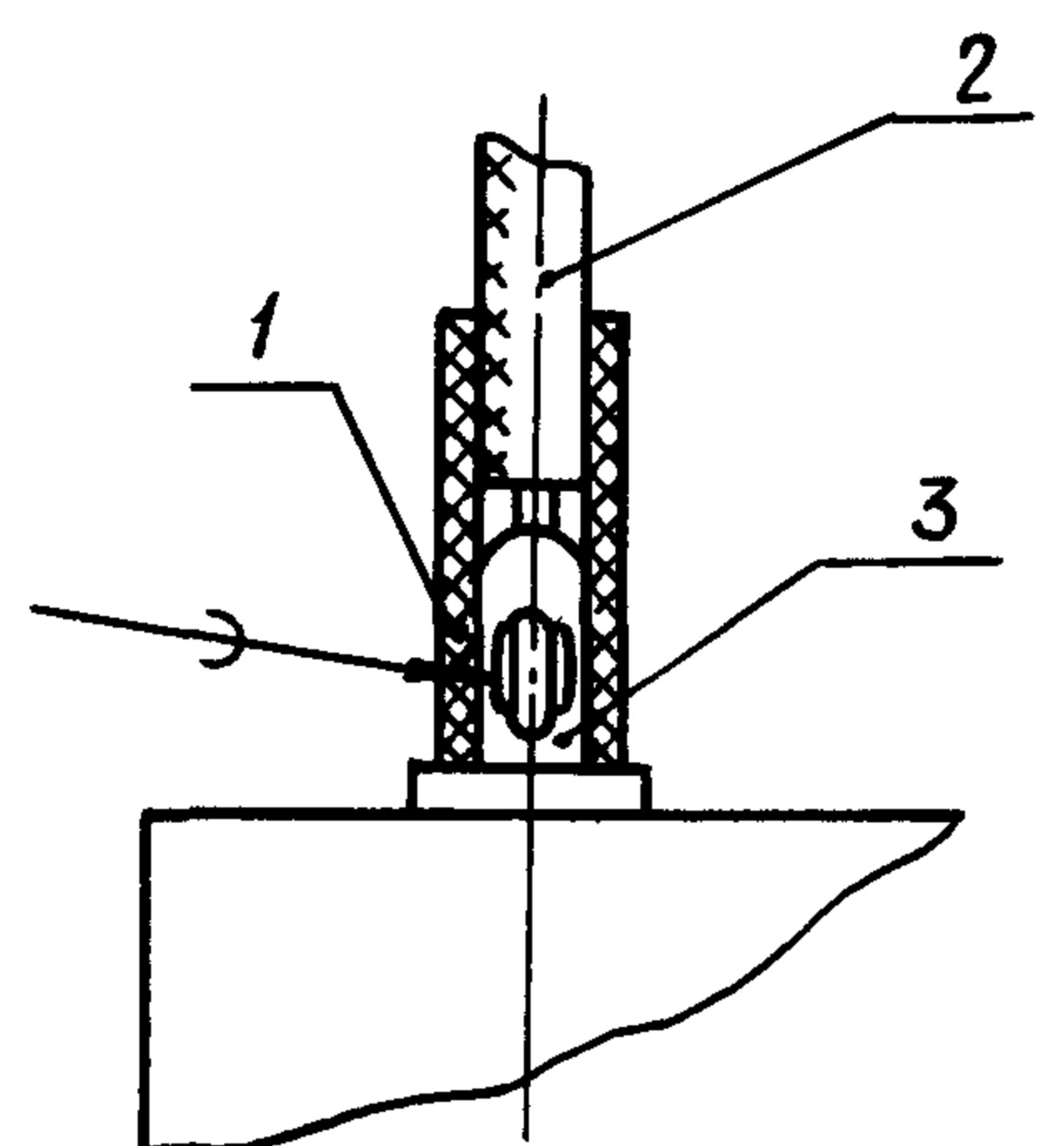
1 - трубка изоляционная; 2 - провод; 1 - вывод; 2 - трубка изоляционная;
