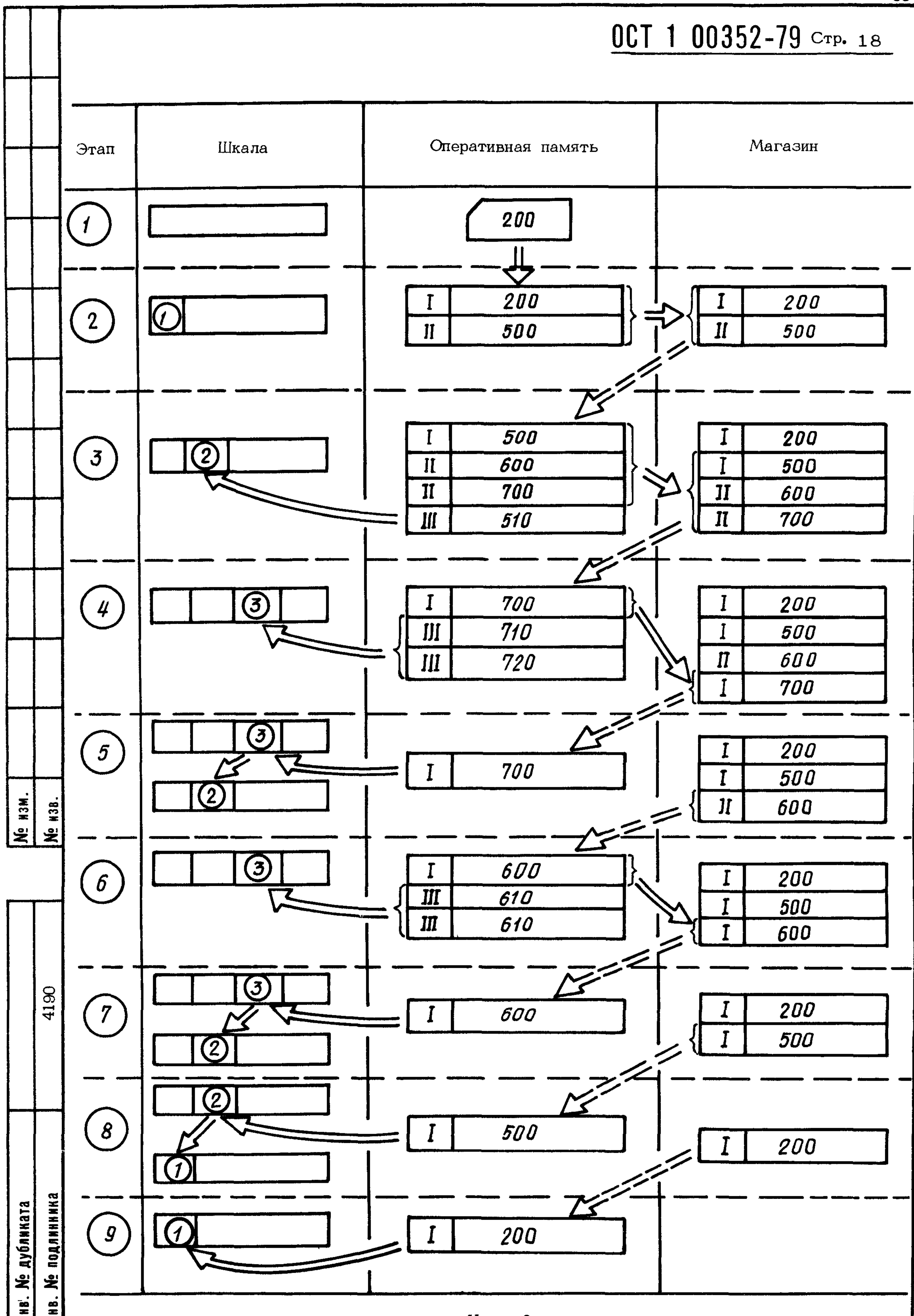
4-й этап. По данным второго поля шкалы и фразы II типа рассчитывается матрица направляющих косинусов углов поворота и координаты положения системы координат сборочной единицы 700 относительно корневой системы координат. Эти данные заносятся в третье поле шкалы. Из фразы II типа выделяется шифр 700, и по нему при помощи каталога из банка данных вызывается абзац с шифром 700. Фраза I типа абзаца заносится в магазин. Фраза III типа обрабатываются и результаты заносятся в третье поле шкалы.
