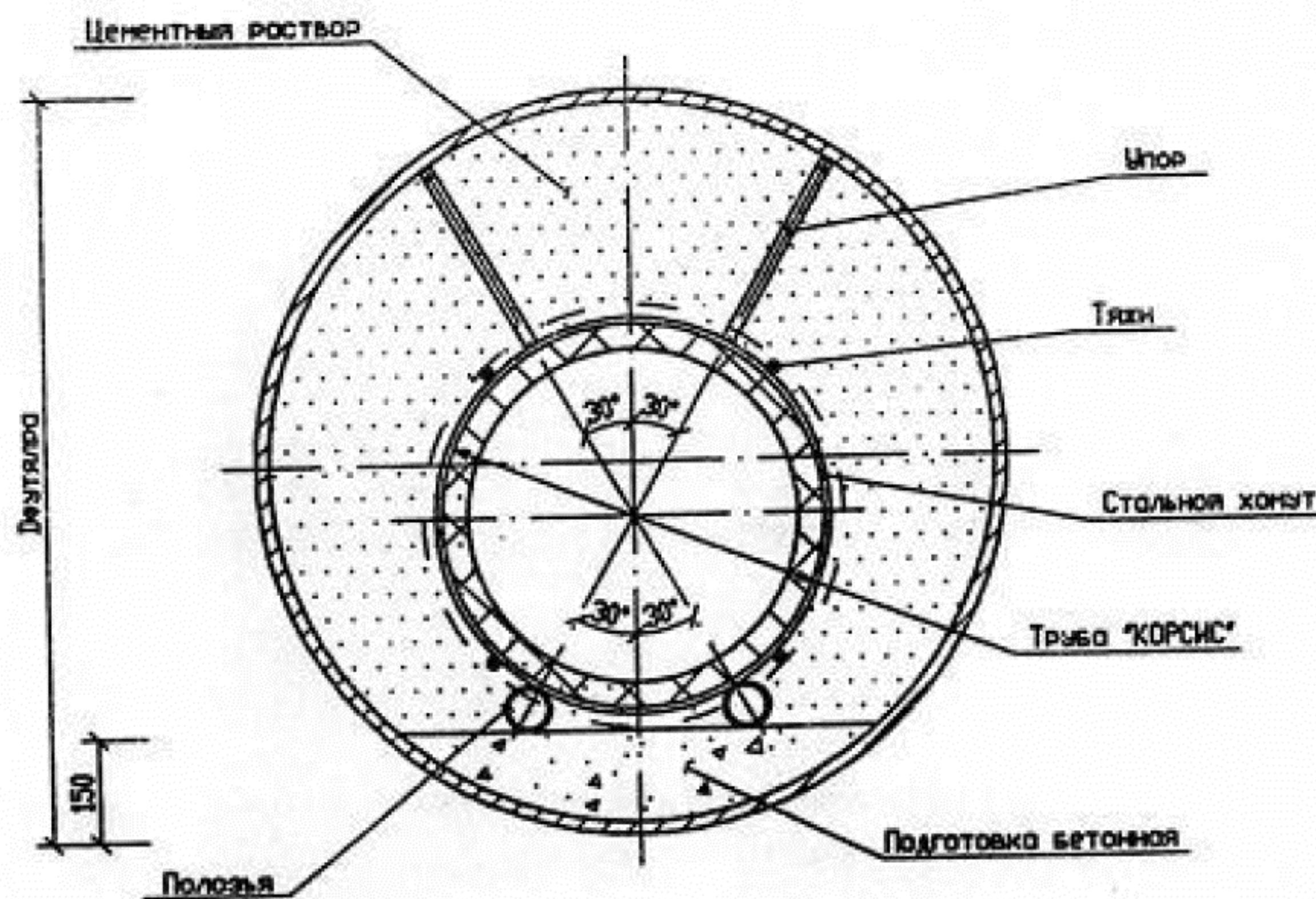
Конструкция ж.б. обоймы на трубах «КОРСИС»
