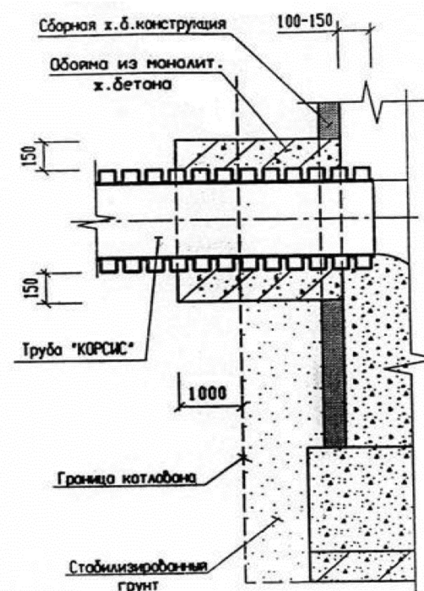
Узлы присоединения трубопроводов из труб «КОРСИС» к типовым канализационным колодцам типа КЛ, ВГ, ВС, ВД
