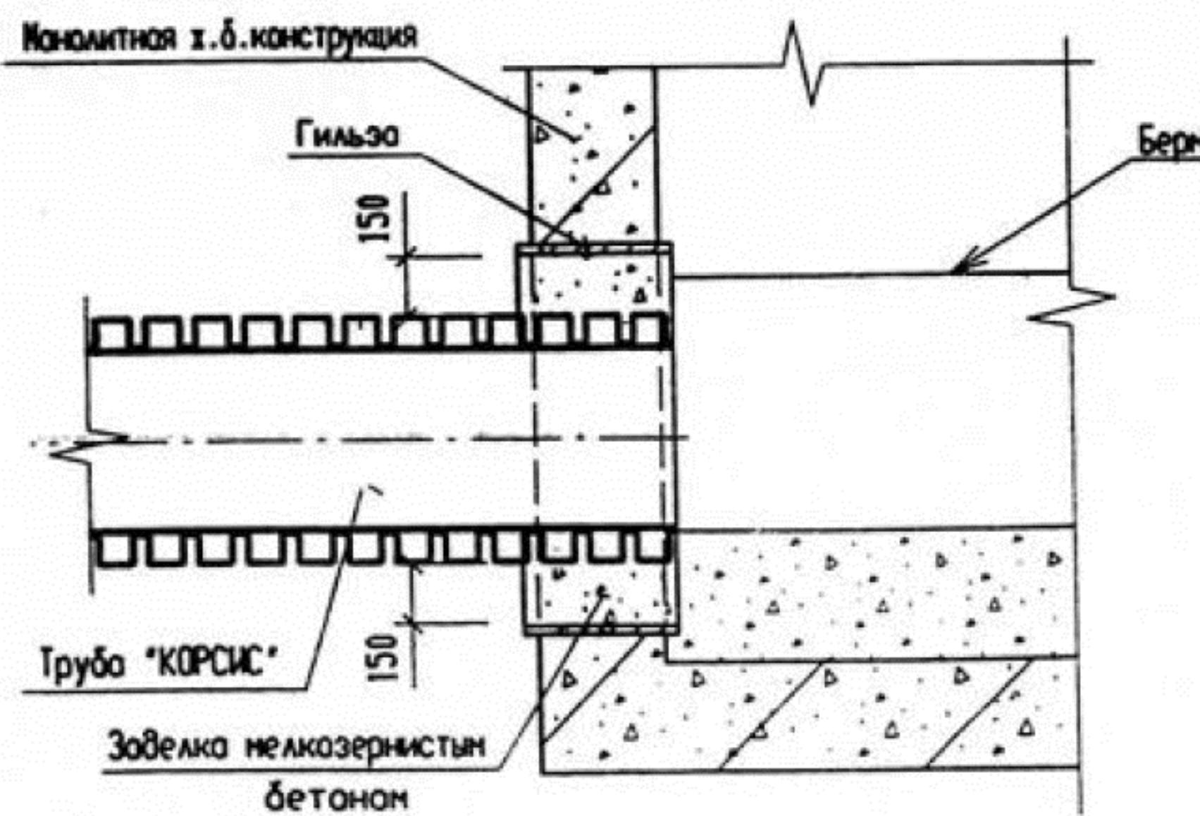
Узлы присоединения трубопроводов из труб «КОРСИС» к колодцам из элементов при устройстве перепадов
