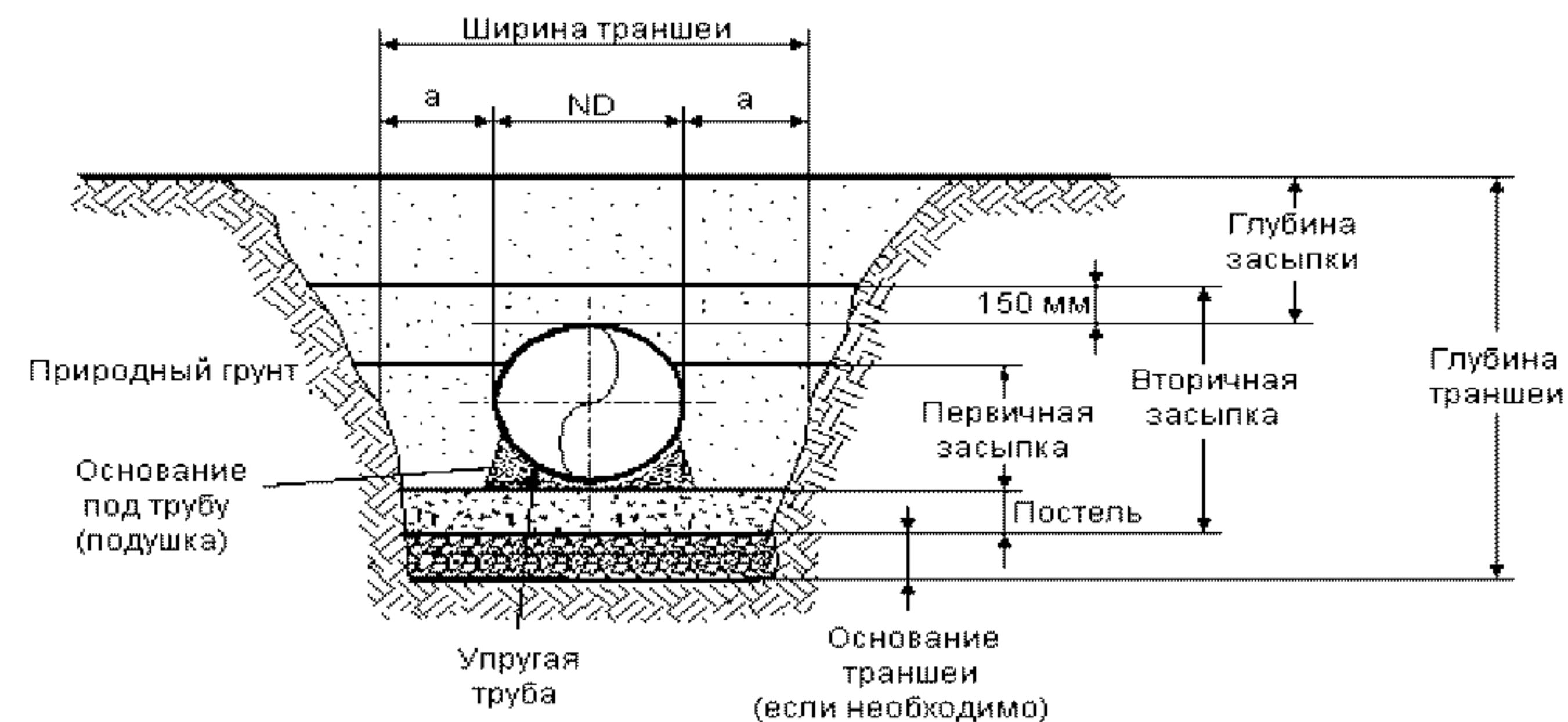
Рис. 3. Общая схема укладки трубопровода. Минимальные размеры:
