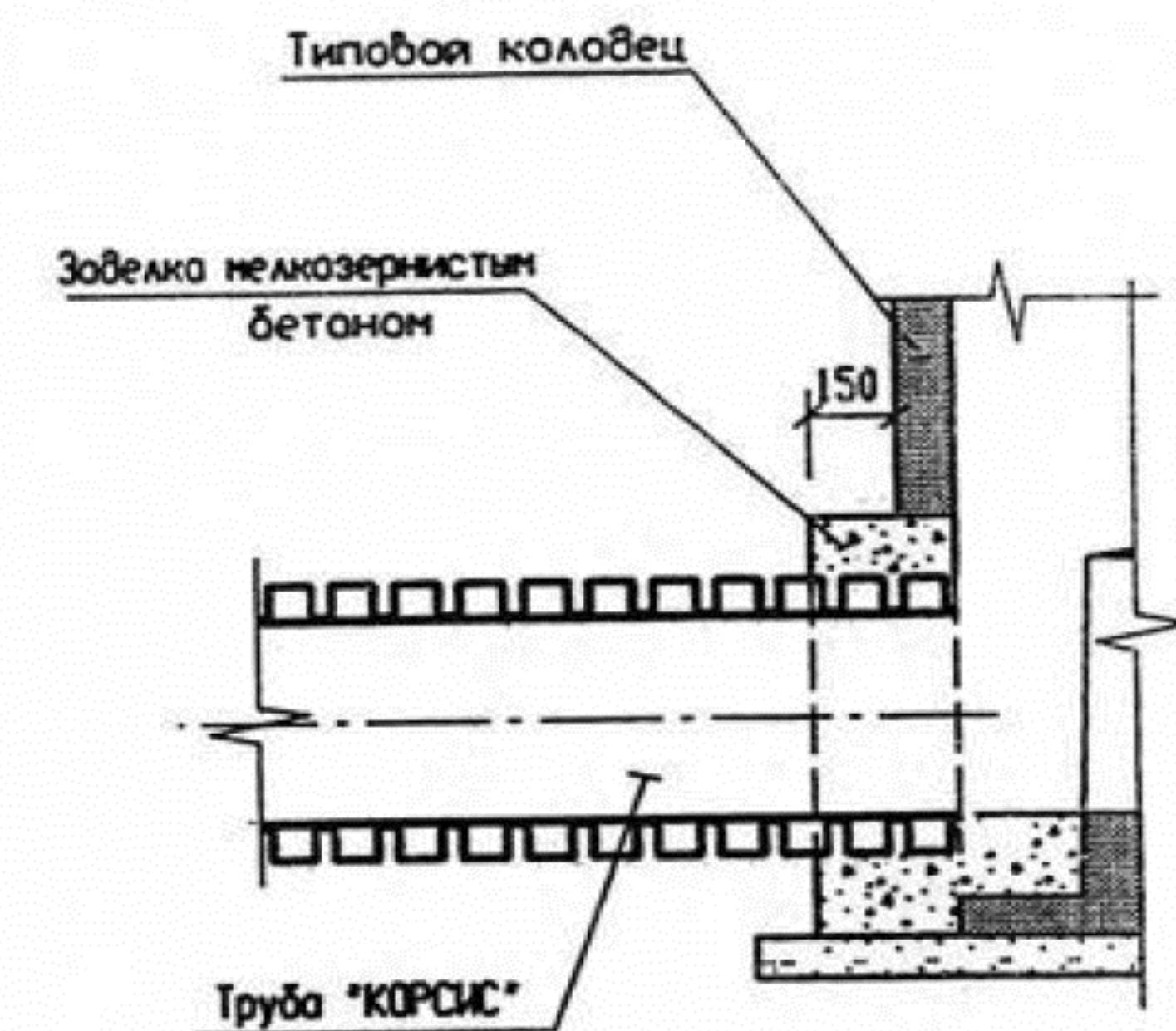
1. Не следует бетонировать трубу «КОРСИС» одновременно с обустройством стен монолитного колодца, т.к. это может вызвать деформацию трубы под тяжестью не застывшего бетона.
