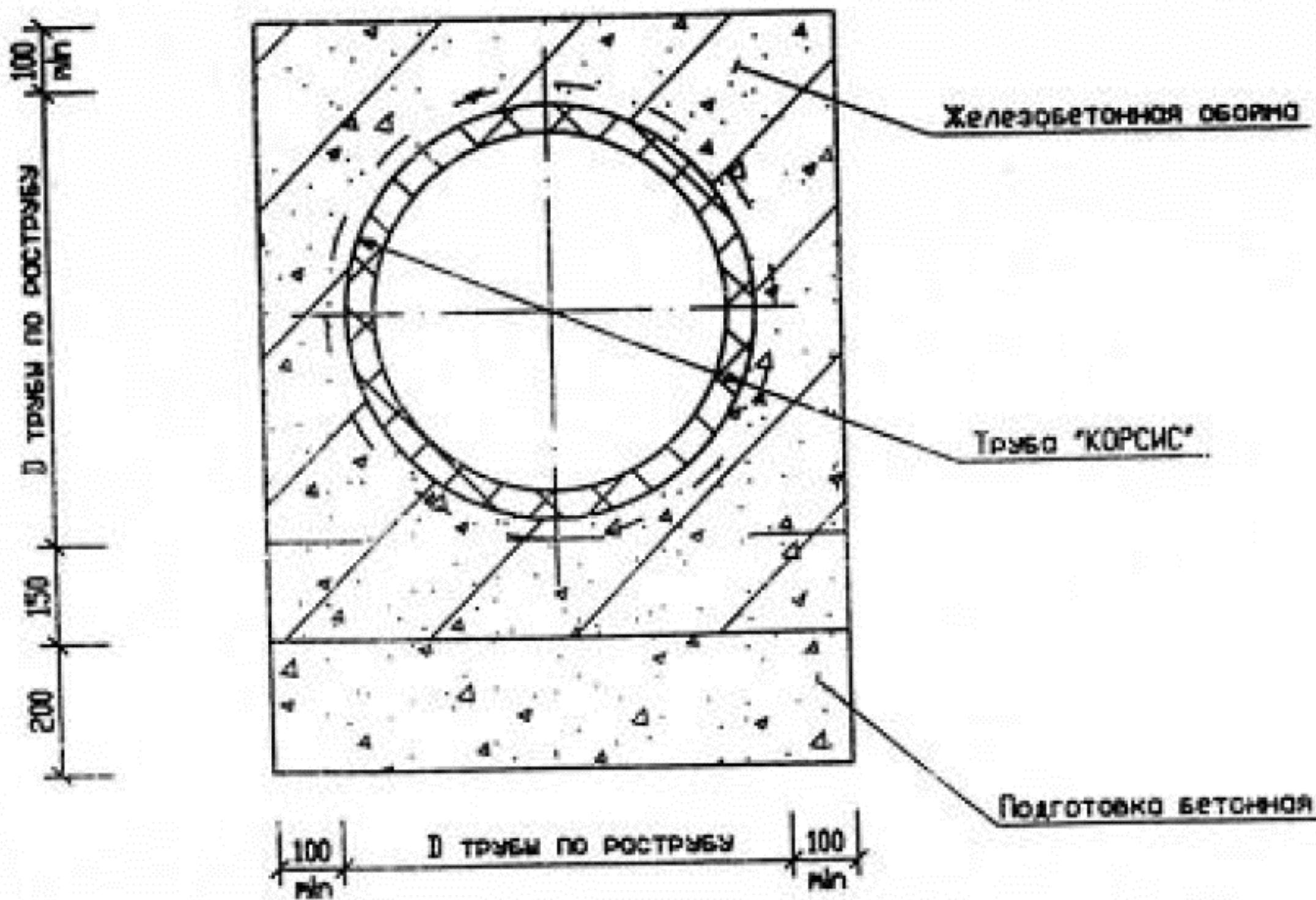
Укладка труб «КОРСИС» в микротоннеле
