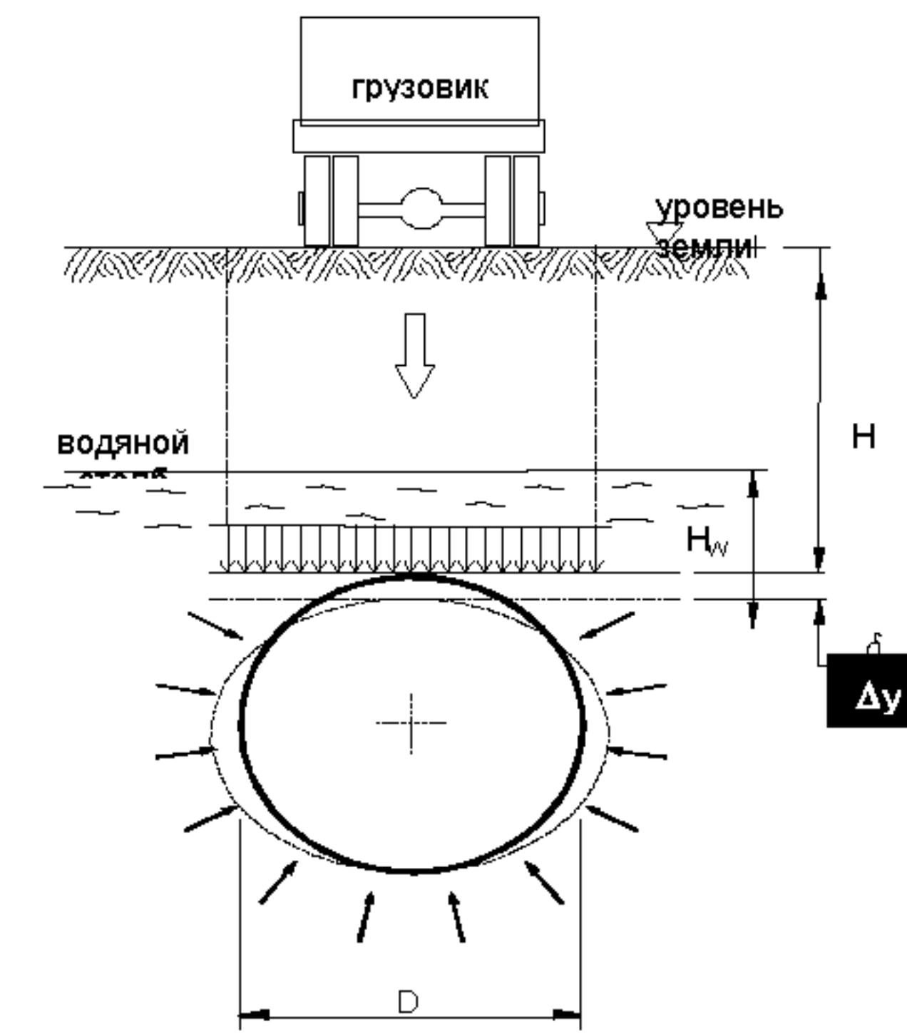
Рис.4. Нагрузки, вызывающие деформацию трубы при сжатии грунта.
