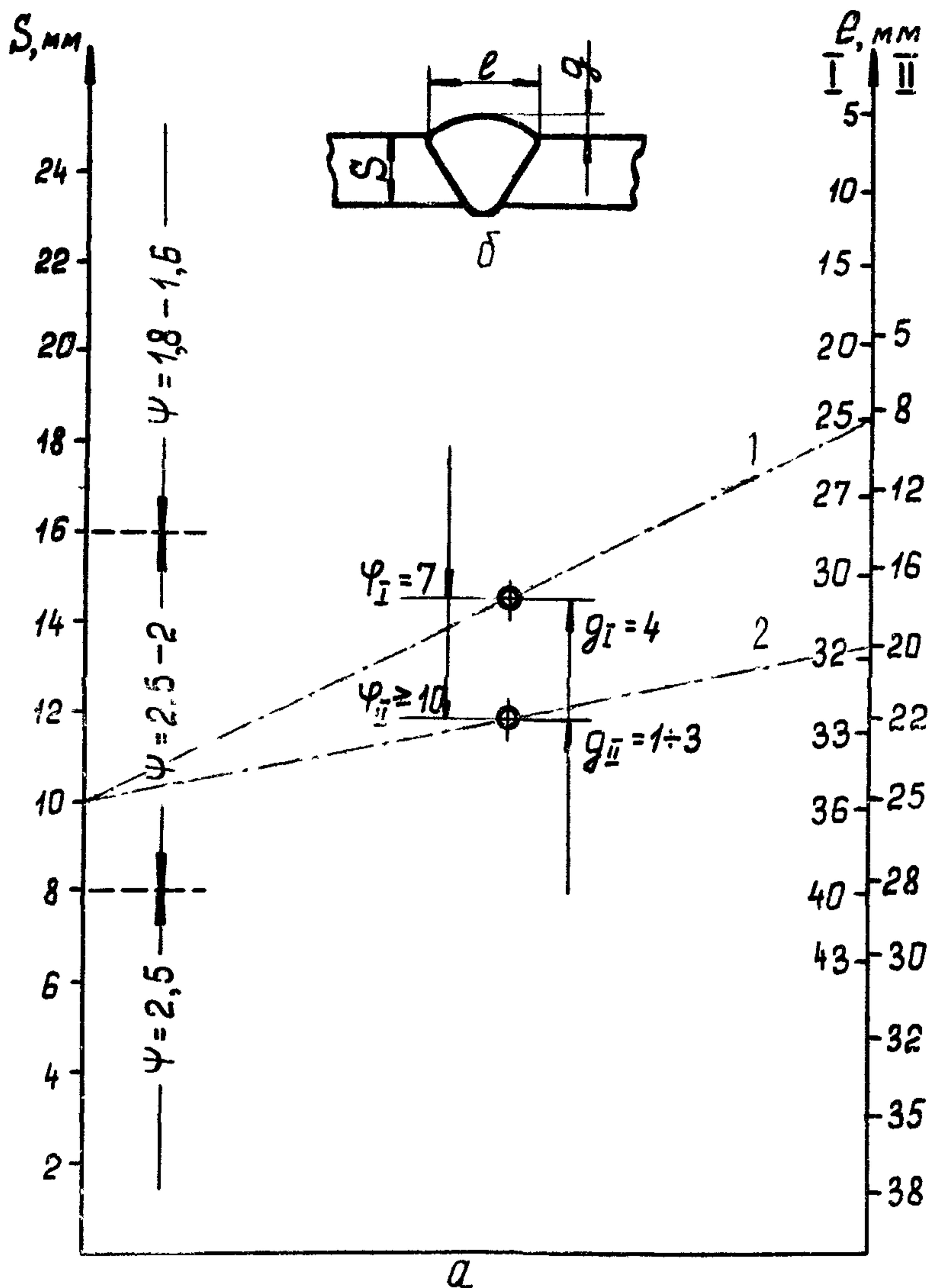
Номограмма для определения параметров стыкового сварного шва
