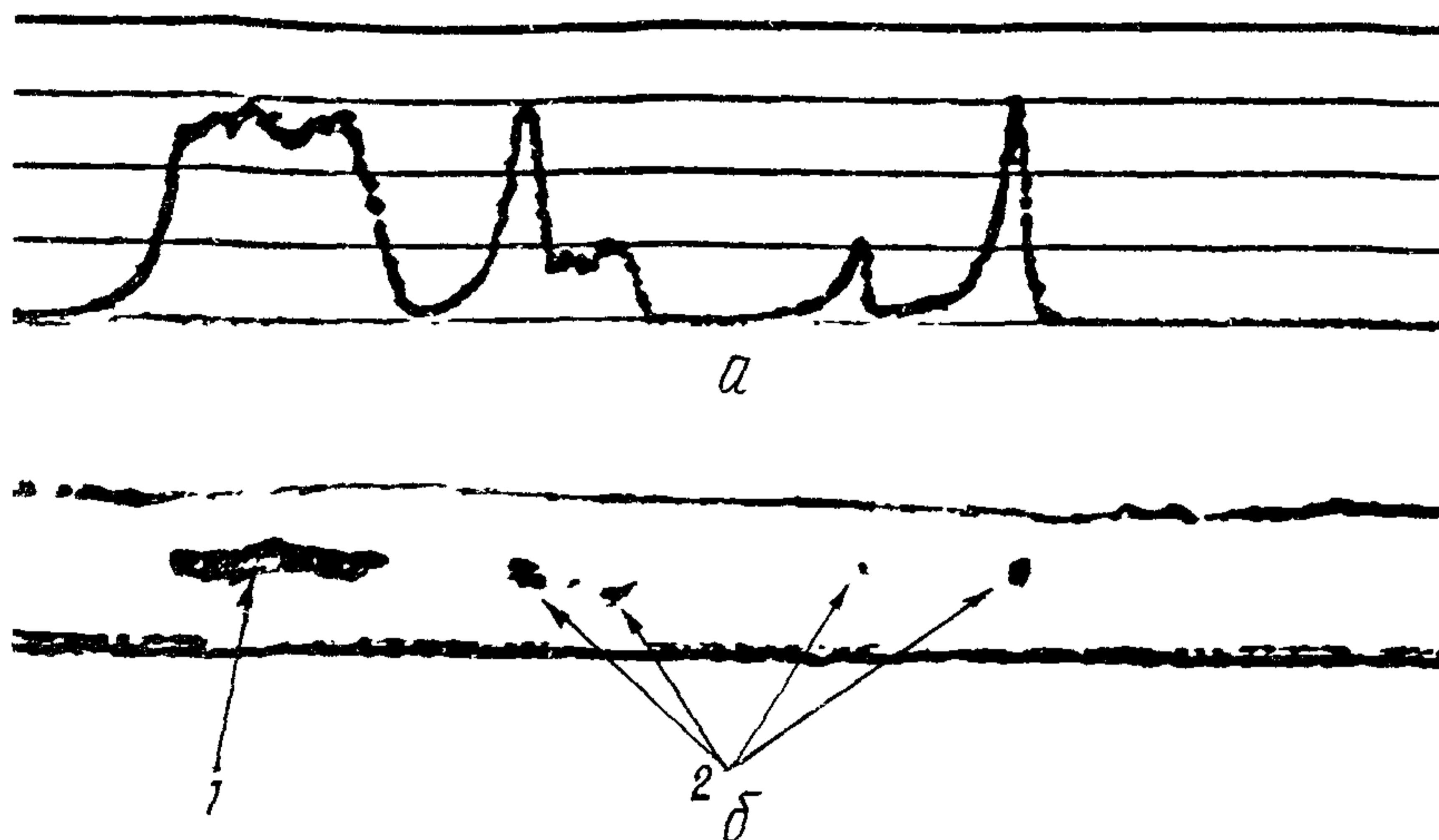
Рис. II. Отрезок регистрационной записи сварного шва, полученной на дефектоскопе МД-20Г:
