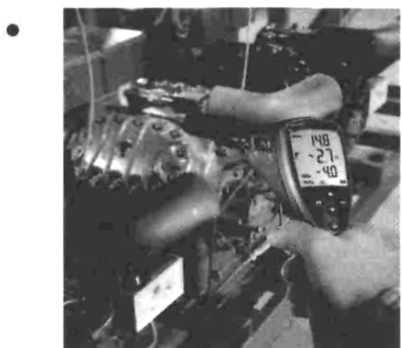
...для определения температуры поверхностей двигателей, корпусов и несущих компонентов больших и малых моторов.
