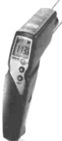
**testo 830 T4**, ИК измерительный прибор температуры с оптикой 30:1 и 2-х точечным лазерным целеуказателем, вкл. батарею и заводской сертификат о калибровке в точках +80 °C и +350 °C
