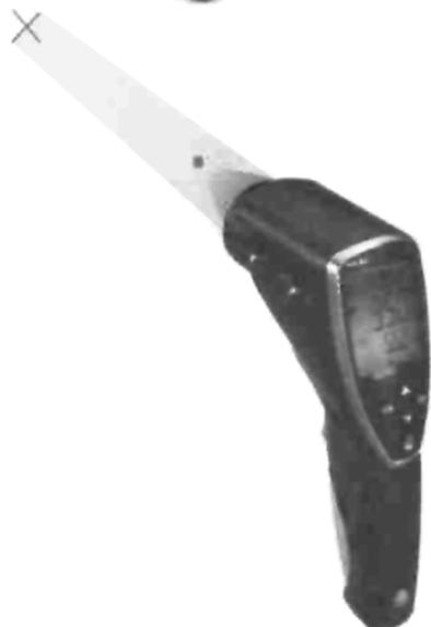
**testo 845**, инфракрасный термометр с перекрестным лазерным целеуказателем, переключаемой оптикой для измерений на близких и дальних дистанциях, разъемом для контактного зонда термопары, оптическим/акустическим сигналом тревоги, памятью измеренных значений, ремнем для переноски, ПО для ПК, USB-кабелем для передачи данных, алюминиевым кейсом, батарейкой и заводским протоколом калибровки
