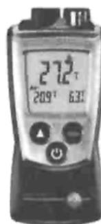
**testo 810**; 2-х каналный прибор измерения температуры с ИК термометром, вкл. лазерный целеуказатель, коэффициент визирования 6:1, встроенный NTC термометр воздуха, вкл. защитную крышку, батарейки и заводской протокол калибровки
