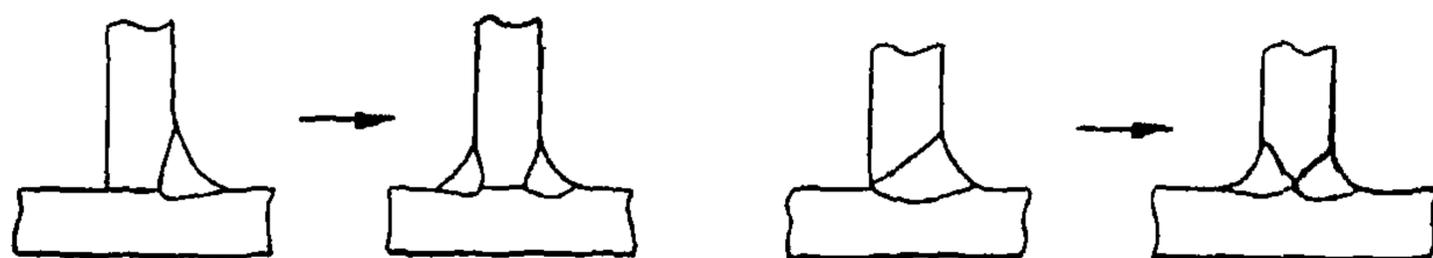
Рисунок 5.4 – Применение симметричных угловых швов
