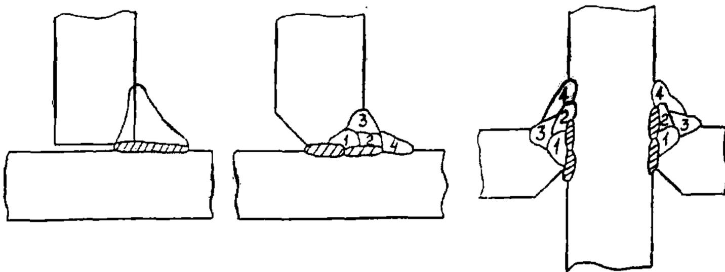
Рисунок 6.2 – Выполнение швов методом «демпфирующих» валиков
