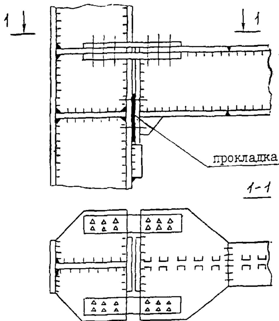
Рисунок В.2 – Болтовое соединение ригеля с колонной с горизонтальными накладками по верхнему поясу «в обход» полки колонны
