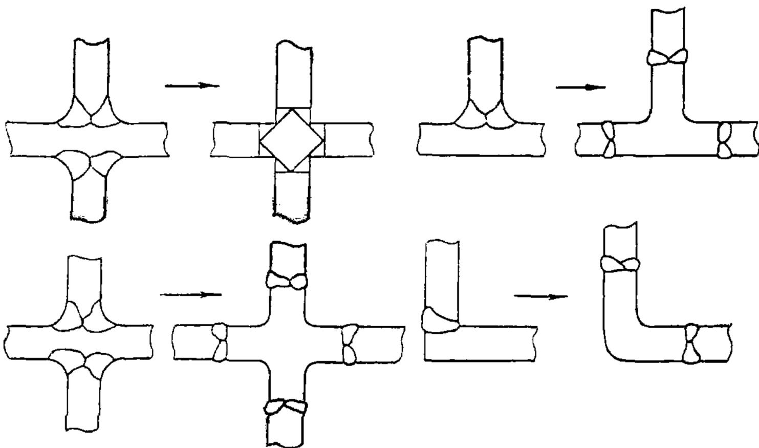
Рисунок 5.5 – Использование вставок из профилей специальной формы
