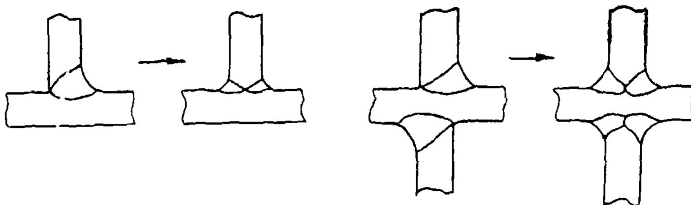
Рисунок 5.3 – Замена одностороннего шва на двухсторонний
