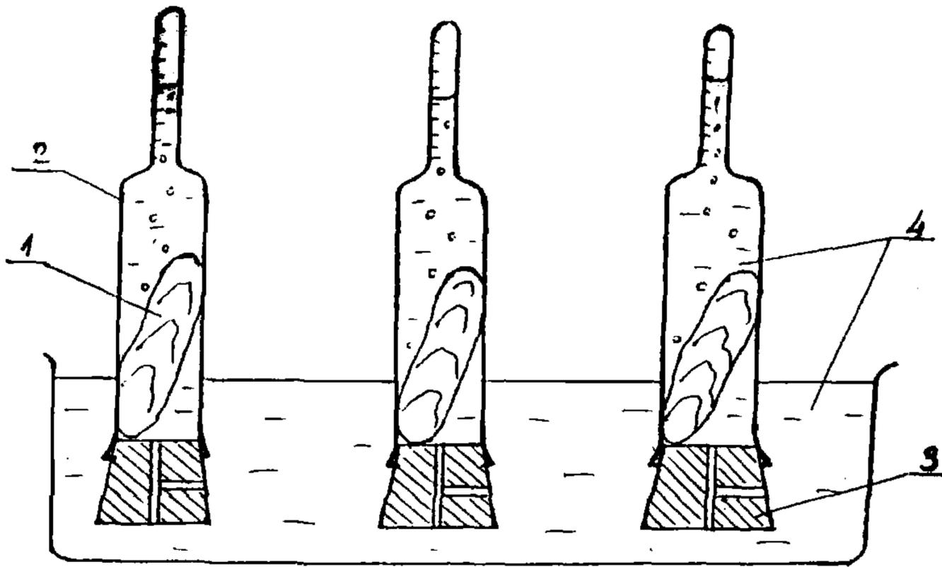
1 – образец; 2 – эвдиометр; 3 – пробка; 4 – спирт
