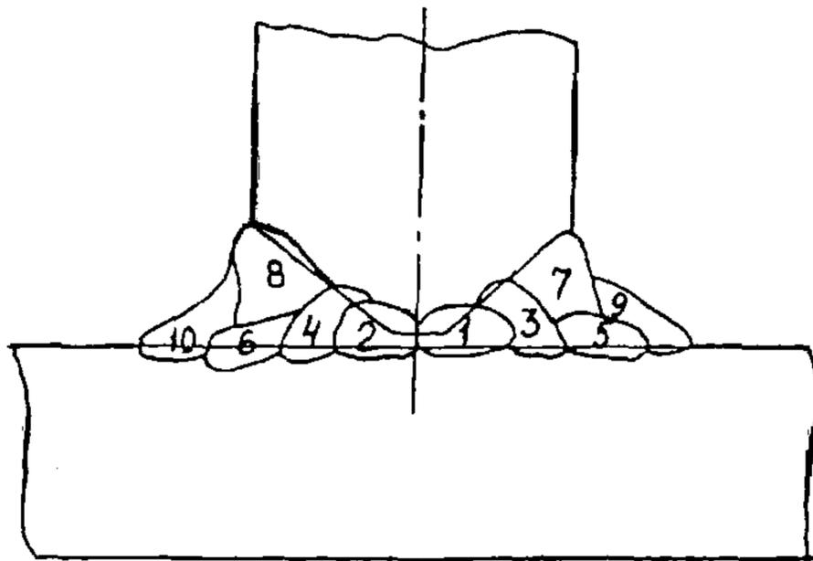
Рисунок 6.1 – Применение метода симметричной сварки
