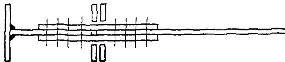
Рисунок В.3 – Болтовое соединение ригеля с колонной с вертикальными накладками, пропущенными в прорези полки колонны и торцевой планки ригеля
