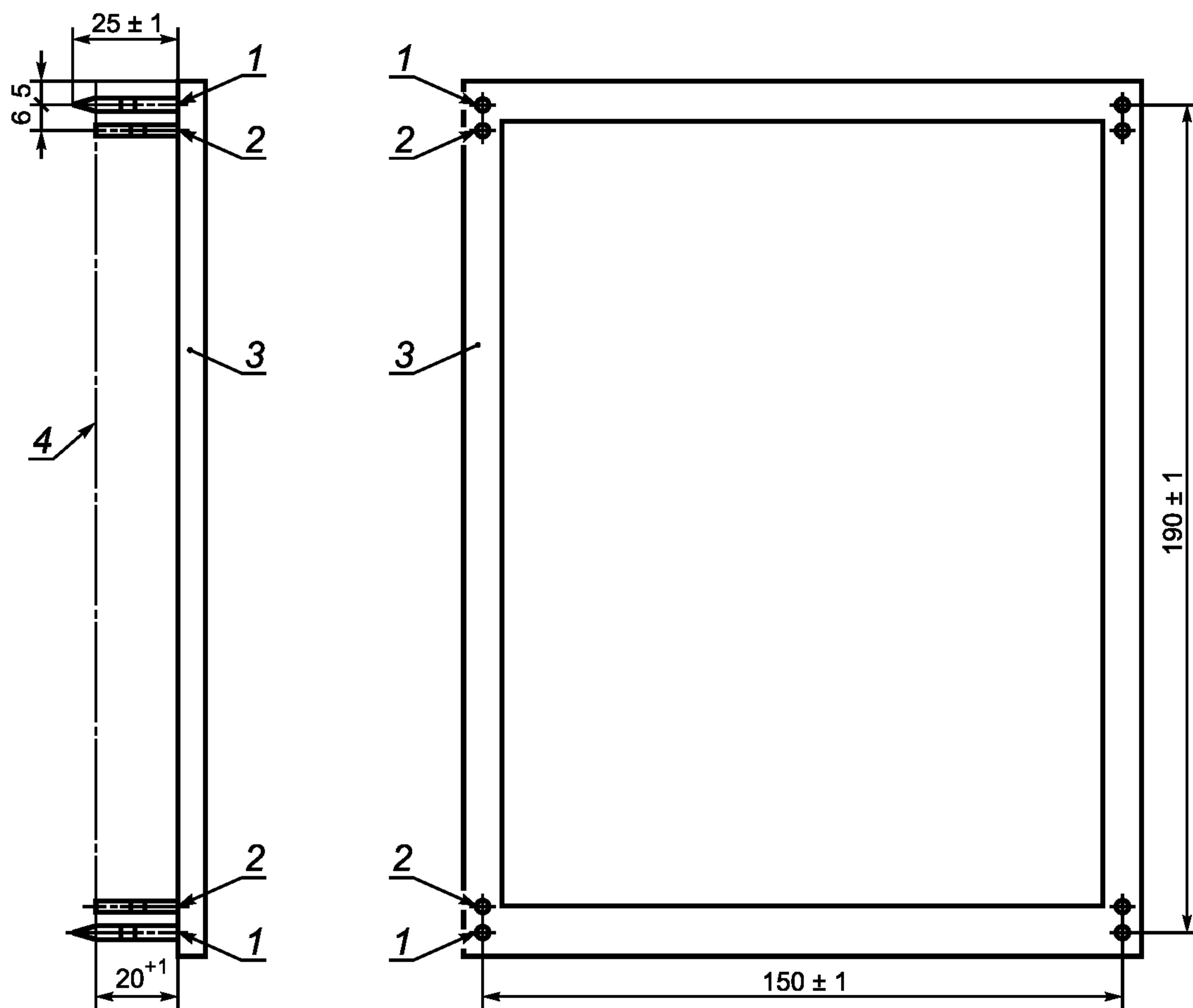
1 — опорный штифт образца диаметром  $(2,0 \pm 0,5)$  мм; 2 — распорный штырь диаметром 2 мм; 3 — монтажная рама;
