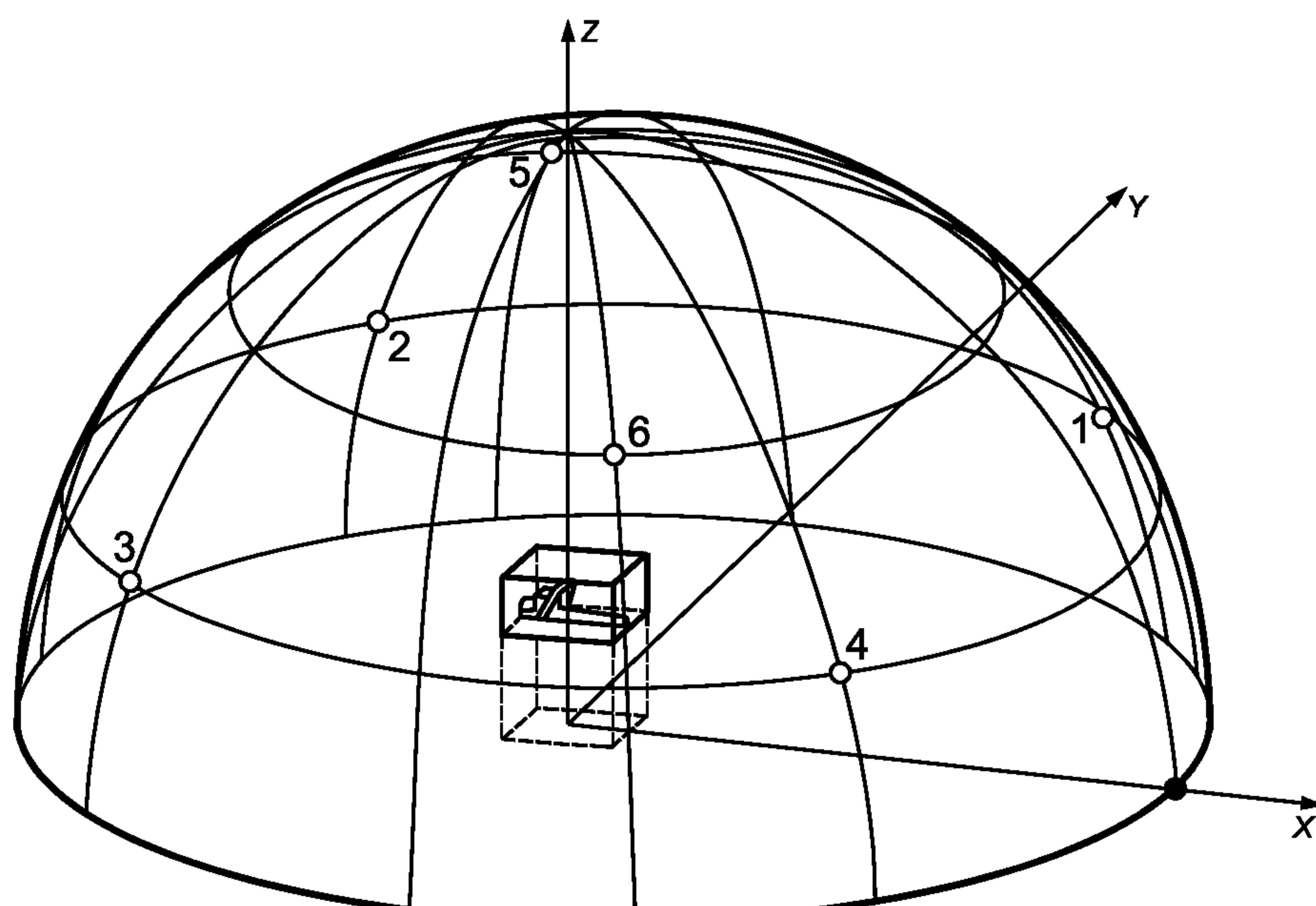
Рисунок 1 — Положения точек измерений на полусфере
