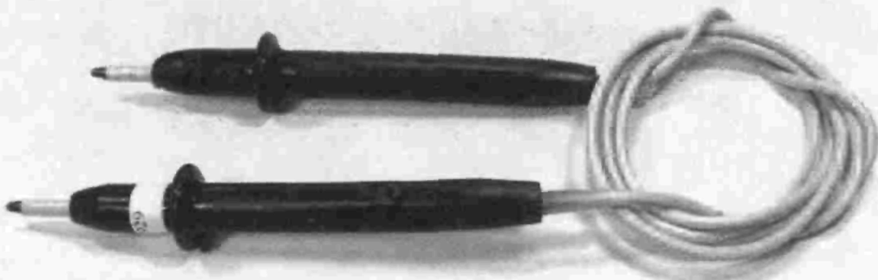
Двухполюсный указатель, выполненный в особо прочном, защищенном от пыли и влаги корпусе, предназначен для определения наличия или отсутствия напряжения в электроустановках постоянного и переменного тока напряжением от 40 до 1000 В. Наличие напряжения индицируется с помощью светодиодов.
