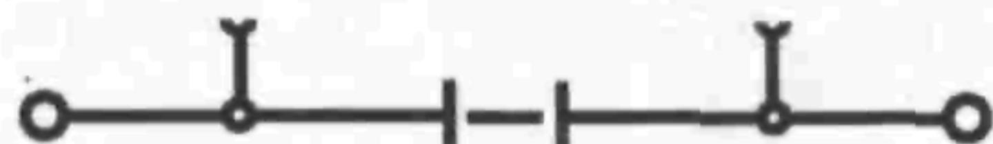
7.2.6.1. Шинные клеммы с размыкателями служат для разрыва токовых цепей, но не под нагрузкой.
