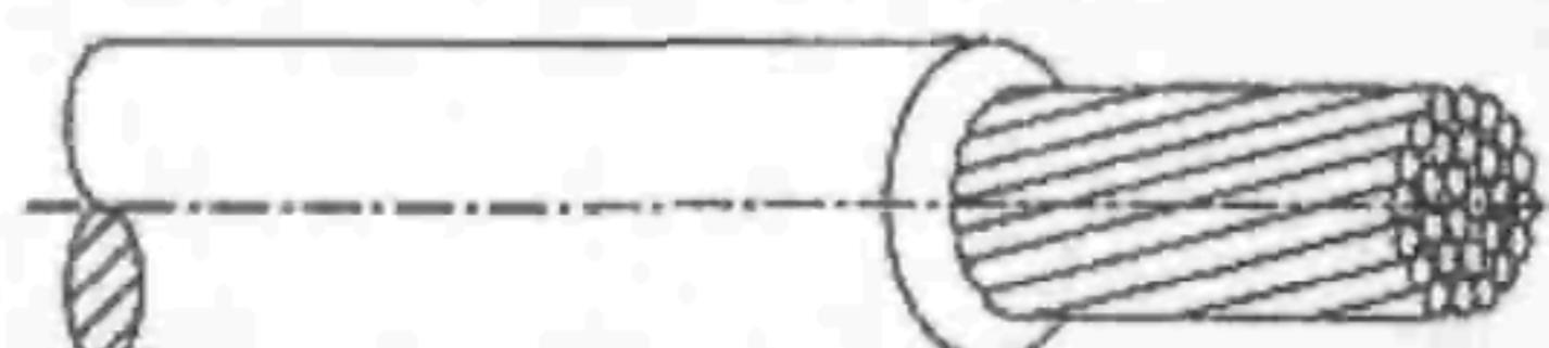
Рис. 10.2.1. Правильно снятая изоляция.
