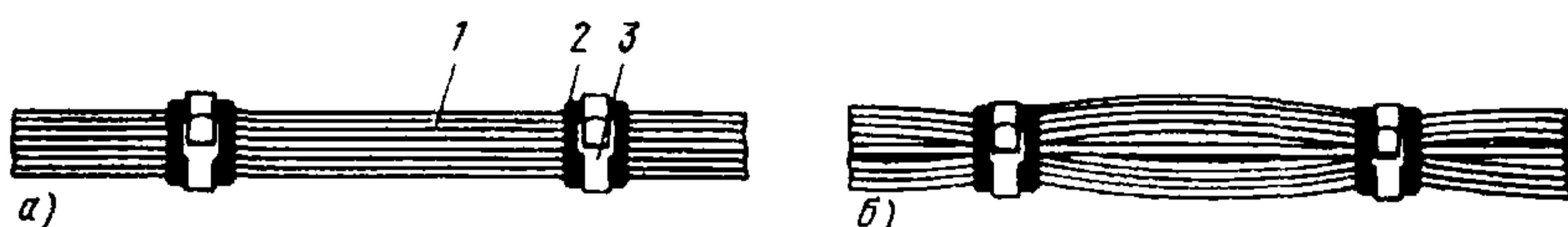
Рис. 1.2. Формирование и бандажирование потока проводов:
