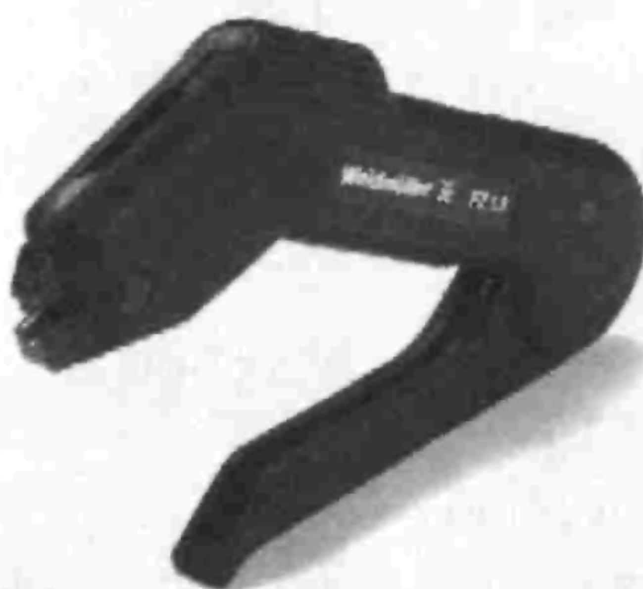
Инструмент для обжима кабельных наконечников с сечением 0,25 - 1,5 мм<sup>2</sup> с пластиковыми втулками или без пластиковых втулок и двойных наконечников с сечением 0,5 - 1,0 мм<sup>2</sup>.
