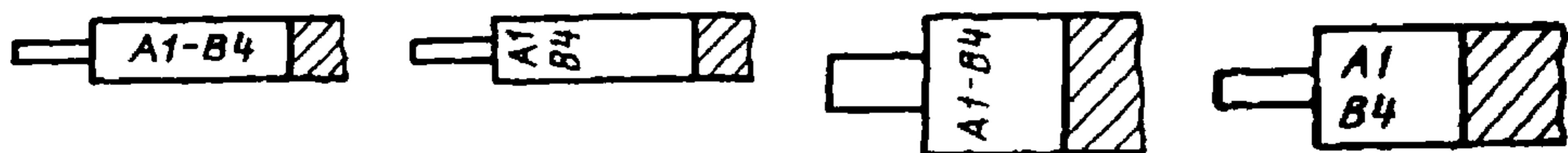
Продольная маркировка в строчку    Поперечная маркировка в колонку    Поперечная маркировка в строчку    Продольная маркировка в колонку
