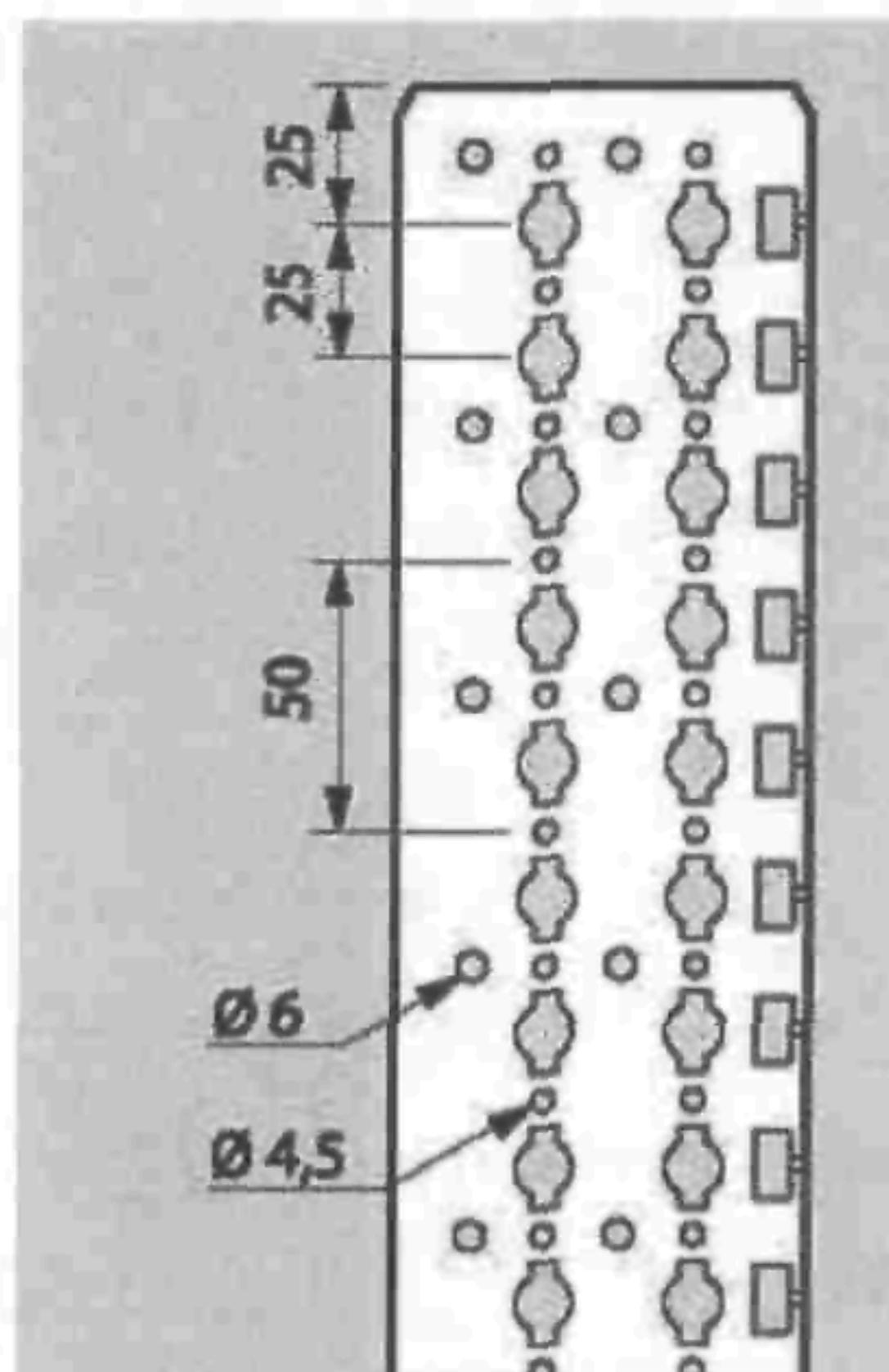
**Рис. 6.1.2.** Отверстия на передней стороне стойки
