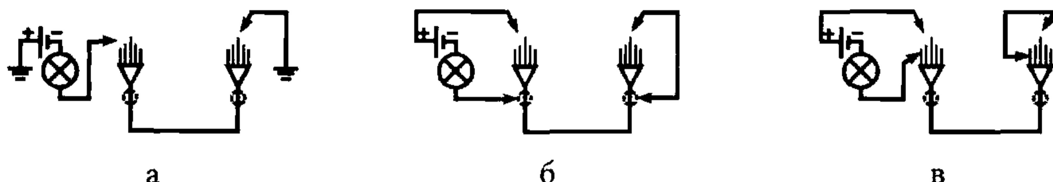
Рис. 9.4.1. Схема прозвонки кабеля пробником:
