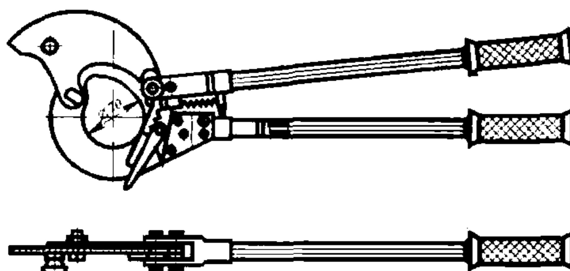
Предназначены для перерезания проводов и кабелей с медными и алюминиевыми жилами, в том числе и бронированных.
