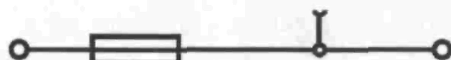
7.2.2.1. Клеммы с предохранителем состоят из клеммного основания и держателя предохранителя.
