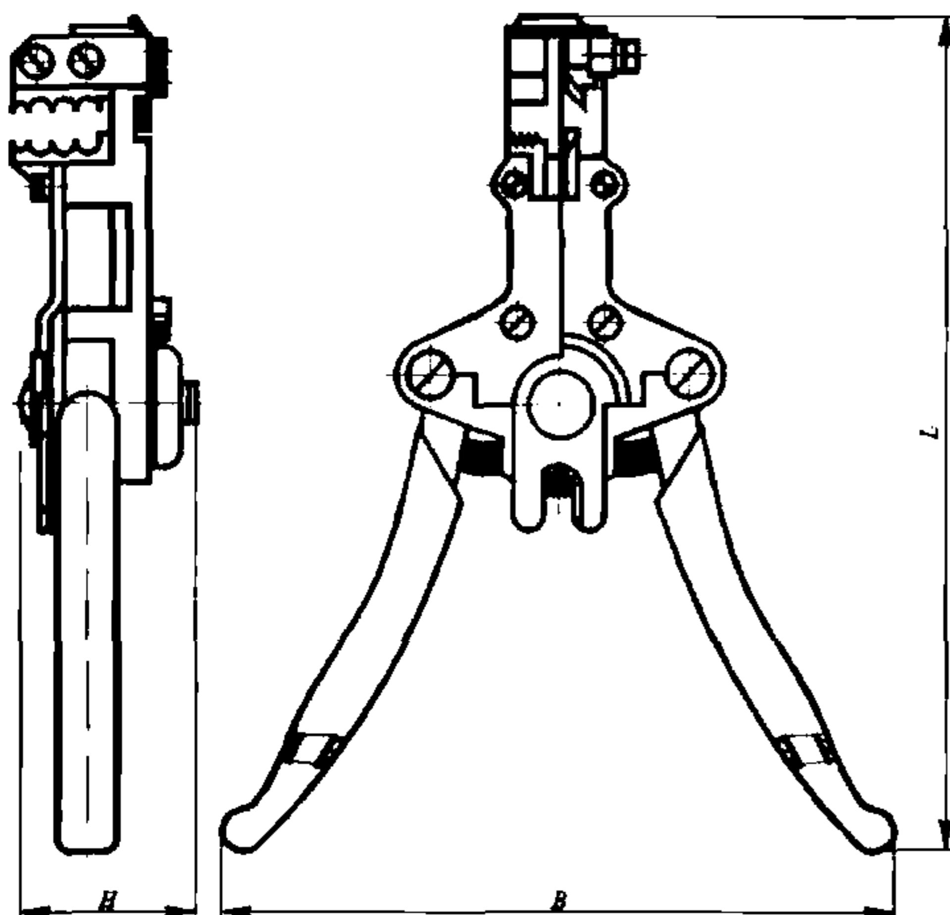
Инструмент МБ-1М предназначен для снятия резиновой и пластмассовой изоляции с круглых проводов и их перерезания. Обеспечивает быстрое снятие изоляции без нарушения целостности токоведущих жил.
