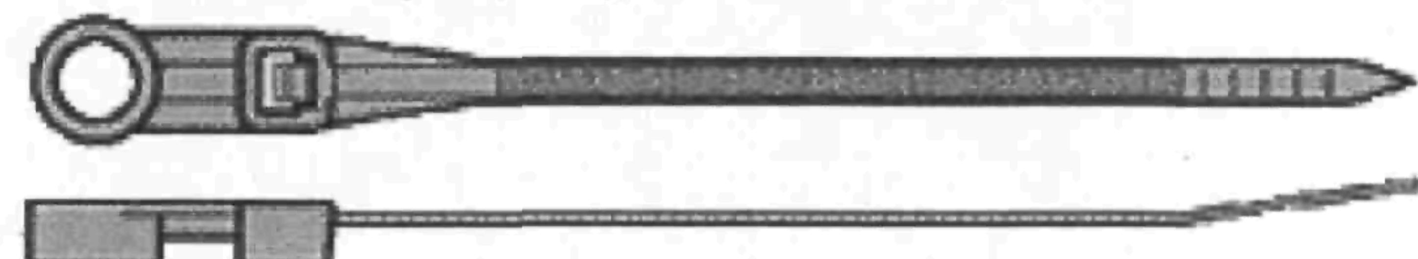
5. Стяжки (хомуты) с анкерным креплением (одноразовые и многоразового использования).
