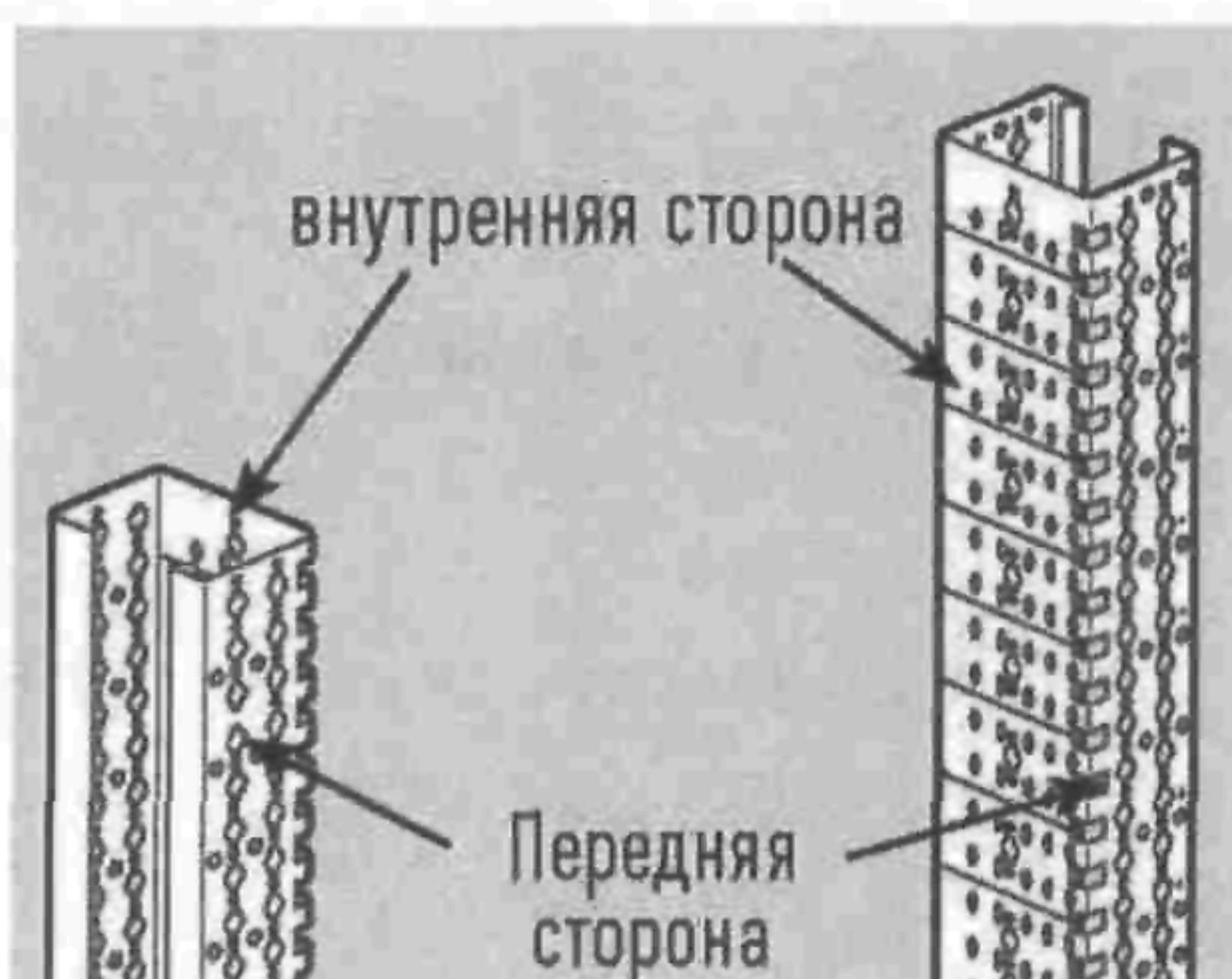
**Рис. 6.1.1.** Стороны перфорированных монтажных стоек
