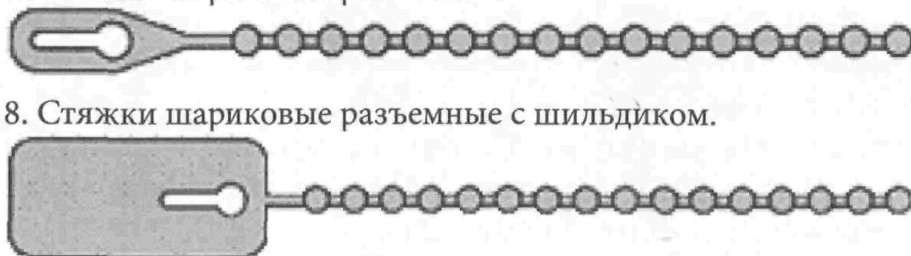
8. Стяжки шариковые разъемные с шильдиком.
