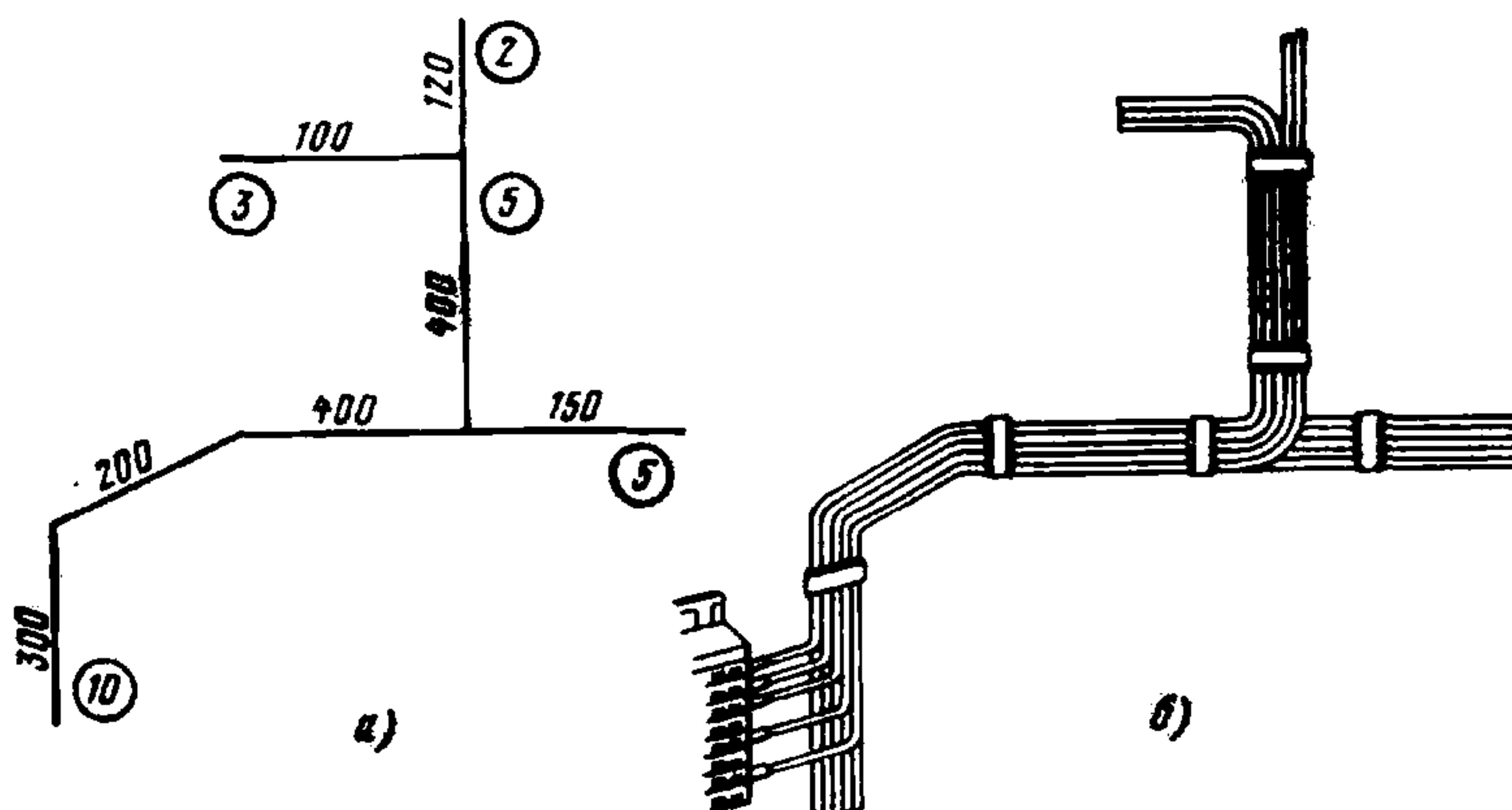
Рис. 4.1. Эскизы для заготовки проводов
