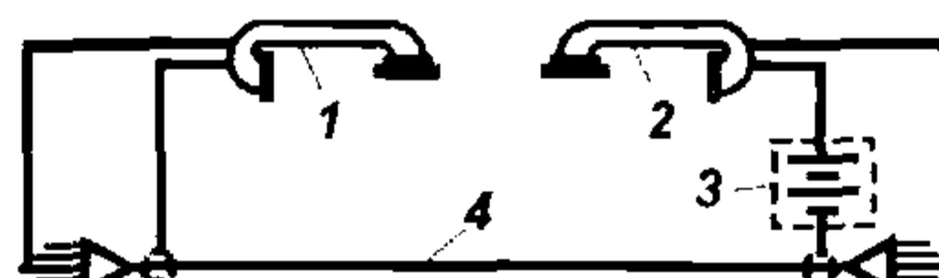
Рис. 9.4.2. Схема прозвонки кабеля с помощью телефонных трубок
