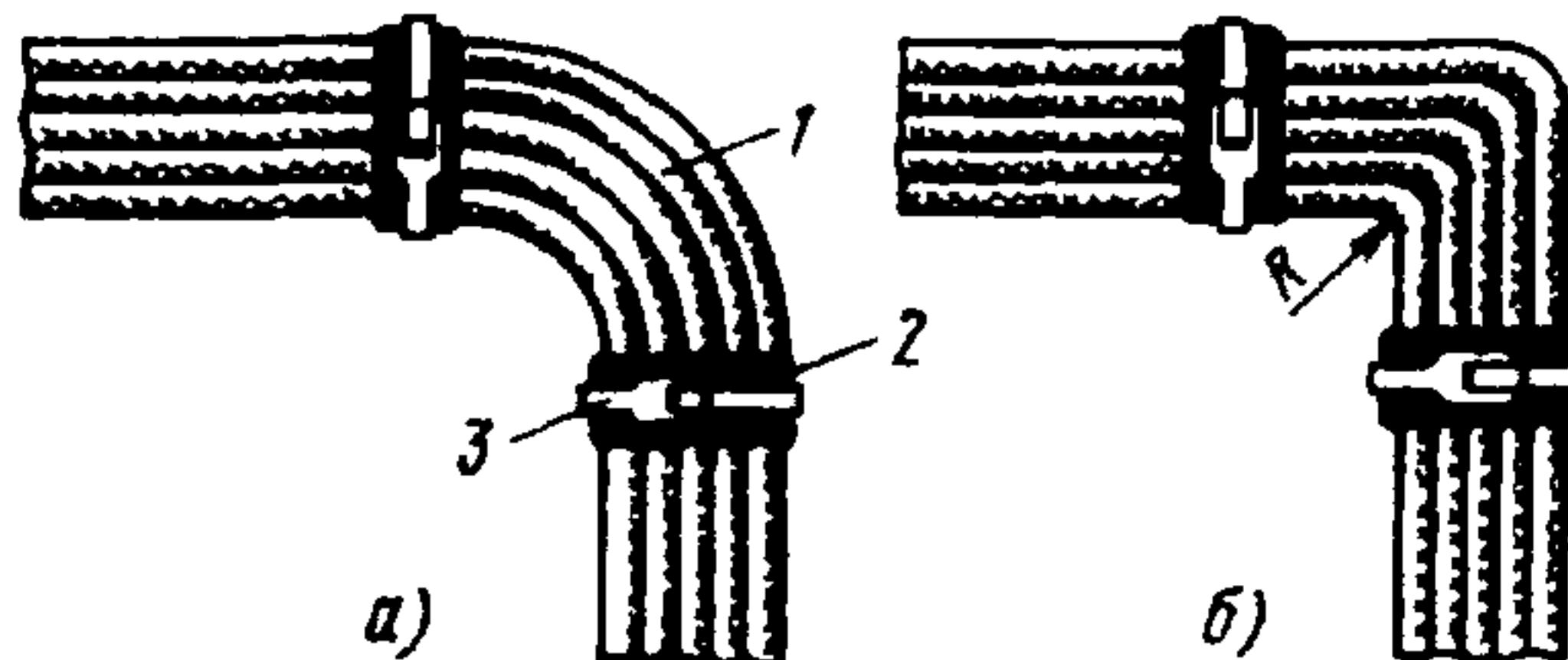
Рис. 1.3. Выполнение поворота потока проводов на 90°:
