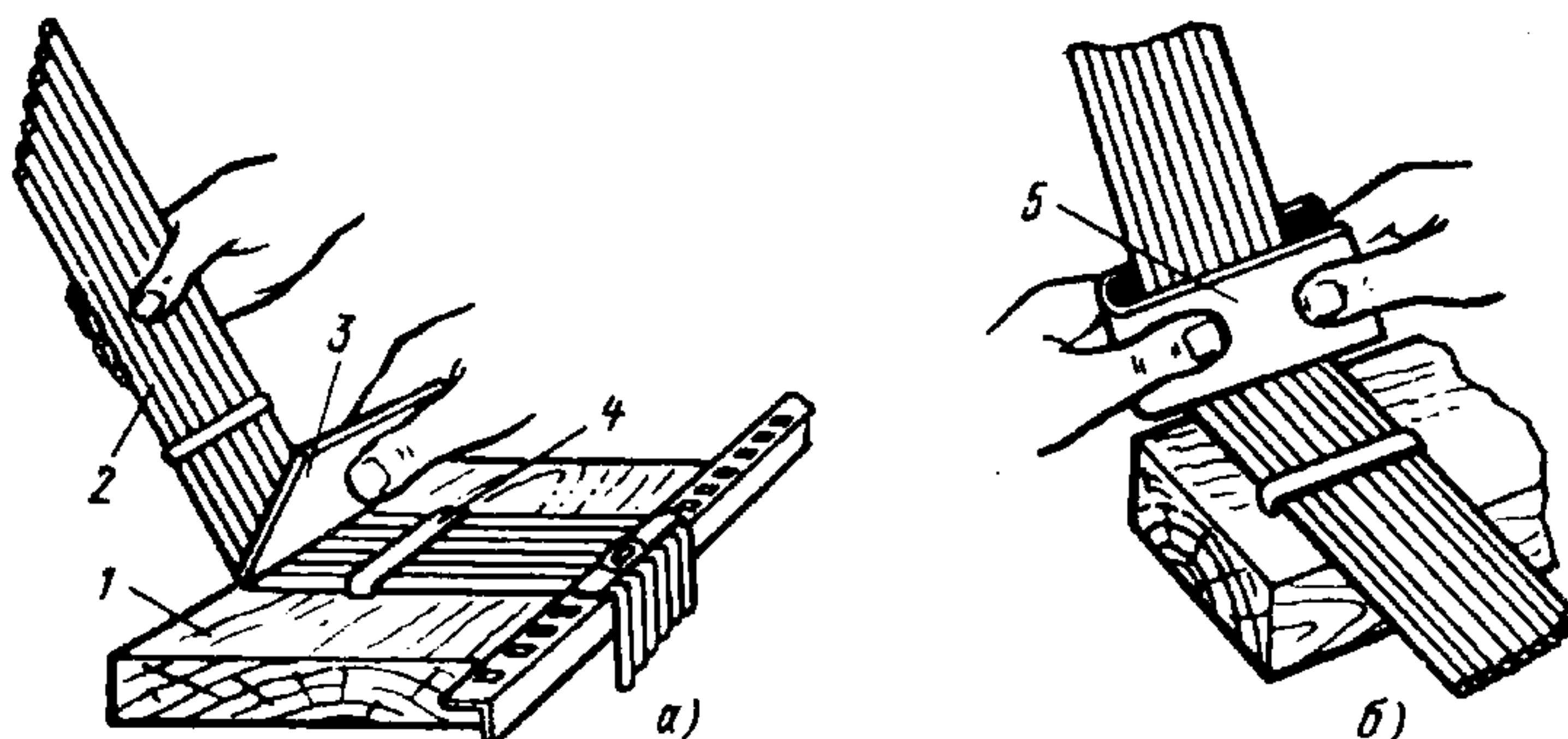
Рис. 4.3. Изгибание потока проводов на плоскость
