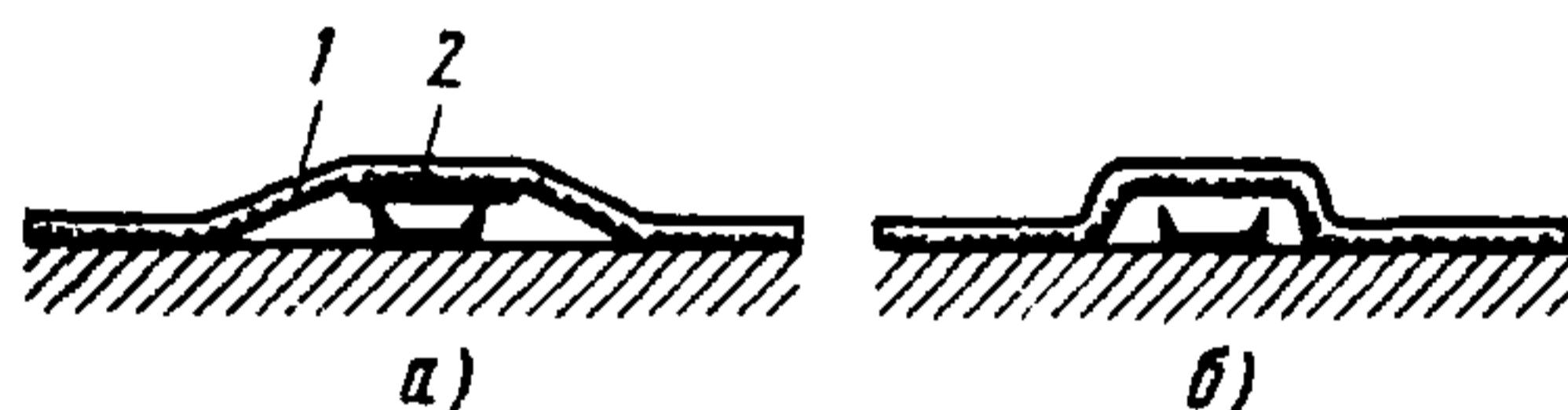
Рис. 1.1. Выполнение обхода препятствий проводом (жгутом проводов):
