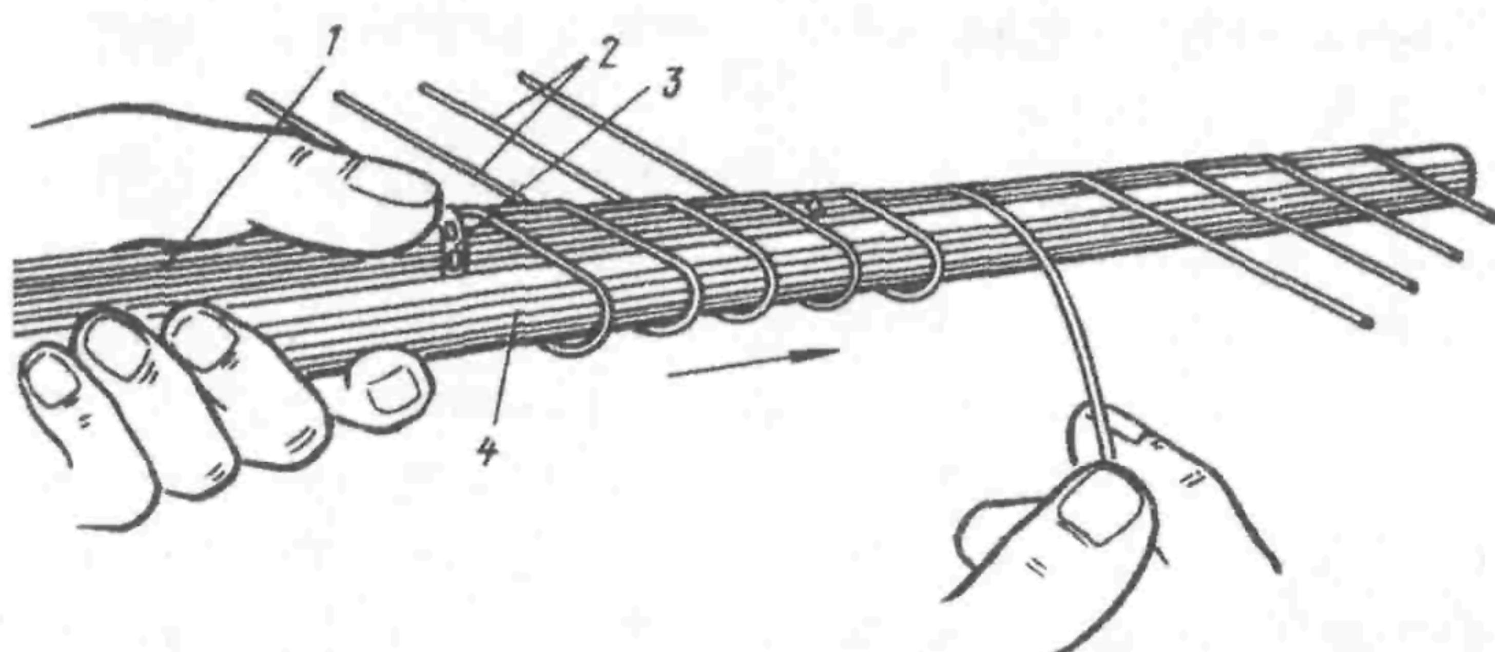
Рис. 8.1.3. Применение линейки-шаблона для изгибаия жил, отходящих от потока проводов к наборным зажимам:
