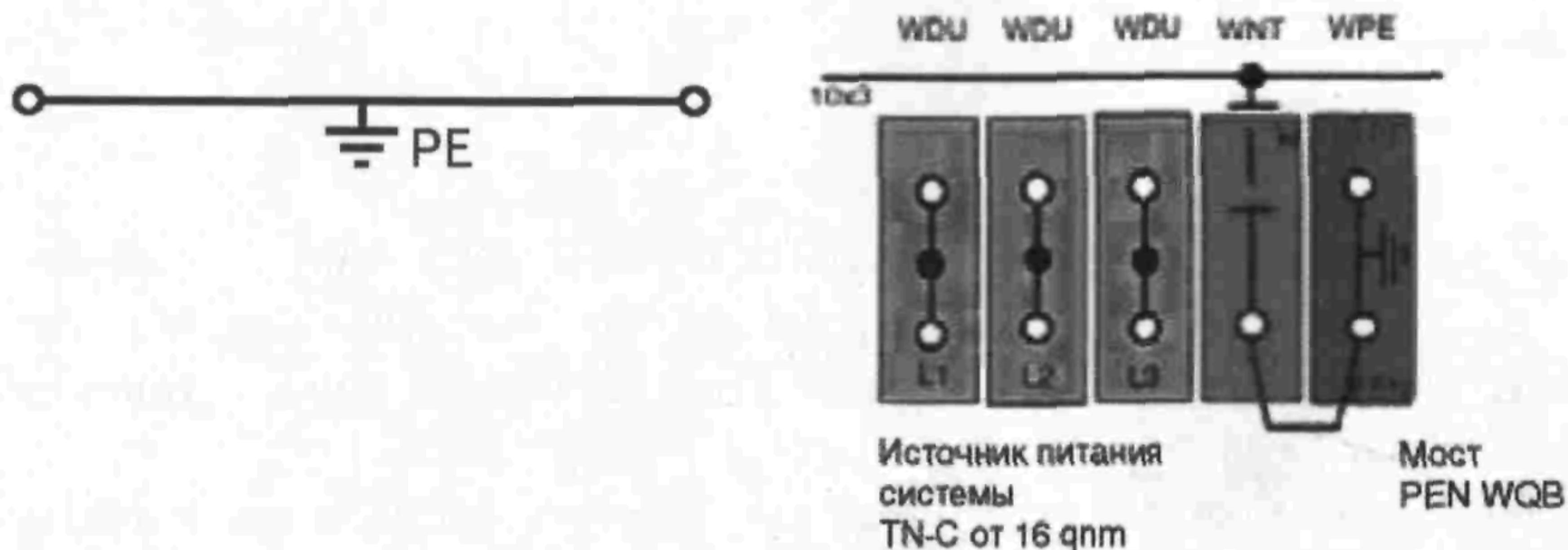
7.2.1.1. Клемма PE - компонент с одной или несколькими положениями захима для подсоединения и/или разветвления проводников PE при помощи проводящего соединения с их опорой. Несущие рейки для наборных клемм часто применяются в качестве сборных защитных проводников. Защитные клеммы PE образуют соединение с несущей DIN-рейкой.
