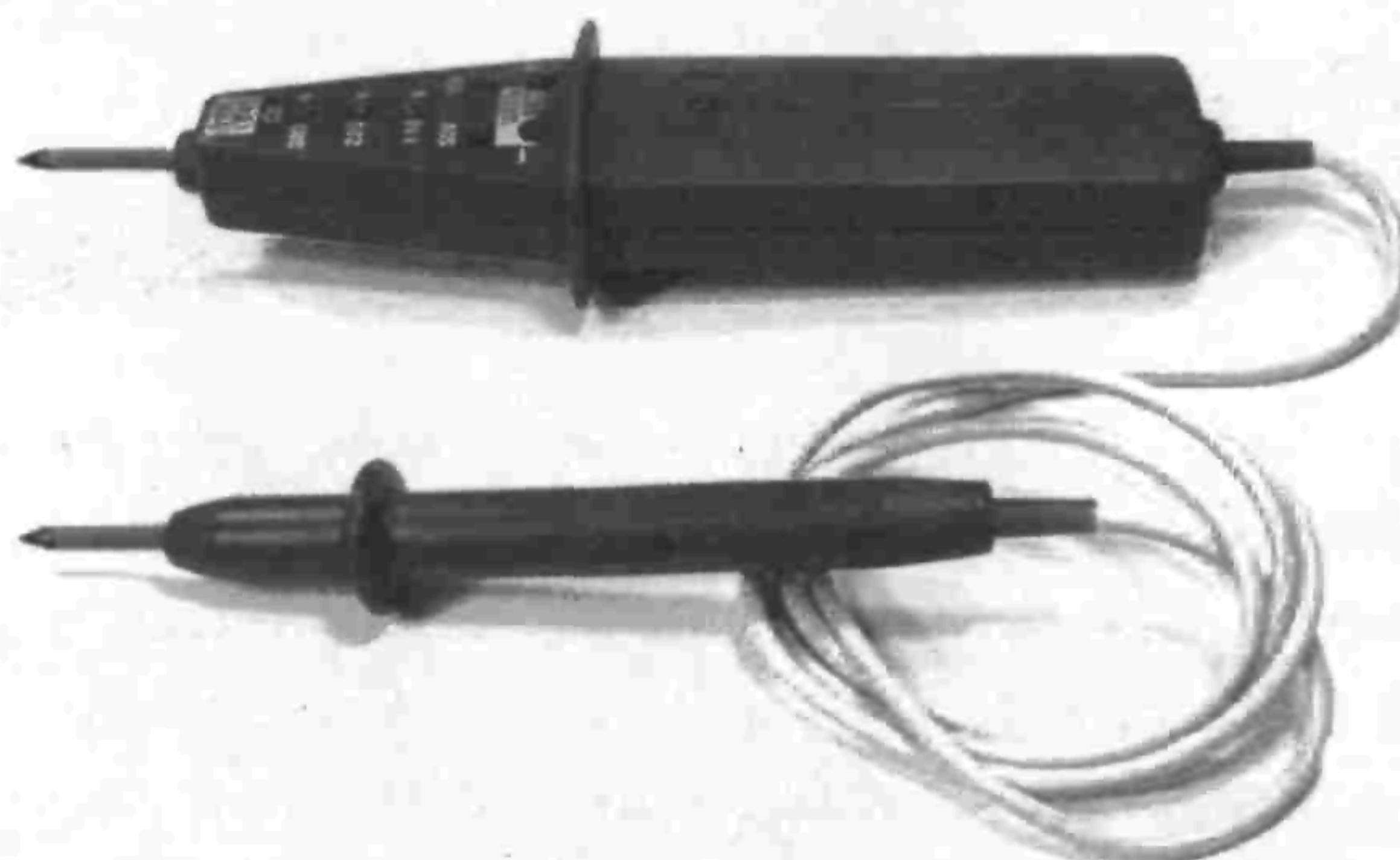
Двухполюсный указатель предназначен для определения наличия или отсутствия напряжения постоянного и переменного тока от 12 до 380 В, определения полярности напряжения постоянного тока и фазы сети переменного тока, а также для проверки электрической цепи сопротивлением до 20 кОм. Наличие напряжения и электрической цепи индицируется с помощью светодиодов повышенной яркости и пьезоизлучателя звука. Корпус указателя выполнен из ударопрочного полистирола.
