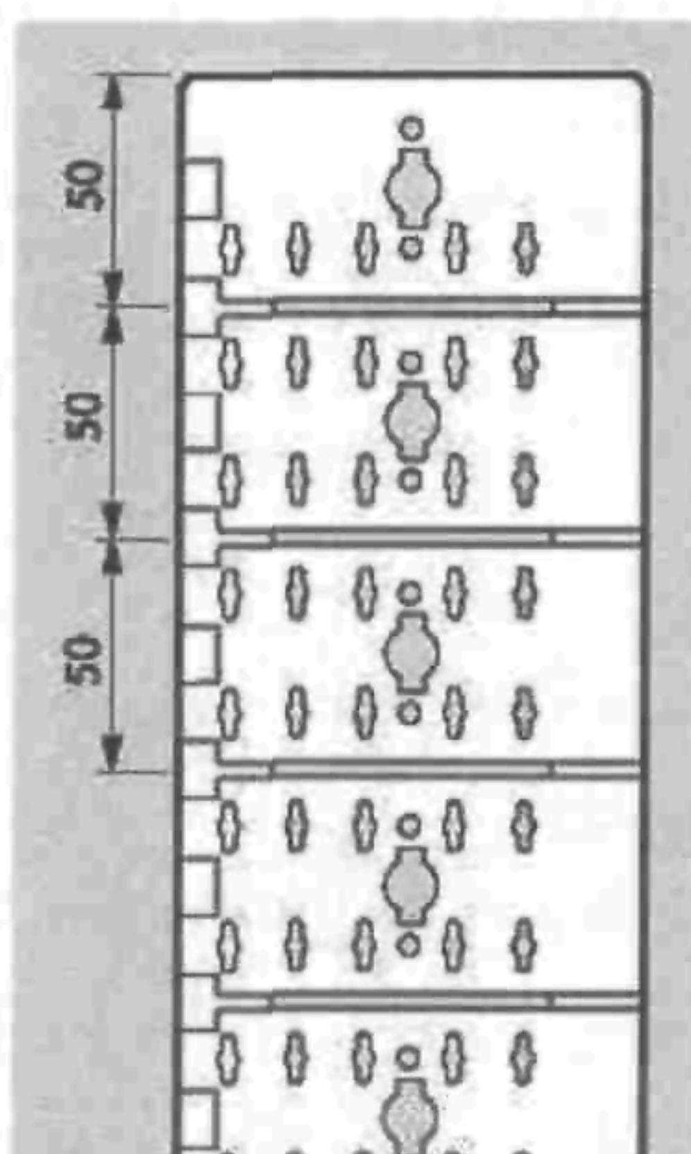
**Рис. 6.1.3.** Прорези отверстия на внутренней стороне стойки
