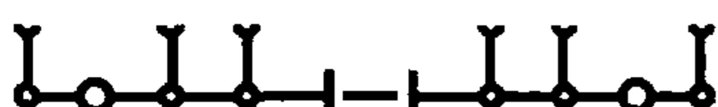
7.2.5.1. Измерительные шинные клеммы с размыкателями служат для временного размыкания токовых цепей для измерительных целей, но не под нагрузкой.
