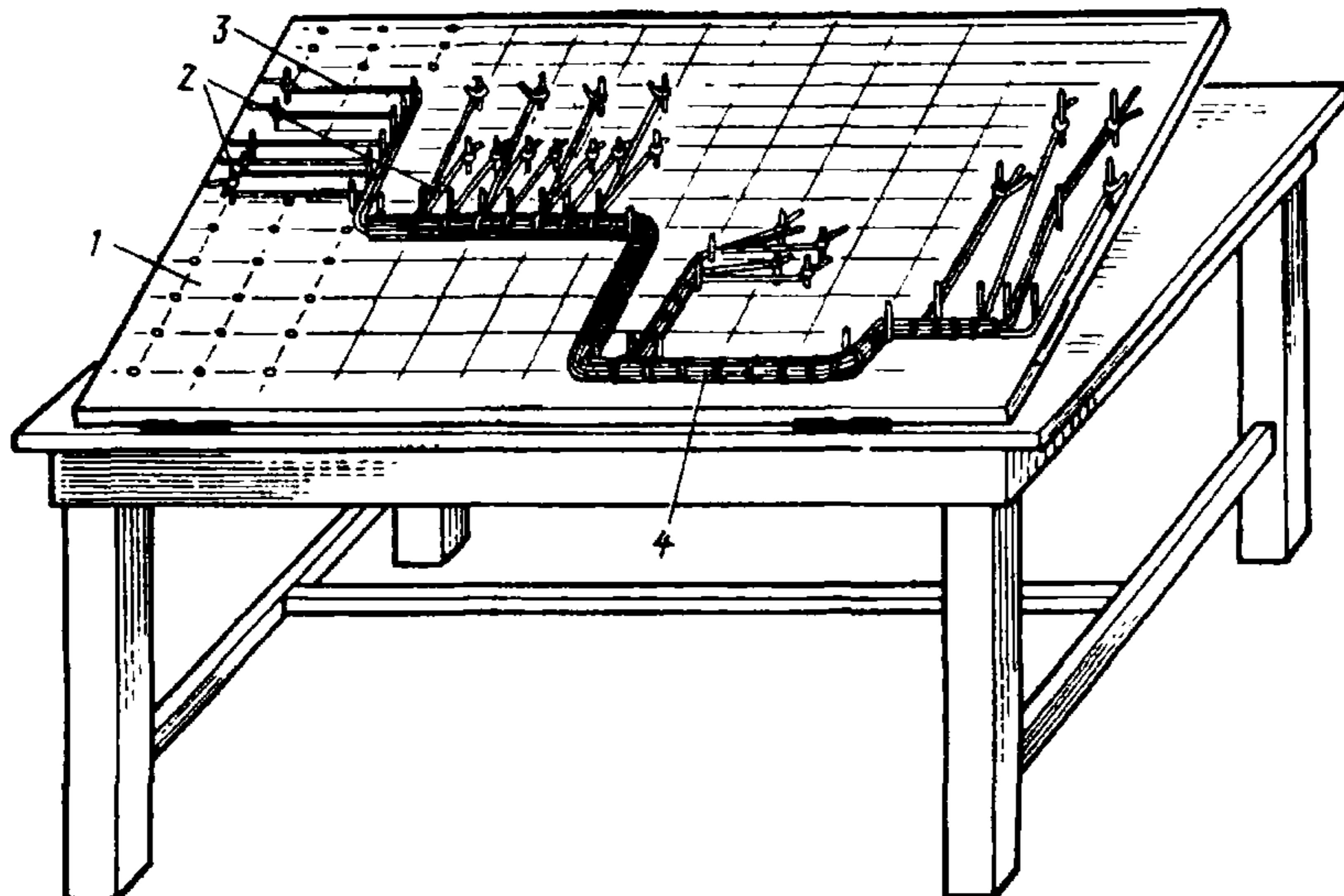
Рис. 4.4. Заготовка жгута проводов с применением универсального шаблона.
