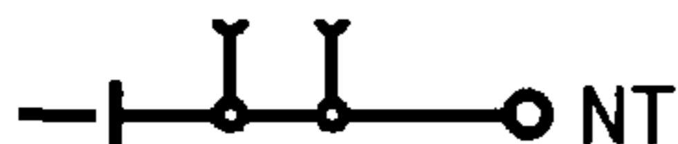
7.2.4.1. Данные клеммы служат для подключения проводов к нейтральнойшине с возможностью разрыва этого соединения расцепителем в клемме.
