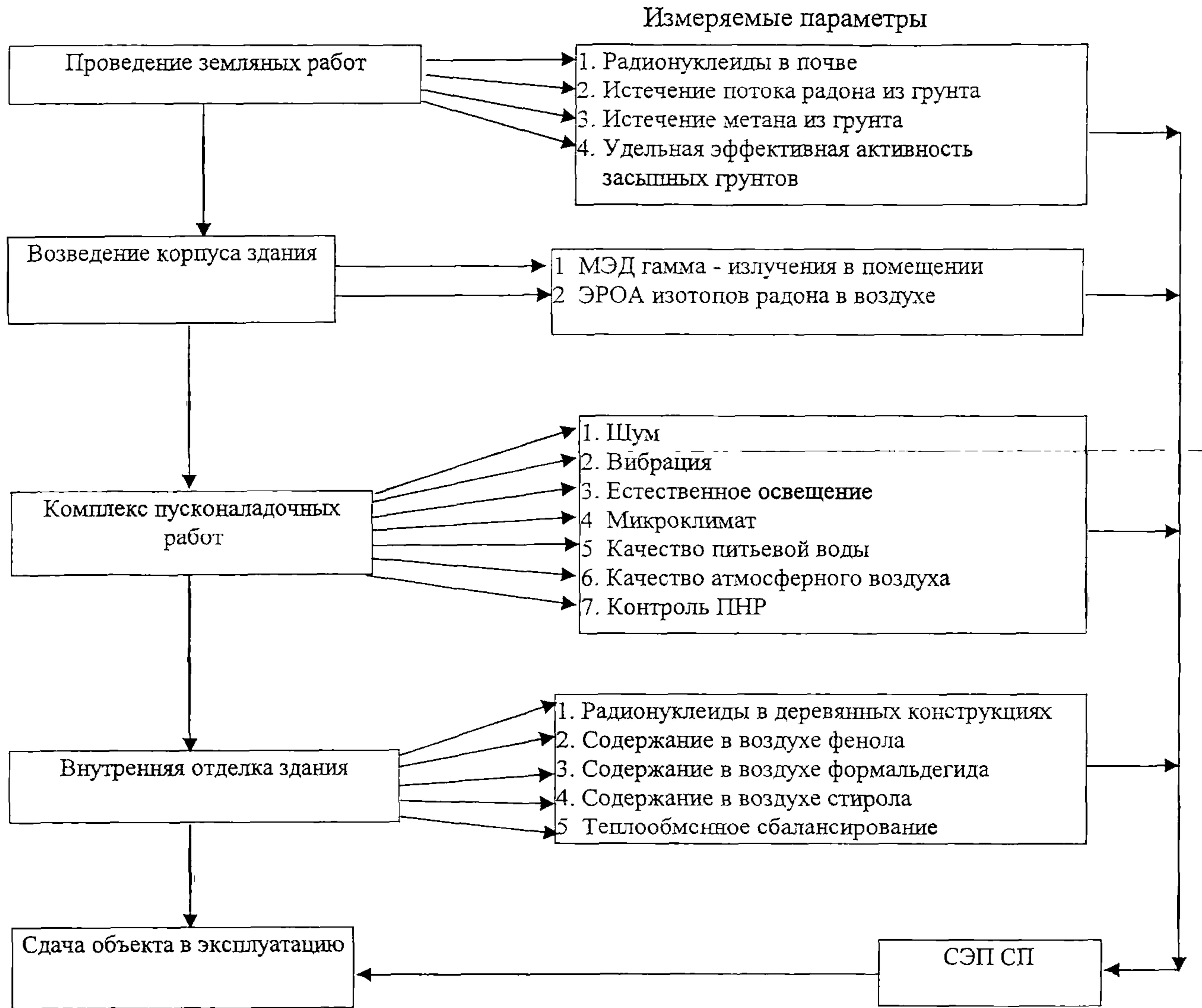
Рис. 1. Блок-схема проведения экологического сопровождения строительных работ [54].
