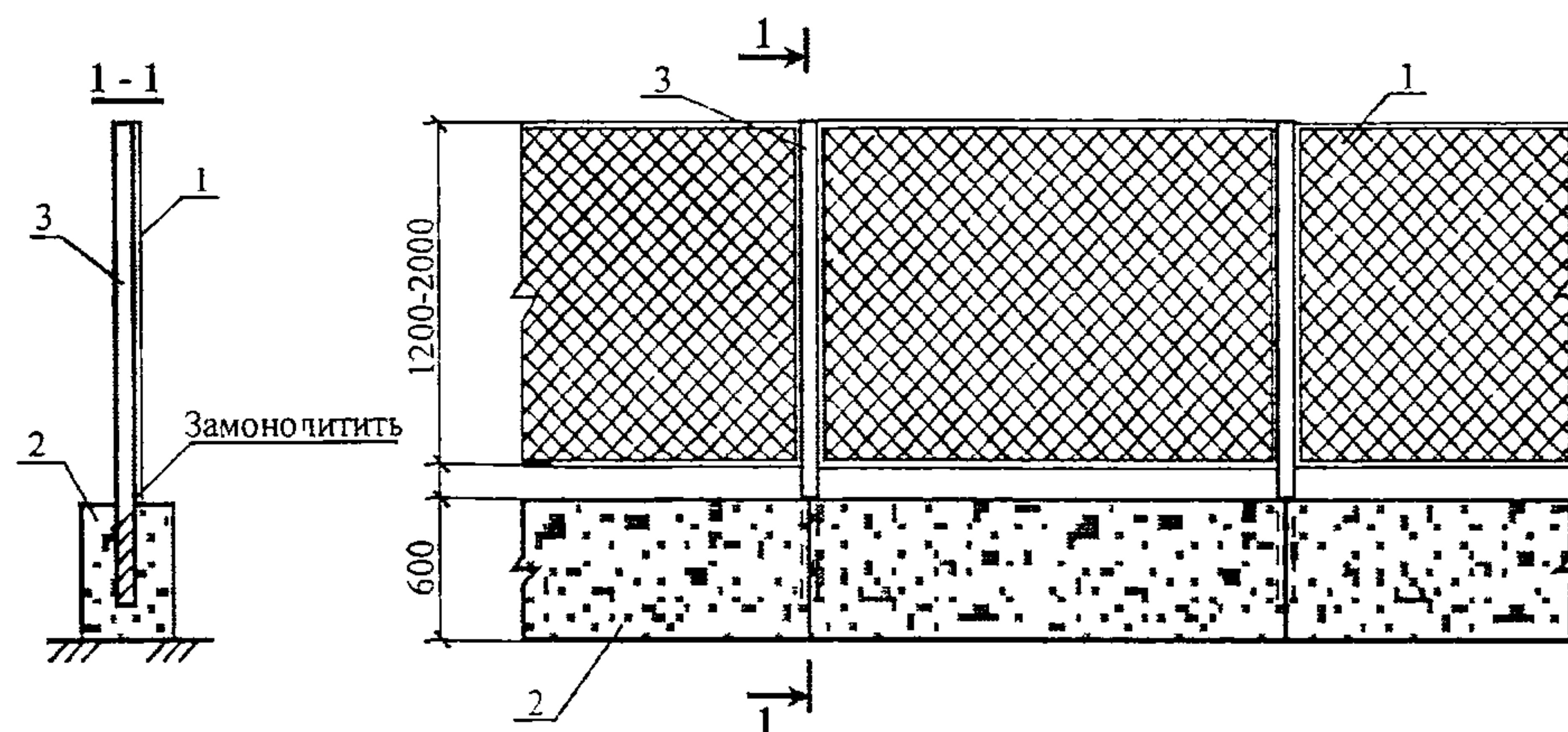
1 - металлическая сетка «Рабитца» на металлическом каркасе;
