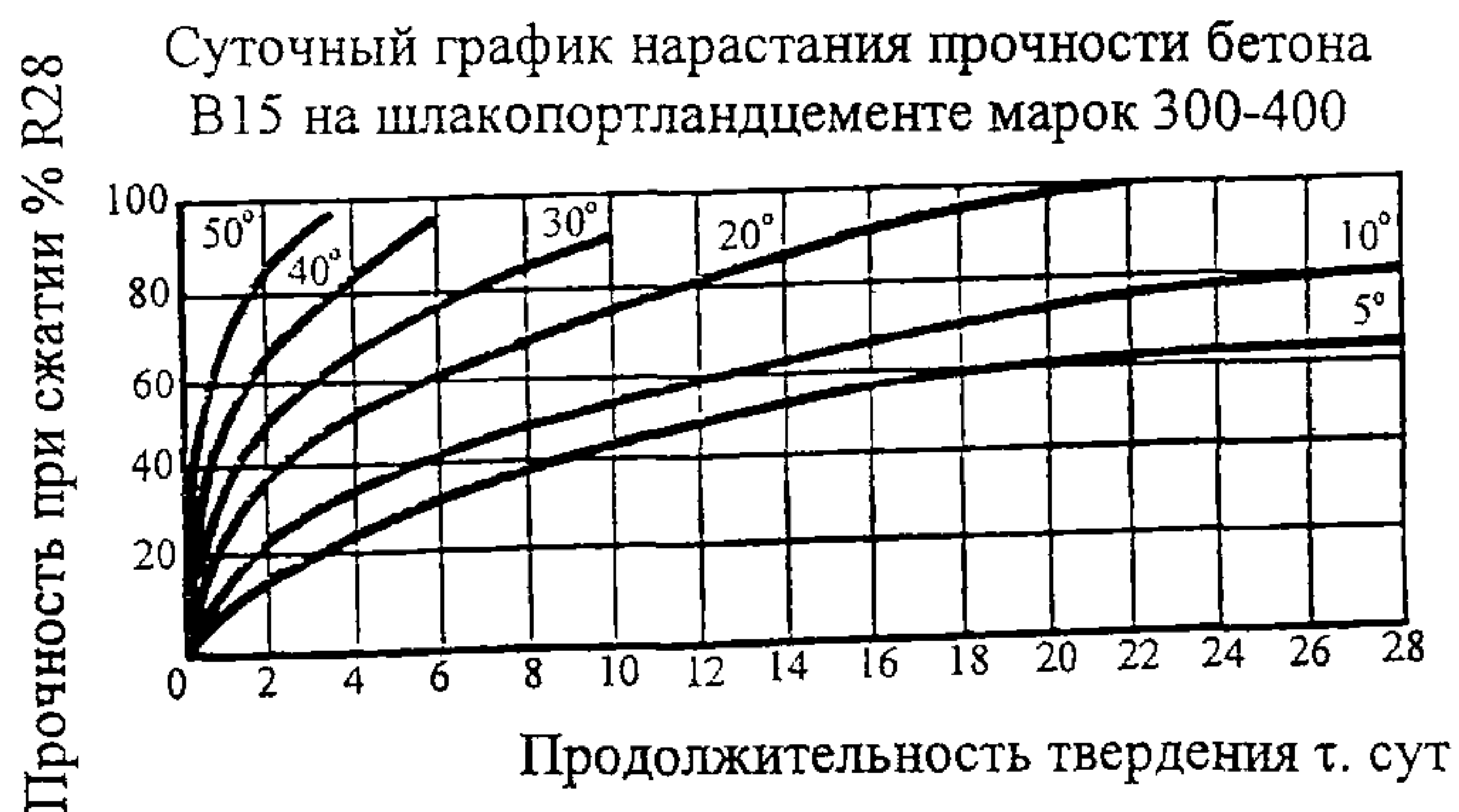
Рисунок Г.1 – Графики нарастания прочности бетона при различных температурах бетонной смеси
