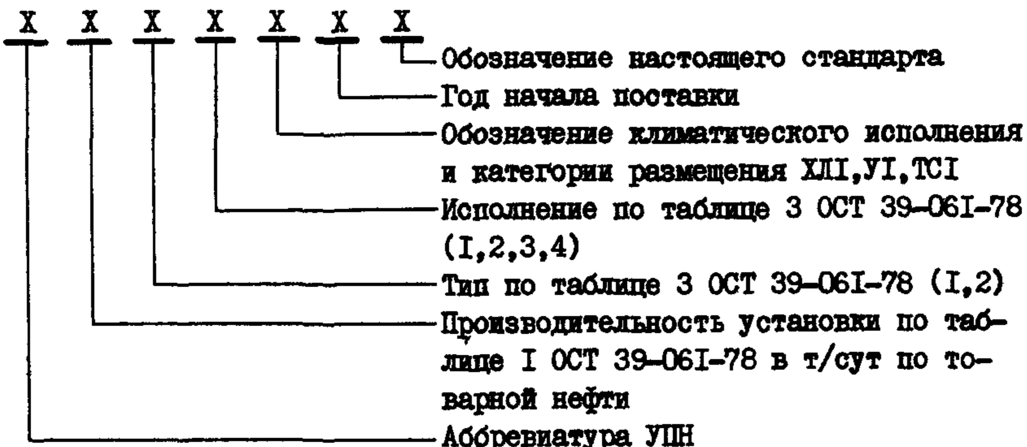
Пример условного обозначения блочной автоматизированной установки подготовки нефти производительностью 6300 т/сут типа I, исполнения I, климатического исполнения УП, год начала поставки 1980.
