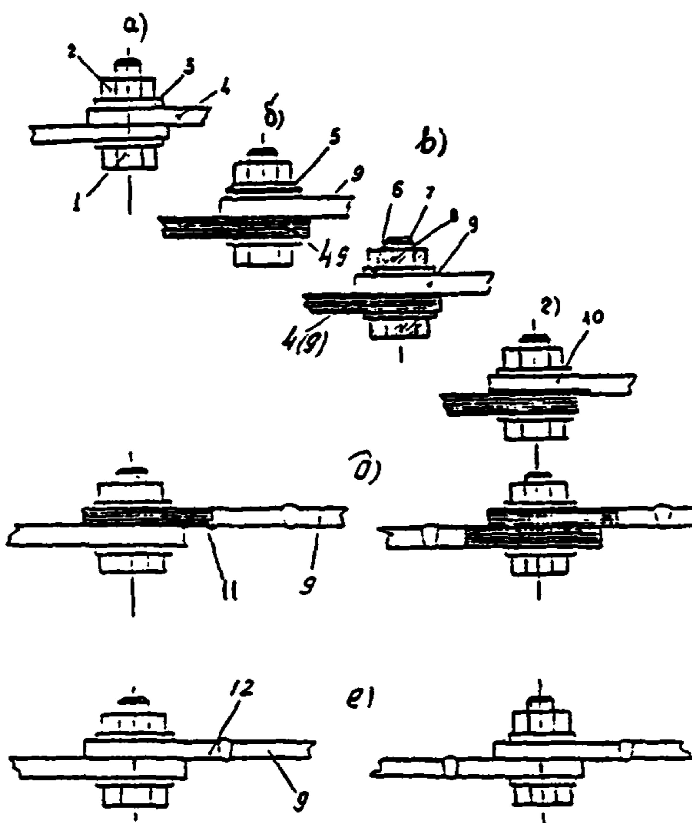
Рис. 3.1. Разборные контактные соединения
