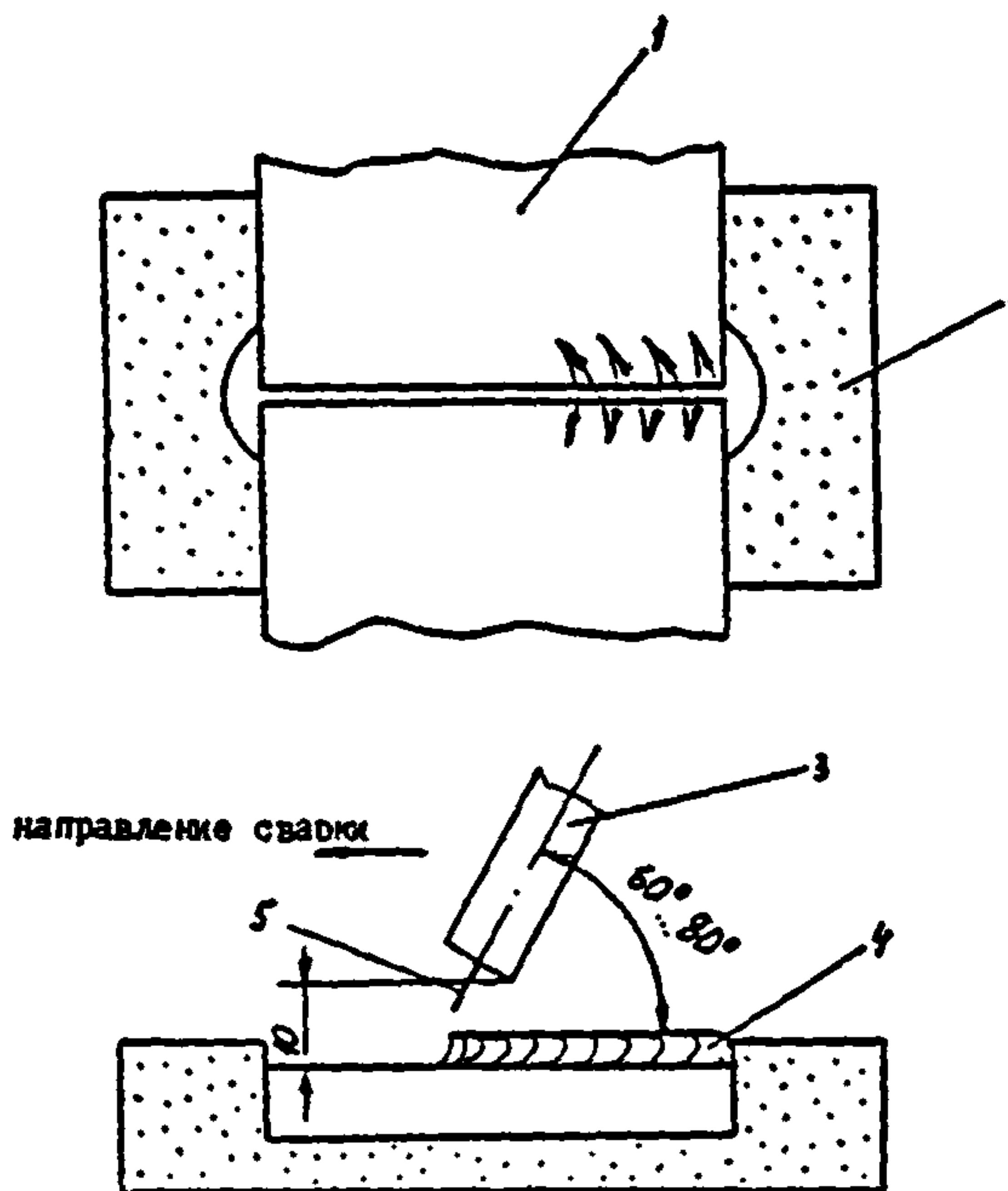
Рис. 2.22. Полуавтоматическая сварка медных шин в защитном газе.
