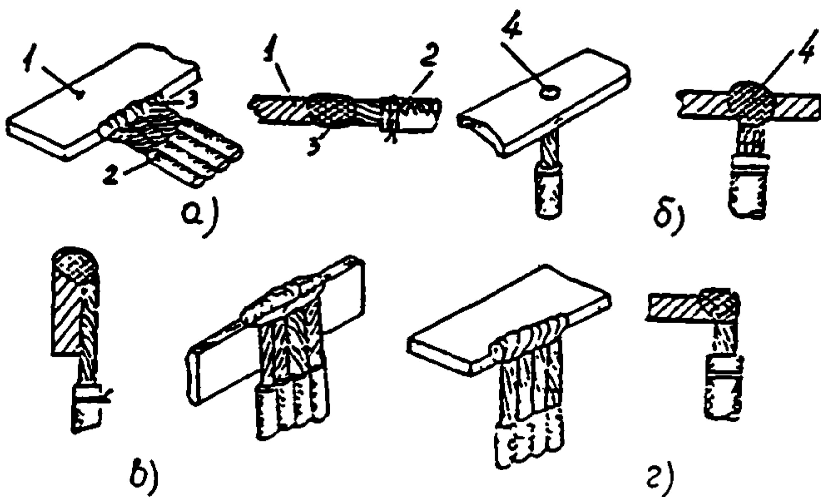
Рис. 2.18. Сварные соединения с шинами
