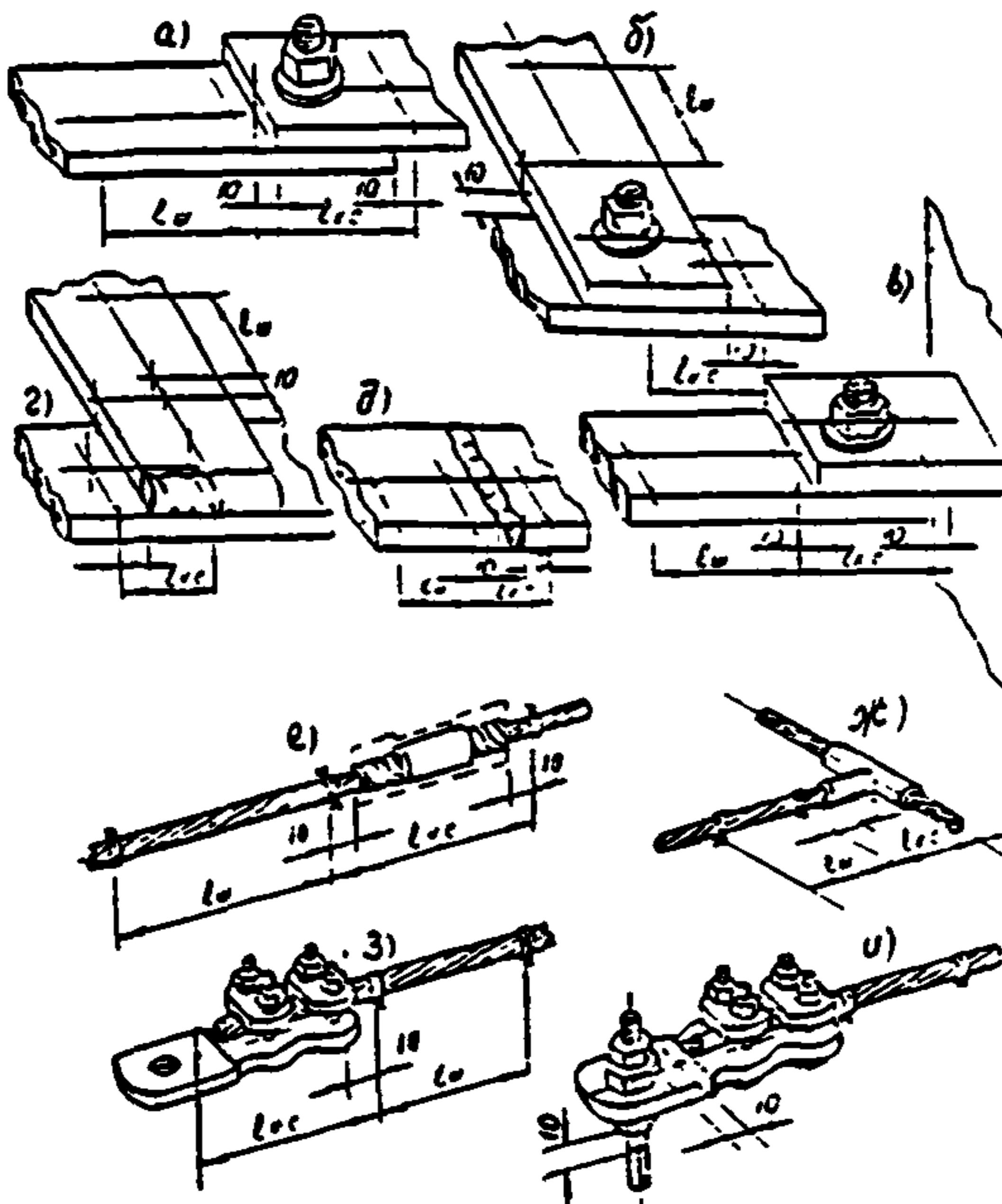
Рис. 6.3. Точки измерения сопротивлений
