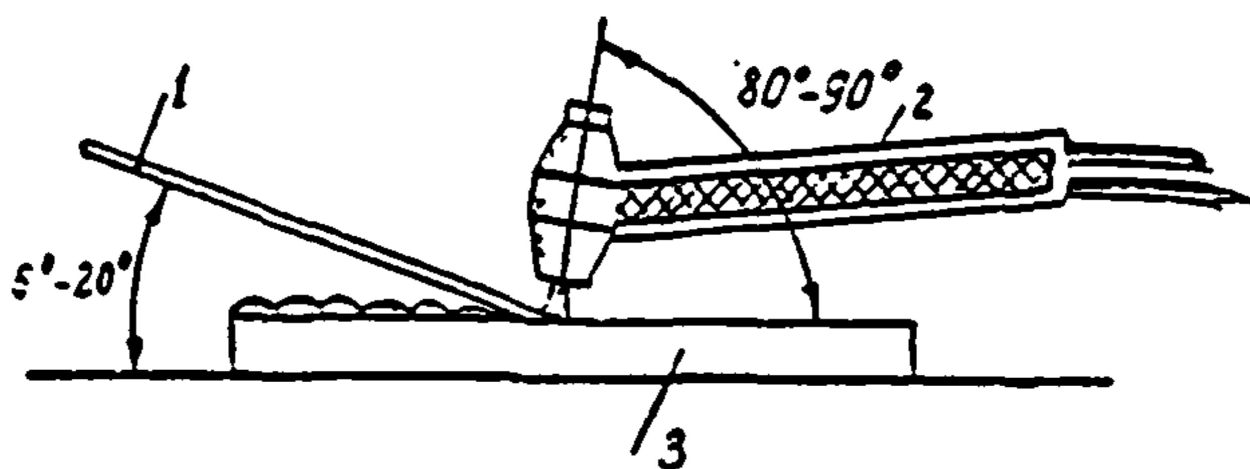
Рис. 2.23. Схема ручной плазменной сварки
