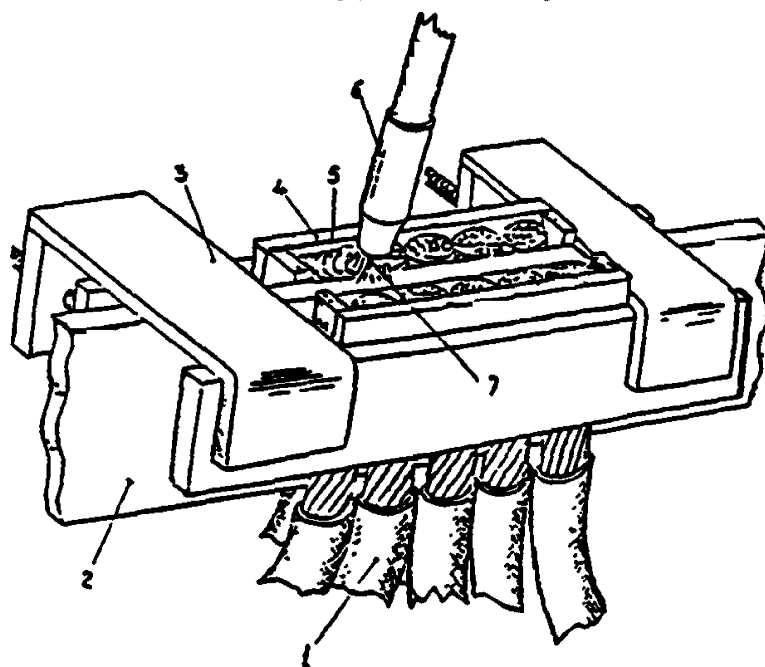
**Рис. 2.20. Сварка проводов с шиной, установленной на ребро**
