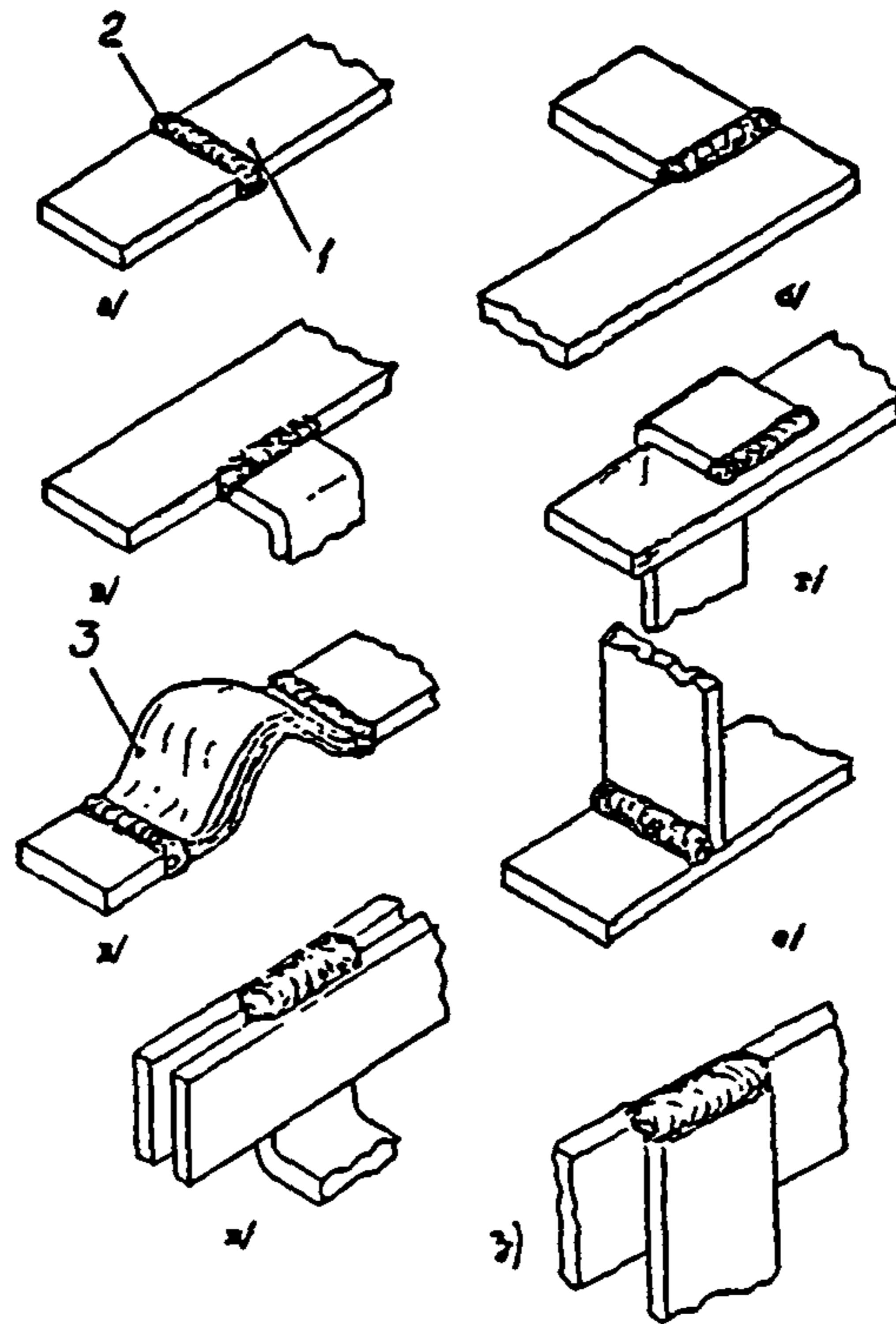
**Рис. 2.6. Основные сварные соединения прямоугольных шин**
