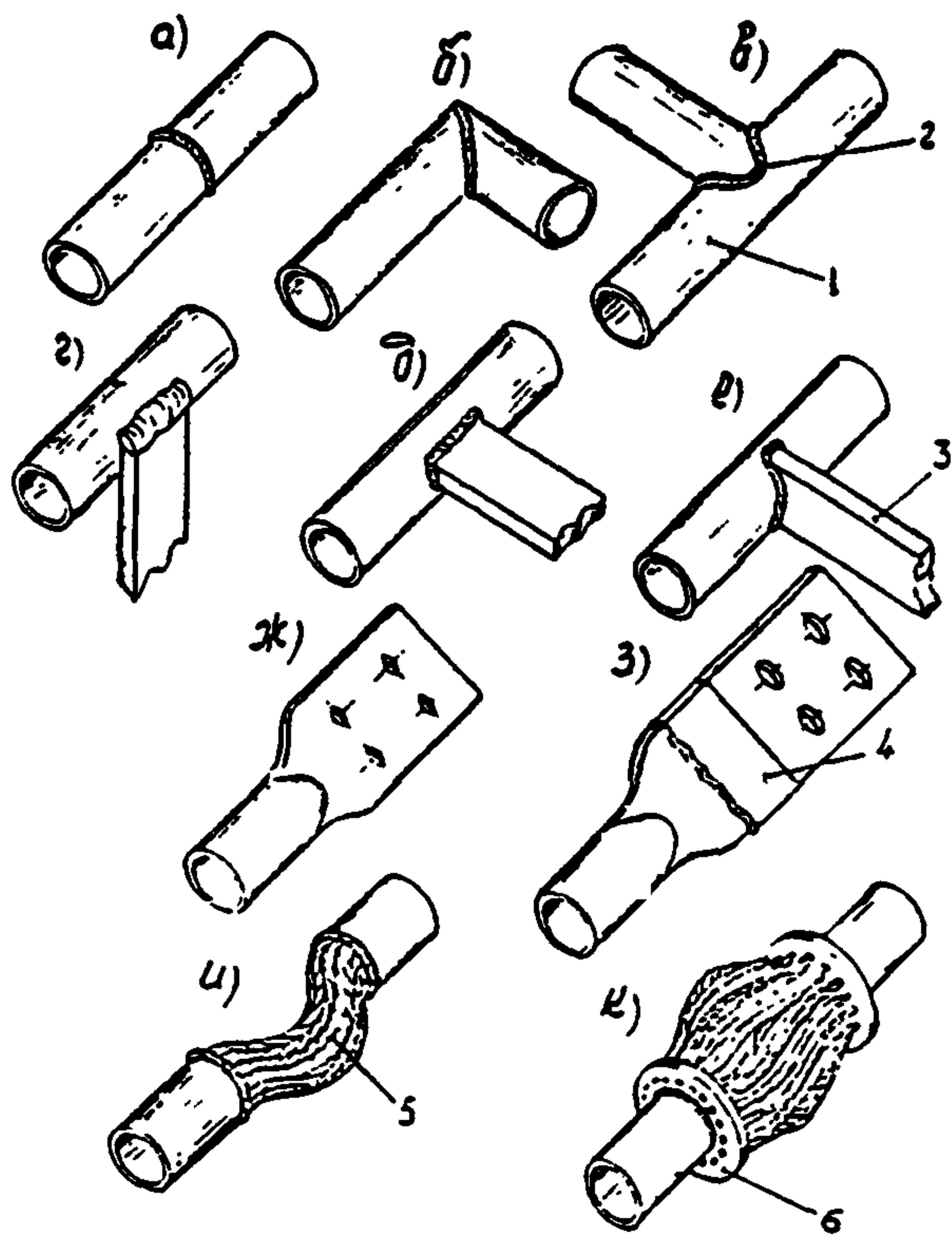
Рис. 2.11. Сварные соединения шин из труб
