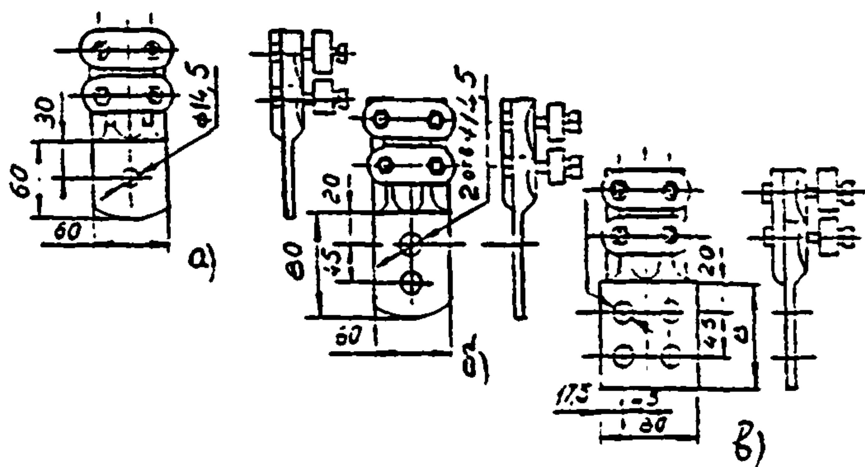
**Рис. 5.3. Аппаратные болтовые зажимы**
