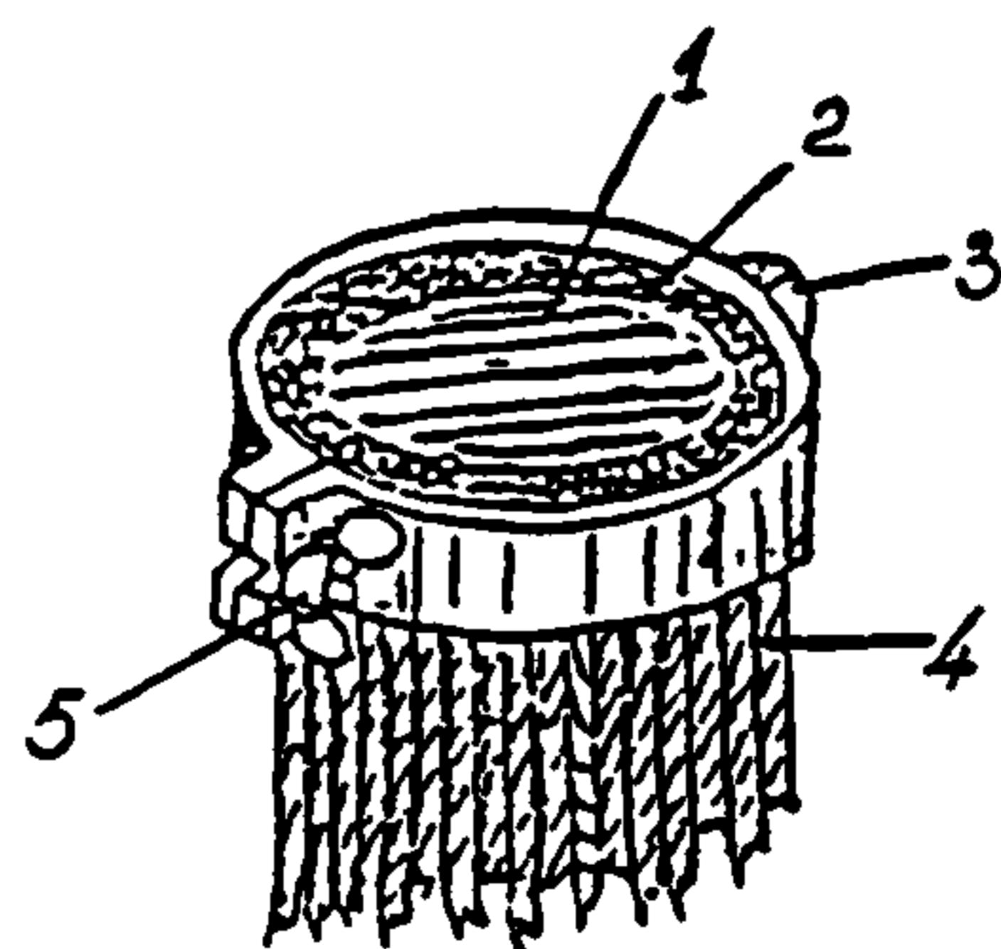
Рис. 2.16. Приспособление для сплавления алюминиевых проводов в монолит
