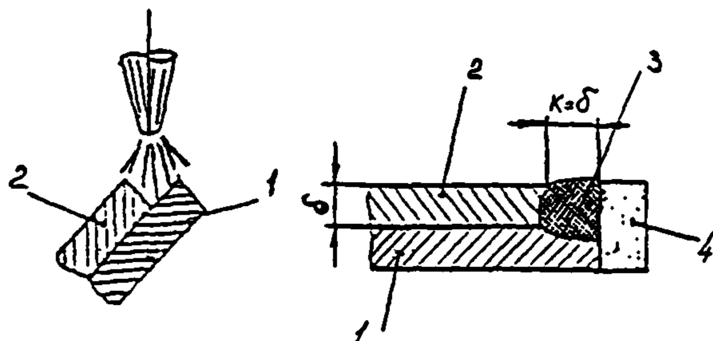
Рис. 2.21. Сварка медных шин внахлестку
