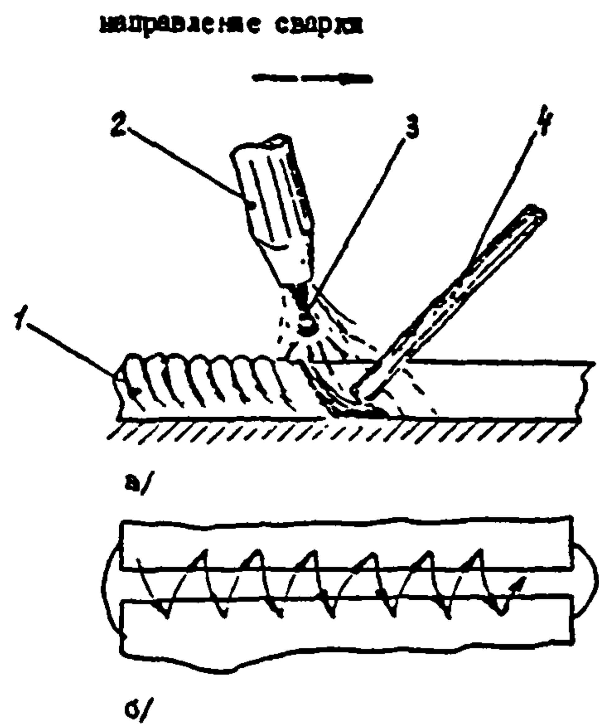
Рис. 2.2. Ручная аргоно-дуговая сварка вольфрамовым электродом
