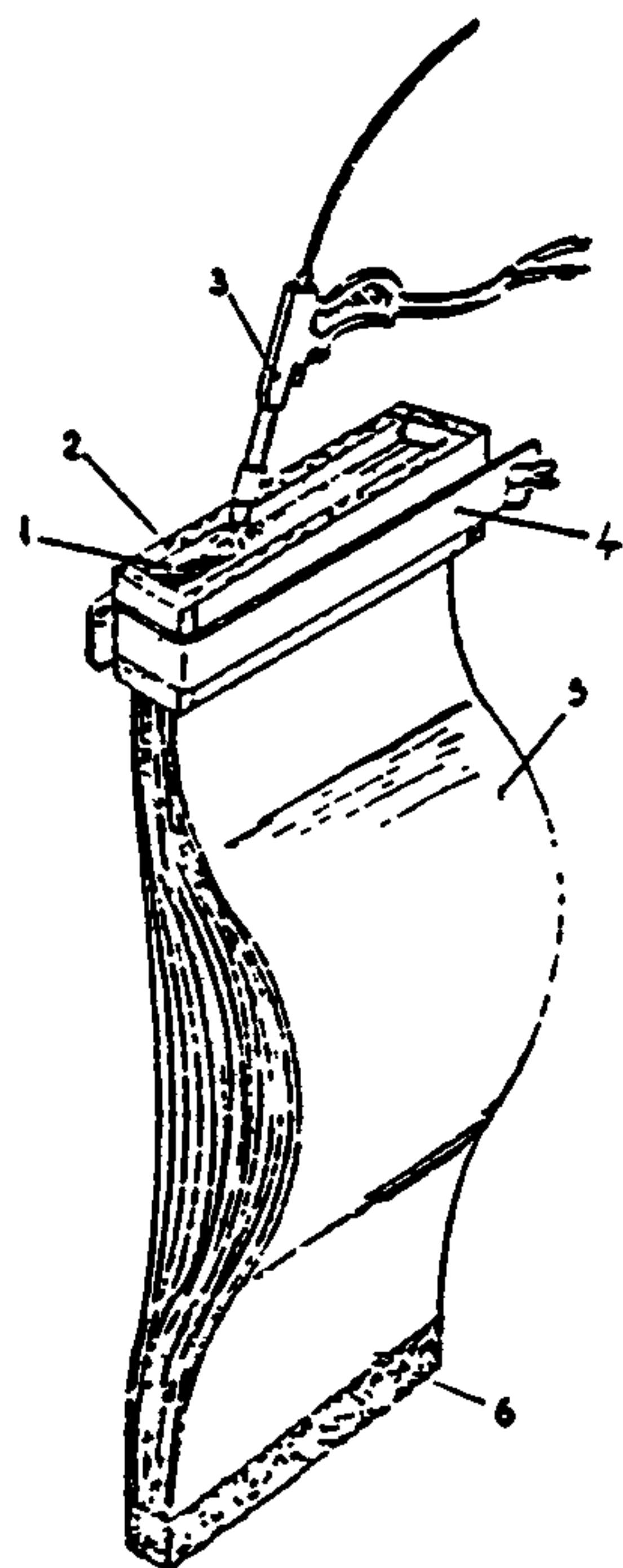
Рис. 2.17. Сварка компенсатора
