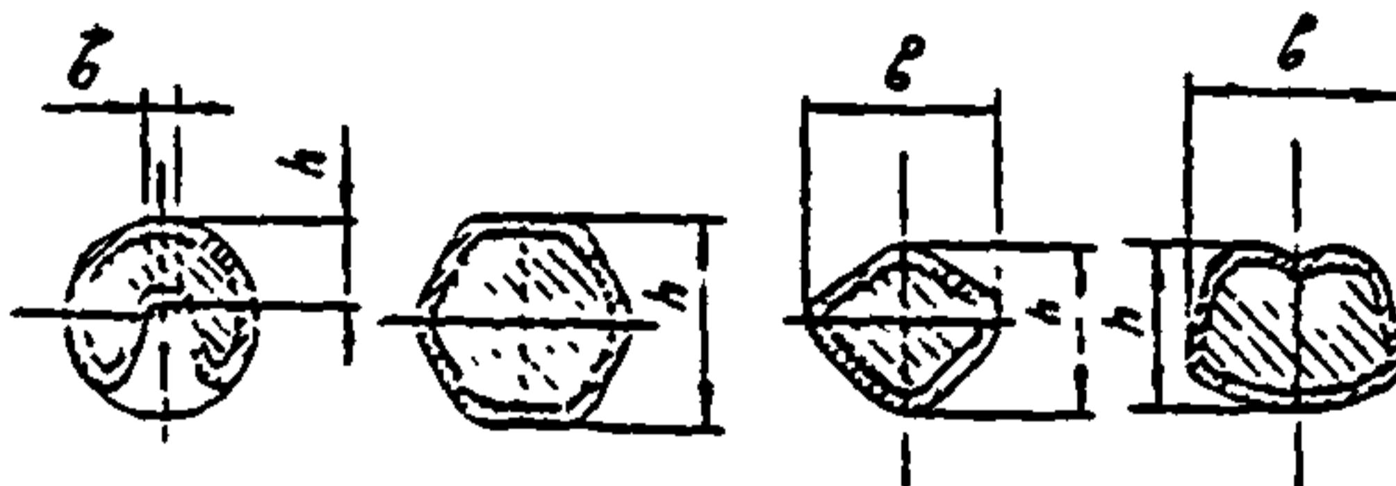
Рис. 6.2. Контролируемые элементы опрессованных соединений
