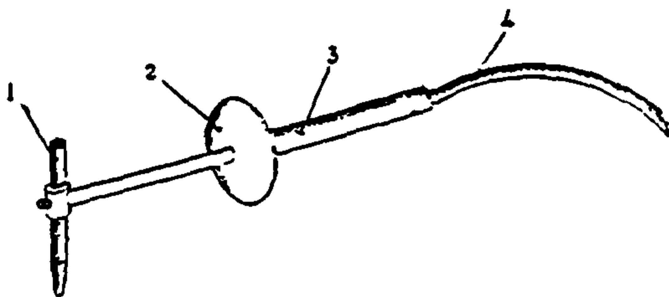
1 - угольный электрод; 2 - защитный экран; 3 - диэлектрическая рукоятка; 4 - сварочный кабель.
