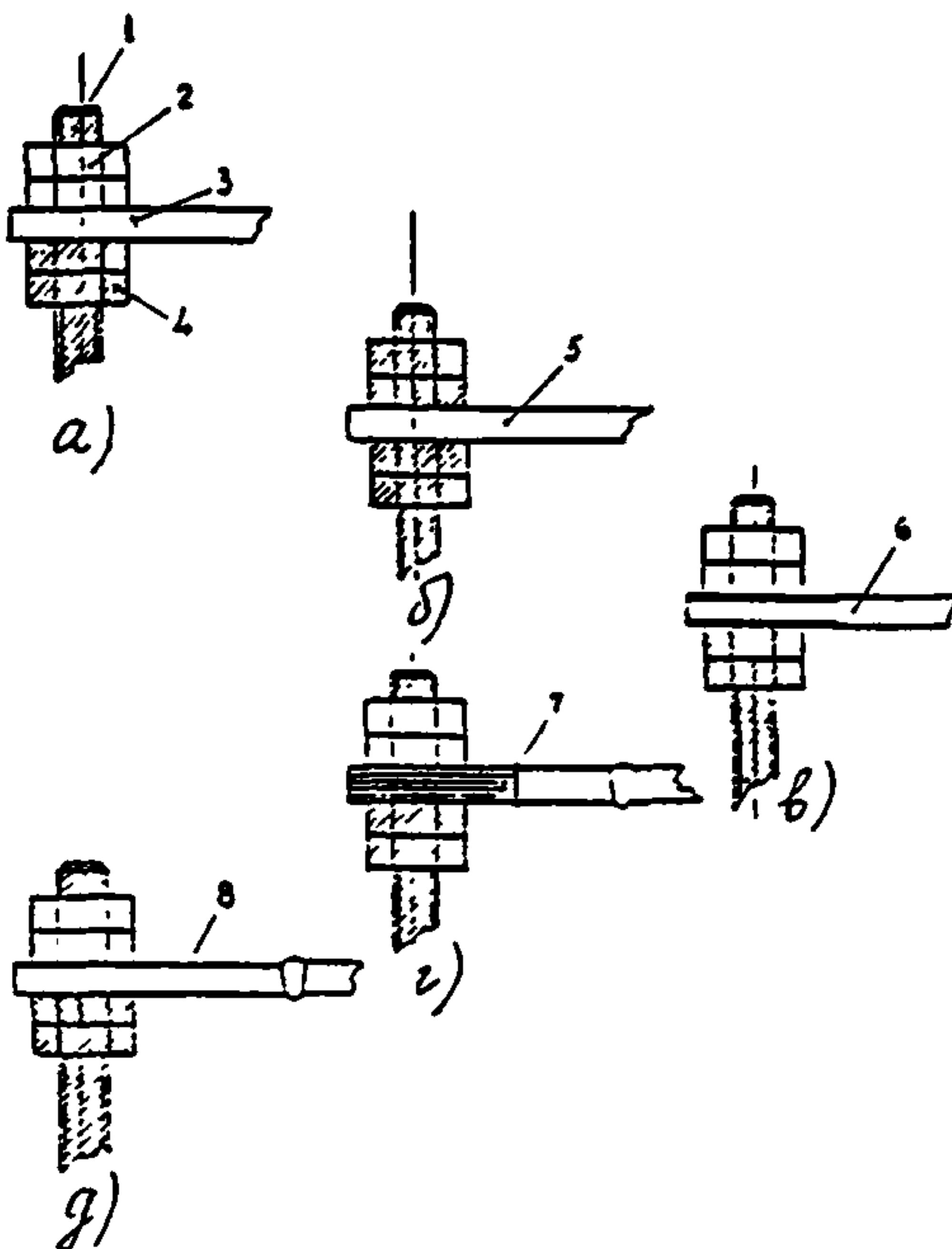
**Рис. 4.1. Соединение со штыревыми выводами**
