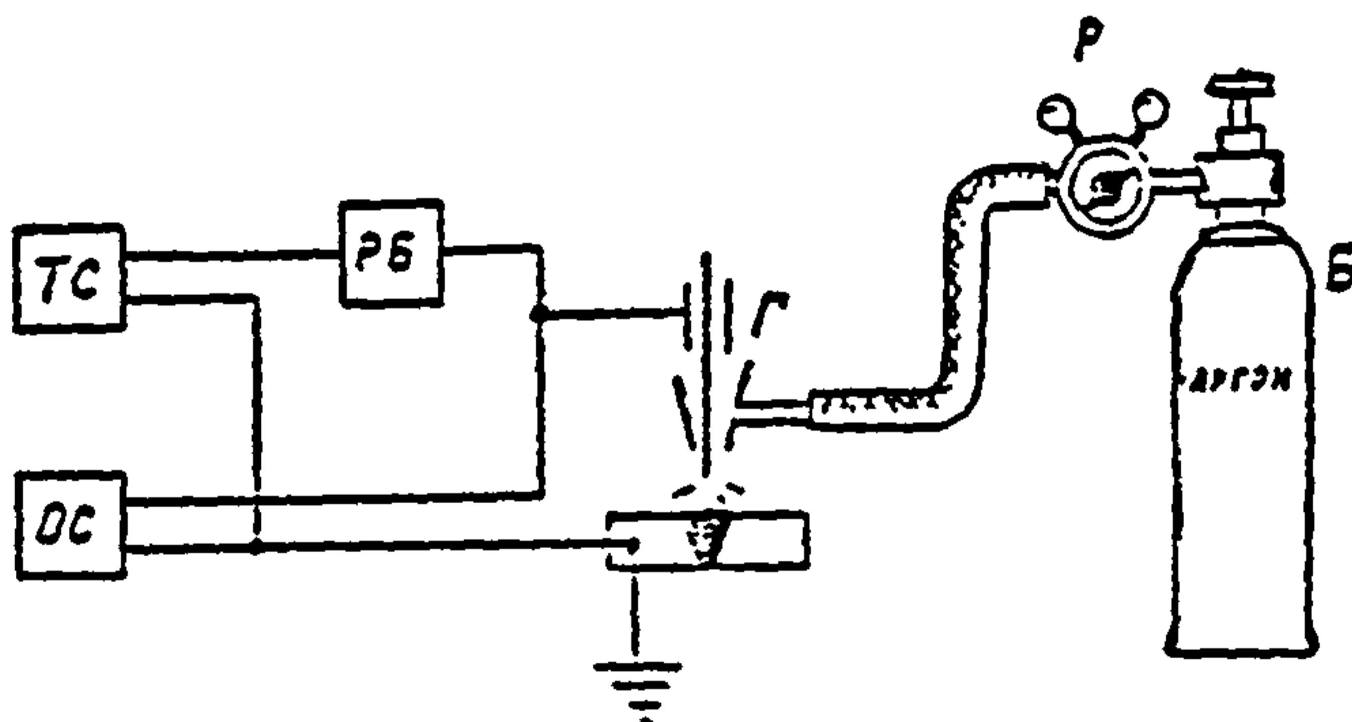
Рис. 2.1. Схема поста для ручной аргоно-дуговой сварки на «переменном токе»
