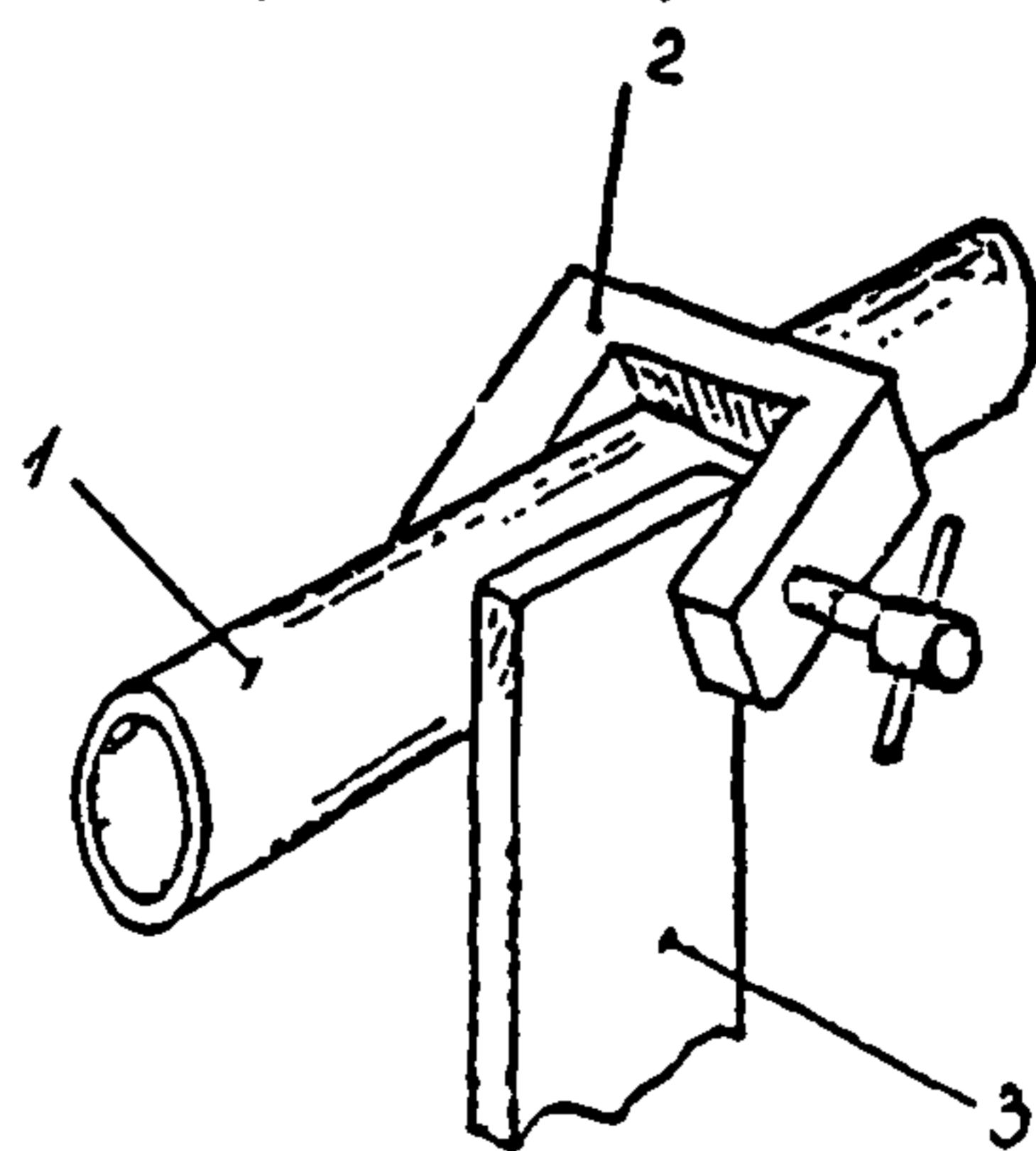
**Рис. 2.15. Сборка под сварку прямоугольной шины с грубой**
