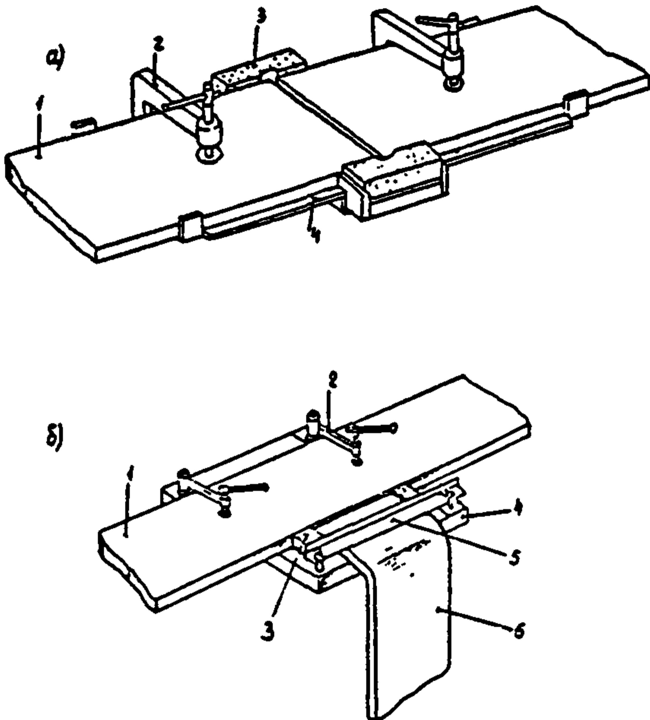
Рис. 2.7. Переносные приспособления для сварки шин на монтаже
