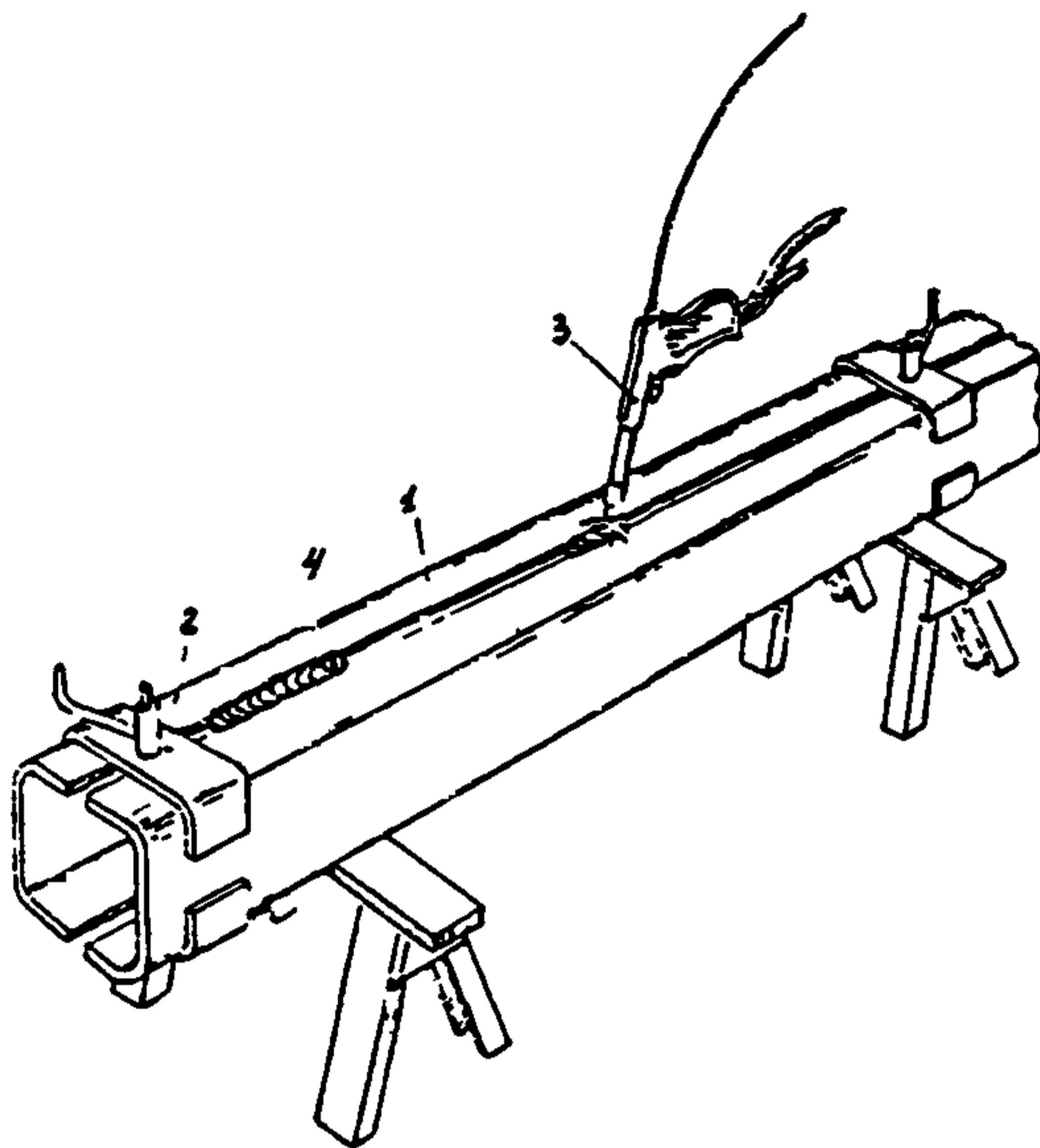
Рис. 2.12. Сварка коробчатой шины из алюминиевого швеллера
