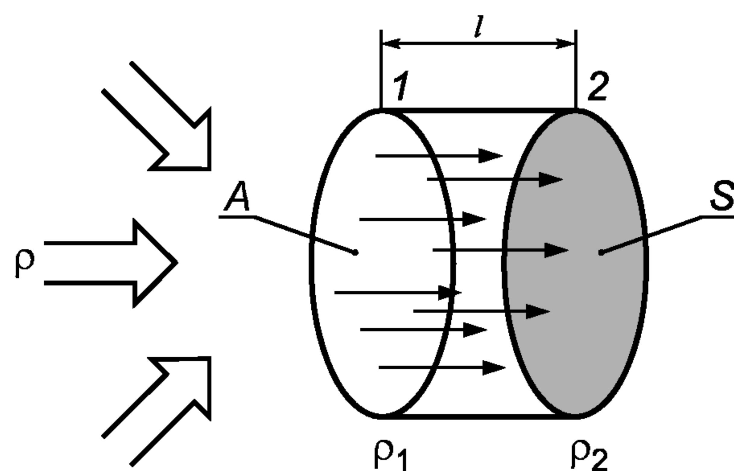
Рисунок A.1 – Схема диффузионного отбора проб
