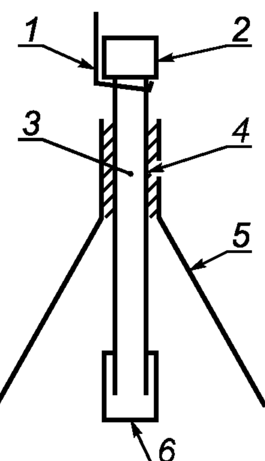
1 — шнур; 2 — навинчивающаяся крышка; 3 — сорбент; 4 — трубка с пробой; 5 — воронка; 6 — диффузионная крышка с сеткой
