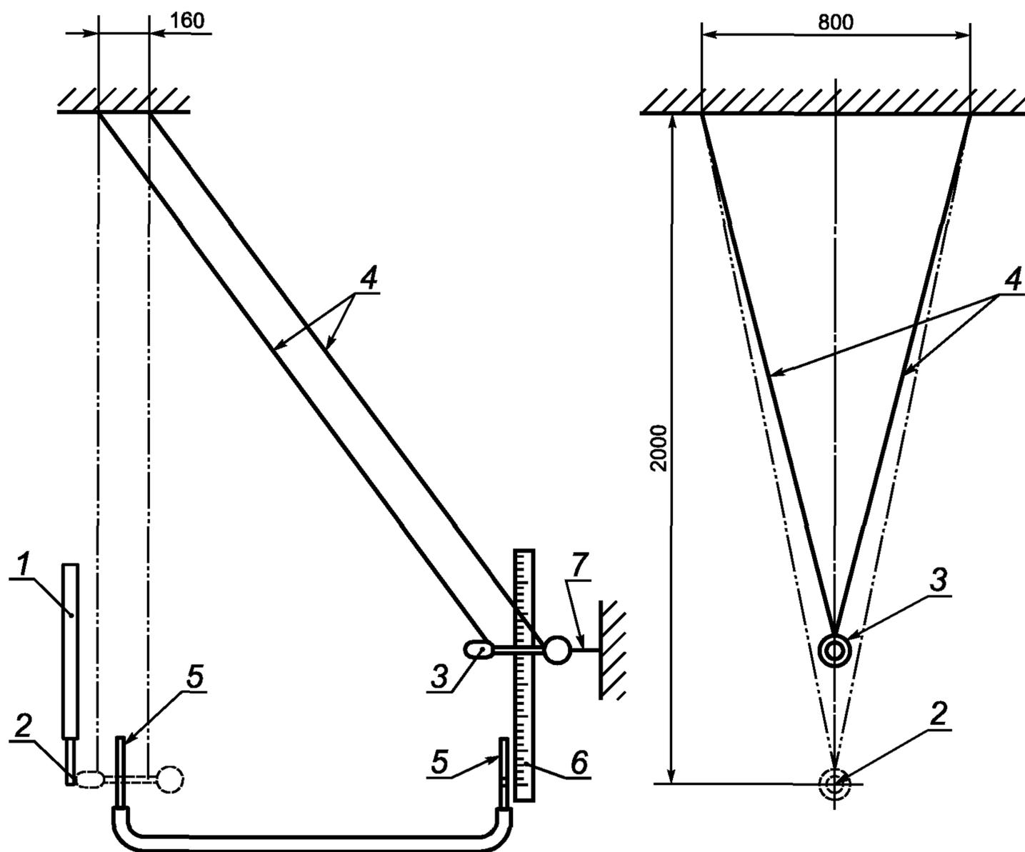
1 — маятник (рисунок Б.1); 2 — точка удара; 3 — калибровочный ударник; 4 — льняные нити; 5 — стеклянные трубки;
