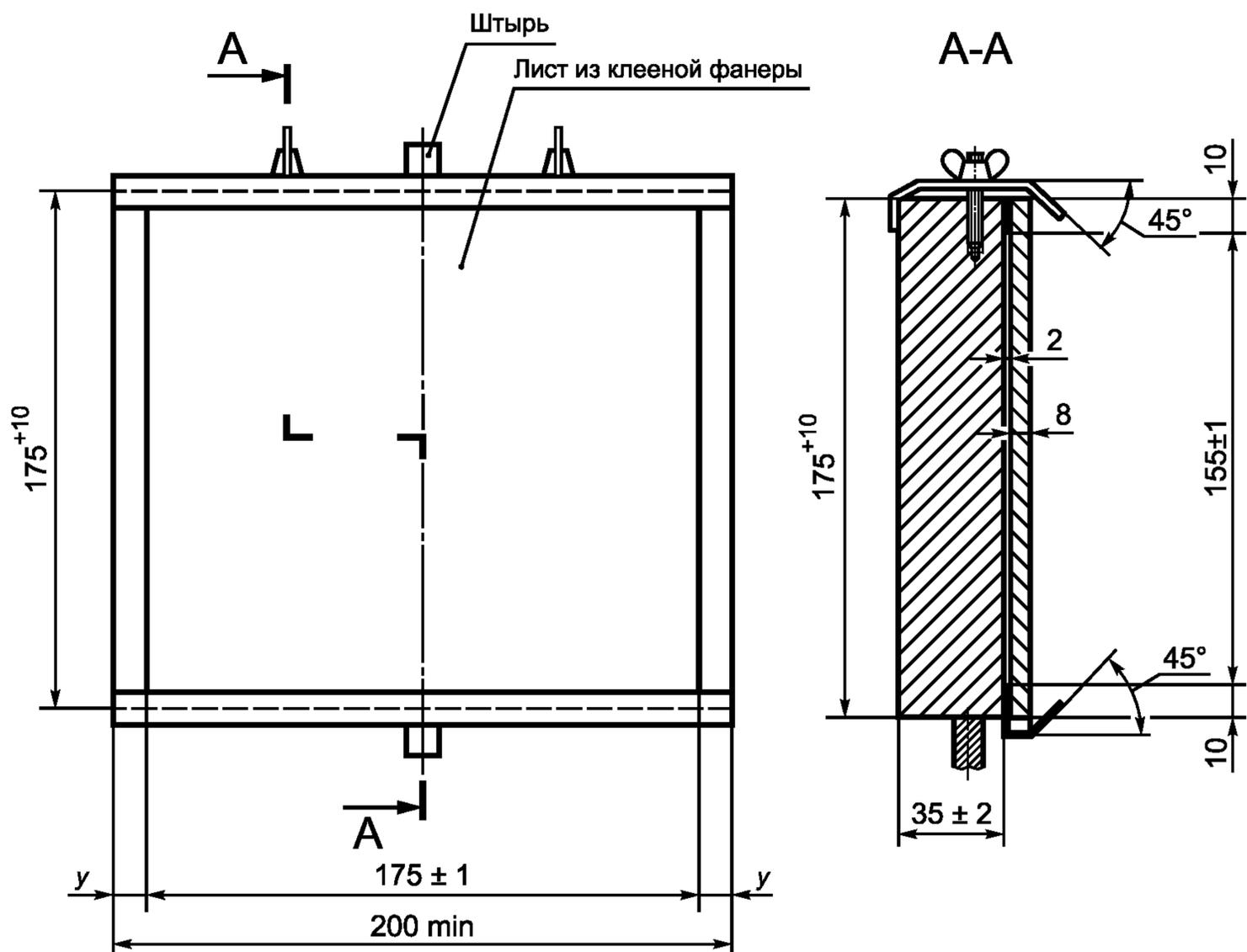
Рисунок Г.3 — Монтажное приспособление
