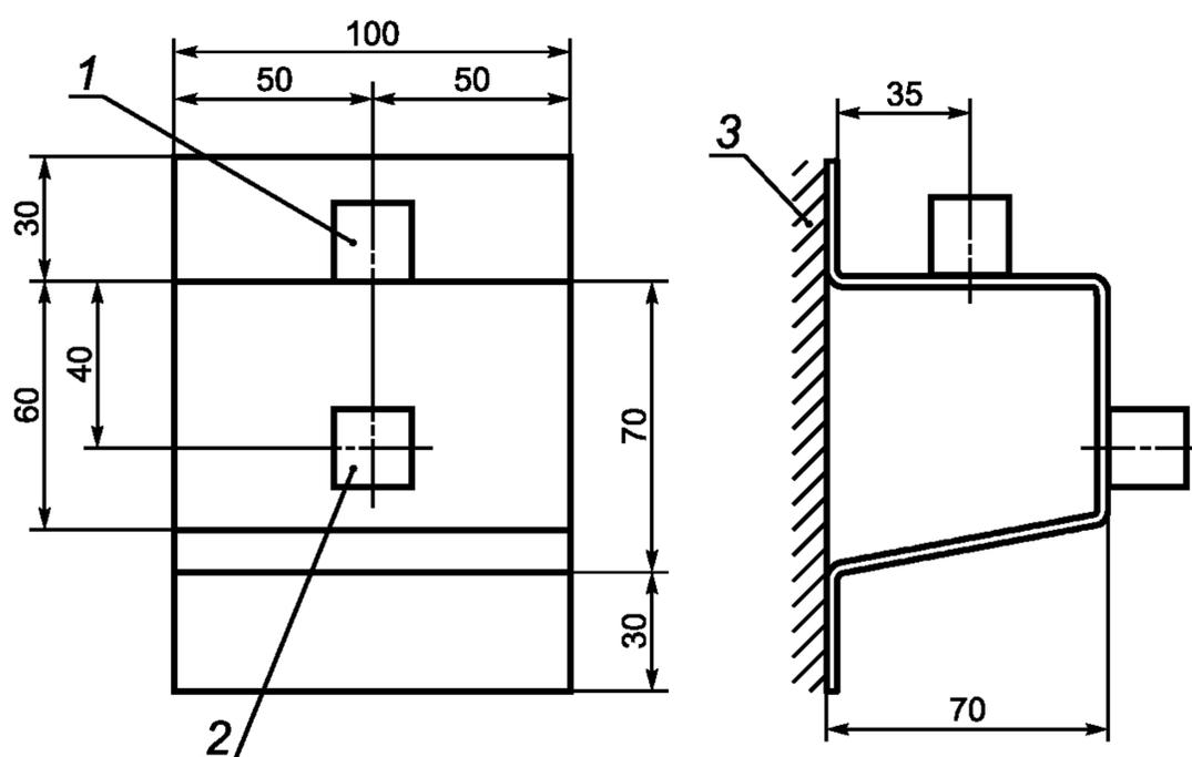
1 — образец для поверхности или полувстроенного крепления; 2 — образец полувстроенного крепления;
