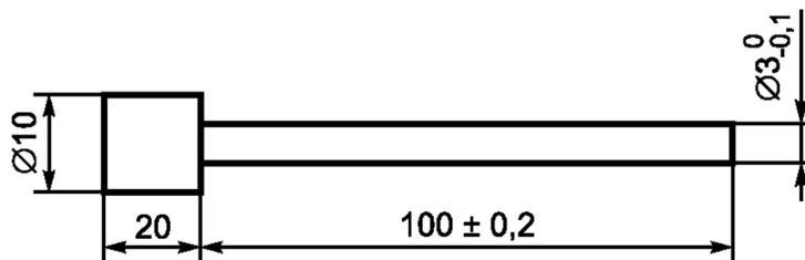
Рисунок 101 — Испытательный стержень для скрытой блокировки
