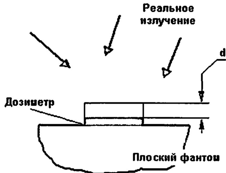
Рис.2. Схема определения  $H_p(d)$ .
