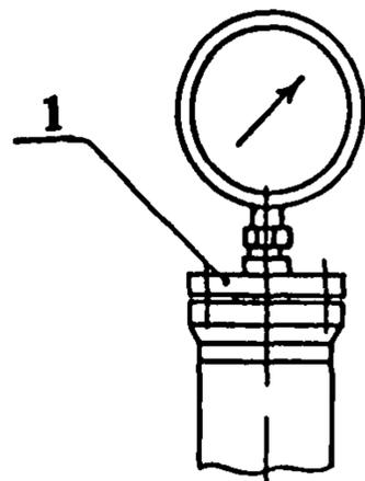
Пример условного обозначения установки прибора с мембранным разделителем на Горизонтальном трубопроводе смотри «Общие указания» п.п. 4, 4.5, 4.6, 4.7.
