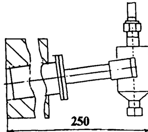
Пример условного обозначения подключения импульсной трубы к закладной конструкции отборного устройства разрежения смотри - «Общие указания» п.п. 6; 6.4; 6.5.
