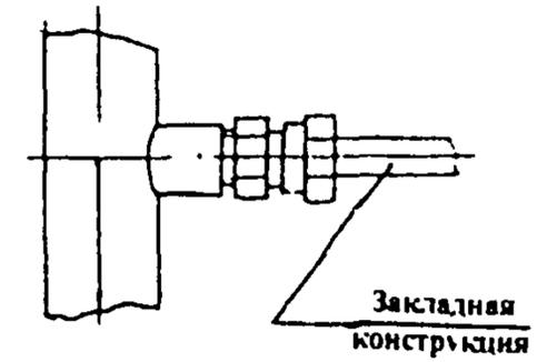
Пример условного обозначения установки прибора на трубопроводе или стенке аппарата смотри «Общие указания» п п 3 1, 3 2, 3 3, 3 4, 3 5
