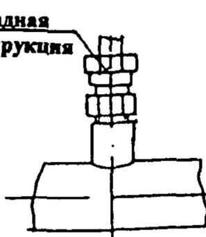
Пример условного обозначения установки прибора на трубопроводе или стенке аппарата, смотри «Общие указания» п.п. 3; 3.6.
