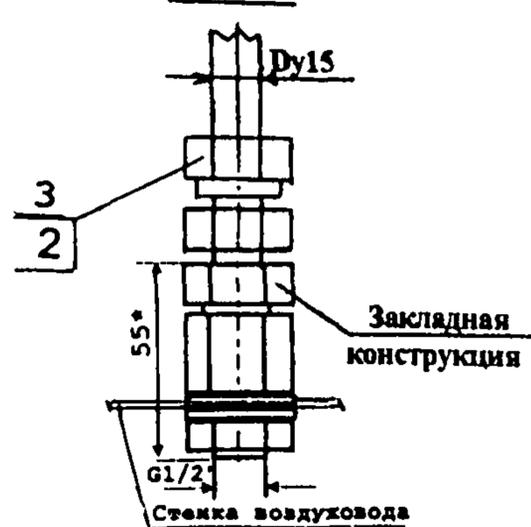
Пример условного обозначения подключения импульсной трубы к закладной конструкции смотри - «Общие указания» п.п. 6; 6.1; 6.2; 6.3.
