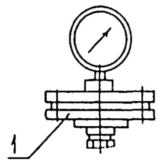
пример условного обозначения установки прибора с мембранным разделителем на трубопроводе – смотри «Общие указания» п.п. 4; 4.1; 4.2; 4.4.
