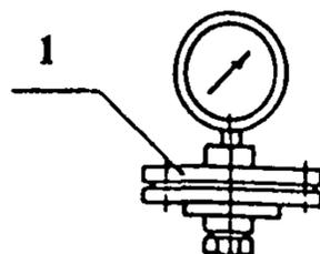
Пример условного обозначения установки прибора с мембранным разделителем на трубопроводе
