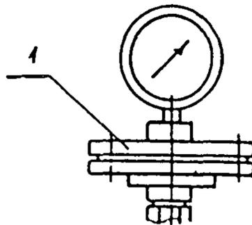
Пример условного обозначения установки прибора с мембранным разделителем на трубопроводе – смотри «Общие указания» п.п. 6; 6.1; 6.2; 6.3.
