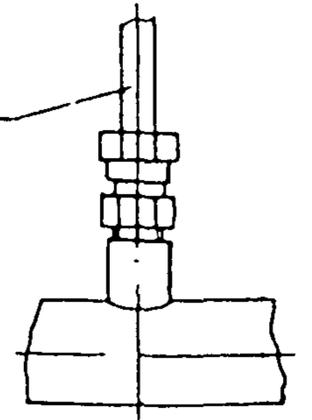
Пример условного обозначения установки прибора на трубопроводе или стенке аппарата смотри «Общие указания» п.п. 3.1, 3.2, 3.3, 3.4, 3.5.
