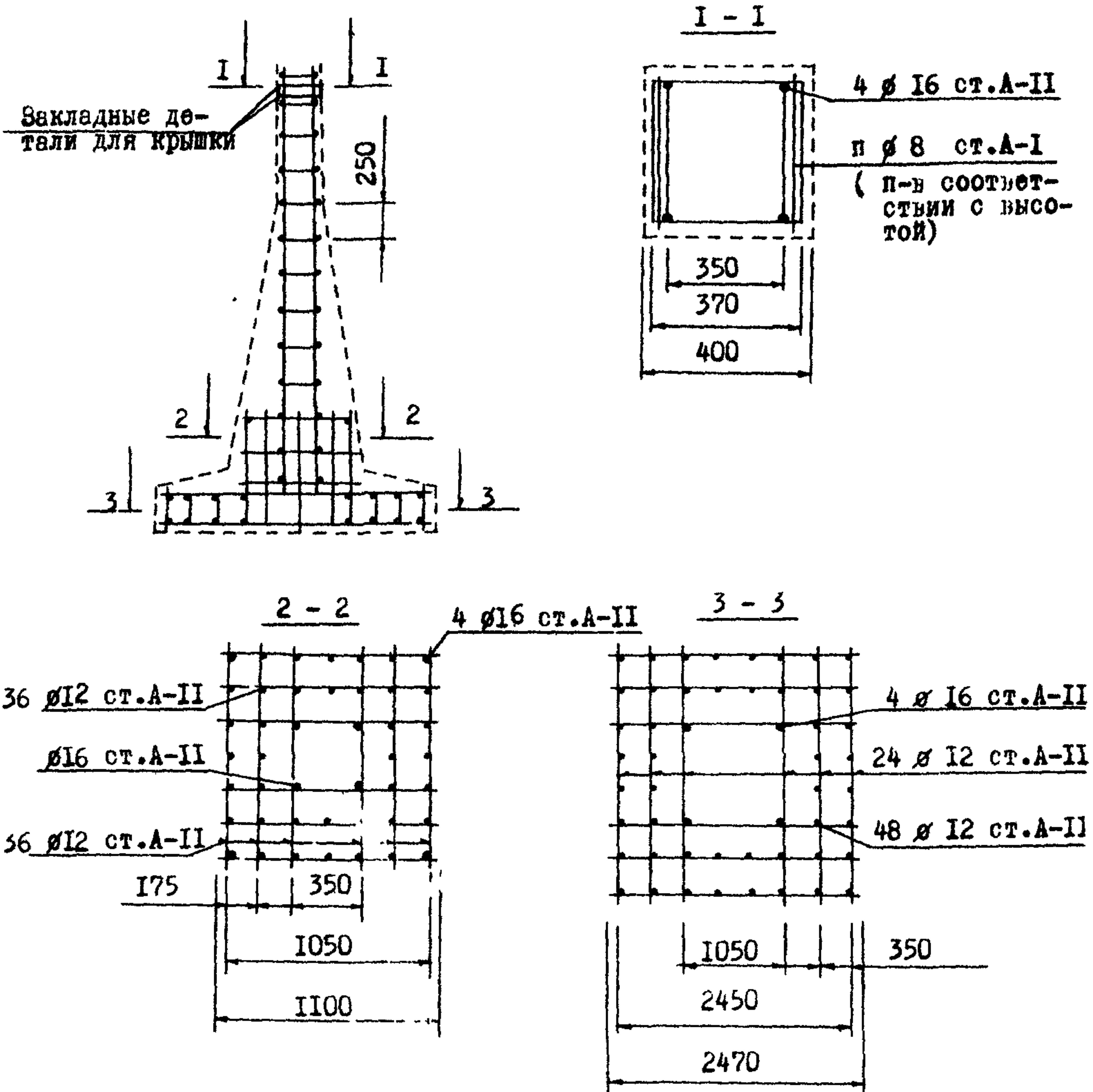
Конструкция стального каркаса центра
