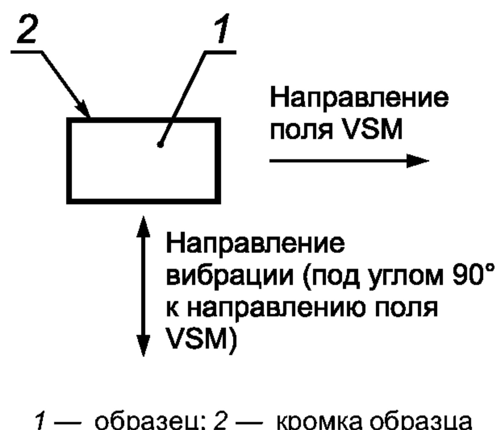
1 — образец; 2 — кромка образца
