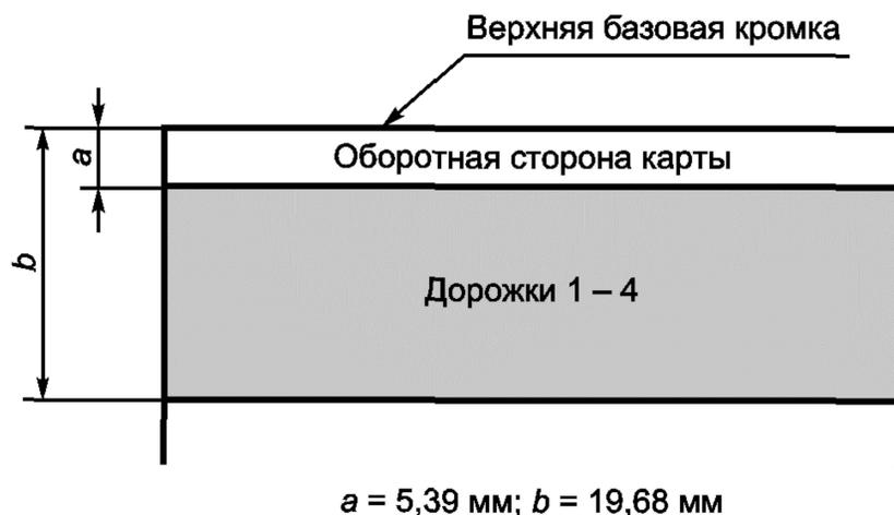
Рисунок 8 — Расположение и высота полосы при четырех дорожках
