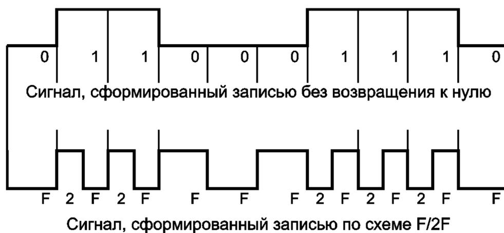
Рисунок В.1 — Кодирование F/2F
