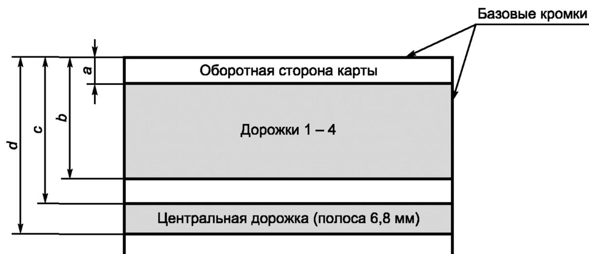
$$a = 5,39 \text{ мм}; b = 19,68 \text{ мм}; c = 23,59 \text{ мм}; d = 30,59 \text{ мм}$$
