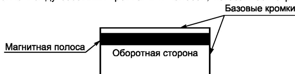
Рисунок 1 — Базовые кромки и боковая полоса
