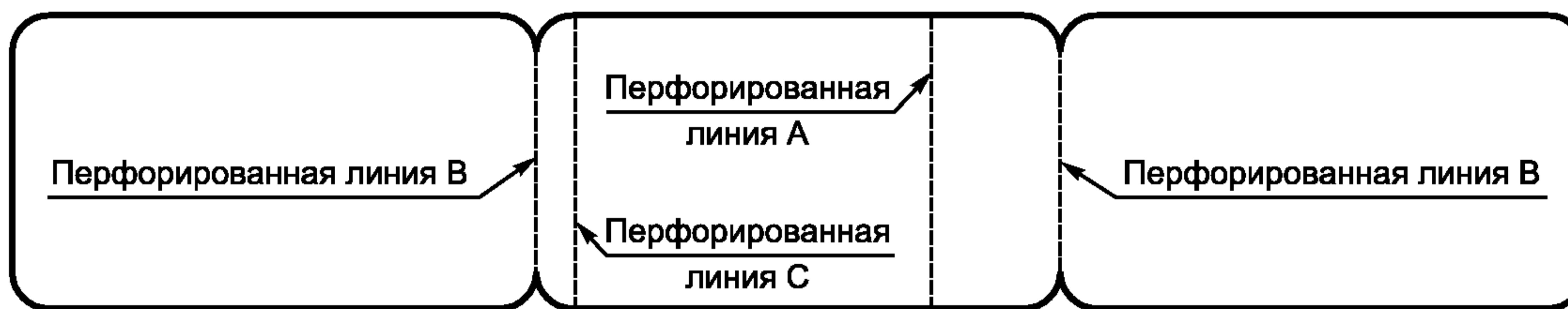
Рисунок 11 — Перфорированные линии на картах формата TFC.5,
