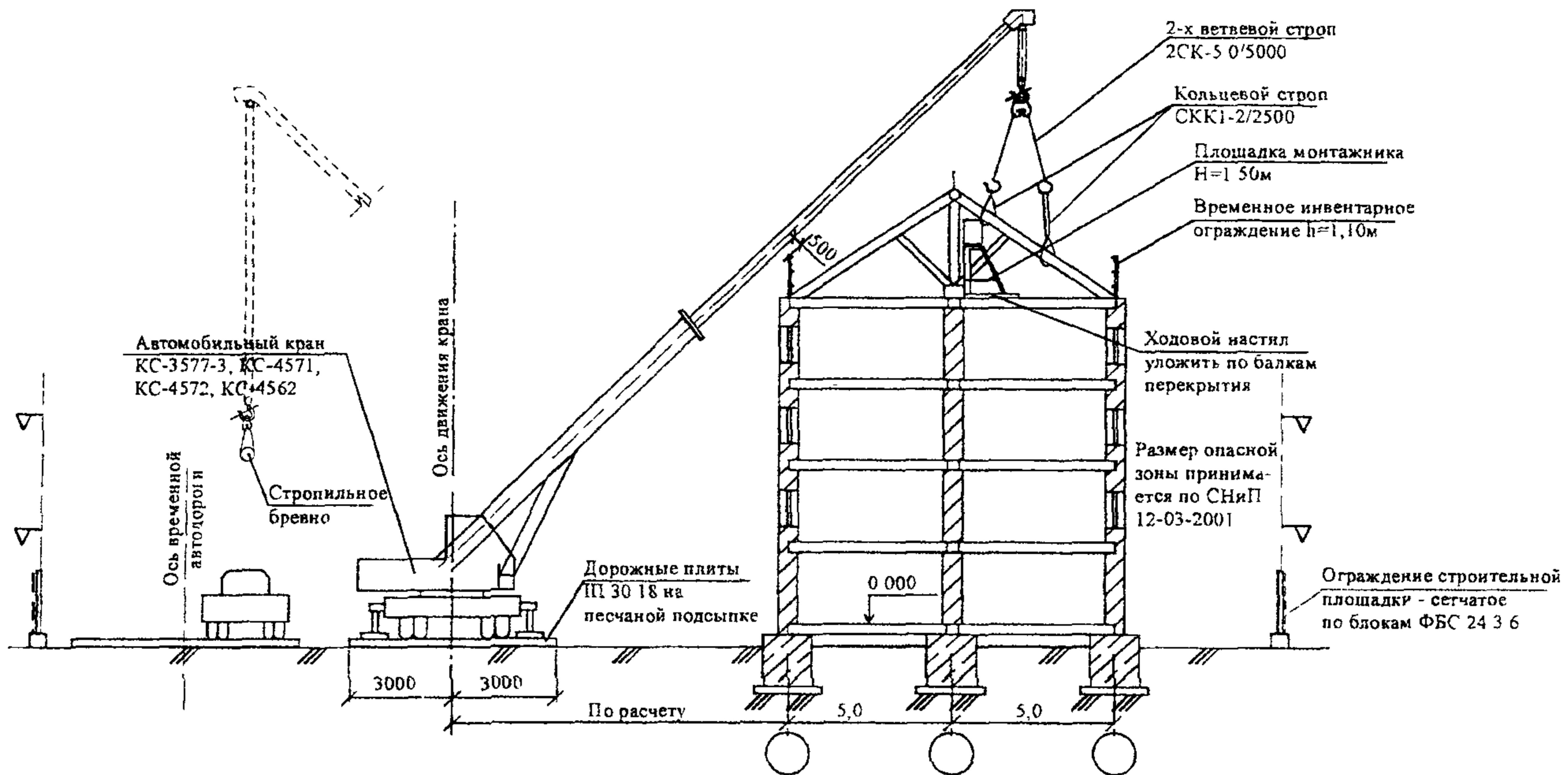
**Рисунок 5 – Схема строповки стропильных балок**
