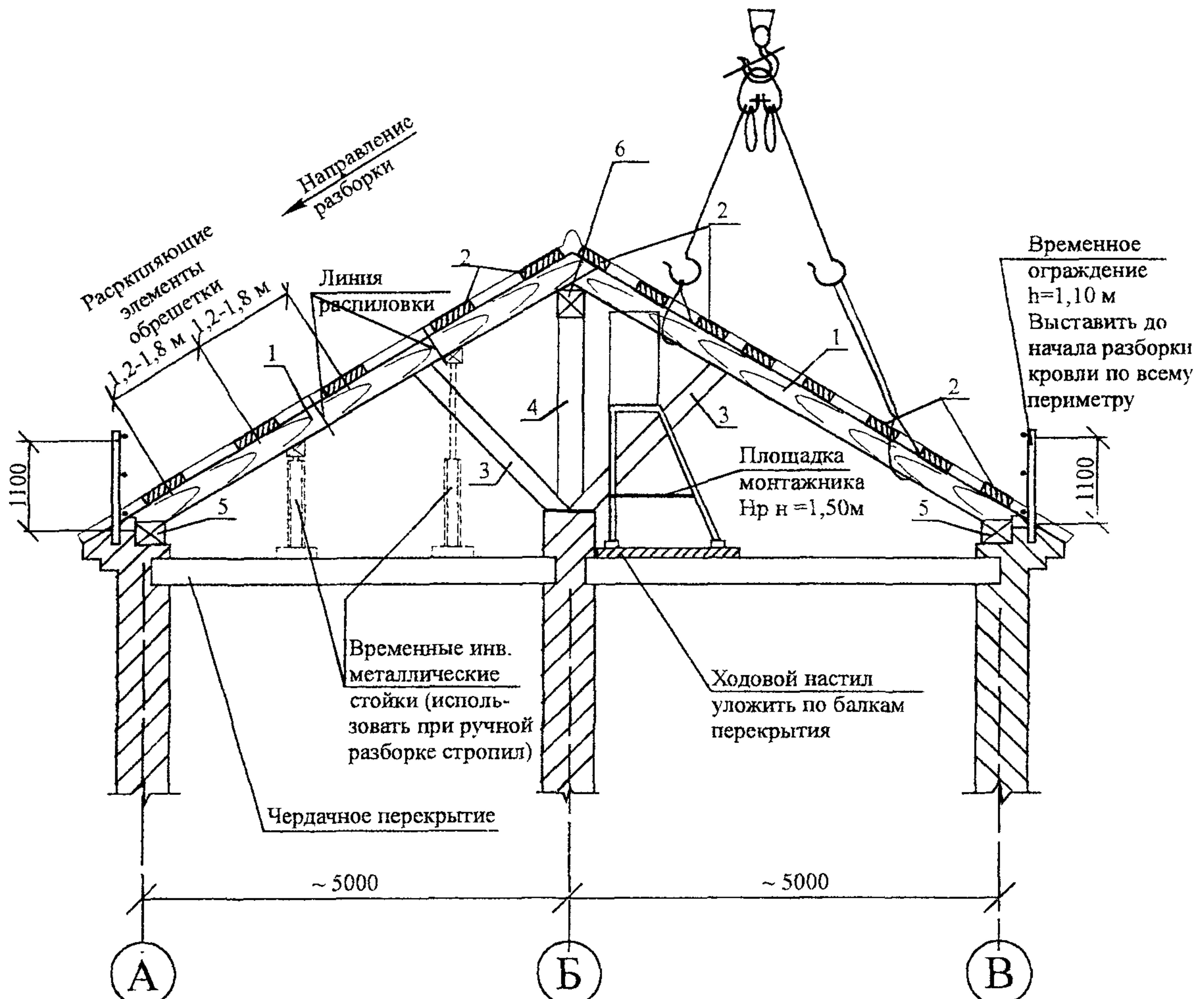
1 – стропило (бревно  $\varnothing 180\text{-}220$  мм); 2 – обрешетка (доска  $25\times 100$  мм); 3 – подкос (брус  $70\times 100$  мм); 4 – стойка (брус  $100\times 100$  мм); 5 – подстропильный брус ( $150\times 150$  мм), 6 – верхний прогон (БРЖ  $150\times 100$  мм)
