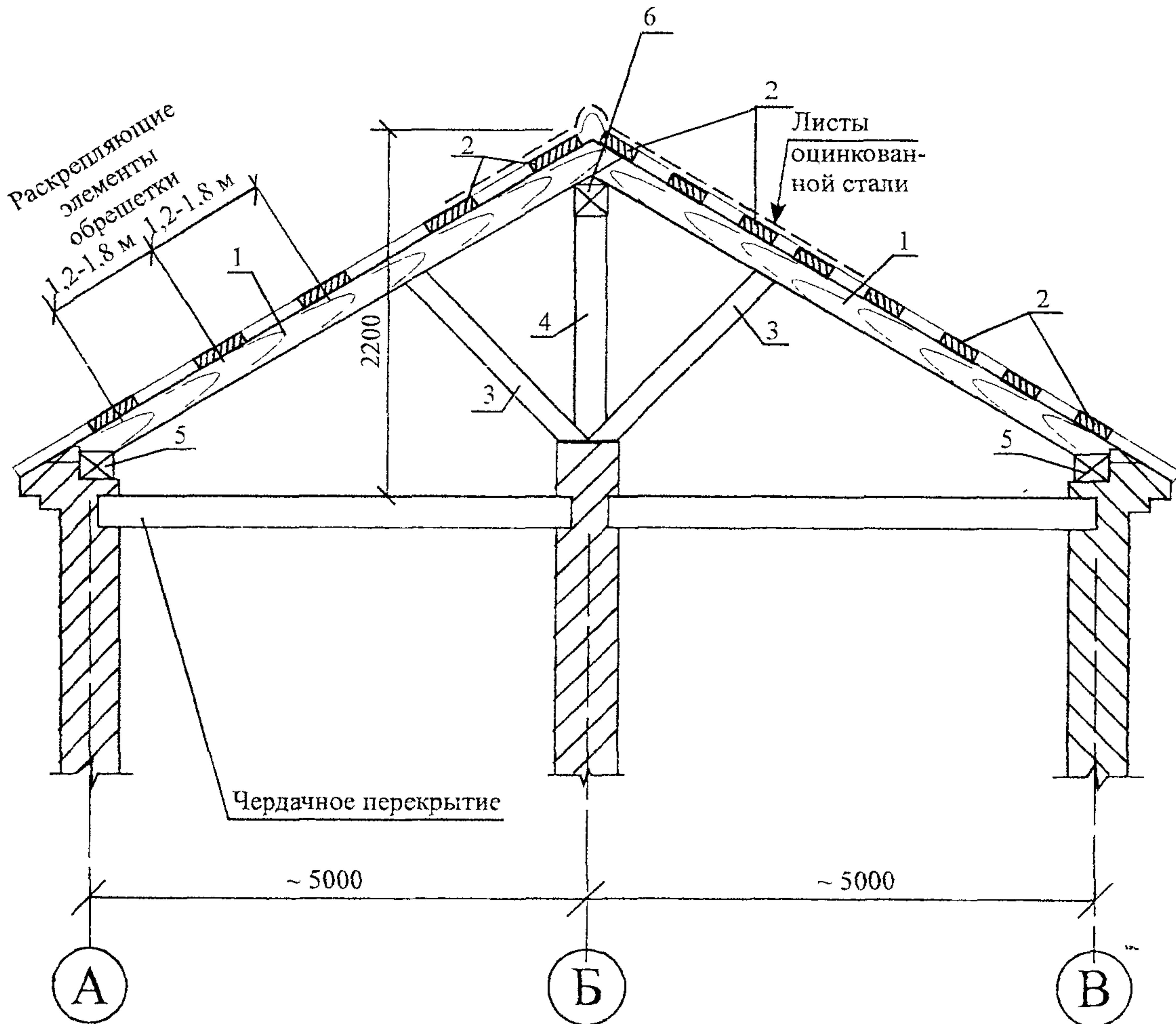
1 – стропила (бревно Ø180-220 мм); 2 – обрешетка (доска 25×100 мм); 3 – подкос (брус 70×100 мм); 4 – стойка (брус 100×100 мм); 5 – подстропильный брус (150×150 мм); 6 – верхний прогон (БРЖ 150×100 мм)
