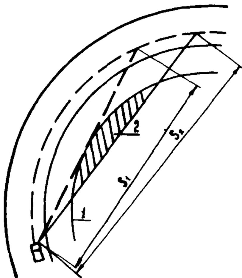
Рис. I. Обеспечение видимости на кривых в плане:
