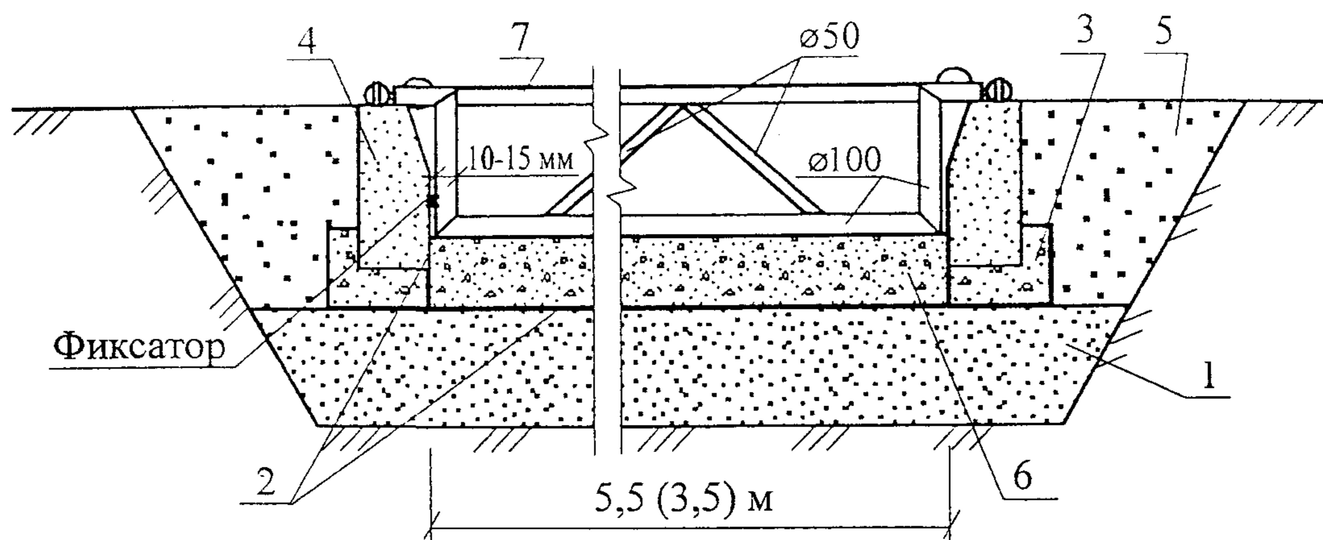
1 – подстилающий слой из песка; 2 – гидроизоляционный материал (полиэтиленовая пленка, пергамин и др.); 3 – бетонное основание под бортовой камень; 4 – бортовой камень; 5 – пазуха корыта дороги; 6 – основание из литого бетона; 7 – катучий металлический шаблон
