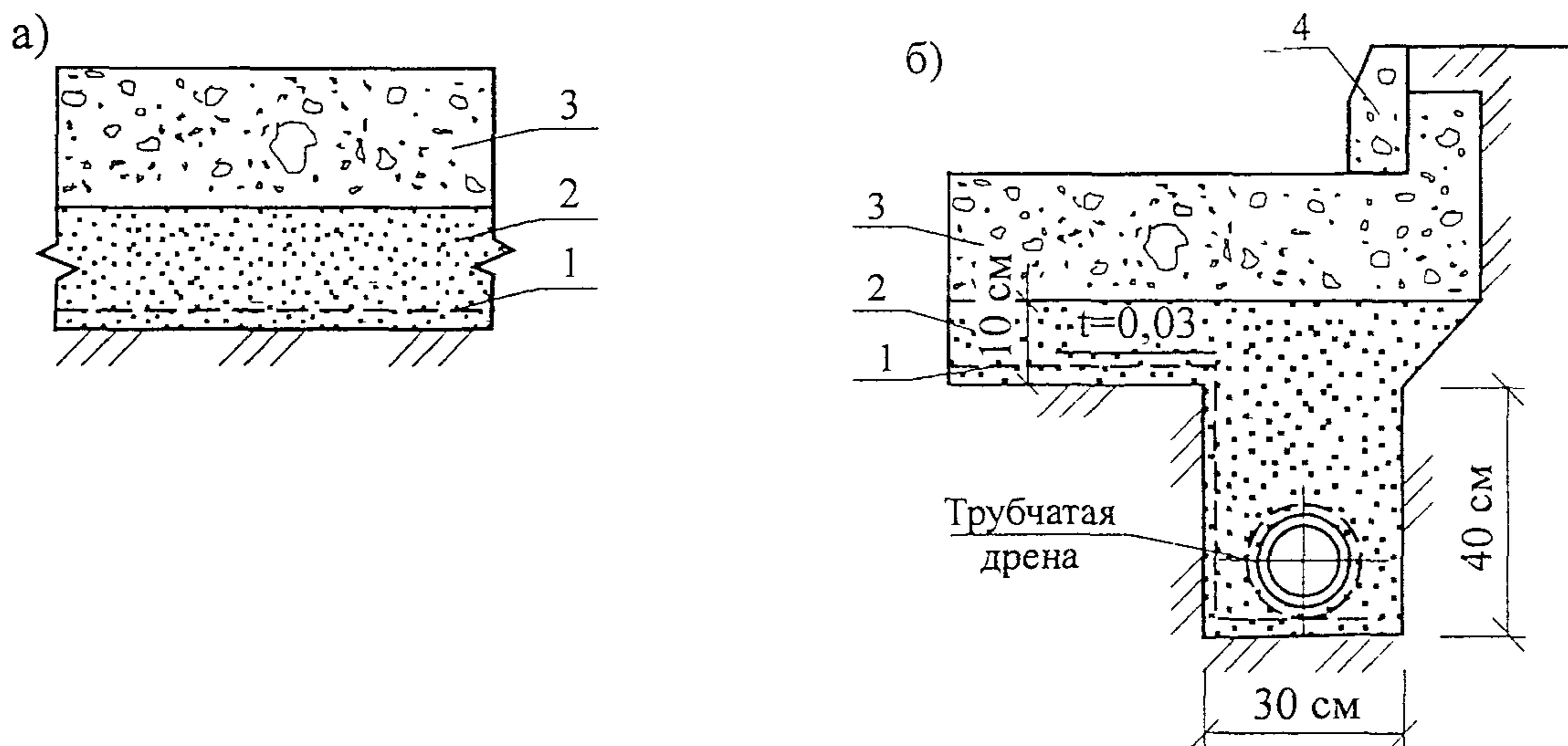
а – без устройства сопутствующего дренажа; б – при совмещении дренирующей прослойки с дренажом мелкого заложения;
