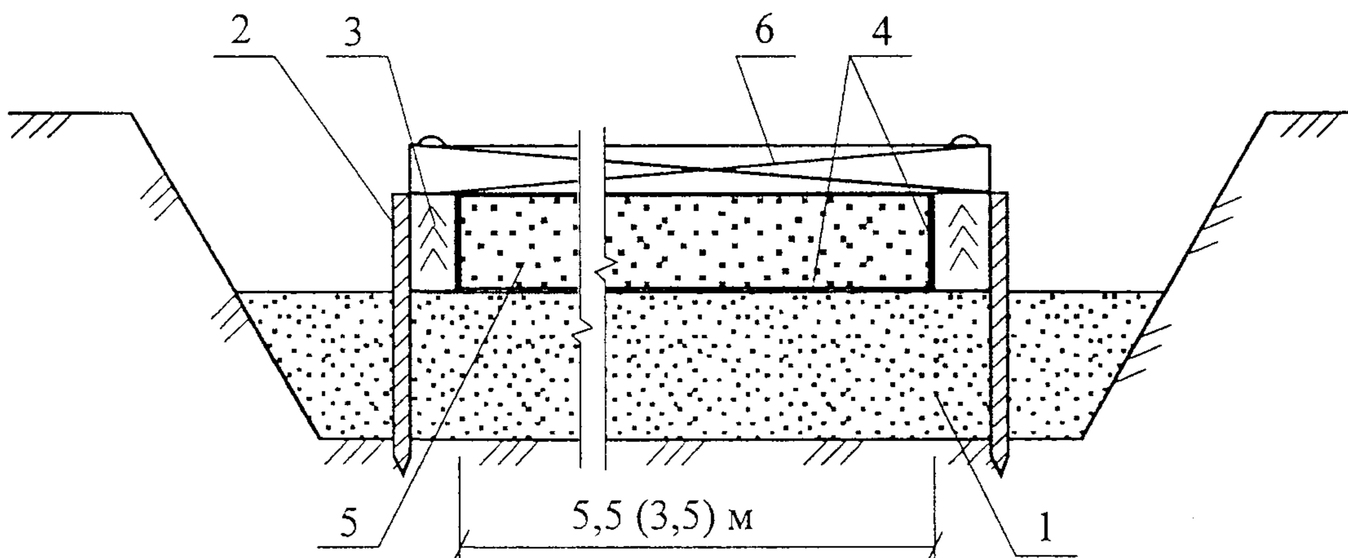
1 – подстилающий слой из песка; 2 – металлический штырь; 3 – деревянная опалубка; 4 – гидроизоляционный материал (полиэтиленовая пленка, пергамин и др.); 5 – основание из литого бетона; 6 – металлический или деревянный шаблон;
