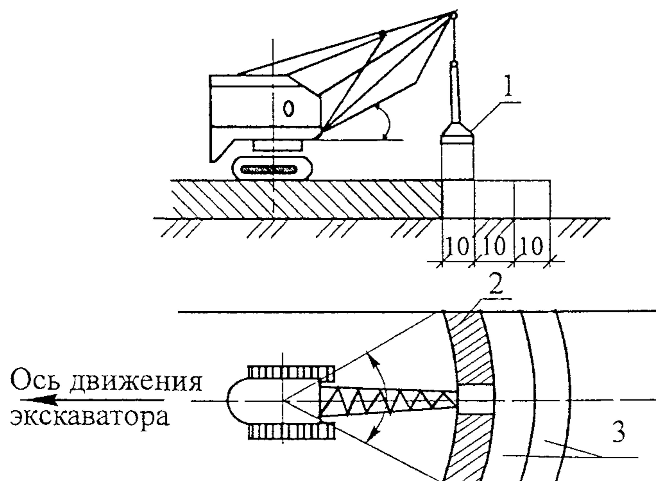
1 – трамбующая плита; 2 – полоса перекрытия; 3 – уплотненная полоса
