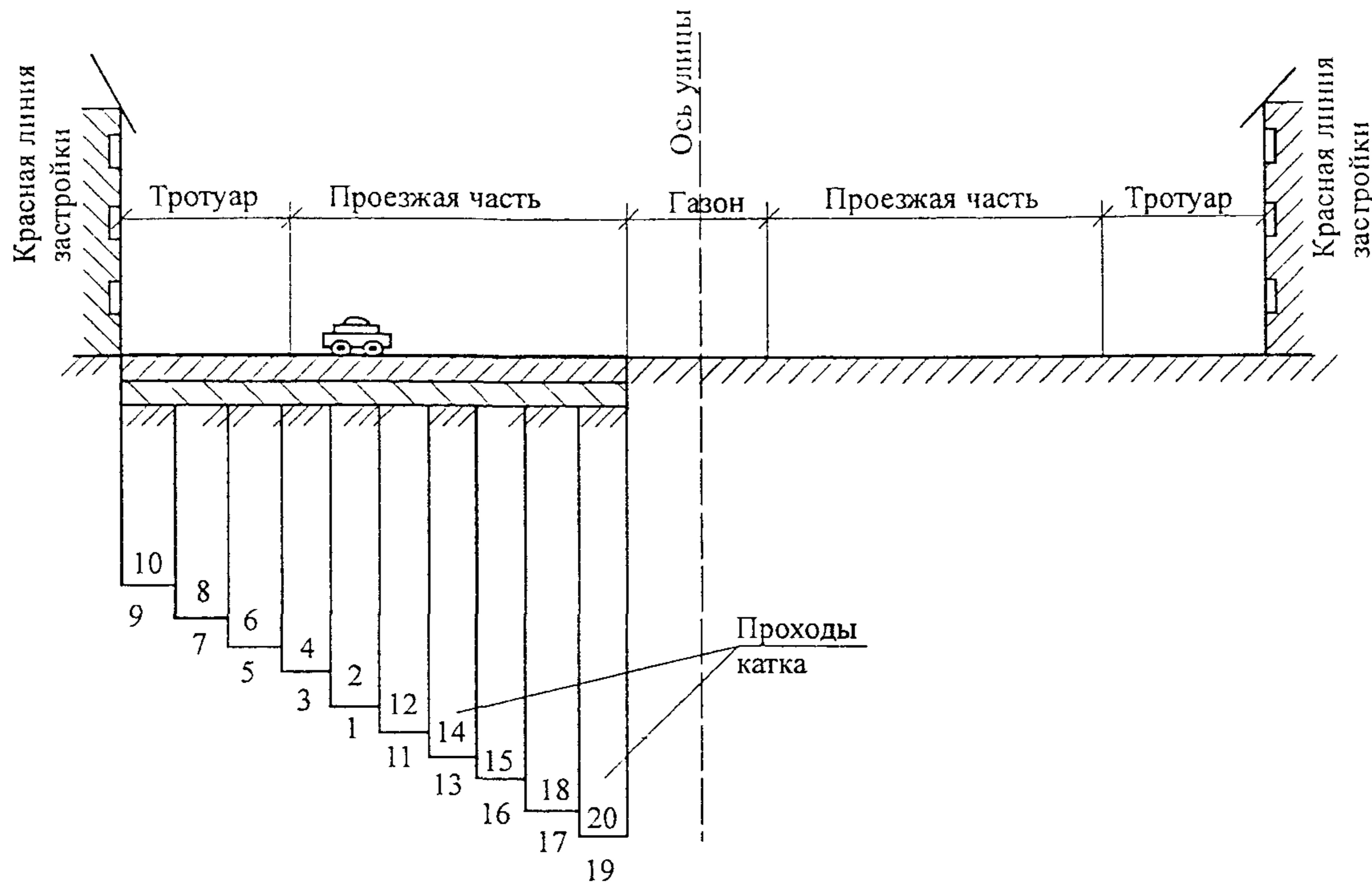
**Рисунок 4 – Схема уплотнения земляного полотна самоходными катками**
