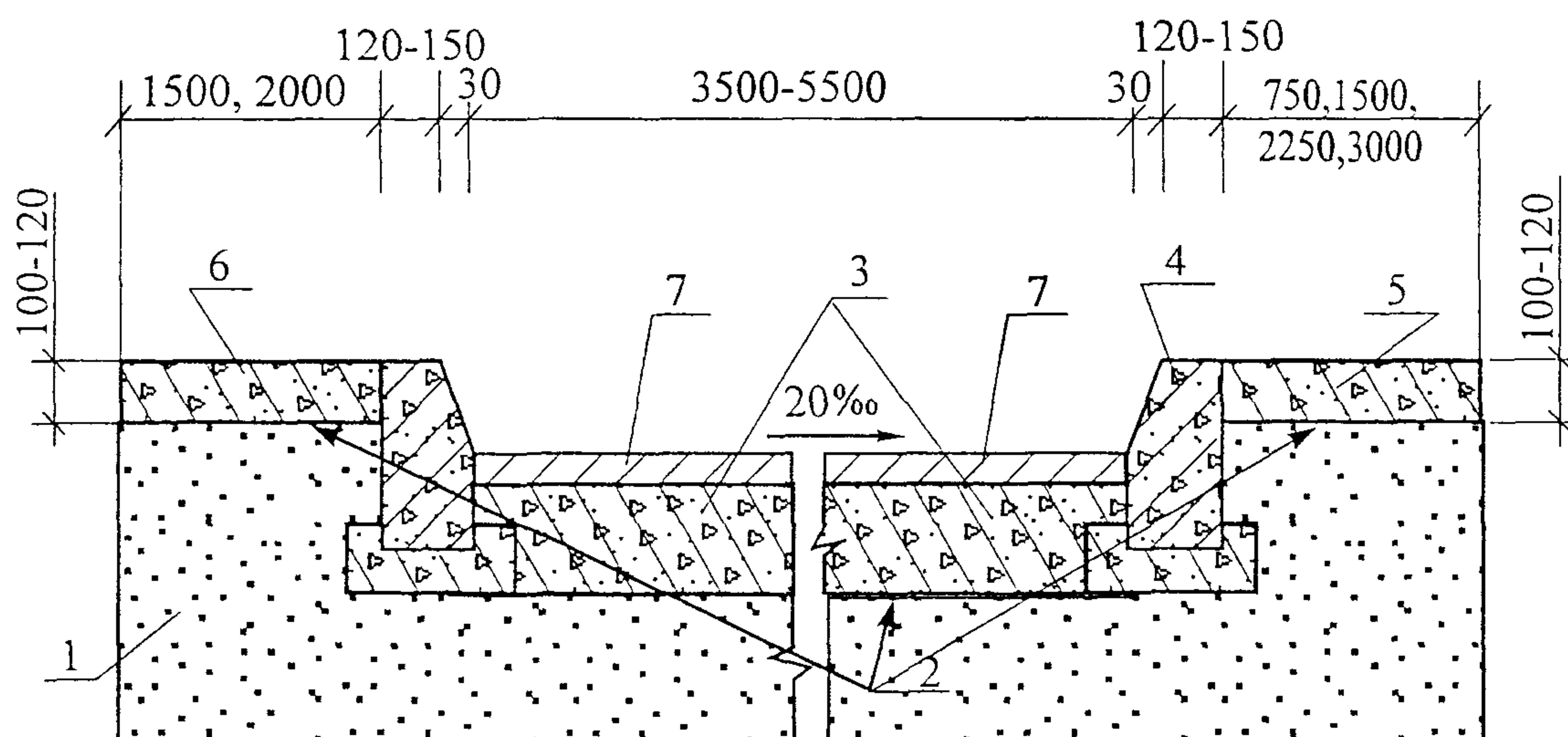
1 – песок; 2 – гидроизоляционный материал (пергамин, полиэтиленовая пленка); 3 – бетонное основание дороги; 4 – бортовой камень; 5 – бетонное покрытие тротуара; 6 – бетонная отмостка; 7 – асфальтобетонное покрытие
