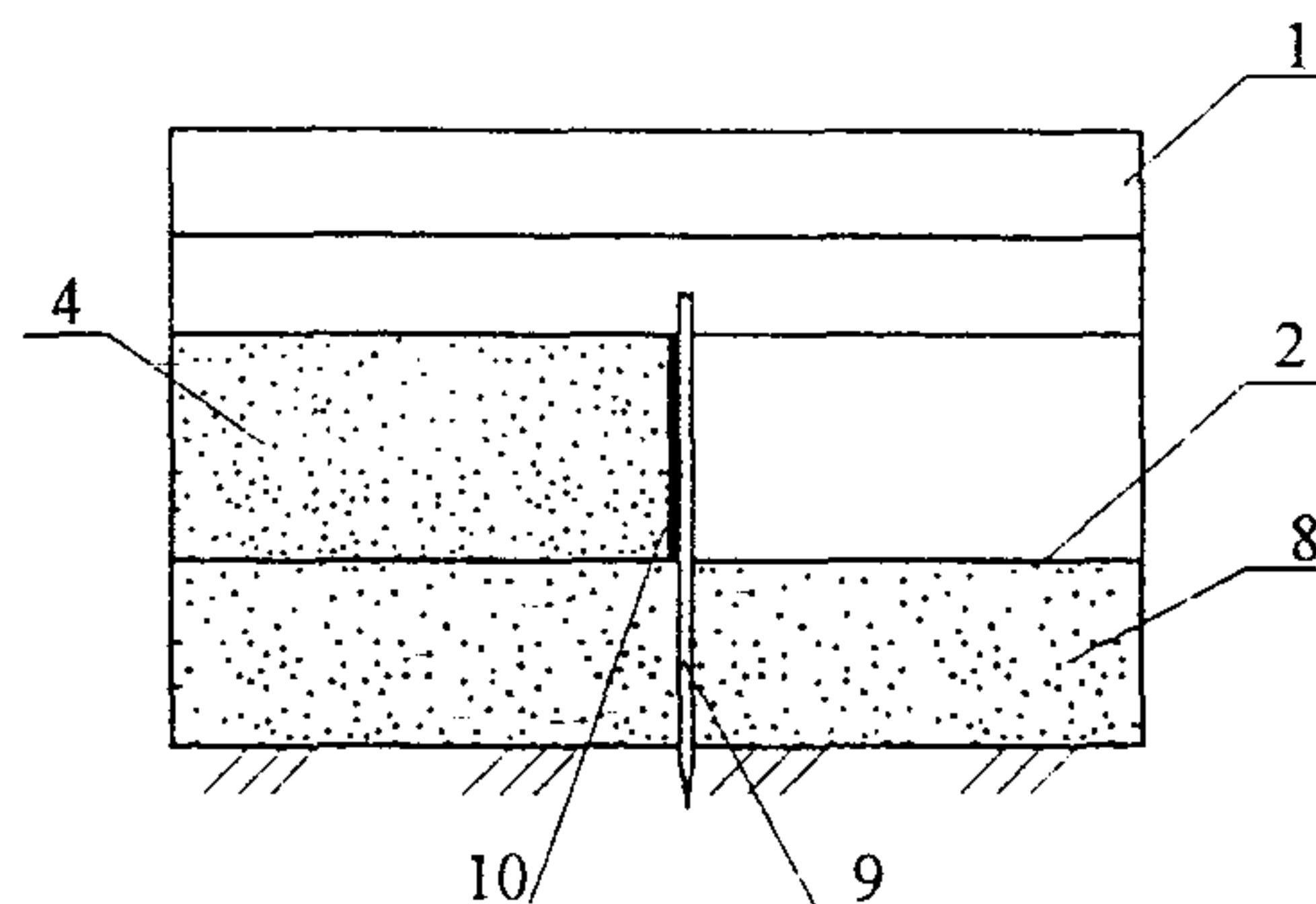
1 – бортовой камень или деревянная опалубка; 2 – гидроизоляционный материал (полиэтиленовая пленка или пергамин и др.); 3 – гладилка; 4 –литой бетон; 5 – направление работ; 6 – шаблон для разравнивания литого бетона; 7 – выровненная поверхность литого бетона; 8 – подстилающий слой песка; 9 – штырь; 10 – металлический шаблон (или деревянная доска), обернутый пергамином
