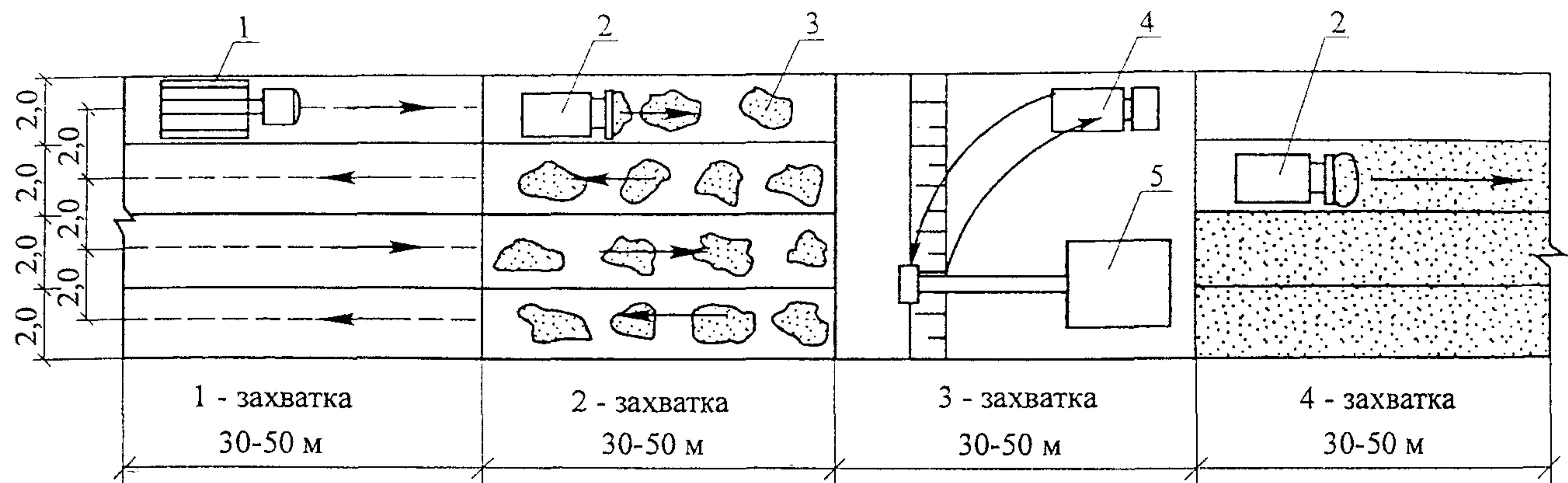
1 – грунтоуплотняющая машина ДУ-52; 2 – бульдозер ДЗ-54; 3 – грунт для подсыпки; 4 – автосамосвал КАМАЗ-55111; 5 – гидравлический экскаватор ЭО-4124Б
