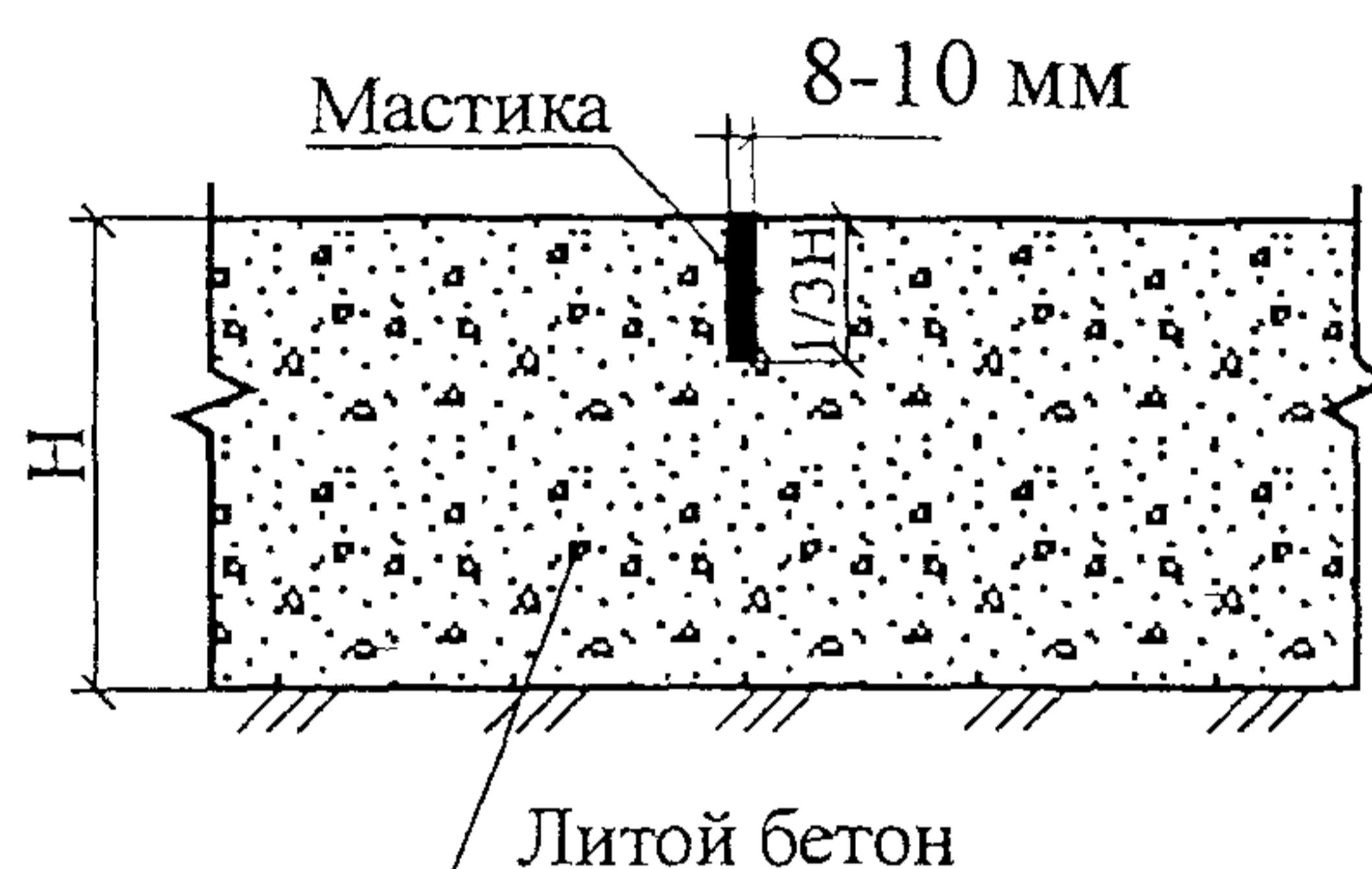
Рисунок 11 – Схема ложного шва сжатия
