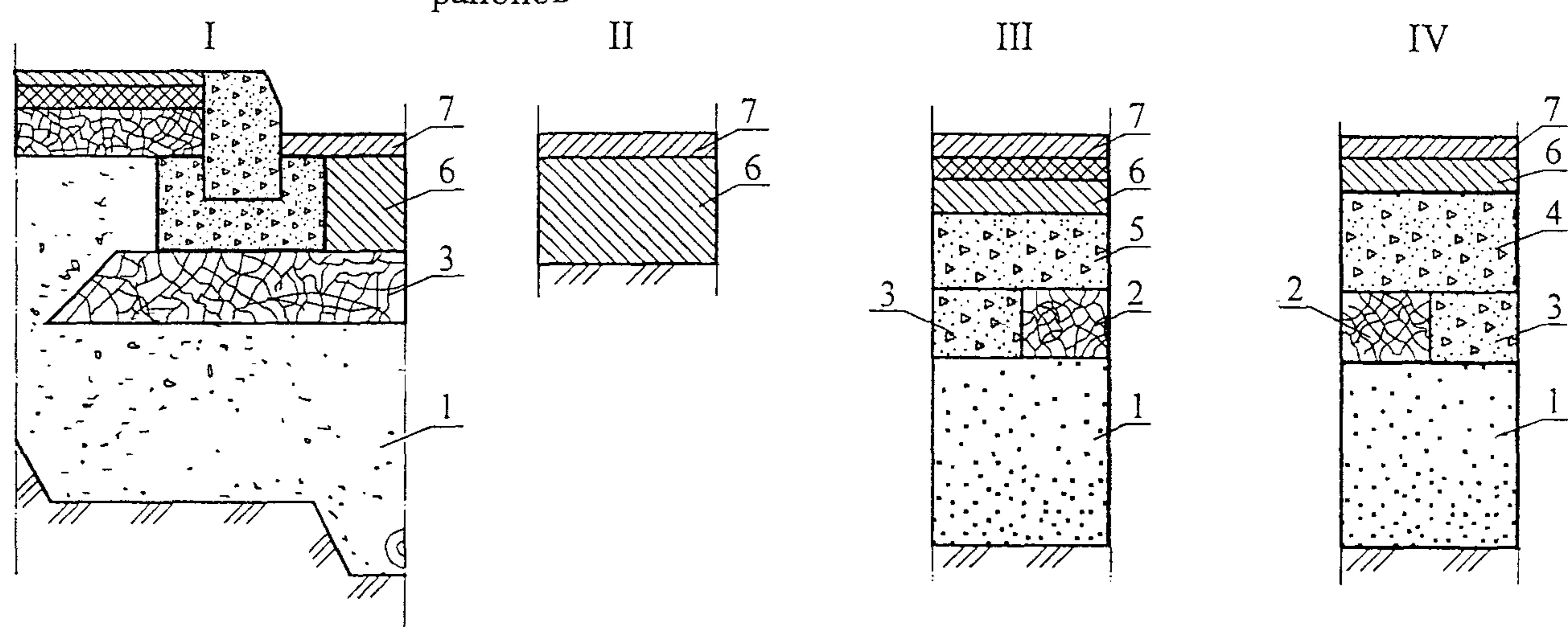
Вариант I – асфальтобетонное покрытие на технологическом слое; II – то же, на грунте; III, IV – то же, на бетонном основании:
