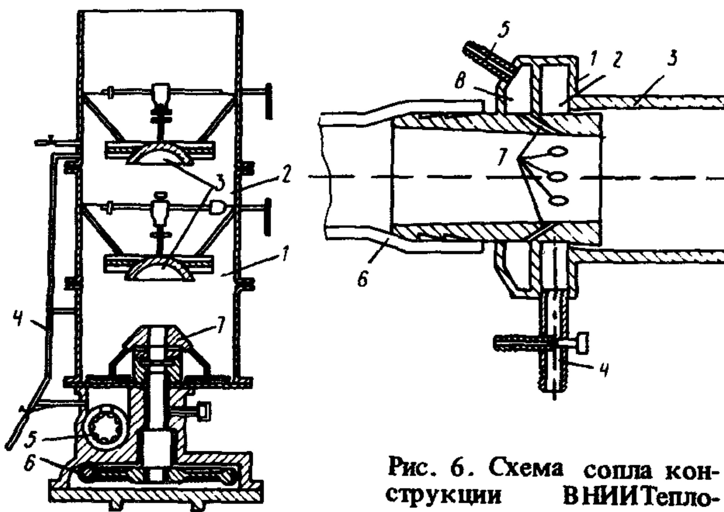
Рис. 5. Схема переоборудованной цемент-пушки С-320А
