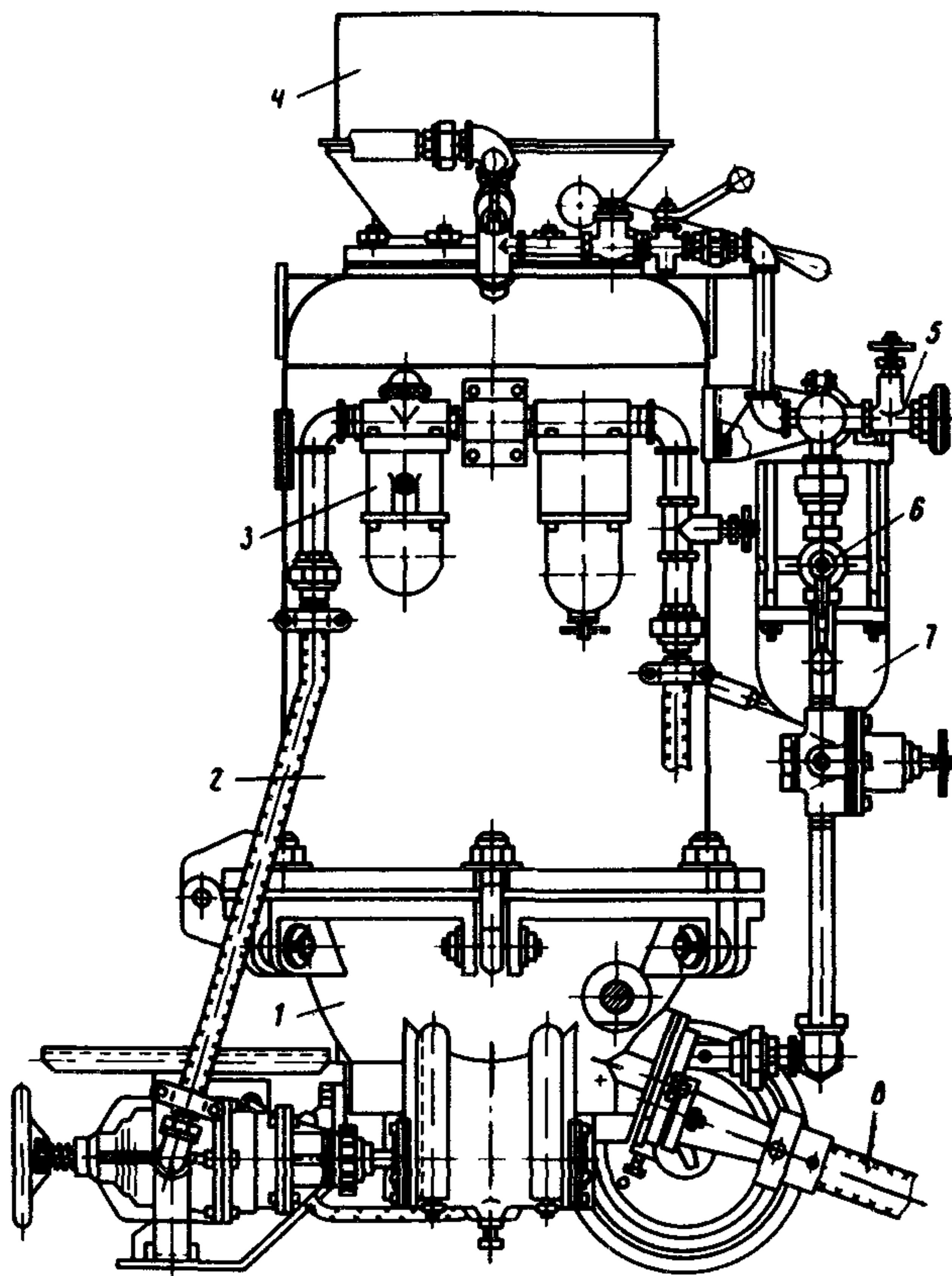
Рис. 4. Схема цемент-пушки ЦПШК-1 м
