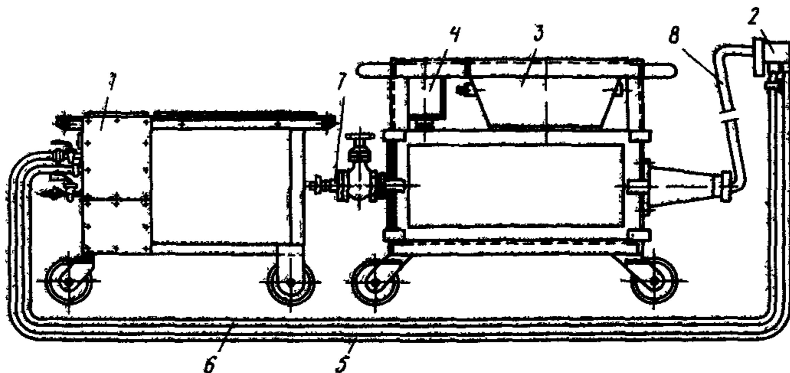
Рис. 9. Установка для нанесения огнезащитного покрытия ОФП-ММ марки УНОП-1м (ЦНИИСК им. Кучеренко)
